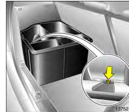
Ablagebox hinten mit Rändelschraube befestigen.
