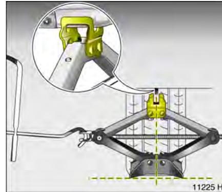
4. Vor Ansetzen des Wagenhebers erforderliche Höhe durch Drehen der Öse mit der Hand einstellen. Wagenheber – vorn bzw. hinten – so ansetzen, dass die Wagenheberklaue den senkrechten Steg zwischen den Markierungen umfasst und in die Aussparung im Steg greift. Auf korrekten Sitz achten.
