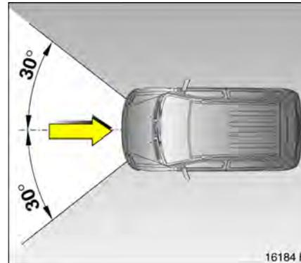
Das Front-Airbag-System löst aus
