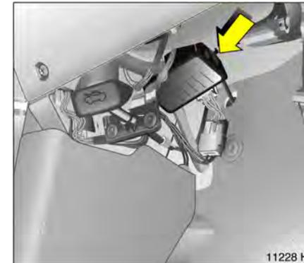
Zum Öffnen des Sicherungskastens im Fahrzeuginnenraum Lasche an Deckel drücken und Deckel abziehen. Auf dem Deckel ist die Sicherungsbelegung gezeigt.
