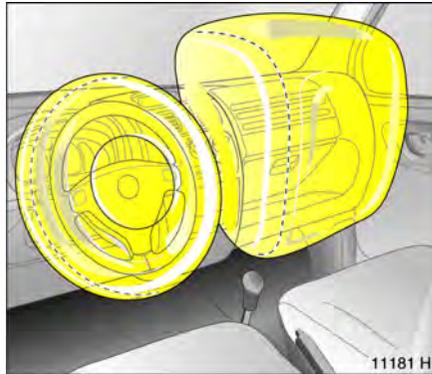
Beim Auslösen füllen sich die Front-Airbags innerhalb von Millisekunden und bilden Sicherheitspolster für Fahrer und Beifahrer\*. Die Vorwärtsbewegung der vorn sitzenden Insassen wird gedämpft und dadurch die Verletzungsgefahr von Oberkörper und Kopf erheblich vermindert.
