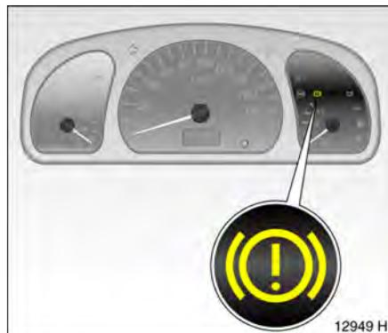
**Kontrollleuchte (ⓘ) für Bremssystem**
