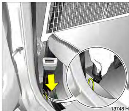
Spanngurte des Sicherheitsnetzes unten in die Ösen im Boden hinter den Vordersitzen einhängen und spannen.
