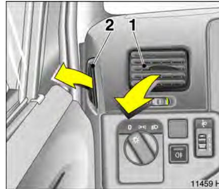
Seitliche Düsen öffnen: Rändelrad nach rechts drehen.
