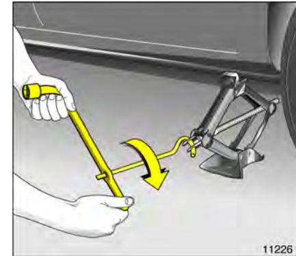
Kurbelstange in Öffnung an der Gewindestange einhängen, Radschraubensteckschlüssel mit Öse auf Kurbelstange stecken.
