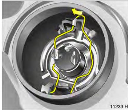
4. Federdrahtbügel aus der Haltnase zur Seite ausrasten und nach unten schwenken.
