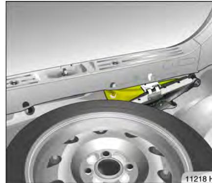
Das Wagenwerkzeug ist zwischen Wagenheber und der hinteren Gepäckraumwand untergebracht.
