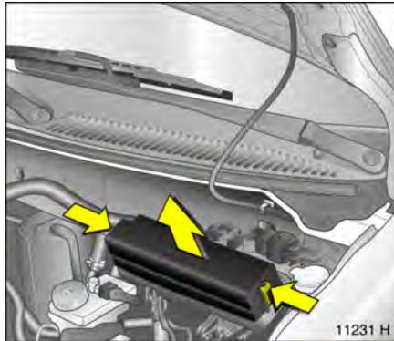
**Sicherungskasten im Motorraum unterhalb der Windschutzscheibe**
