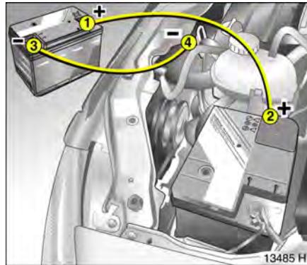
Kabel in der im Bild gezeigten Reihenfolge anschließen:
