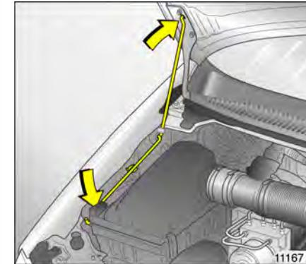
Zum Arretieren der Haube in Öffnungsstellung die in Fahrtrichtung rechts angeordnete Stütze in den kleinen Längsschlitz auf der Haubenunterseite einsetzen.
