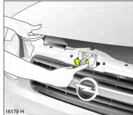
In Motorhaubenmitte befindet sich über dem Kühlergrill ein Sicherungsgriff: Zum Öffnen zur rechten Fahrzeugseite drücken und Haube anheben.
