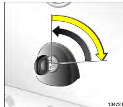
Nach Schließen der Hecktür Schlüssel bis zum Anschlag rechts herum drehen. Schlüssel springt in Mittelstellung zurück, die Hecktür ist verriegelt. Schlüssel abziehen.
