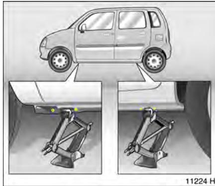
3. Am Fahrzeugunterbau sind vorn und hinten – jeweils zwischen zwei Markierungen – Aufnahmen zum Ansetzen des Wagenhebers vorhanden.
