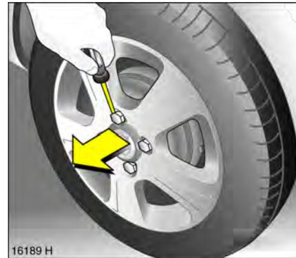
Leichtmetallräder \*: Radschraubenkappen mit Schraubendreher von den Radschrauben abziehen. Dabei zum Schutz der Felge weichen Lappen zwischen Schraubendreher und Leichtmetallrad legen.
