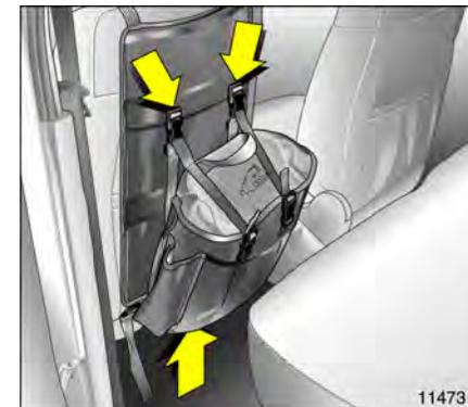
Rucksack oben an beiden Haltern einrasten und unten an Druckknopf befestigen.
