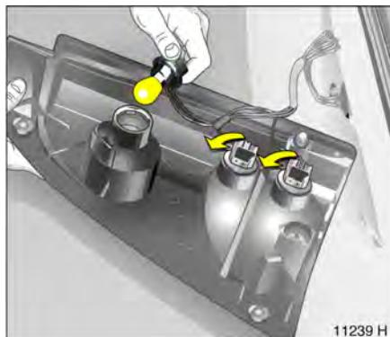
3. Entsprechende Lampenfassung links herum drehen und aus Lampengehäuse nehmen.
