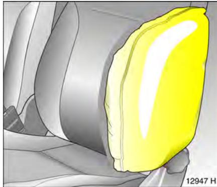
Beim Auslösen füllt sich der Seiten-Airbag innerhalb von Millisekunden und bildet im Bereich der jeweiligen Vordertür ein Sicherheitspolster für Fahrer bzw. Beifahrer. Bei einem Seitenaufprall wird so die Verletzungsgefahr des Oberkörpers erheblich vermindert.
