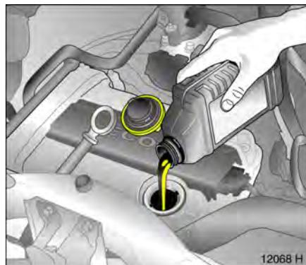
Zum Nachfüllen diejenige Motorölmarke verwenden, die beim vorangegangenen Motorölwechsel eingefüllt wurde, unbedingt Hinweise im Serviceheft beachten.
