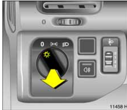
Dauerbetrieb: Lichtschalter ziehen.
