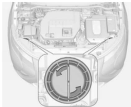
1. Abdeckung durch Drehen nach links von der Rückseite der Scheinwerferbaugruppe abnehmen.
