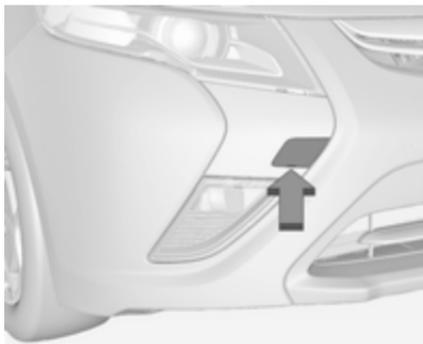
Einen Schraubendreher in den Schlitz an der kürzeren Kante der Abdeckung stecken. Abdeckung durch vorsichtiges Seitwärtsbewegen des Schraubendrehers lösen. Um Schäden zu vermeiden, wird empfohlen, ein Tuch zwischen Schraubendreher und Rahmen zu legen.
