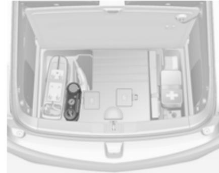
Das Reifenreparaturset befindet sich unter einer Abdeckung im Laderaum.
