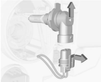
4. Neue Glühlampe in die Fassung einsetzen.
