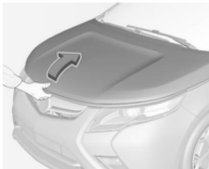
3. Den Verschlusshaken im Motorraum nach rechts ziehen und die Motorhaube öffnen.
