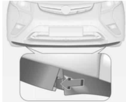
Der vordere Windabweiser lenkt den Luftstrom unterhalb des Fahrzeugs. Falls er sich gelockert hat, die Lasche in den Schlitz stecken. Ggf. auf der anderen Seite wiederholen.
