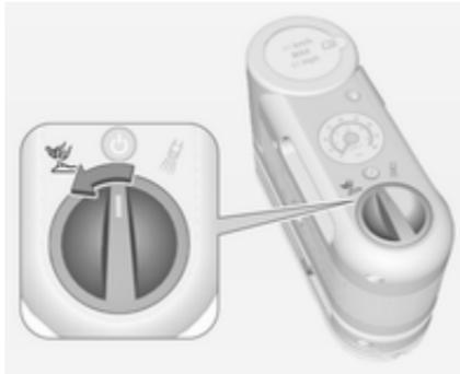
8. **Dichtmittel-/Luftschlauch:** Den Wahlwippschalter drücken und nach links auf ↶ drehen.
