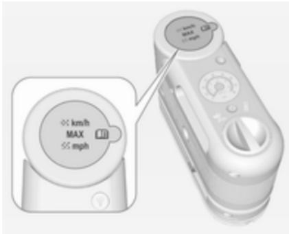
16. **Dichtmittel-/Luftschlauch:** Wenn der defekte Reifen bis zum empfohlenen Druck befüllt wurde, den Aufkleber für die Höchstgeschwindigkeit vom Dichtmittelbehälter abziehen und an einer gut sichtbaren Stelle anbringen. Die hier angegebene Geschwindigkeit nicht überschreiten, solange der defekte Reifen nicht repariert oder ersetzt wurde.
