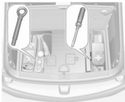
Die Abschleppöse und ein Schraubendreher sind unter einer Abdeckung im Laderaum zu finden. Die Abschleppöse befindet sich unter dem Reifenreparaturset.
