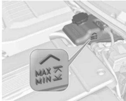
Wenn das Fahrzeug seit mind. 1 Minute abgestellt ist, ist der maximale Füllstand die obere Behälterkante. Bei laufendem Fahrzeug sollte der Flüssigkeitsstand im korrekten Betriebsbereich zwischen den Markierungen **MIN** und **MAX** liegen. Wenn nicht, das hydraulische Bremssystem auf Undichtigkeiten prüfen lassen.
