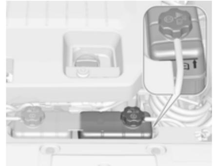
Überprüfen, ob Kühlmittel im Kühlmittelbehälter der Motorelektronik- und Lademodule sichtbar ist. Wenn Kühlmittel sichtbar ist, der Kühlmittelstand jedoch unter der Kaltfüllmarkierung liegt, könnte das Kühlsystem undicht sein.
