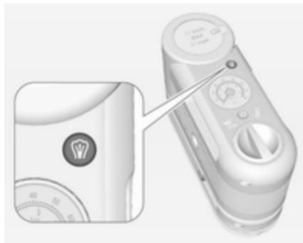
**Nur-Luft-Schlauch:** Falls der Reifen stärker als empfohlen aufgepumpt wurde, kann der überschüssige Druck durch Drücken von
