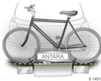
Stellen Sie die Radaufnahme so ein, dass das Fahrrad mehr oder weniger waagrecht steht. Hier sollte der Abstand zwischen den Pedalen und der Hecktür mindestens 5 cm betragen. Einstellen der Radaufnahmen - siehe Seite 158.
