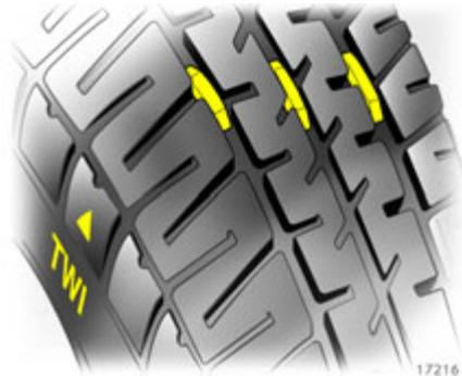
Reifen sollten aus Sicherheitsgründen bei einer Profiltiefe von 2 bis 3 mm erneuert werden. Die gesetzlich zulässige Mindestprofiltiefe (1,6 mm) ist erreicht, wenn das Profil bis zu einem der Verschleißanzeiger abgefahren ist.
