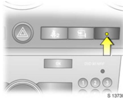
Prüfen Sie, dass die Kontrollleuchte nach dem Leuchten für ca. 30 Sekunden langsam zu blinken beginnt, um die erfolgreiche Aktivierung der Diebstahlwarnanlage anzuzeigen.
