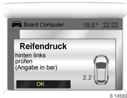
Eine Grafik mit Kennzeichnung des hinteren linken Reifens und der Anzeige des aktuellen Reifendruckes: Geringe Druckabweichung, Geschwindigkeit verringern. Reifendruck bei nächster Gelegenheit mit geeichtem Prüfgerät überprüfen und gegebenenfalls korrigieren.
