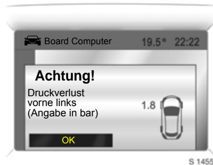
Eine Grafik mit Kennzeichnung des vorderen linken Reifens und der Anzeige des aktuellen Reifendruckes: Erheblicher Druckunterschied oder direkter Druckverlust! Schnellstmöglich aus dem fließenden Verkehr ohne Behinderung anderer Fahrzeuge fahren, anhalten und Reifen überprüfen.
