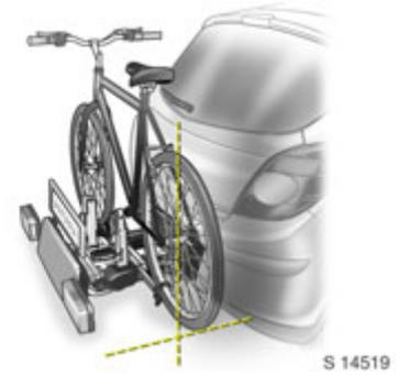
Richten Sie das Fahrrad in der Längsachse des Fahrzeugs aus:
