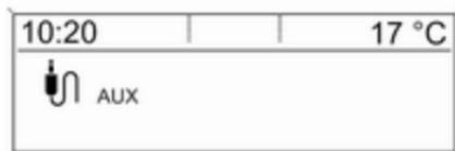
Eine am AUX-Eingang angeschlossene Audioquelle kann nur über die Bedienelemente der Audioquelle bedient werden.
