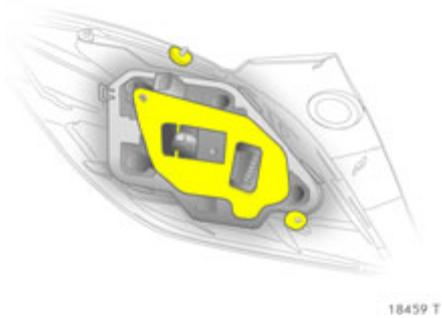
9. Sicherstellen, dass die Dichtungen am Lampenträger und an den Befestigungsschrauben angesetzt sind.
