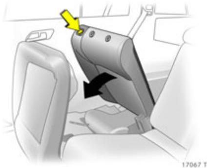
Rück Sitzlehne, einteilig oder geteilt ✱, mit Drucktasten ausrasten, nach vorn klappen und einrasten.
