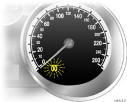
Wenn das Filter gereinigt werden muss und die letzten Fahrbedingungen die Reinigung nicht automatisch zuließen, dann blinkt die Kontrollleuchte
