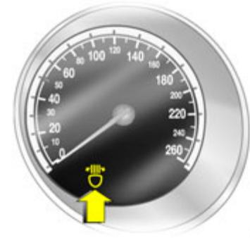
**Kontrollleuchte** für adaptives Fahrlicht Blinken: Störung im System. Das System ist nicht funktionsbereit.
