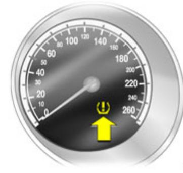
Gleichzeitig erscheint eine Grafik mit Kennzeichnung des hinteren linken Reifens und der Anzeige des aktuellen Reifendrucks: Geringe Druckabweichung, Geschwindigkeit verringern. Reifendruck bei nächster Gelegenheit mit geeichtem Prüfgerät überprüfen und gegebenenfalls korrigieren.
