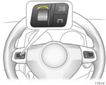
Auswahl mit dem linken Stellrad \* am Lenkrad: Rändelrad drehen und drücken.
