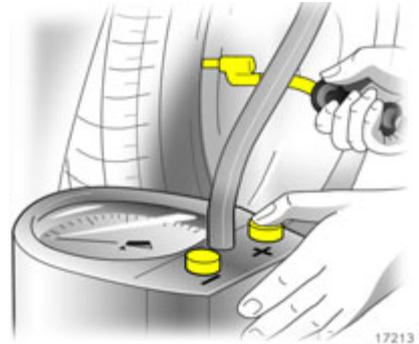
Ventilkappen nach der Prüfung mit Ventilkappenschlüssel fest zuschrauben.
