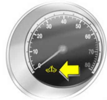
Leuchtet die Kontrollleuchte nach Anlassen des Motors, liegt eine Störung in der Motorelektronik oder der Getriebeelektronik \* vor, siehe Seiten 184, 190, 198, 209 oder es befindet sich Wasser im Dieselmotorkraftstofffilter \*, siehe Seite 304.
