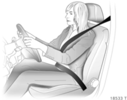
Höhe so einstellen, dass der Sicherheitsgurt über die Schulter verläuft und an der Schulter anliegt. Er darf nicht über Hals oder Oberarm verlaufen.
