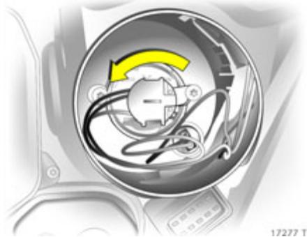
3. Lampenträger links herumdrehen und ausrasten.
