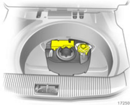
Das Reifenreparaturset befindet sich in einer Ablage unter der Bodenabdeckung im Gepäckraum.
