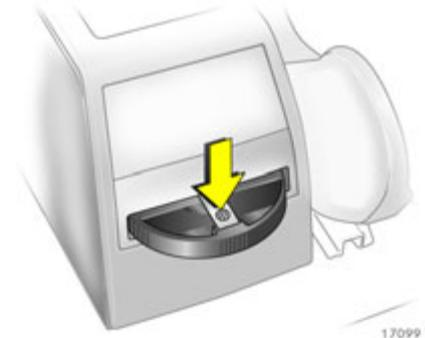
Zum Entleeren Ascher öffnen, Feder drücken (Pfeil) und Ascher gerade nach hinten herausziehen.
