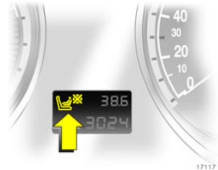
Leuchtet die Kontrollleuchte während der Fahrt nicht, sind der Front- und Seiten-Airbag \* für den Beifahrer nicht deaktiviert, es besteht Lebensgefahr für das Kind, Kindersicherheitssystem auf dem Rücksitz montieren. Störungsursache von einer Werkstatt beheben lassen.
