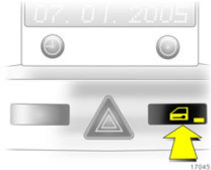
**Zentralverriegelungstaste zum Verriegeln bzw. Entriegeln der Türen vom Innenraum aus**
