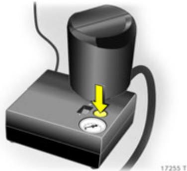
Wird der vorgeschriebene Reifendruck innerhalb von 10 Minuten nicht erreicht, das Reifenreparaturset abbauen. Das Fahrzeug um eine Reifenumdrehung bewegen. Das Reifenreparaturset wieder anschließen und Befüllvorgang 10 Minuten fortsetzen. Wird der vorgeschriebene Reifendruck danach immer noch nicht erreicht, ist der Reifen zu stark beschädigt. Hilfe einer Werkstatt in Anspruch nehmen.
