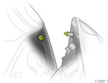
10. Lampengehäuse in Karosserie einsetzen, dabei Rastnase und Kugelbolzen in Aussparungen einrasten. Befestigungsmuttern mit Radschraubensteckschlüssel \* festziehen. Kabelstecker einrasten. Klappe schließen und verriegeln.
