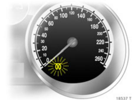
Unter bestimmten Fahrbedingungen, z. B. Kurzstreckenverkehr, kann das System sich nicht automatisch reinigen.
