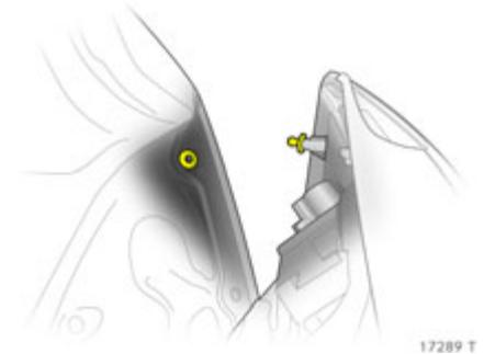
10. Lampengehäuse in Karosserie einsetzen, dabei Rastnase und Kugelbolzen in Aussparungen einrasten. Befestigungsmuttern mit Radschraubensteckschlüssel \* festziehen. Kabelstecker einrasten. Klappe schließen und verriegeln.
