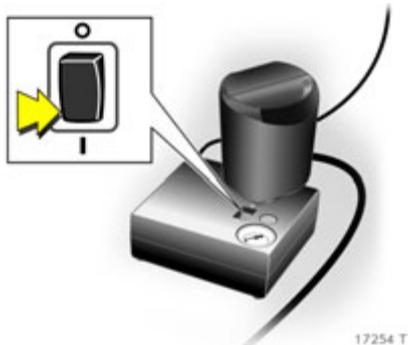
10. Wippschalter am Kompressor auf I stellen, der Reifen wird mit dem Dichtmittel gefüllt.
