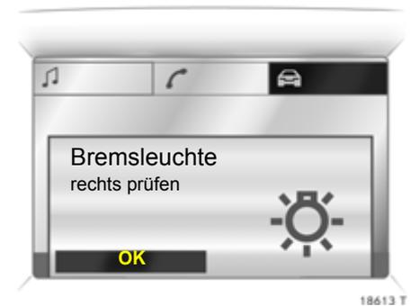
Bei einer Störung der Fahrzeugbeleuchtung erscheint die entsprechende Fehlerquelle als Text, z. B.:
