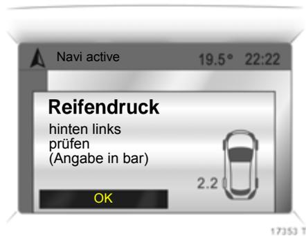
Gleichzeitig erscheint eine Grafik mit Kennzeichnung des hinteren linken Reifens und der Anzeige des aktuellen Reifendrucks: Geringe Druckabweichung, Geschwindigkeit verringern. Reifendruck bei nächster Gelegenheit mit geeichtem Prüfgerät überprüfen und gegebenenfalls korrigieren.
