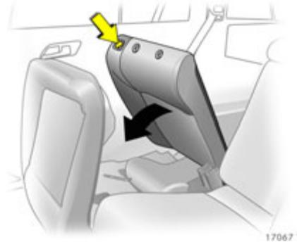
Rücksitzlehne, einteilig oder geteilt ✱, mit Drucktasten austrasten, nach vorn klappen und einrasten.
