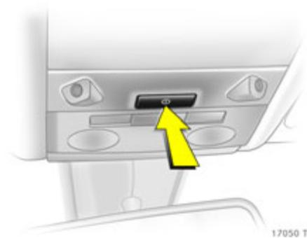
**Einschalten ohne Überwachung des Innenraums und der Fahrzeugneigung**
