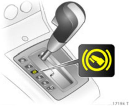
In den Stellungen **P** oder **N** leuchtet die Kontrollleuchte
