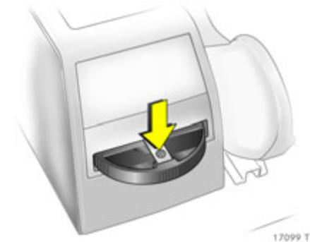
Zum Entleeren Ascher öffnen, Feder in Pfeilrichtung drücken und Ascher gerade nach hinten herausziehen.
