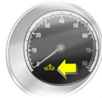
Leuchtet die Kontrollleuchte nach Anlassen des Motors, liegt eine Störung in der Motorelektronik oder der Getriebeelektronik \* vor ↗ 174, ↗ 180, ↗ 185, ↗ 193 oder es befindet sich Wasser im Diesel-Kraftstofffilter \* ↗ 285.
