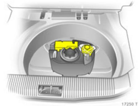
Das Reifenreparaturset befindet sich in einer Ablage unter der Bodenabdeckung im Gepäckraum.
