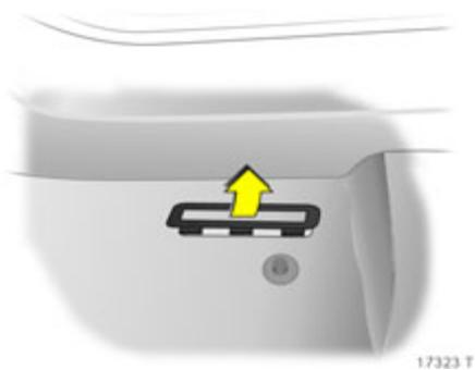
Die Fahrzeug-Identifizierungsnummer ist auf dem Typschild und auf der rechten Seite im Boden des Fahrzeuges zwischen Vordertür und Sitz unter einer Abdeckung eingepreßt.
