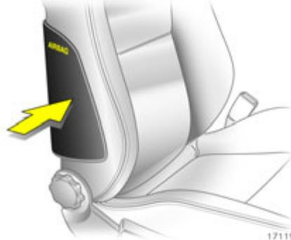
Ausführung mit Seiten-Airbag-System \* ist an den Schriftzügen **AIRBAG** an den Außenseiten der Vordersitzlehnen erkennbar. Sitzbelegungserkennung \* ⇨ 94.
