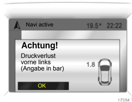
Gleichzeitig erscheint eine Grafik mit Kennzeichnung des vorderen linken Reifens und der Anzeige des aktuellen Reifendrucks: Erheblicher Druckunterschied oder direkter Druckverlust! Schnellstmöglich aus dem fließenden Verkehr ohne Behinderung anderer Fahrzeuge fahren, anhalten und Reifen überprüfen.
