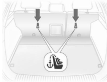
Zusätzlich zur Isofix-Befestigung den Top-Tether Befestigungsgurt an der Top-Tether Befestigungsöse verankern. Der Gurt muss zwischen den beiden Führungstangen der Kopfstütze verlaufen.
