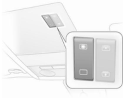
Betätigung mit Wipptaste in der Dachkonsole.
