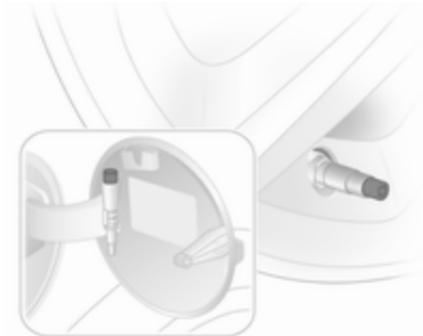
Bei Fahrzeugen mit Reifendruck-Kontrollsystem: Adapter auf Ventil schrauben.
