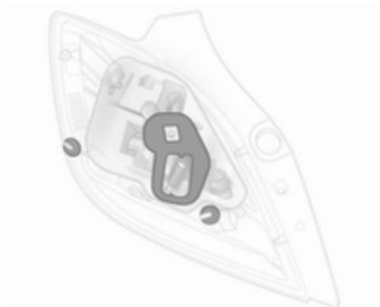
8. Sicherstellen, dass die Dichtungen am Lampenträger und an den Befestigungsschrauben angesetzt sind.
