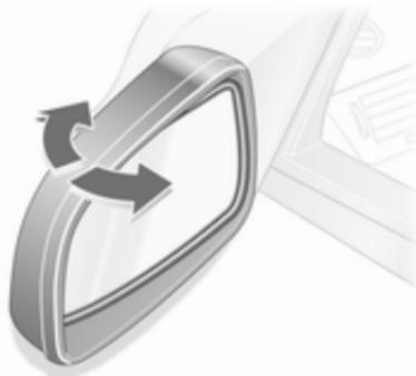
Zur Sicherheit von Fußgängern klappen die Außenspiegel bei Anstoßen aus ihrer Ausgangslage. Durch leichten Druck auf das Spiegelgehäuse wieder einrasten.
