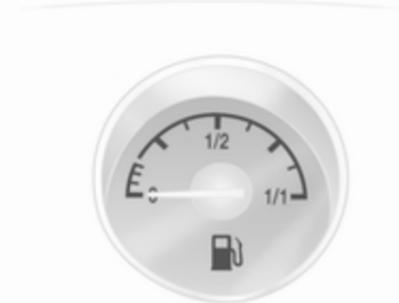
Anzeige des Kraftstofffüllstands im Tank je nach Betriebsart.
