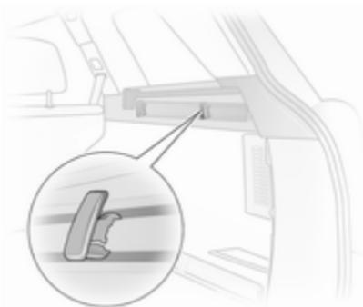
Beim Caravan Haken in gewünschter Position in Schienen einsetzen: Dazu Haken in obere Nut der Schiene einsetzen und in untere Nut drücken.
