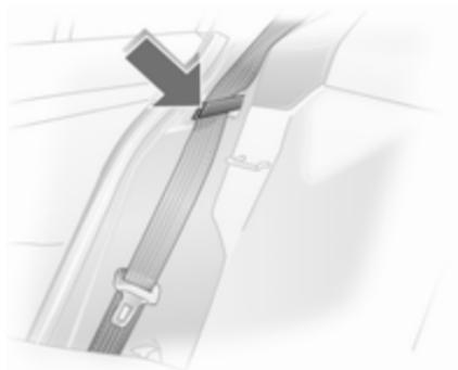
Zur Vermeidung von Beschädigungen die Sicherheitsgurte in die Führungen am Entriegelungsknopf einhängen. Beim Klappen der Sitzlehnen werden gleichzeitig die Sicherheitsgurte herausgezogen.
