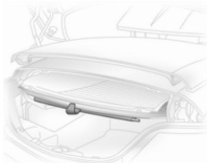
Beim TwinTop: Die Beladungshilfe Easy Load ermöglicht ein bequemes Beladen des Laderaums bei geöffnetem Dach. Das geklappte Dach im Gepäckraum lässt sich per Tastendruck um ca. 25 cm anheben. Dadurch wird die Beladungsöffnung des Laderaums vergrößert.
