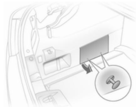
Zum Öffnen beide Knöpfe ziehen, Spreizclipse herausnehmen und Deckel nach oben klappen.
