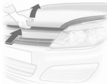
Sicherungsgriff hochdrücken und Motorhaube öffnen.
