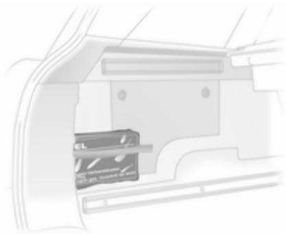
Verbandstasche an der linken Laderaumwand mit einem Haltegurt befestigen.
