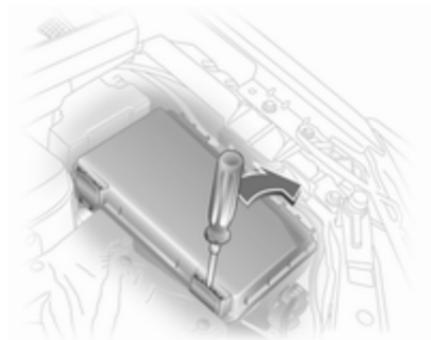
Schraubendreher bis zum Anschlag in Öffnungen stecken und zur Seite schwenken. Deckel nach oben klappen und abnehmen.
