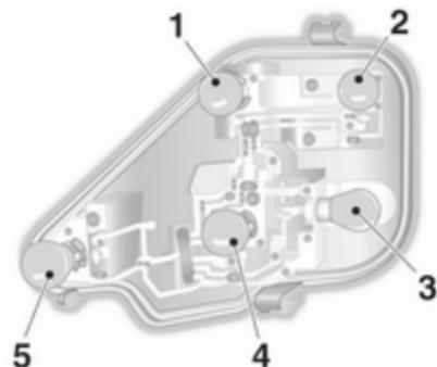
6. Glühlampe herausnehmen und neue Glühlampe einsetzen.
