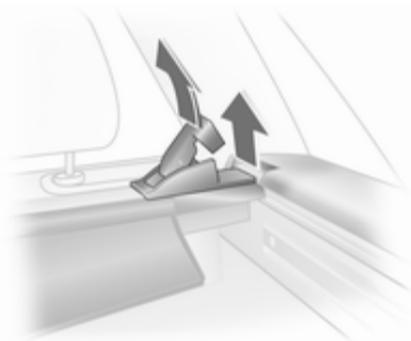
Laderaumabdeckung öffnen und Haken an Kopfstützen aushängen.
