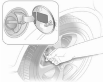
Ventilkappenschlüssel aus Tankklappe entnehmen und damit Ventilklappe abschrauben.
