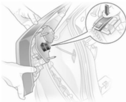
2. Lampengehäuse von außen abnehmen. Kabelstecker durch Druck auf die Klappe ausrasten und vom Lampenträger abziehen.
