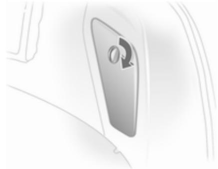
1. Zum Wechseln der Glühlampen auf der rechten Seite eine Münze verwenden, um die Verriegelung zu öffnen, und die Abdeckung herunterklappen.
