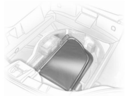
Ausbau in umgekehrter Reihenfolge, Windschott vollständig zusammengeklappt im Laderaum unterbringen:
