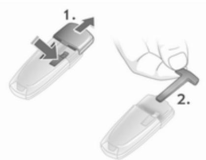
Lässt sich das Fahrzeug auch mit der Funkfernbedienung nicht entriegeln, kann die Fahrertür mit dem im elektronischen Schlüssel befindlichen Notschlüssel ver- bzw. entriegelt werden: Verriegelung drücken und die Abdeckkappe bei leichtem Druck abziehen. Notschlüssel über Rastung nach außen schieben und entnehmen.
