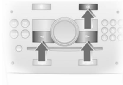
Wählen Sie Menüpunkte über Menüs und mit den Tasten auf dem Infotainmentsystem aus. Mit OK-Taste markierten Punkt auswählen oder einen Befehl bestätigen.
