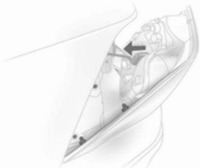
4. Rückleuchten zurückdrücken und dabei das Lampengehäuse von außen halten. Kabelstecker vom Lampenträger abziehen.
