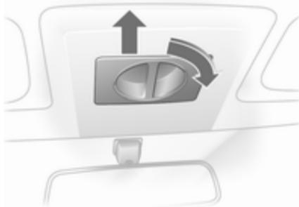
Dachverkleidung öffnen: Drehgriff nach rechts drehen und Dachverkleidung in beliebige Position nach hinten schieben.
