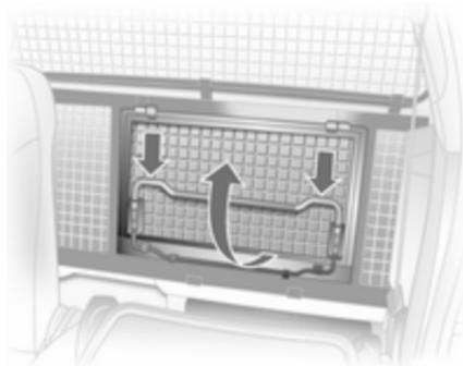
Für den Transport langer Gegenstände kann ein Teil des Laderaumgitters hinter dem Beifahrersitz geöffnet werden:
