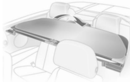
Das Windschott kann bei Nichtbedarf nach hinten geklappt werden.
