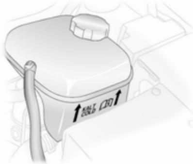
Bei kaltem Kühlsystem sollte der Kühlmittelstand gerade über der **KALT/COLD**-Markierung liegen. Bei zu niedrigem Füllstand auffüllen.
