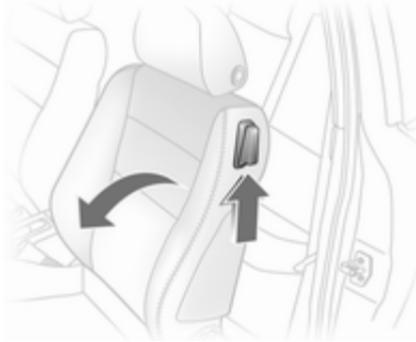
Entriegelungshebel anheben und Sitzlehne nach vorn klappen. Sitz nach vorn schieben.
