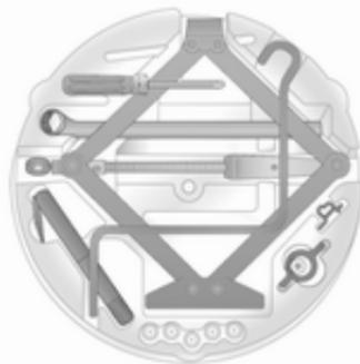
Wagenheber und Wagenwerkzeug befinden sich in einer Ablage im Laderaum unter dem Reserverad. Reserverad ↗ 205
