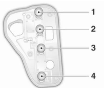
5. Glühlampe herausnehmen und neue Glühlampe einsetzen.
