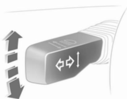
Hebel nach oben = Blinker rechts
