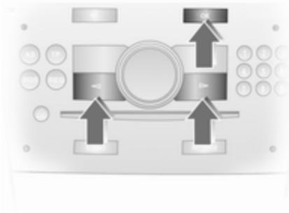
Im Menü **Settings** wird die gewünschte Funktion mit der OK-Taste aufgerufen. Mit den Pfeiltasten werden die Einstellungen geändert.
