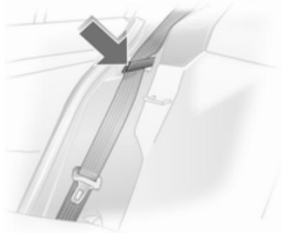
Vor dem Aufrichten der Sitzlehne den Sicherheitsgurt zum Schutz vor Beschädigung durch die Gurthalterungen führen.
