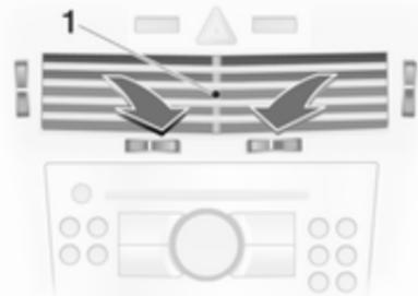
Zum Öffnen der Düse Rändelrad auf I drehen.
