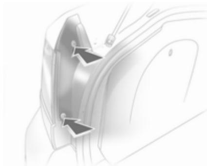
3. Die drei Schrauben mit einem Schraubendreher lösen und Lampenträger herausnehmen. Wagenwerkzeug ↻ 194.
