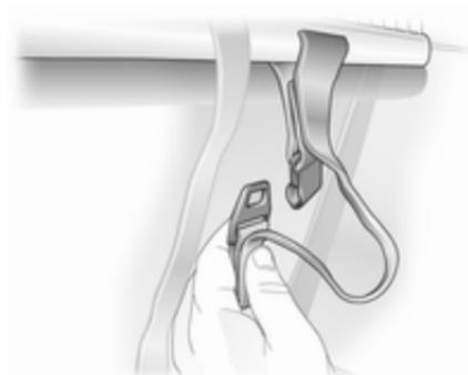
Längenversteller der Netzspanngurte hochkippen, Netzspanngurte aushängen. Stange des Sicherheitsnetzes aus Aufnahmen im Dachrahmen aushängen. Netz aufrollen und mit einem Band verzurren.
