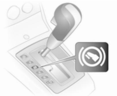
In den Stellungen **P** oder **N** leuchtet die Kontrollleuchte (☹) in der Wählhebelskala rot, wenn der Wählhebel gesperrt ist. Befindet sich der Wählhebel nach Ausschalten der Zündung nicht in Stellung **P**, blinken die Kontrollleuchte (☹) und **P** in der Wählhebelskala.
