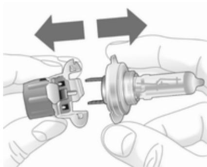
5. Lampenträger einsetzen, die beiden Nasen im Reflektor einrasten und zum Verriegeln nach rechts drehen.
