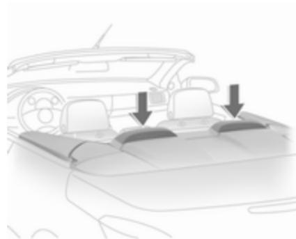
Ausfahrbare Überrollbügel sind zwischen den hinteren Kopfstützen und dem Laderaumdeckel integriert. Bei einem Überschlag, einem Frontalaufprall oder einem seitlichem Aufprall fahren die Überrollbügel innerhalb von Millisekunden nach oben. Sie lösen auch zusammen mit den Front- und Seiten-Airbag-Systemen aus.
