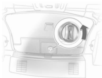
Von innen den Drehknopf auf der Innenseite des Laderaumdeckels entgegen dem Uhrzeigersinn drehen, der Laderaumdeckel wird entriegelt und öffnet sich ein wenig.
