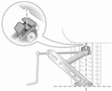
4. Wagenheber auf die erforderliche Höhe einstellen, bevor er direkt unter den Ansatzpunkt so positioniert wird, dass er nicht wegrutschen kann.
