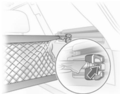
Jeweils einen Adapter in jede Schiene einsetzen: Griffplatte aufklappen, Adapter in obere und untere Nut der Schiene einsetzen, in gewünschte Position bringen. Griffplatte zum Arretieren des Adapters nach oben schwenken. Vor Einsetzen in die Adapter müssen die Stangen des Netzes verlängert werden: Alle Endstücke herausziehen und durch rechts Herumdrehen arretieren.
