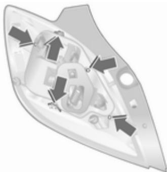
5. Die drei Schrauben mit einem Schraubendreher herausdrehen. Die Sperrungen an den Außen-seiten des Lampenträgers nach innen drücken und Lampenträger herausnehmen.
