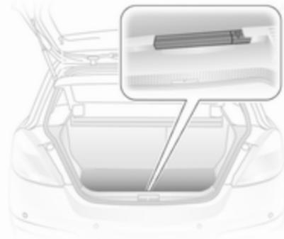
Warndreieck in der hinteren Laderaumwand unterbringen: Warndreieck zuerst links in Aussparung schieben und dann rechts in Führung stecken.
