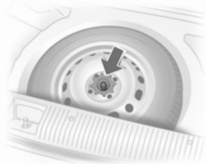
Das Reserverad befindet sich im Laderaum unter der Abdeckung des Laderaumbodens. Es ist mit einer Flügelmutter in der Vertiefung fixiert.
