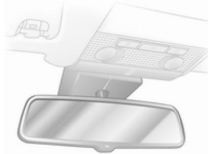
Bei Nacht wird die Blendwirkung durch nachfolgende Fahrzeuge automatisch reduziert.
