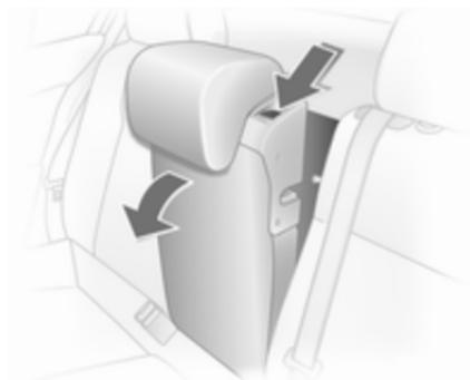
Kopfstütze so weit wie möglich nach unten schieben ⇨ 48. Sitzlehne mit Hebel ausrasten und auf Sitzfläche klappen. Hochgestellte Sitzfläche bis zum Einrasten vorklappen.
