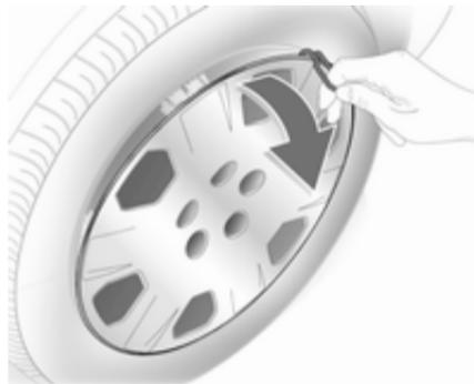
1. Radabdeckung mit dem Haken abziehen. Wagenwerkzeug ↪ 194.
