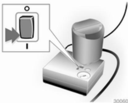
10. Wippschalter am Kompressor auf  $\text{I}$  stellen, der Reifen wird mit dem Dichtmittel gefüllt.
