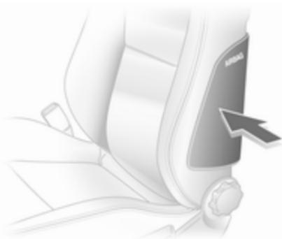
Das Seiten-Airbag-System besteht aus je einem Airbag in den Rückenlehnen der Vordersitze. Diese Stellen sind mit dem Wort **AIRBAG** gekennzeichnet.
