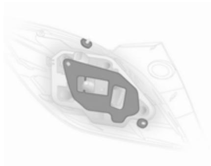
8. Sicherstellen, dass die Dichtungen am Lampenträger und an den Befestigungsschrauben ange-setzt sind.
