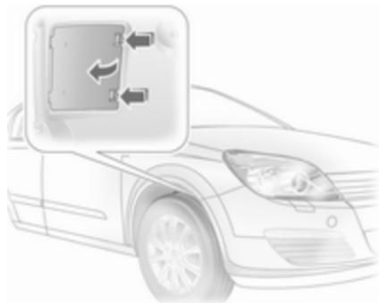
Der Lampenwechsel der vorderen äußeren Leuchten wird durch Öffnungen in den vorderen Radkästen
