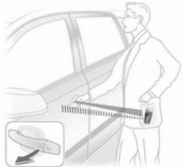
Bei Verwendung des elektronischen Schlüssels kann das Fahrzeug durch einfaches Ziehen am Türgriff entriegelt und die Tür geöffnet werden. Zum Öffnen der Hecktür Taste unter der Leiste drücken.
