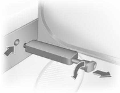
Drehknebel der Arretierstifte links und rechts ziehen und durch Verdrehen arretieren. Windschott ausrichten, Drehknebel zurückdrehen und Arretierstifte in die entsprechenden Aufnahmen der Seitenverkleidung einrasten lassen.
