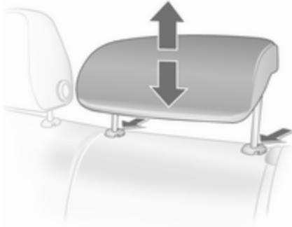
Kopfstütze nach oben ziehen bzw. die Rastfedern durch Drücken entriegeln und die Kopfstütze nach unten schieben.
