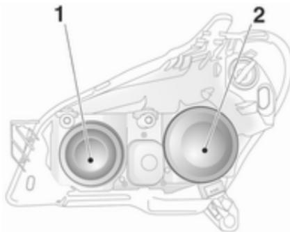
Scheinwerfer haben getrennte Systeme für Fernlicht **1** (innere Lampen) und Abblendlicht **2** (äußere Lampen).
