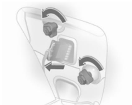
3. Befestigungsmuttern mit Radschraubensteckschlüssel lösen und von Hand abschrauben. Wagenwerkzeug ↗ 194.
