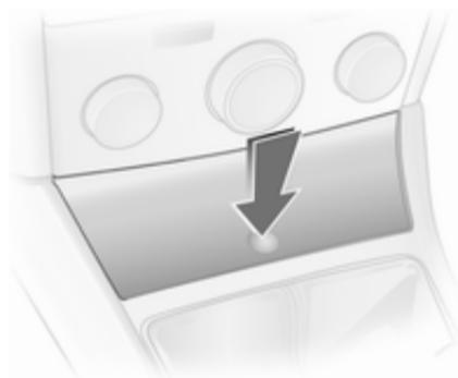
Der Zigarettenanzünder befindet sich hinter der Ascherabdeckung. Zum Öffnen Ascherabdeckung drücken.
