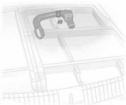
Bei der Limousine ist die Kugelstange in einem Beutel in der Cargo-Box des Laderaums mit einem Gurt befestigt. Beim Caravan ist die Kugelstange in einer Ablage in der Reserveradmulde im Laderaum mit einem Gurt befestigt.
