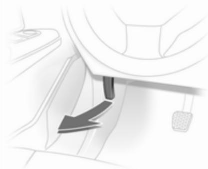
Entriegelungshebel ziehen und in die Ausgangsposition zurückführen.
