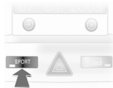
Das ESP®<sup>Plus</sup> kann ausgeschaltet werden, wenn der Sport-Modus für sportliches Fahren gewählt wird:
