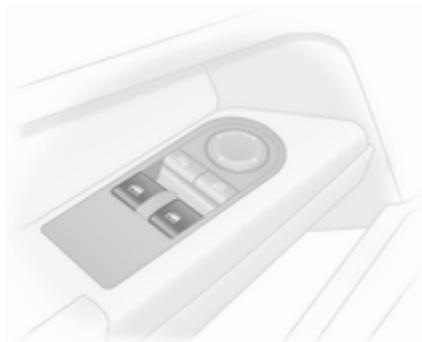
Zum Öffnen oder Schließen des Fensters Schalter betätigen.
