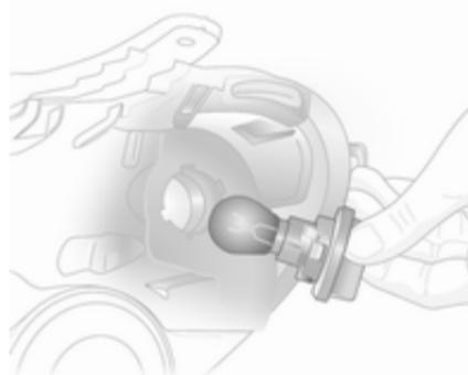
3. Glühlampe etwas in die Fassung hineindrücken, nach links drehen und herausnehmen. Neue Glühlampe einsetzen.
