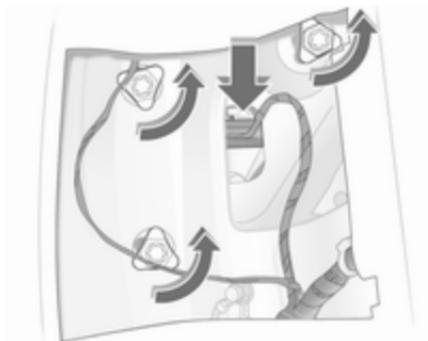
2. Kabelstecker vom Lampenträger abziehen.
