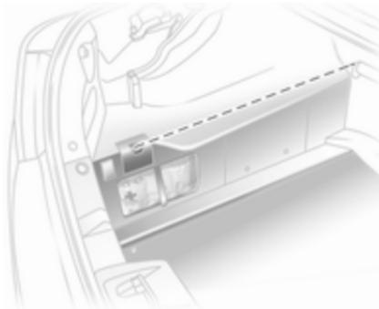
Das Dach darf nur geöffnet werden, wenn die Ladung im Laderaum weder die Höhe des Laderaumrollos überschreitet noch seitlich herausragt. Die Ladehöhe darf nicht überschritten werden. Das Laderaumrollo muss geradflächig sein, darunter befindliche Gegenstände dürfen es nicht nach oben drücken. Anderenfalls können Dach und Ladung beschädigt werden.
