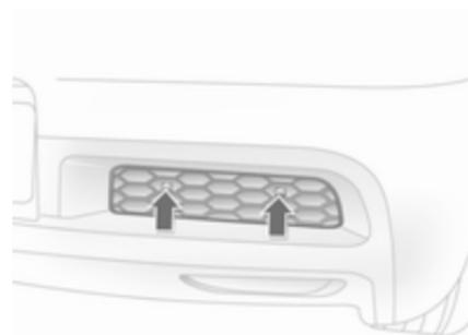
Bei anderen Modellen Rastungen nach unten ausrasten und Abdeckung von oben abziehen.
