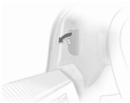
1. Zum Wechseln der Glühlampen die Abdeckung im Laderaum nach Drehen des Verschlusses hochklappen.
