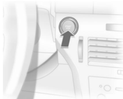
Taste **Start/Stop** drücken. Die Zündung schaltet sich ein. Elektronische Wegfahrsperrung und Lenksperre werden deaktiviert.
