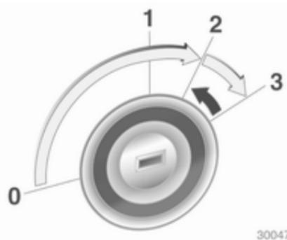
Kupplung und Bremse betätigen, Automatikgetriebe in **P** oder **N**, kein Gas geben, bei Dieselmotoren zum Vorglühen Schlüssel auf Position 2, bis Kontrollleuchte
