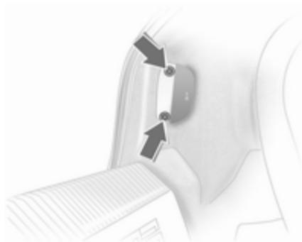
2. Die Schrauben hinter der Abdeckung mit einem normalen Schraubenschlüssel lösen und abnehmen.
