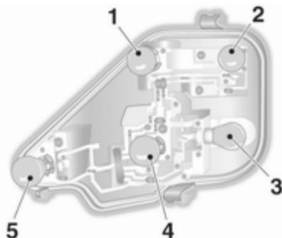
6. Glühlampe herausnehmen und neue Glühlampe einsetzen.
