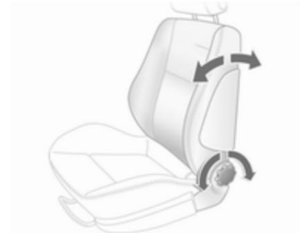
Handrad drehen. Zum Einstellen Rückenlehne entlasten.
