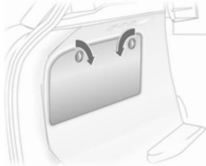
Der Sicherungskasten befindet sich hinter einer Abdeckung.
