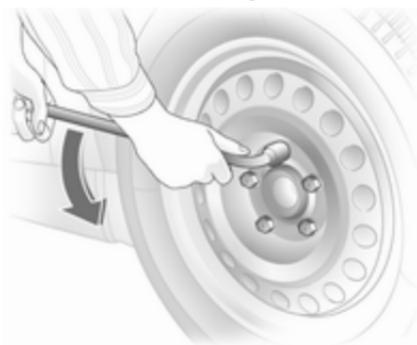
2. Radschraubenschlüssel ganz aufstecken. Jede Schraube eine halbe Umdrehung lösen.
