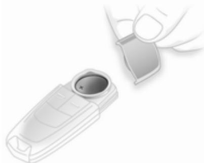
Zum Batteriewechsel Verriegelung drücken und die Abdeckkappe bei leichtem Druck abziehen. Die Abdeckkappe auf der anderen Seite nach außen drücken.
