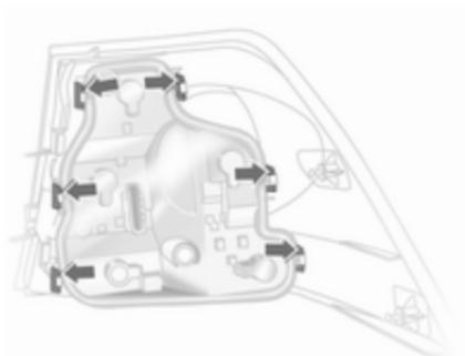
5. Sechs Verriegelungen am Lampengehäuse herausdrücken und Lampenträger herausnehmen.
