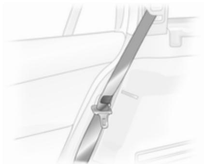
Vor dem Aufrichten der Sitzlehne den Sicherheitsgurt zum Schutz vor Beschädigung durch die Gurthalterungen führen. Entriegelungsknopf drücken und Rücksitzlehnen aufrichten, bis der Verriegelungsmechanismus hörbar einrastet.
