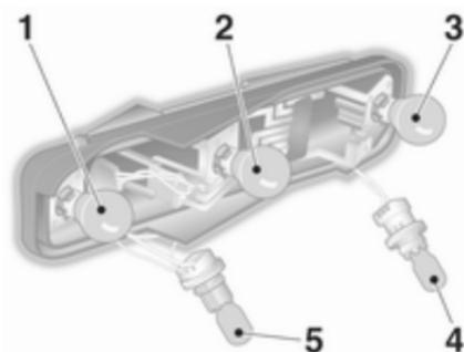
5. Glühlampe herausnehmen und neue Glühlampe einsetzen.
