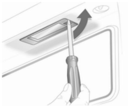
1. Einen Schraubendreher in das Gehäuse einstecken, zur Seite drücken und Feder entriegeln.
