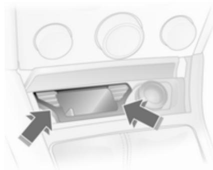
Zum Entleeren Aschereinsatz beidseitig fassen und nach oben herausziehen.
