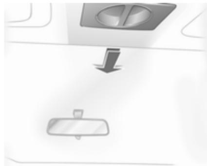
Dachverkleidung schließen: Dachverkleidung in gewünschte Position nach vorn schieben. In vorderster Stellung rastet die Dachverkleidung ein.
