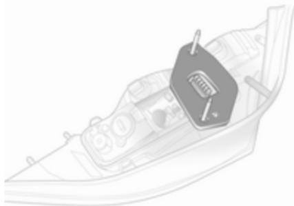
7. Dichtung am Lampenträger ansetzen. Sicherstellen, dass die Dichtung im Bereich um die Schrauben plan anliegt.
