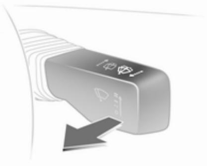
Hebel ziehen. Waschflüssigkeit spritzt auf die Windschutzscheibe und die Wischer werden für einige Wischbewegungen eingeschaltet.
