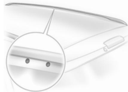
Zur Befestigung des Dachgepäckträgers Montagebolzen in die abgebildeten Bohrungen stecken.
