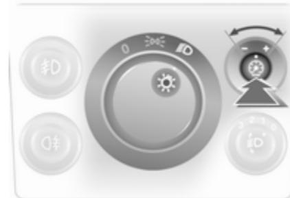
Helligkeit bei eingeschalteter Außenbeleuchtung einstellbar: Knopf
