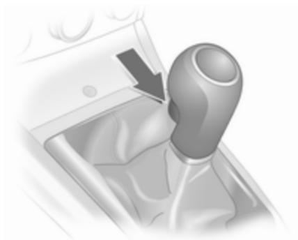
Rückwärtsgang: Nach Betätigung des Kupplungspedals bei stehendem Fahrzeug 3 Sekunden warten, anschließend Knopf auf dem Wählhebel nach oben ziehen und Gang einlegen.
