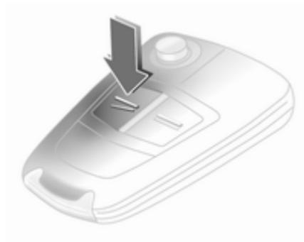
Zum Entriegeln und Öffnen der Tür Taste
