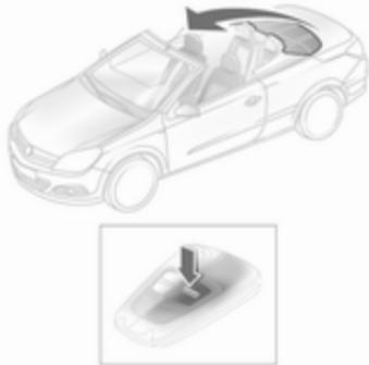
Stehendes Fahrzeug verriegeln. Taste
