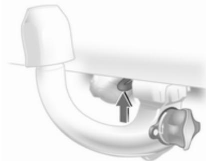
Kugelstange verriegeln, dazu Schlüssel in Position
