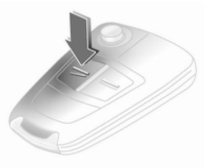
Wenn die Türen mit der Zentralverriegelung verriegelt sind, kann der Laderaumdeckel nicht mit der Taste
