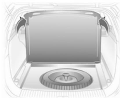
Adapter und Haken aus den Schienen in den Laderaumwänden nehmen. Hintere Verzurrösen hochstellen und Bodenabdeckung bis zur Senkrechten anheben, so dass sie an der Dachinnenverkleidung stehen bleibt. Beim Zurückklappen die Verzurrösen durch die Schlitze in der Bodenabdeckung führen. Fahrzeuge mit Cargo-Box: Ausbau ↪ 77.
