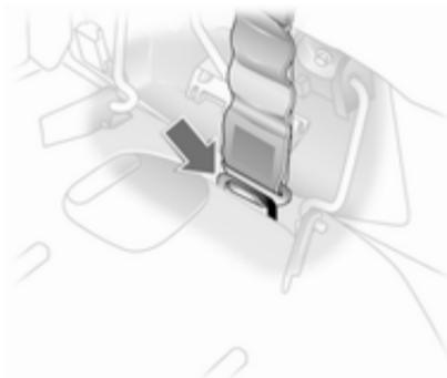
Länge der Gurte des Sicherheitsnetzes durch Einhängen des oberen Hakens in die Öse des Gurts einstellen und in Ösen im Boden rechts und links einhängen.
