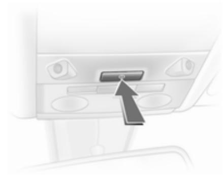
Die Überwachung des Fahrzeuginnenraums und der Fahrzeugneigung ausschalten, wenn Personen oder Tiere im Fahrzeug bleiben, da durch Bewegung verursachte Ultraschallsignale die Alarmanlage auslösen. Auch auf Fähren oder Zügen ausschalten.
