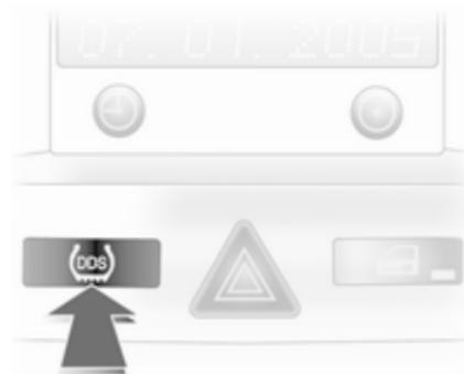
Nach einem Radwechsel muss das System initialisiert werden: Reifen mit dem vorgeschriebenen Reifendruck füllen, Zündung einschalten, Taste **DDS** für ca. 4 Sekunden drücken, Kontrollleuchte (⚠) blinkt dreimal.
