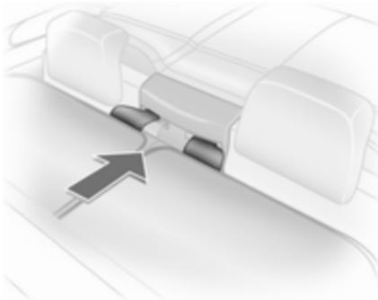
Windschott mit den Führungslaschen in die Aufnahmen der Sicherheitsgurte zwischen den hinteren Kopfstützen einsetzen.
