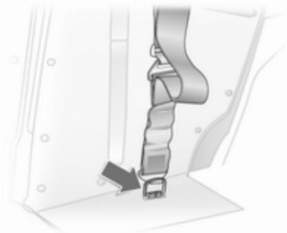
Länge der Gurte des Sicherheitsnetzes durch Einhängen des oberen Hakens in die Öse des Gurts einstellen und in Ösen im Boden rechts und links einhängen.
