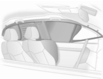
Der aufgeblähte Airbag dämpft den Aufprall, wodurch die Verletzungsgefahr für den Kopf bei einem Seitenaufprall deutlich verringert wird.
