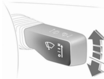
Der Hebel kehrt immer in die Ausgangsposition zurück.
