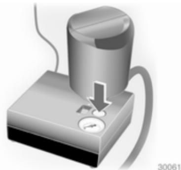
13. Der vorgeschriebene Reifendruck sollte innerhalb von 10 Minuten erreicht werden. Reifendruck  $\varnothing$  248. Kompressor bei Erreichen des korrekten Drucks abschalten. Wird der vorgeschriebene Reifendruck nicht innerhalb von 10 Minuten erreicht, Reifenreparaturset entfernen. Das Fahrzeug um eine Reifenumdrehung bewegen. Das Reifenreparaturset wieder anschließen und Füllvorgang
