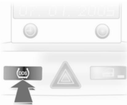
Nach Korrektur des Reifendrucks oder nach einem Radwechsel muss das System initialisiert werden: Zündung einschalten, Taste **DDS** für ca. 4 Sekunden drücken, Kontrollleuchte
