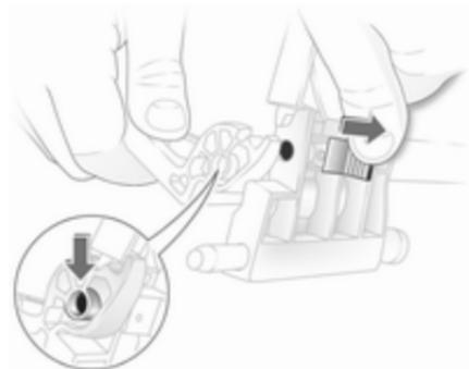
Auseinandergeklappte Enden des Windschotts zusammenfügen: Stift an Schieber nach innen drücken, Rastgelenk über Stift führen und Schieber loslassen, so dass der Stift durch das Rastgelenk führt.
