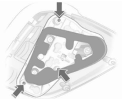
4. Die drei Schrauben mit einem Schraubendreher lösen und Lampenträger herausnehmen. Wagenwerkzeug ↗ 194.
