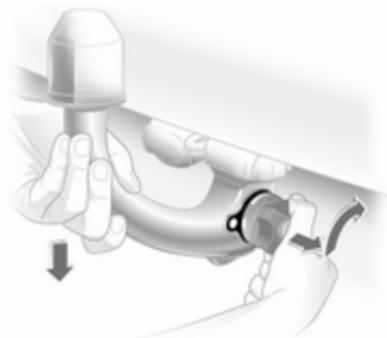
Schutzlasche öffnen und zum Entriegeln der Kugelstange Schlüssel in Position
