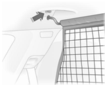
Im Dachrahmen sind je zwei Montageöffnungen: Stange des Netzes auf einer Seite einhängen und einrasten,
