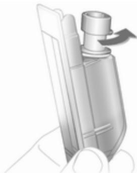
4. Lampenträger nach links drehen und ausrasten.
