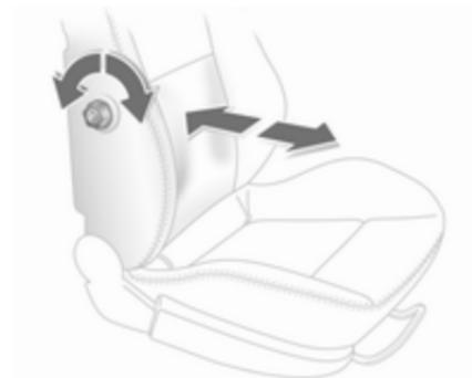
Handrad drehen. Zum Einstellen Rückenlehne entlasten.
