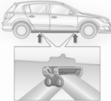
3. Sicherstellen, dass der Wagenheber an den Aufnahmen richtig ausgerichtet ist.
