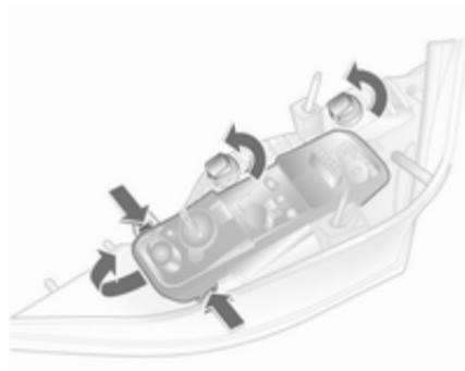
4. Einzelfassungen durch Drehen ausrasten und herausnehmen. Sperrungen an den Längsseiten des Lampenträgers nach außen drücken und Lampenträger an der Stirnseite anheben und herausnehmen.
