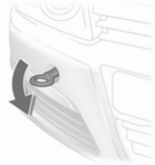
Abschleppöse bis zum Anschlag in waagerechter Stellung einschrauben.
