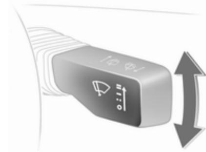
Wischintervall auf einen Wert zwischen 2 und 15 Sekunden einstellen: Zündung einschalten, Hebel aus Position ○ nach unten bewegen, gewünschte Intervallzeit abwarten, Hebel auf -- anheben.
