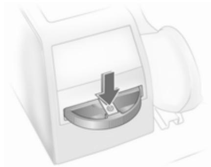
Zum Entleeren Feder drücken und Ascher gerade nach hinten herausziehen.
