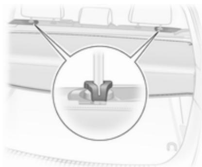
Zur Abdeckung des Spalts zwischen Laderaumabdeckung und hinteren Sitzlehnen befindet sich an der Kassette eine Abdeckung. Beide Haken an der Abdeckung in Führungsstangen der Kopfstützen einhängen. Bei montiertem Sicherheitsnetz Haken durch Maschen des Netzes führen.
