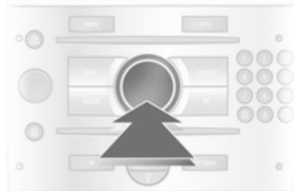
Zum Markieren von Menüpunkten oder Befehlen und zur Auswahl von Funktionsbereichen Multifunktionsknopf drehen.
