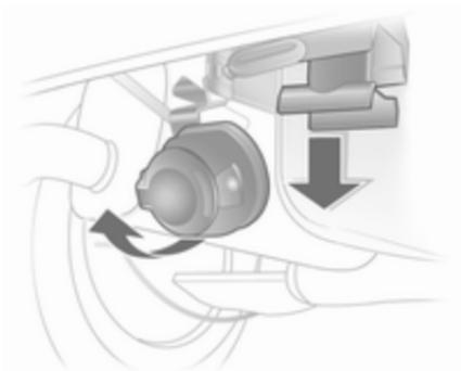
Steckdose herunterklappen. Verschlussstopfen aus der Aufnahmeöffnung für die Kugelstange ziehen und im Laderaum unterbringen.
