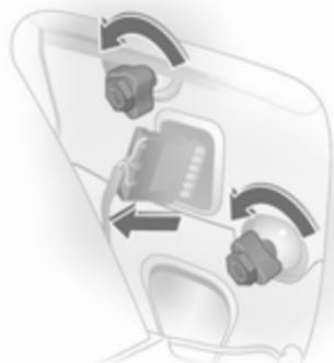
3. Befestigungsmuttern mit Radschraubensteckschlüssel lösen und von Hand abschrauben. Wagenwerkzeug ↗ 194.
