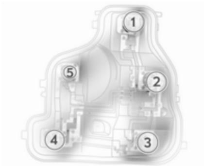
6. Glühlampe herausnehmen und neue Glühlampe einsetzen.
