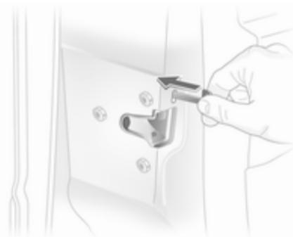
Schlüssel oder Notschlüssel  $\varnothing 22$  in die Öffnung oberhalb des Schlosses auf der Innenseite der Tür stecken und zum Verriegeln so lange drücken, bis es im Schloss klickt. Dann die Tür schließen. Dieser Vorgang muss für jede Tür wiederholt werden. Die Fahrertür kann auch von außen mit dem Schlüssel verriegelt werden. Tankklappe und Hecktür/Laderaumdeckel können nicht verriegelt werden.
