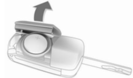
Schlüsselbart ausklappen und die Funkfernbedienung öffnen. Batterie austauschen (Batterietyp CR 2032).
