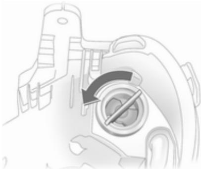
2. Lampenträger nach links drehen und ausrasten.
