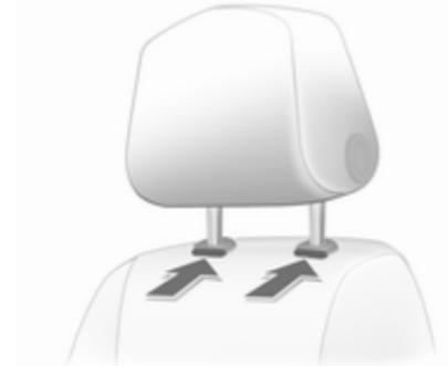
Auf die Rastfedern drücken und die Kopfstütze nach oben ziehen.
