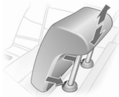
Kopfstütze nach oben ziehen bzw. beide Rastfedern zum Entriegeln drücken und die Kopfstütze dann nach unten schieben.
