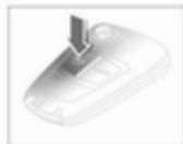
Stehendes Fahrzeug entriegeln. Taste
