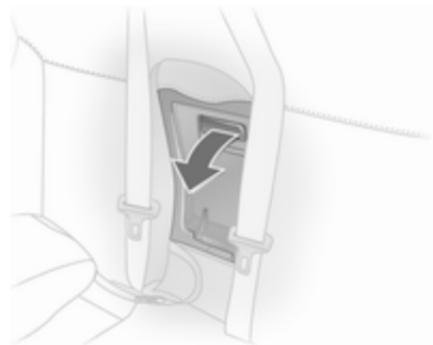
Armlehne an Schlaufe herausziehen. Die Armlehne ist mit einem Halteband an der Sitzlehne befestigt. Zum vollständigen Ausbau der Armlehne Halteband an Halteband ausrasten.
