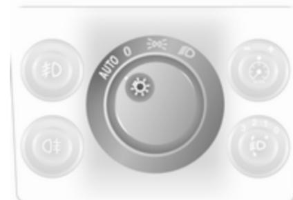
Lichtschalter auf **AUTO**: Bei laufendem Motor werden die Scheinwerfer abhängig von den äußeren Lichtverhältnissen eingeschaltet.
