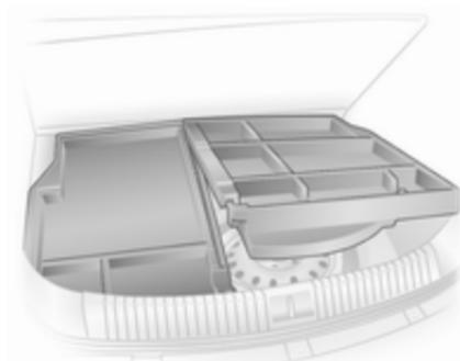
Klappbare Box unter der Bodenabdeckung zur Unterteilung des Laderaums.
