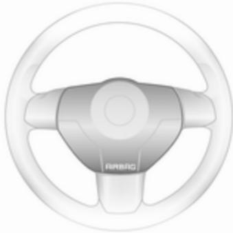
Das Front-Airbag-System besteht aus einem Airbag im Lenkrad und einem in der Instrumententafel auf der Beifahrerseite. Diese Stellen sind mit dem Wort **AIRBAG** gekennzeichnet.
