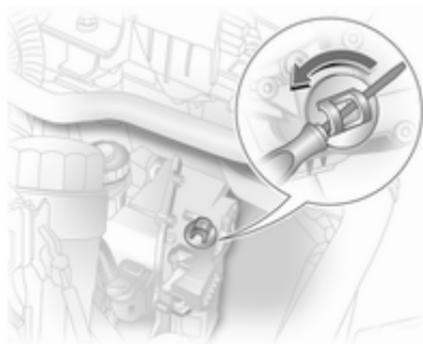
Muss das Fahrzeug aus dem fließenden Verkehr entfernt werden, Kupplung wie folgt lösen (nur bei Fahrzeugen mit automatisiertem 5-Gang-Schaltgetriebe):
