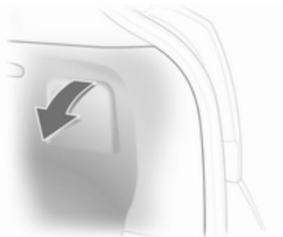
1. Zum Lampenwechsel Deckel nach unten klappen.
