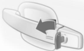
Mit dem Notschlüssel kann nur die Fahrertür verriegelt und entriegelt werden. Gesamtes Fahrzeug entriegeln ↷ 25. Bei Fahrzeugen mit Diebstahlwarnanlage kann es vorkommen, dass der Alarm beim Entriegeln des Fahrzeugs ausgelöst wird. Zur Deaktivierung Zündung einschalten.
