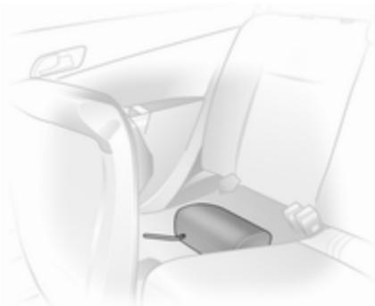
Hintere äußere Kopfstützen ausbauen, mittlere Kopfstütze ganz nach unten schieben ⇨ 48. Ausgebaute Kopfstützen in der Mulde unter den hochgestellten Sitzflächen verstauen.
