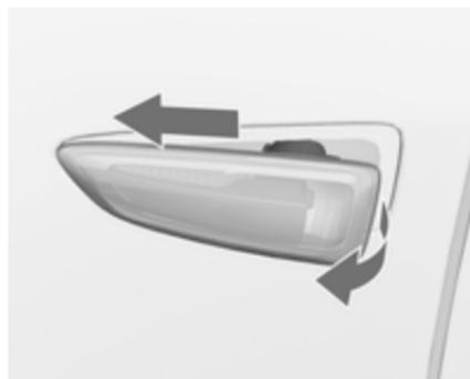
1. Auf der linken Fahrzeugseite die Lampe nach vorne schieben und mit dem hinteren Ende aus dem vorderen Flügel entnehmen.
