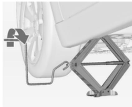
Wagenhebergriff anbringen und bei korrekt ausgerichtetem Wagenheber am Griff drehen, bis das Rad nicht mehr den Boden berührt.
