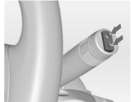
Zur Betätigung des Heckscheibenwischers Wippschalter drücken:
