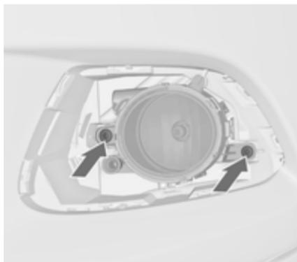
2. Beide Schrauben ausdrehen und den Leuchtenzusammenbau vom Stoßfänger abnehmen.
