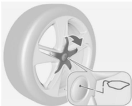
Leichtmetallräder mit Radzierkappen in der Mitte: Radzierkappe lösen. Dazu Abzieher in die Aussparung des Markenemblems stecken und daran ziehen. Wagenwerkzeug ⇨ 270.
