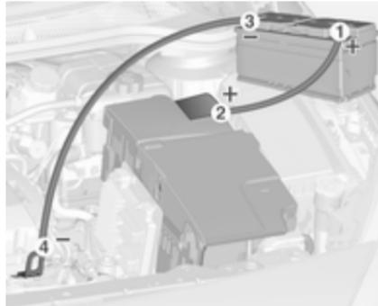
Reihenfolge für das Anschließen der Kabel:
