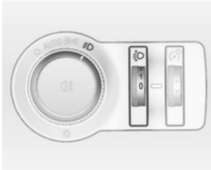
Zur Anpassung der Leuchtweite an die Fahrzeuglast, um Blendwirkung zu reduzieren: Daumenrädchen
