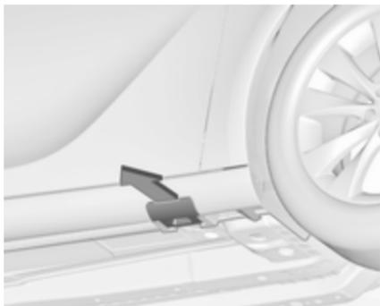
Einige Fahrzeuge verfügen über Schwellerverkleidungen mit abgedeckten Ansatzpunkten für den Wagenheber. Ziehen Sie zuerst die Abdeckung des entsprechenden Ansatzpunkts ab.
