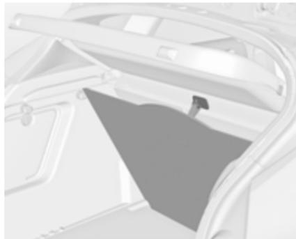
Die hintere Bodenabdeckung kann angehoben werden. Schlaufe in den Haken auf der Unterseite der Laderaumabdeckung einhängen.
