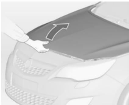
Verschlusshaken nach rechts ziehen und Motorhaube öffnen.
