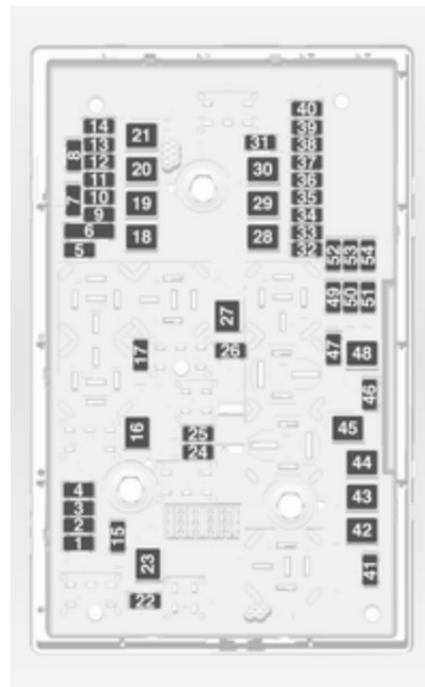
Sicherungszieher von oben oder seitlich auf die verschiedenen Ausführungen von Sicherungen stecken und Sicherung herausziehen.
