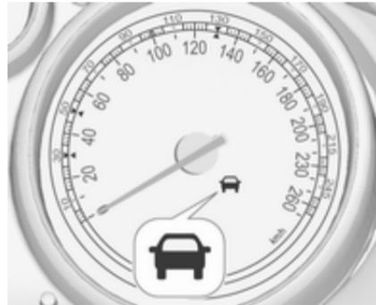
Wenn das System ein vorausfahrendes Fahrzeug in der Fahrspur erkennt, leuchtet die Anzeige für ein erkanntes vorausfahrendes Fahrzeug
