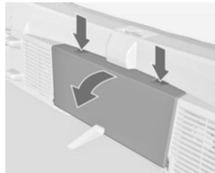
2. Nur Schrägheck, 3-türig: Hinteres Ablagefach durch Drücken beider Tasten entfernen. Abdeckung nach unten klappen und Stauraum nach oben ausfahren.
