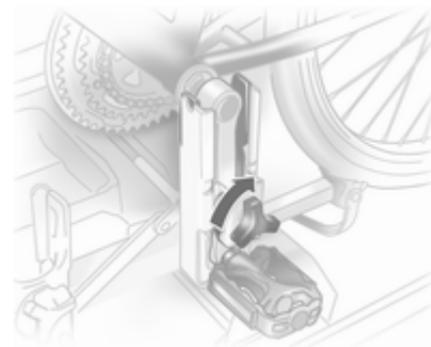
Die Tretkurbel durch Drehen der Klemmschraube an der Tretkurbelfixierung festklemmen.
