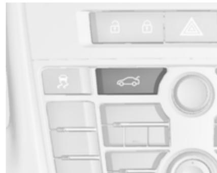
Wenn die Türen über die Zentralverriegelung verriegelt sind, kann der Laderaumdeckel nicht über die Taste
