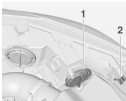
**Bi-Halogen-Scheinwerfer (1)** mit einer Lampe für Ablend- und Fernlicht
