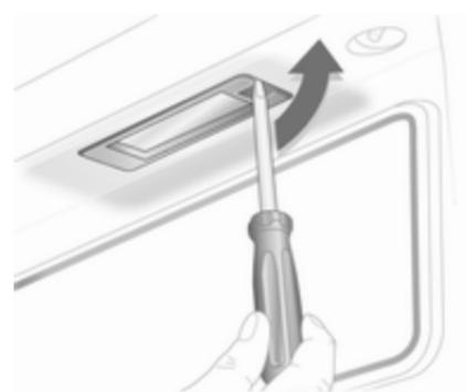
1. Schraubendreher in die Aussparung der Abdeckung einführen, zur Seite drücken und die Feder lösen.
