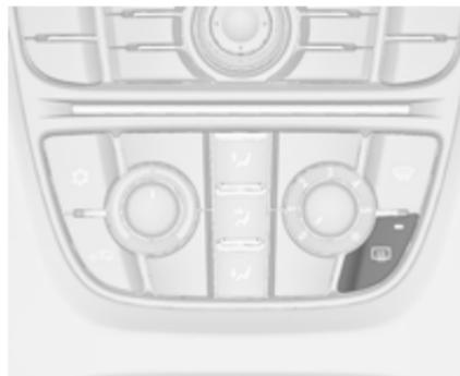
Die Heizung wird durch Drücken der Taste
