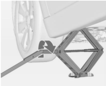
8. Radschlüssel ansetzen und den korrekt ausgerichteten Wagenheber hochkurbeln, bis das Rad vom Boden abhebt.
