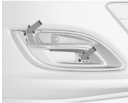
2. Beide Schrauben ausdrehen und den Leuchtenschaubau vom Stoßfänger abnehmen.
