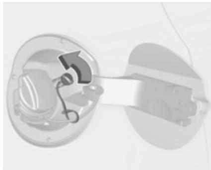
Die Schutzkappe vom Einfüllstutzen abschrauben.
