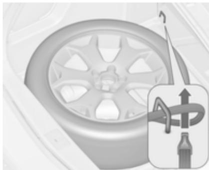
2. Das Schlaufenende des Gurtes durch die vordere Zurröse an der entsprechenden Seite führen.
