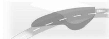
Der Lichtstrahl wird auf Basis des Lenkwinkels und der Geschwindigkeit geschwenkt, was die Ausleuchtung von Kurven verbessert.
