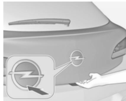
Zum Entriegeln und Öffnen der Hecktür Taste
