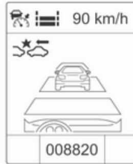
Taste **MENU** am Blinkerhebel drücken und mit dem Daumenrad die Seite des adaptiven Geschwindigkeitsreglers auswählen, um diese Seite im Fahrerinformationszentrum anzuzeigen.
