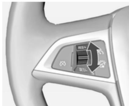
Bei aktiviertem Geschwindigkeitsbegrenzer das Daumenrad auf Position **RES/+** gedreht halten oder wiederholt auf Position **RES/+** drehen, bis die
