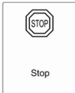
Die vom System vorgeschlagene Parklücke wird angenommen, wenn der Fahrer das Fahrzeug maximal 10 Meter nach Anzeige der Stoppmeldung anhält. Das System berechnet die optimale Route in die Parklücke. Dann führt es den Fahrer durch detaillierte Anweisungen in die Lücke.
