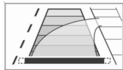
Die Fahrzeugsur wird entsprechend des Lenkwinkels angezeigt.
