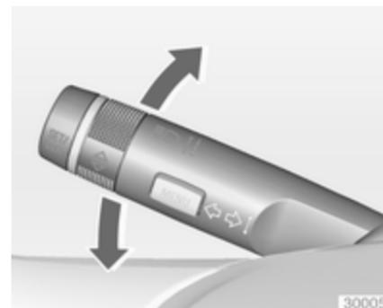
Hebel nach oben = Blinker rechts
