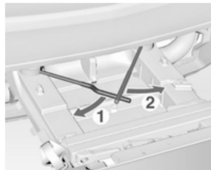
Zuerst den linken Spannhelme (1), danach den rechten Spannhelme (2) bis zum Anschlag schwenken.
