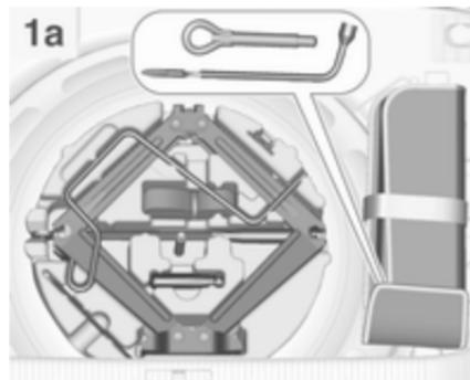
Wagenheber, Wagenwerkzeug und ein Gurt zur Befestigung eines beschädigten Rades befinden sich im Werkzeugkasten unter dem Reserverad im Laderaum. Der Radschlüssel und die Abschleppöse befinden sich in der Werkzeutasche, die in der Nähe des Werkzeugkastens in der Reserveradaufnahme verstaut ist. Reserverad ⇨ 284.
