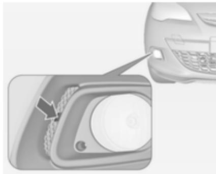
1. Mit einem Schraubendreher in die Aussparung fahren, Abdeckung lösen und abnehmen.
