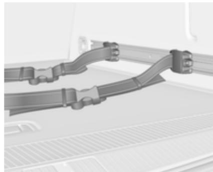
Die Adapter des Gurtsatzes in eine Schiene einsetzen. Darauf achten, dass der Gurt nicht verdreht ist.
