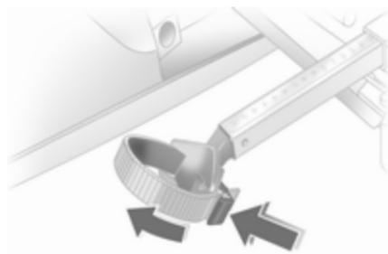
Den Entriegelungshebel am Spannband drücken und das Spannband herausziehen.
