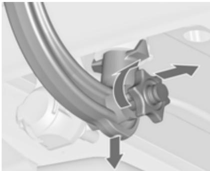
Die Schutzklappe öffnen und zum Entriegeln der Kugelstange den Schlüssel in Position
