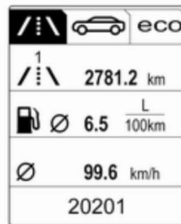
Im Uplevel-Kombi-Display werden die Menüseiten durch Drücken der Taste **MENU** ausgewählt. In der obersten Zeile des Displays werden die Menüsymbole angezeigt:
