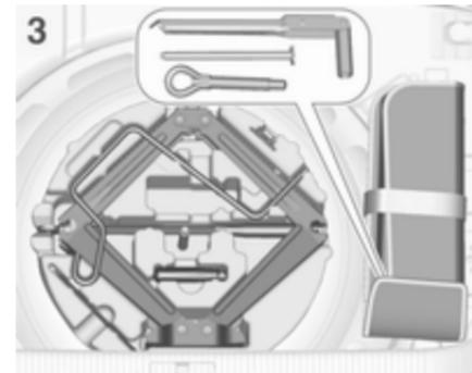
Der Wagenheber und das Wagenwerkzeug befinden sich im Werkzeugkasten unter dem Reserverad im Laderaum. Der Radschlüssel, die Abschleppöse und der Verlängerungsbolzen zum Befestigen eines beschädigten Rads (nur Fahrzeuge mit Not-Reserverad) befinden sich in der Werkzeutasche, die in der Nähe des Werkzeugkastens in der Reserveradaufnahme verstaut ist. Reserverad
