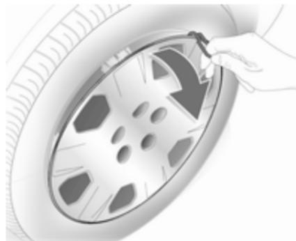
1. Radmutternkappen mit Schraubendreher lösen und abnehmen. Radabdeckung mit dem Haken abziehen. Wagenwerkzeug ↷ 270.
