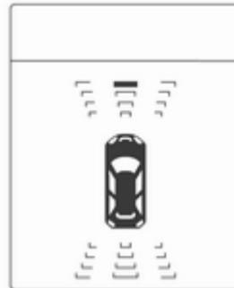
Bei Ausführungen mit Uplevel-Kombi-Display zeigen wechselnde Segmente den Abstand zu Hindernissen vor und hinter dem Fahrzeug an.
