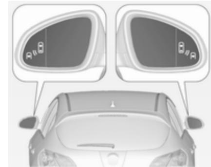
Die Funktion „Toter-Winkel-Warnung“ ist bei Geschwindigkeiten zwischen 10 km/h und 140 km/h aktiv. Bei Geschwindigkeiten über 140 km/h wird das System deaktiviert; dies wird in beiden Außenspiegeln durch die Warnsymbole  $\text{A}^{\text{B}}$  angezeigt. Wird die Geschwindigkeit erneut reduziert, erlöschen die Warnsymbole. Wird daraufhin ein Fahrzeug im toten Winkel erkannt, leuchten die Warnsymbole  $\text{A}^{\text{B}}$  wie üblich auf der entsprechenden Seite auf.
