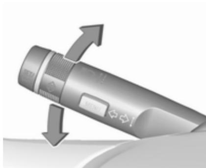
Hebel nach oben : Blinker rechts
