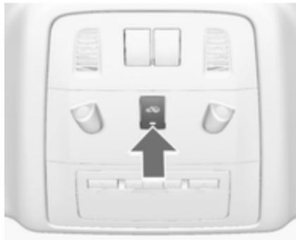
Die Überwachung der Fahrgastzelle und der Fahrzeugneigung abschalten, wenn Haustiere im Fahrzeug zurückbleiben, da der Alarm durch laute Ultraschallsignale oder Bewegungen ausgelöst werden kann. Auch ausschalten, wenn das Fahrzeug auf einer Fähre oder einem Zug transportiert wird.
