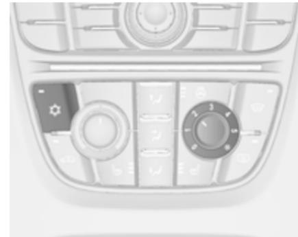
drücken, um die Kühlung einzuschalten. Die Aktivierung wird durch das Leuchten der LED in der Taste angezeigt. Die Kühlung ist nur bei laufendem Motor und eingeschaltetem Gebläse der Klimatisierung funktionsfähig.
