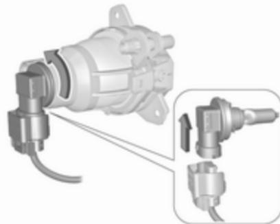
4. Die Lampenfassung linksherum drehen und aus dem Reflektor herausnehmen.
