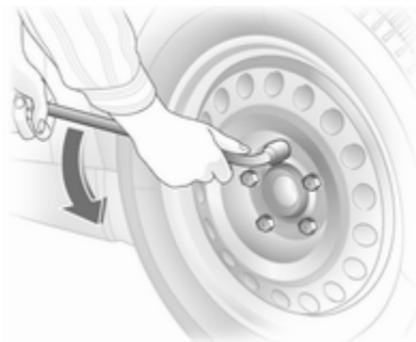
Radschraubenschlüssel ansetzen und sicherstellen, dass er gut sitzt. Jede Radmutter um eine halbe Drehung lösen.
