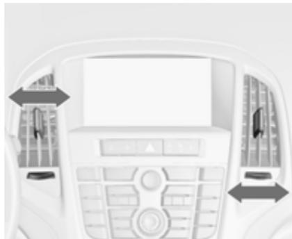
Zum Öffnen der Düse das Einstellrädchen zum größeren Symbol
