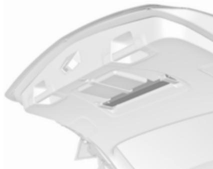
Haltegurte. Warndreieck in der Aussparung hinter den Befestigungsgurten an der Innenseite der Hecktür aufbewahren.
