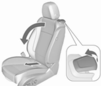
Entriegelungshebel anheben und Sitzlehne nach vorn klappen. Der Sitz wird automatisch bis zum Anschlag nach vorne verschoben.
