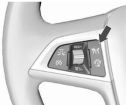
Zum Einschalten des adaptiven Geschwindigkeitsreglers
