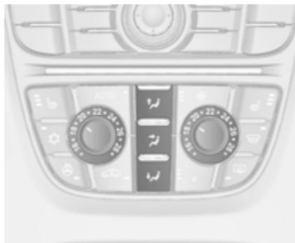
Entsprechende Taste für die gewünschte Einstellung drücken. Die Aktivierung wird durch das Leuchten der LED in der Taste angezeigt.
