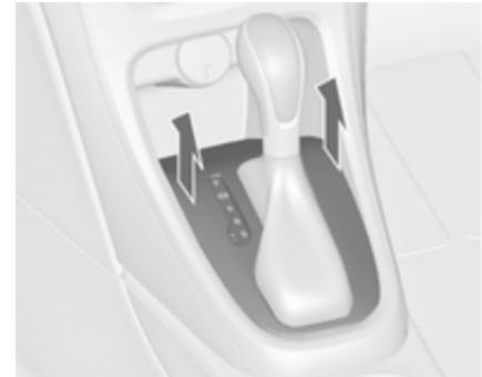
2. Die Wählhebelverkleidung vorn von der Mittelkonsole lösen, nach oben klappen und linksherum drehen.
