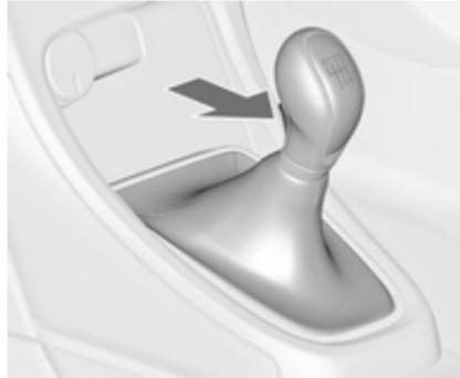
Rückwärtsgang: Bei stehendem Fahrzeug das Kupplungspedal treten, den Entriegelungsknopf am Wählhebel drücken und Gang einlegen.
