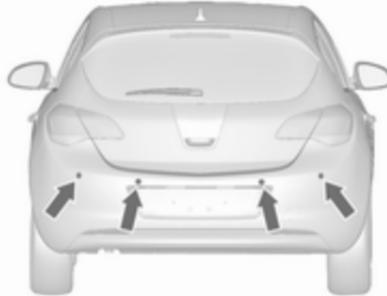
Das System besteht aus vier Ultraschall-Parksensoren im hinteren Stoßfänger.
