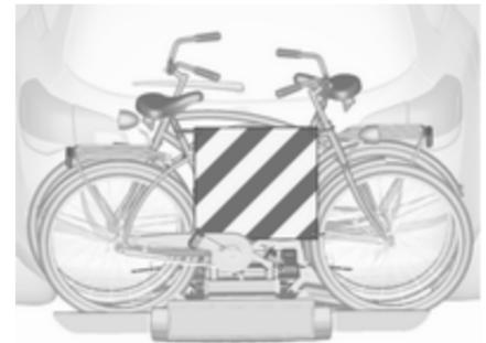
Für bessere Sichtbarkeit sollte am hintersten Fahrrad ein Warnschild angebracht werden.
