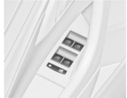
Zur Deaktivierung der elektrischen Fensterbetätigung der Hintertüren
