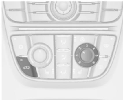
Zum Einschalten des Umluftbetriebs
