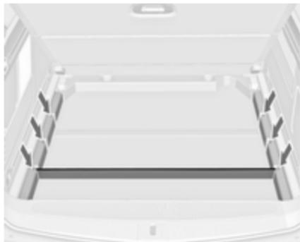
Die Stange in die Aufnahmen an den Seitenwänden einsetzen.
