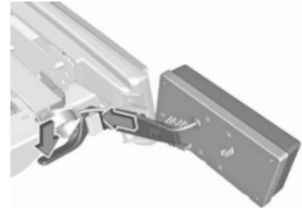
Den Spannhebel nach unten drücken und den Lampenträger in die Halterung drücken, bis er einrastet.
