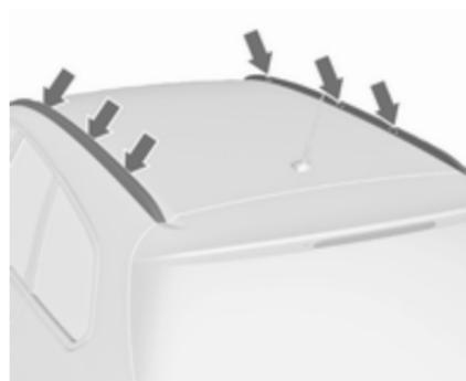
Den Dachgepäckträger im Bereich der Löcher, die in der Abbildung mit Pfeilen gekennzeichnet sind, befestigen.
