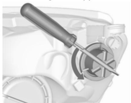
1. Die Kappe (3) linksherum drehen und abnehmen. Den Schraubendreher zum Drehen der Kappe verwenden.
