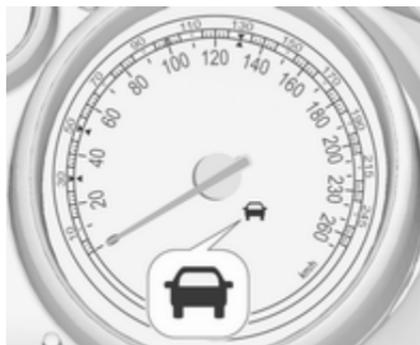
Wenn das System ein vorausfahrendes Fahrzeug in der Fahrspur erkannt hat, leuchtet die Kontrollleuchte für ein erkanntes vorausfahrendes Fahrzeug
