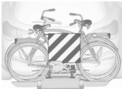
Für bessere Sichtbarkeit sollte am hintersten Fahrrad ein Warnschild angebracht werden.
