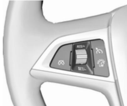
☺ drücken. Wenn zuvor der Geschwindigkeitsregler oder der adaptive Geschwindigkeitsregler aktiviert wurde, wird dieser beim Aktivieren des Geschwindigkeitsbegrenzers ausgeschaltet. Die Kontrollleuchte ☺ erlischt.
