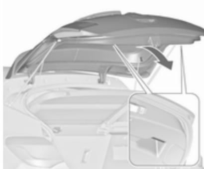
Einen der Innengriffe verwenden. Während die Hecktür zugeklappt wird, weder den Touchpad-Schalter noch das Emblem drücken, da sonst die Hecktür erneut entriegelt wird. Zentralverriegelung
