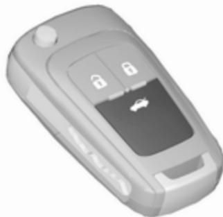
Durch Drücken auf
