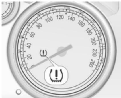
Wenn niedriger Reifendruck erkannt wird, wird dies durch die Kontrollleuchte (⚠) gemeldet ⇨ 122.
