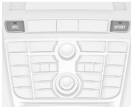
Das Fahrsystem OPC Flex Ride ermöglicht es dem Fahrer, zwischen drei Fahrmodi zu wählen:
