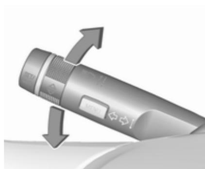
Hebel nach oben : Blinker rechts
