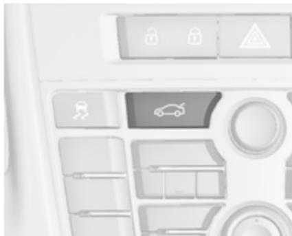
Wenn die Türen über die Zentralverriegelung verriegelt sind, kann der Kofferraumdeckel nicht durch Drücken auf
