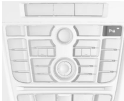
Die Front-Heck-Einparkhilfe wird mit **P** betätigt. Wenn das Fahrzeug zusätzlich mit der erweiterten Einparkhilfe ausgestattet ist (siehe nachfolgende Beschreibung), enthält das System **P**. Beide Systeme werden durch **P** betrieben.
