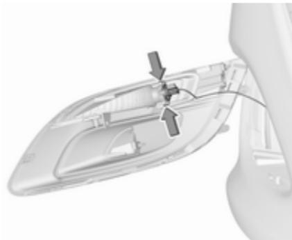
3. Die Lampenfassung durch Drücken der beiden Haltenasen vom Reflektor lösen.
