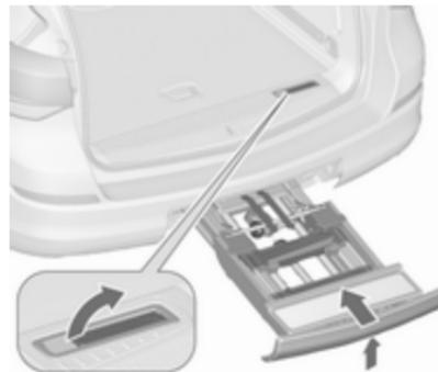
Entriegelungshebel nach oben drücken und halten. Das System etwas anheben und bis zum Einrasten in den Stoßfänger drücken.
