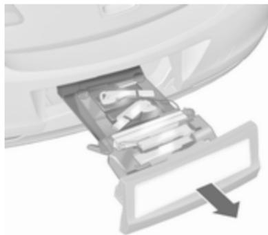
Das Heckträgersystem vollständig bis zum hörbaren Einrasten herausziehen.
