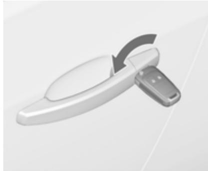
Fahrtür durch Drehen des Schlüssels im Schloss manuell entriegeln. Zündung einschalten und Zentralverriegelungstaste
