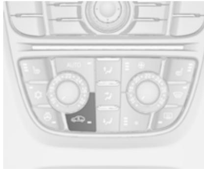
Zum Einschalten des Umluftbetriebs
