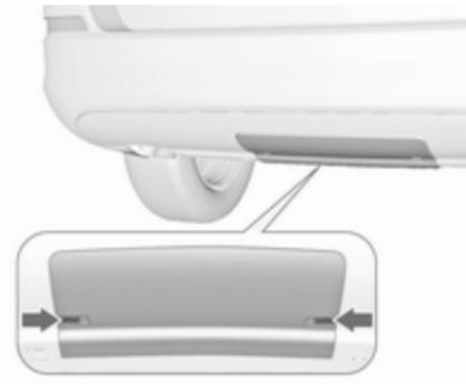
Alle Ausführungen außer Schrägheck, 3-türig: Befestigungen nach innen drücken und Abdeckung vorne nach unten klappen. Abdeckung abnehmen.
