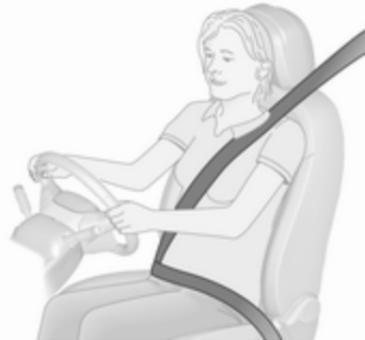
Bei starker Beschleunigung oder Verzögerung des Fahrzeugs blockieren die Sicherheitsgurte, um die Insassen in Sitzposition zu halten. Dadurch wird die Verletzungsgefahr deutlich verringert.
