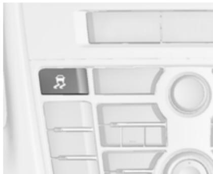
Die Traktionskontrolle kann ausgeschaltet werden, wenn ein Durchdrehen der Antriebsräder erwünscht ist:
