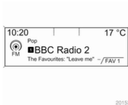
Ein Temperaturabfall wird sofort angezeigt, ein Temperaturanstieg mit Verzögerung.
