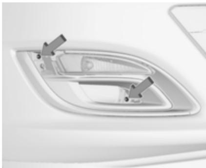
2. Beide Schrauben ausdrehen und den Leuchtensammenbau vom Stoßfänger abnehmen.
