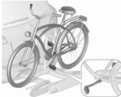
1. Die Pedale in die abgebildete Position drehen und das Fahrrad auf der vordersten Radaufnahme platzieren.
