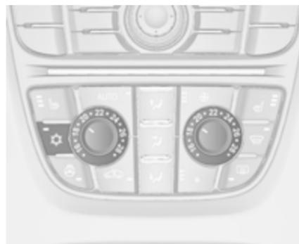
☼ drücken, um die Kühlung einzuschalten. Die Aktivierung wird durch das Leuchten der LED in der Taste angezeigt. Die Kühlung ist nur bei laufendem Motor und eingeschaltetem Gebläse der Klimatisierung funktionsfähig.
