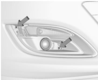
2. Beide Schrauben ausdrehen und den Blinkerleuchtensammenbau vom Stoßfänger abnehmen.
