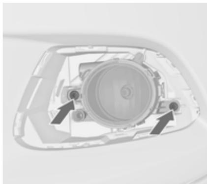
2. Beide Schrauben ausdrehen und den Leuchtensammenbau vom Stoßfänger abnehmen.
