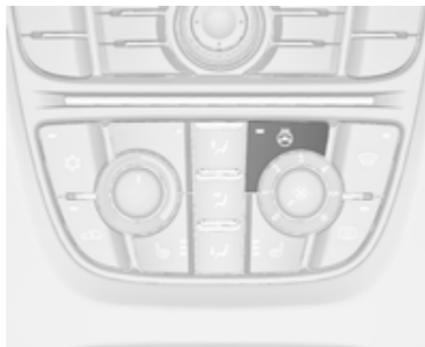
Die Heizung durch Drücken von ☀ einschalten. Die Aktivierung wird durch das Leuchten der LED in der Taste angezeigt.
