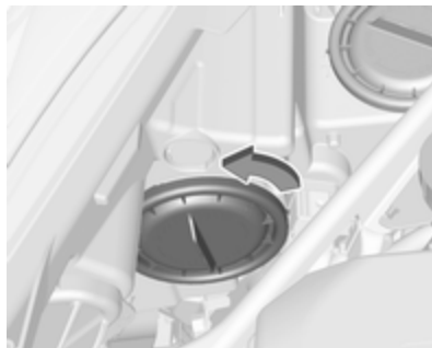
Abblendlicht (1), äußere Lampe. Fernlicht (2), innere Lampe.
