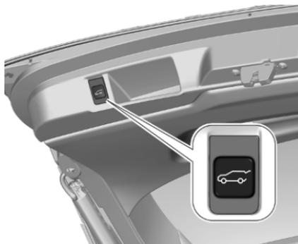
Zum Schließen auf
