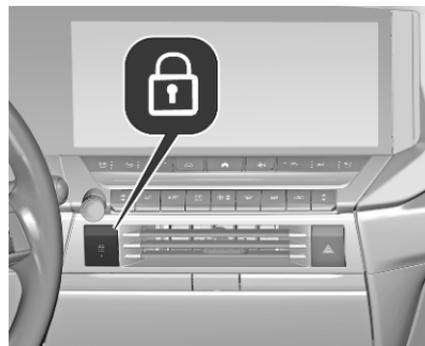
Zum Verriegeln auf
