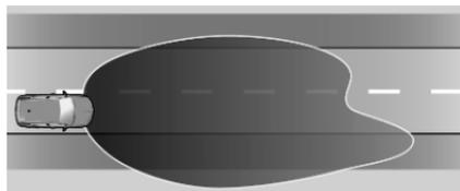
Wird beim Fahren auf Landstraßen abhängig von der Fahrzeuggeschwindigkeit automatisch aktiviert. Die Ausleuchtung der eigenen Fahrbahn und des Fahrbahnrandes wird angepasst. Entgegenkommende und vorausfahrende Fahrzeuge werden nicht geblendet.
