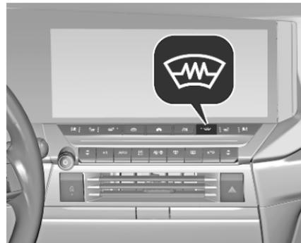
Betätigung durch Berühren von
