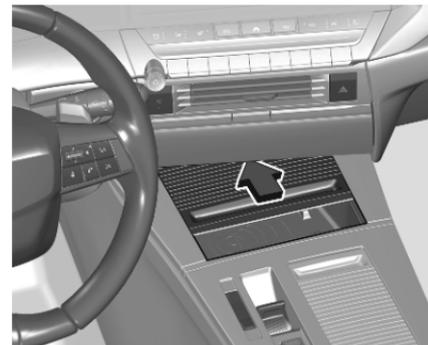
Unterhalb der Instrumententafel befindet sich ein Ablagefach mit induktivem Ladegerät.
