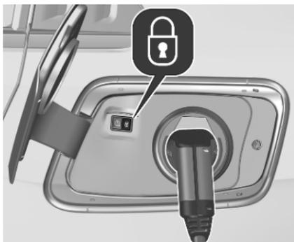
Nach dem Beginn des Ladevorgangs wird der Fahrzeugstecker am Ladeanschluss verriegelt und kann während des aktiven Ladens nicht getrennt werden.
