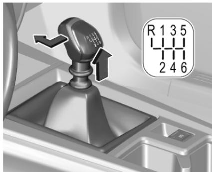
Zum Einlegen des Rückwärtsgangs bei stehendem Fahrzeug und Motor im Leerlauf das Kupplungspedal drücken, den Ring unter dem Wählhebel ziehen und den Gang einlegen.
