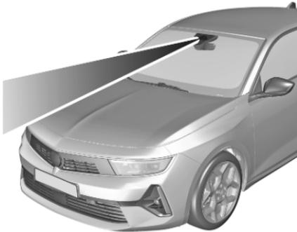
Das aktivierte System beobachtet mithilfe einer Kamera oben an der Windschutzscheibe die Spurmarkierungen. Das System lenkt das Fahrzeug in der erkannten Fahrspur. Der Fahrer spürt dabei, wie sich das Lenkrad dreht.
