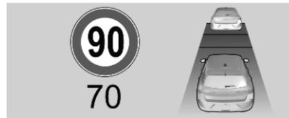
Wenn das System ein Fahrzeug in Fahrtrichtung erkennt, ändert sich der Bildschirm des adaptiven Geschwindigkeitsreglers entsprechend.
