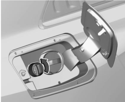
4. Die Schutzkappe vom Einfüllstutzen abschrauben.
