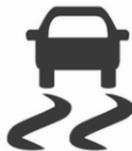
Die elektronische Stabilitätsregelung und die Traktionskontrolle sind nach jedem Motorstart funktionsfähig, sobald die Kontrollleuchte
