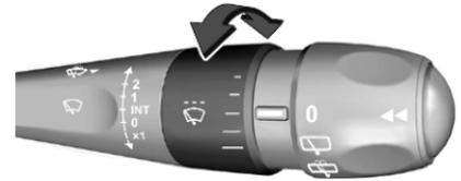
Bei Wischerhebel in Position **INT** kann durch Drehen des Rings eine von fünf Intervallstufen ausgewählt werden.
