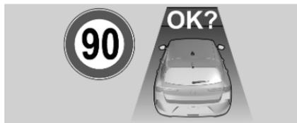
**OK** drücken, um die aktuelle Fahrzeuggeschwindigkeit zu speichern und den Geschwindigkeitsregler zu aktivieren. Auf dem Bildschirm des adaptiven Geschwindigkeitsreglers werden die eingestellte Geschwindigkeit
