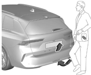
Zum Öffnen oder Schließen der Heckklappe den Fuß im Bereich unter dem Heckstoßfänger, der in der Abbildung gezeigt ist, hin und her bewegen. Bei Fahrzeugen mit Einparkhilfe wird der Bereich unter dem gezeigten Sensor erkannt. Den Fuß nicht zu lange unter dem Heckstoßfänger halten und nicht zu langsam bewegen. Der elektronische Schlüssel muss sich außerhalb des Fahrzeugs in einem Umkreis von ca. 1 m um die Heckklappe befinden.
