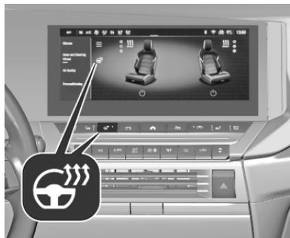
Die Heizung durch Drücken von
