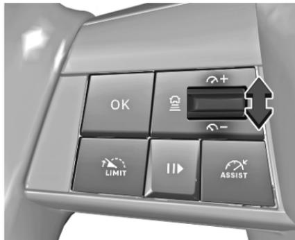
Die eingestellte Geschwindigkeit kann durch Bewegen des Daumenrädchens auf  $\curvearrowright$ + erhöht bzw. auf  $\curvearrowleft$ - gesenkt werden. Daumenrädchen mehrmals kurz schieben, um die Geschwindigkeit in kleinen Schritten zu ändern, länger schieben, um sie in großen Schritten zu ändern.
