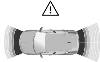
Je näher das Fahrzeug dem Hindernis in Fahrtrichtung kommt, desto kürzer das Intervall zwischen den Tönen. Bei einem Abstand unter ca. 30 cm wird ein Dauersignal ausgegeben.
