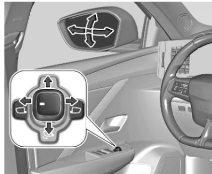
Zum Auswählen eines Außenspiegels die Markierung am Knopf zum gewünschten Außenspiegel drehen.
