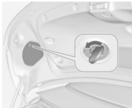
1. Die Abdeckung an der Innenseite des Kofferraumdeckels öffnen und entfernen, indem Sie die Schraube mit einer Münze lösen.
