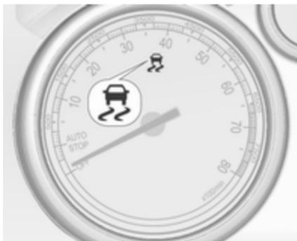
Die Traktionskontrolle ist nach jedem Motorstart funktionsfähig, sobald die Kontrollleuchte
