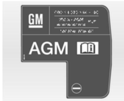
AGM-Batterien sind am entsprechenden Batterieschild zu erkennen. Wir empfehlen den Einsatz einer original Opel-Fahrzeugbatterie.
