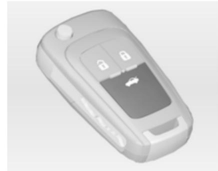
Durch Drücken der Taste
