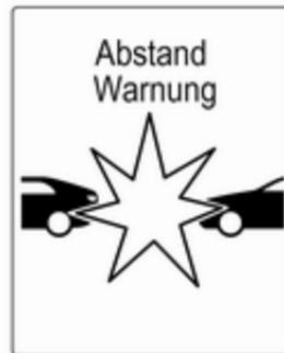
Beim zu schnellen Heranfahren an ein vorausfahrendes Fahrzeug wird die Auffahrwarnungsmeldung im Driver Information Center angezeigt. Gleichzeitig ertönt ein Signalton. Betätigen sie das Bremspedal, wenn es die Situation erfordert.
