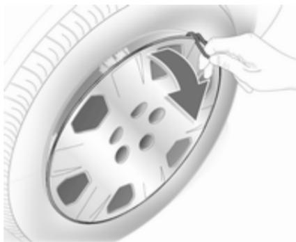
1. Radmutternkappen mit Schraubendreher lösen und abnehmen. Radabdeckung mit dem Haken abziehen. Wagenwerkzeug ⇨ 213.
