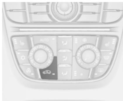
Zum Einschalten des Umluftbetriebs Taste
