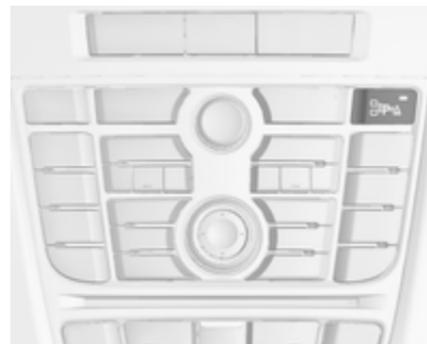
Beim Vorwärtsfahren mit langsamer Geschwindigkeit kann die Front-Einparkhilfe auch durch kurzes Drücken der Einparkhilfe-Taste **P**▲ oder **P**▲□ aktiviert werden.
