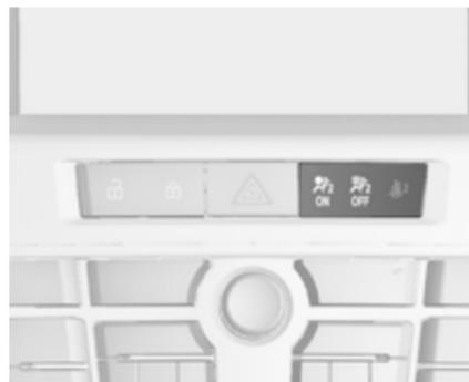
Wenn die Kontrollleuchte
