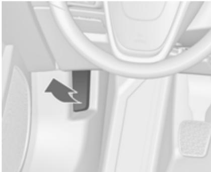
Entriegelungshebel ziehen und in die Ausgangsposition zurückführen.
