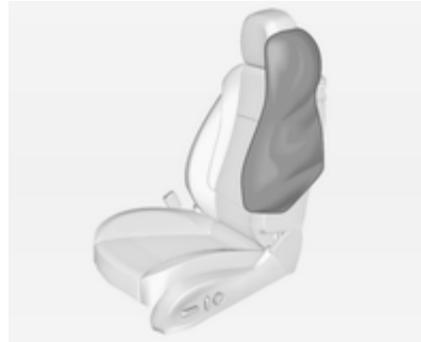
Der aufgeblähte Airbag dämpft den Aufprall, wodurch die Verletzungsgefahr für Kopf und Oberkörper bei einem Seitenaufprall deutlich verringert wird.
