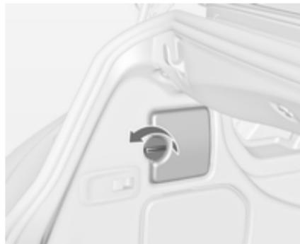
2. Abdeckung in Seitenverkleidung lösen und herausnehmen.
