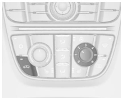
Zum Einschalten des Umluftbetriebs Taste
