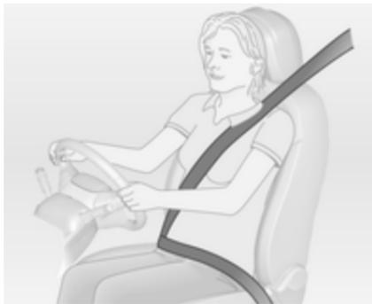
Bei starker Beschleunigung oder Verzögerung des Fahrzeugs blockieren die Sicherheitsgurte, um die Insassen in Sitzposition zu halten. Dadurch wird die Verletzungsgefahr deutlich verringert.
