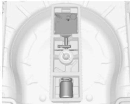
Wagenwerkzeug und die Abschleppöse sind zusammen mit dem Reifenreparaturset in einem Werkzeugkasten untergebracht, der sich unter der Bodenabdeckung im Laderaum befindet.
