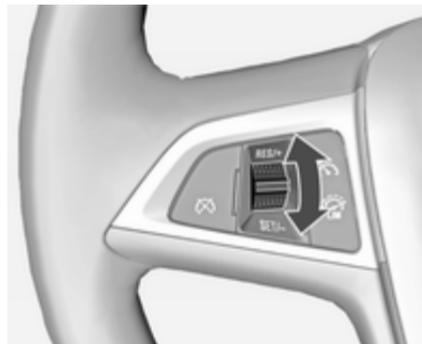
Bei aktiviertem Geschwindigkeitsbegrenzer das Daumenrad auf Position **RES/+** gedreht halten oder wiederholt auf Position **RES/+** drehen, bis die gewünschte Höchstgeschwindigkeit im Driver Information Center angezeigt wird.
