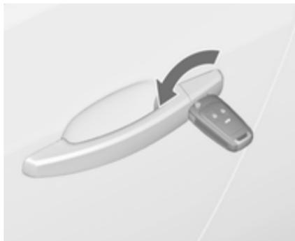
Die Fahrertür durch Drehen des Schlüssels im Schloss von Hand entriegeln. Zündung einschalten und Zentralverriegelungstaste
