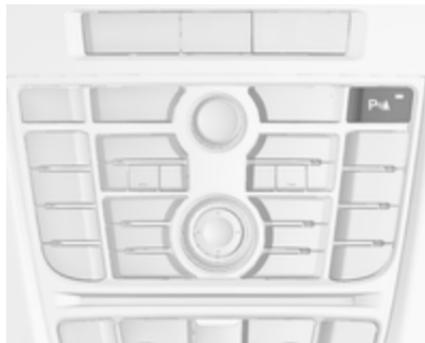
Die Front-Heck-Einparkhilfe wird mit der Taste **P**▲ betätigt. Wenn das Fahrzeug zusätzlich mit der erweiterten Einparkhilfe ausgestattet ist (siehe nachfolgende Beschreibung), umfasst das System die Taste **P**▲□. In diesem Fall werden beide Systeme über die Taste **P**▲□ bedient.
