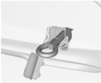
Abschleppöse gegen den Uhrzeigersinn bis zum Anschlag und mit waagerechter Endposition einschrauben.
