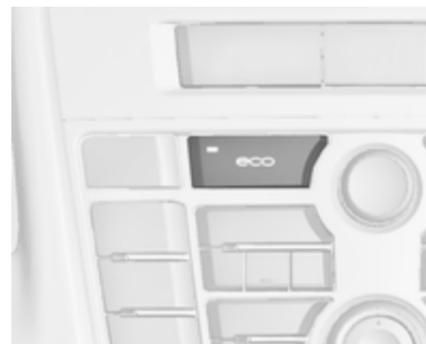
Die Stopp-Start-Automatik lässt sich durch Drücken der Taste **eco** manuell deaktivieren. Die Deaktivierung wird durch das Erlöschen der LED in der Taste angezeigt.
