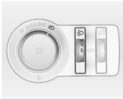
Zur Anpassung der Leuchtweite an die Fahrzeugbeladung, um Blendwirkung zu reduzieren: Daumenrad
