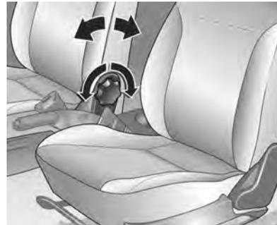
Handrad drehen. Zum Einstellen Rückenlehne entlasten.
