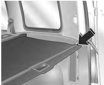
Abdeckung am Griff nach hinten ziehen und seitlich in Halterungen einhängen.
