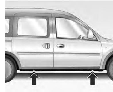
4. Wagenheber auf die erforderliche Höhe einstellen, bevor er direkt unter den Ansatzpunkt so positioniert wird, dass er nicht wegrutschen kann. Wagenheberarm so ansetzen, dass die Wagenheberklaue den senkrechten Steg in der Aussparung umfasst.
