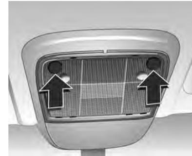
Betätigung mit Taste bei eingeschalteter Zündung.
