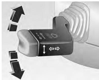
Hebel nach oben = Blinker rechts
