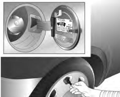
Reifendruck ↻ 155 und auf dem Aufkleber an der Innenseite der Tankklappe.
