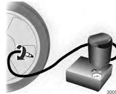
7. Den Schlauch zum Aufpumpen des Reifens an das Ventil schrauben.
