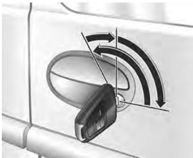
Schlüssel aus der Senkrechten oder Waagerechten gegen den Uhrzeigersinn soweit wie möglich über den Widerstand hinaus drehen und am Griff der Flügeltür ziehen. Zum Schutz gegen Aussperren lässt sich der Schlüssel in dieser Stellung nicht abziehen.
