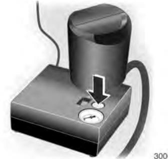
Wird der vorgeschriebene Reifendruck nicht innerhalb von 10 Minuten erreicht, das Reifenreparaturset entfernen. Das Fahrzeug um eine Reifenumdrehung bewegen. Das Reifenreparaturset wieder anschließen und den Füllvorgang für 10 Minuten fortsetzen. Wird der vorgeschriebene Reifendruck danach immer noch nicht erreicht, ist der Reifen zu stark beschädigt. Hilfe einer Werkstatt in Anspruch nehmen.
