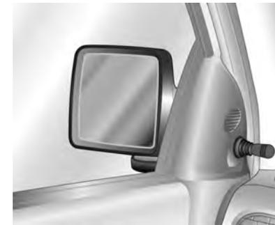
Spiegel durch Schwenken des Hebels in die gewünschte Richtung einstellen.
