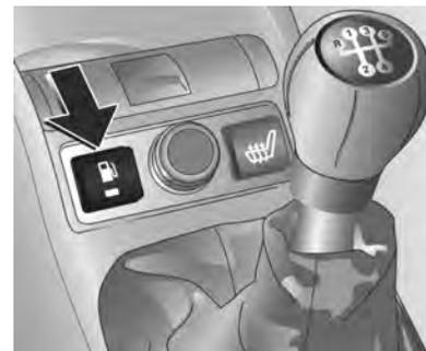
Durch Drücken der Taste
