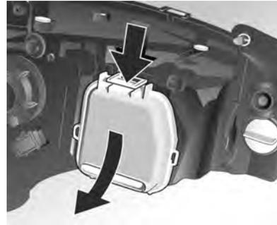
3. Federklammer zum Lösen zur Seite schwenken.
