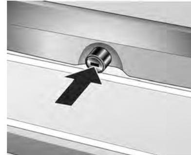
Zum Entriegeln der Hecktür den Schlüssel in waagerechte Stellung drehen oder Taste
