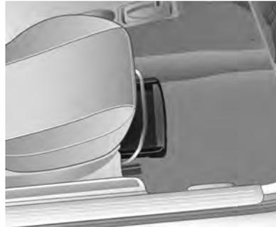
An Griffmulde anheben und herausziehen. Maximales Tragvermögen: 1 kg. Zum Schließen einschieben und einrasten.
