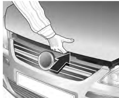
Sicherungsgriff hochdrücken und Motorhaube öffnen.
