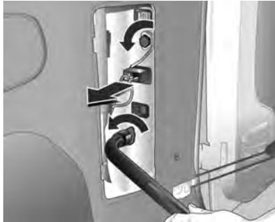
2. Kabelstecker von Lampenträger abziehen.
