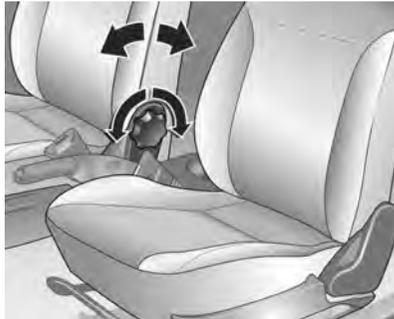
Handrad drehen. Zum Einstellen Rückenlehne entlasten.
