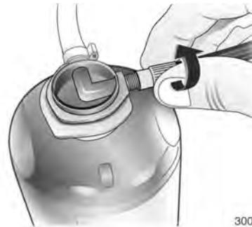
4. Luftschlauch des Kompressors an den Anschluss der Dichtmittelflasche schrauben.
