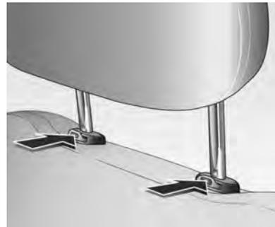
Beide Rastfedern durch Drücken entriegeln, Kopfstütze herausziehen. Die hintere mittlere Kopfstütze kann nicht ausgebaut werden.
