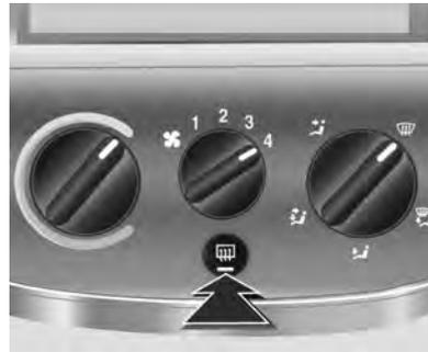
Die Heizung wird durch Drücken der Taste
