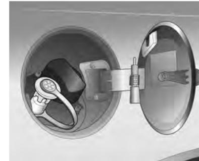
Beim Tanken von Erdgas Schutzkappe des Einfüllstutzens abziehen.
