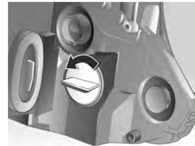
1. Lampenträger links herumdrehen und ausrasten.
