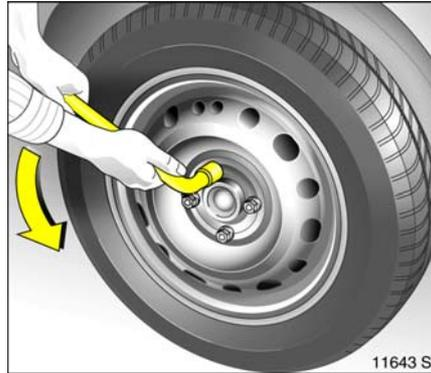
2. Radschrauben mit Radschraubensteckschlüssel **\*** lockern, dabei Radschraubensteckschlüssel **\*** bis zum Anschlag aufstecken.
