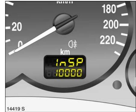
Diese Restlaufstrecke kann bei ausgeschalteter Zündung in der Anzeige des Tageskilometerzählers angezeigt werden: Rückstellknopf für Tageskilometerzähler ca. 2 Sekunden drücken, **InSP** und die verbleibende Restlaufstrecke werden angezeigt.
