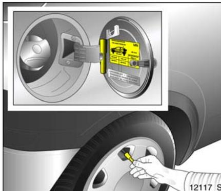
Zum leichteren Abdrehen der Ventilkappen Ventilkappenschlüssel verwenden. Er befindet sich an der Innenseite der Tankklappe.
