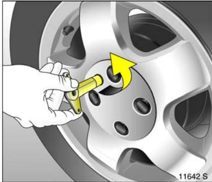
Diebstahlgesicherte Leichtmetallräder **\***: Radkappe mit im Wagenwerkzeug liegendem Sicherungsschlüssel abschrauben und abnehmen.
