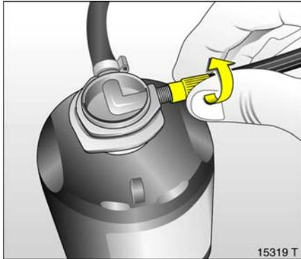
4. Luftschlauch des Kompressors an den Anschluss der Dichtmittelflasche schrauben.
