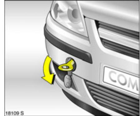
Abschleppöse links herum einschrauben und bis zum Anschlag in waagerechte Stellung festdrehen.
