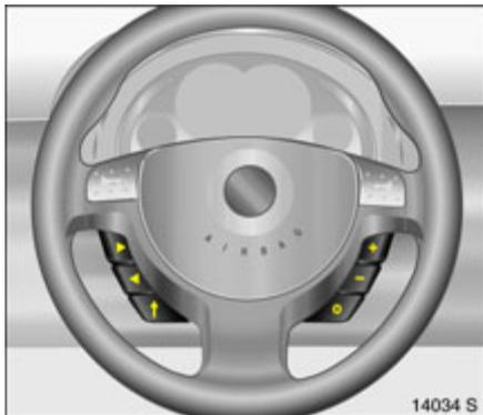
Auswahl mit den Tasten \* am Lenkrad Menüoptionen über Menüs und mit den Tasten auswählen.
