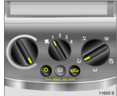
Tasten für Kühlung \* und Umluftsystem
