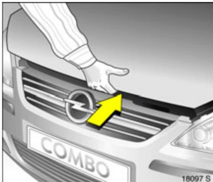
Etwa eine Handbreit rechts von der Motorhaubenmitte – von vorn gesehen – befindet sich an ihrer Unterseite ein Sicherungshaken: Zum Öffnen Haken ziehen und Haube anheben.
