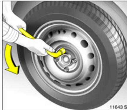
2. Radschrauben mit Radschraubensteckschlüssel ✱ eine halbe Umdrehung lösen, dabei Radschraubensteckschlüssel ✱ bis zum Anschlag aufstecken.
