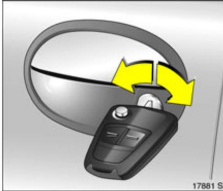
**Manuelle Ent- bzw. Verriegelung mit dem Fahrzeugschlüssel bei Ausfall der Fernbedienung**
