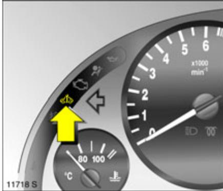
Kontrollleuchte ⚡ für Motorelektronik
