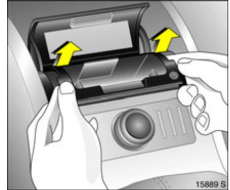
Zum Entleeren Ascherabdeckung über den Druckpunkt hinaus bis zum Anschlag aufklappen, wodurch der Einsatz angehoben wird. Einsatz beidseitig fassen und nach oben herausziehen.
