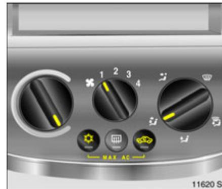
Tasten für Kühlung \* und Umluftsystem sind nur bei Ausführung mit optionaler Klimaanlage \* vorhanden.
