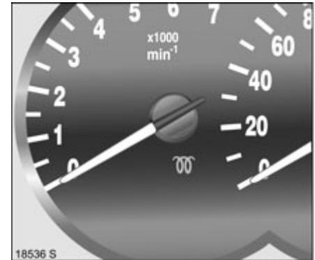
Die Kontrollleuchte ☀️ erlischt, sobald die Selbstreinigung abgeschlossen ist.
