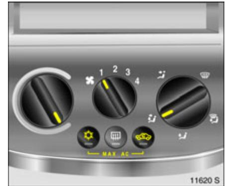
Tasten für Kühlung \* und Umluftsystem
