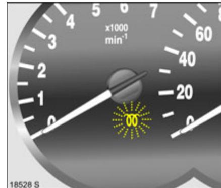
Wenn der Filter gereinigt werden muss und die letzten Fahrbedingungen die Reinigung nicht automatisch zuließen, dann blinkt die Kontrollleuchte ☀.
