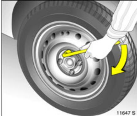
7. Radschrauben eindrehen, Radschraubenschlüssel \* ganz aufstecken und Radschrauben leicht anziehen.
