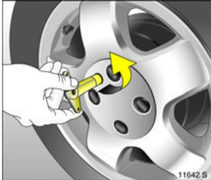
Diebstahlgesicherte Leichtmetallräder \* : Radkappe mit Sicherungsschlüssel abschrauben und abnehmen. Wagenwerkzeug ↗ 134
