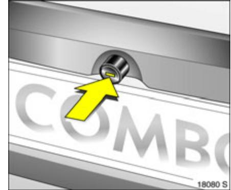
**Hecktür \* entriegeln: Schlüssel in waagerechte Position drehen oder Taste  $\geq$  der Funkfernbedienung \* drücken**
