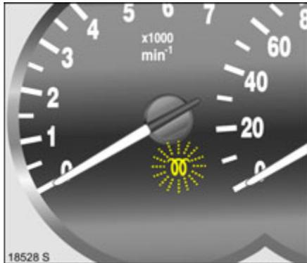
Unter bestimmten Fahrbedingungen, z. B. Kurzstreckenverkehr, kann das System sich nicht automatisch reinigen.
