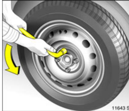
2. Radschraubenschlüssel \* ganz aufstecken und Radschrauben eine halbe Umdrehung lösen.
