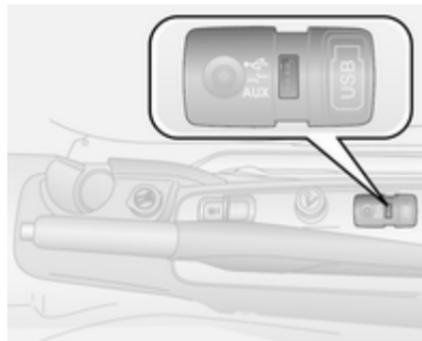
Zum Anschließen externer Audioquellen steht ein USB-Port zur Verfügung.
