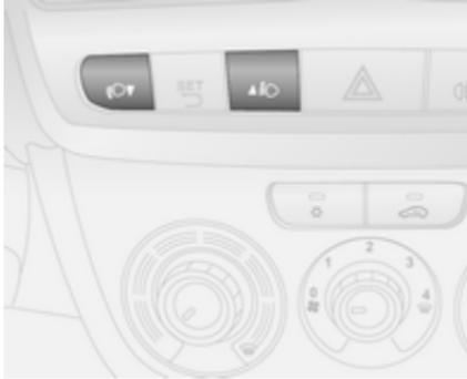
So stellen Sie die Leuchtweite entsprechend des Beladungszustands ein, damit andere Verkehrsteilnehmer nicht geblendet werden: Drücken Sie so lange auf die Tasten bzw. , bis die gewünschte Einstellung im Driver Information Center angezeigt wird 83.
