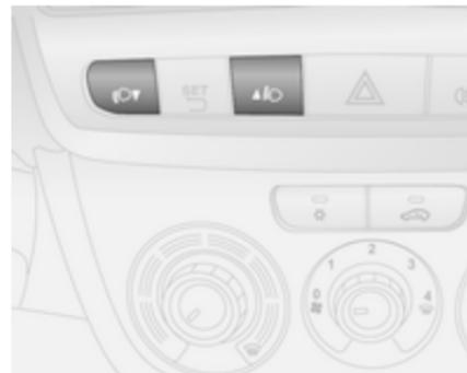
Zum Verschieben des Bildschirms und der Menüoptionen nach oben bzw. Erhöhen des angezeigten Wertes Taste **▲** drücken. Gedrückt halten, um den Wert schnell zu erhöhen (erneut drücken, um beim gewünschten Wert anzuhalten).
