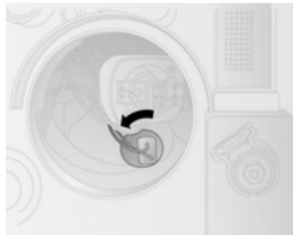
2. Die Glühlampenfassung durch Linksdrehung vom Reflektor abziehen.
