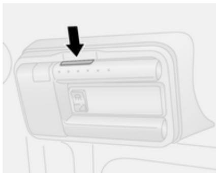
1. Zum Lösen Taste oben an der Lampenbaugruppe drücken.
