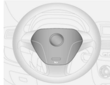
Das Front-Airbag-System wird bei einem Frontalaufprall ab einer bestimmten Unfallschwere ausgelöst. Die Zündung muss eingeschaltet sein.
