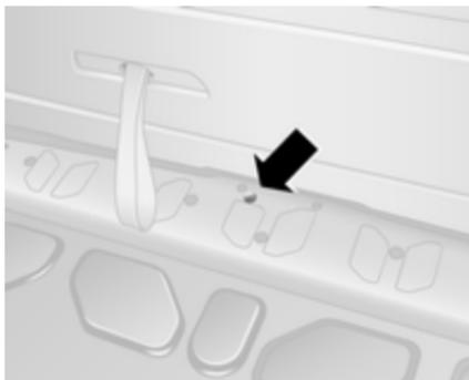
Über eine Zugangsbohrung (s. Pfeil) kann die Heckklappe mit einem geeigneten Werkzeug entriegelt werden. Hebel nach rechts drücken, um die Heckklappe zu entriegeln und zu öffnen.
