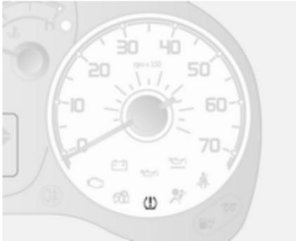
Ein zu niedriger Reifendruck wird durch Aufleuchten der Kontrollleuchte ⚠ ↗ 80 und Ertönen eines
