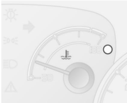
Zeigt die Kühlmitteltemperatur an. Wenn die Kontrollleuchte
