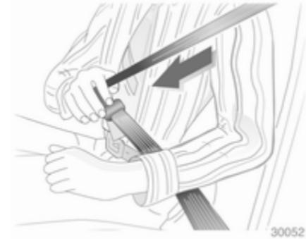
Den Gurt aus dem Aufroller herausziehen, unverdreht über den Körper legen und die Schlosszunge in das Gurtschloss einstecken, bis sie einrastet. Den Beckengurt während der Fahrt durch Ziehen am Schultergurt regelmäßig spannen.
