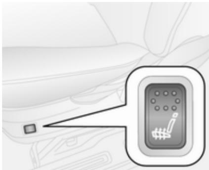
Bei eingeschalteter Zündung Sitzheizung durch Drücken der Taste
