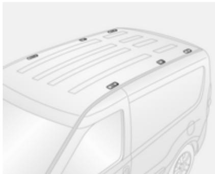
Zur Befestigung eines Dachgepäckträgers die Montagebolzen in die abgebildeten Bohrungen stecken.
