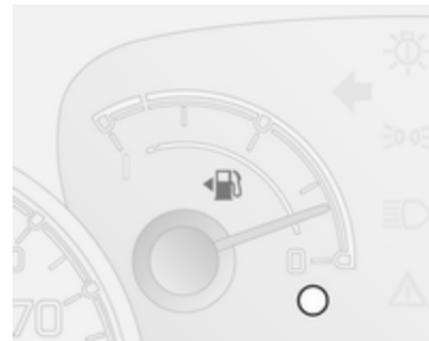
Anzeige von Kraftstofffüllstand bzw. Gasfüllstand im Tank je nach Betriebsart.
