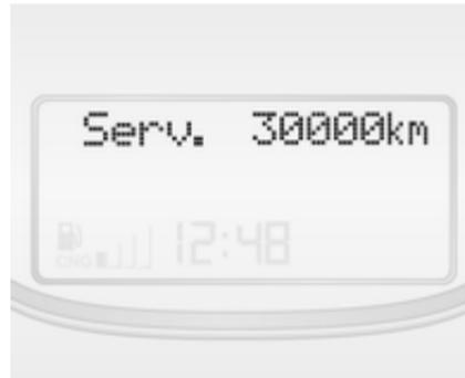
Fahrzeuge mit der Multifunktionsversion des Driver Information Centers ↗ 83 verfügen über eine Serviceanzeige.
