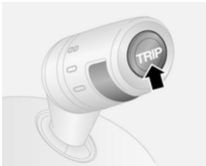
Folgende Funktionen können durch wiederholtes Drücken der **TRIP**-Taste am Ende des Wischerhebels ausgewählt werden:
