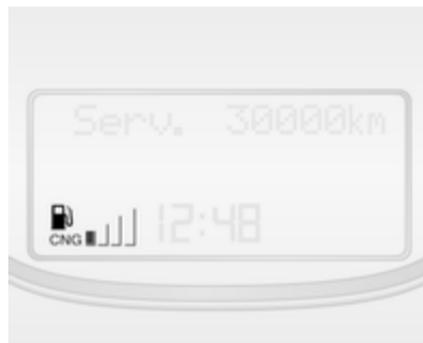
Im Erdgasbetrieb zeigen die vier senkrechten Balken neben **CNG** die verbleibende Methanmenge in den Druckgasbehältern an. Je mehr Kraftstoff verbraucht wurde, desto weniger Balken sind in der CNG-Kraftstoffanzeige zu sehen.
