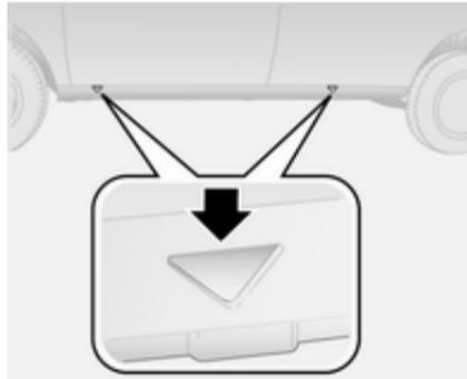
3. Die Ansetzpunkte für den Wagenheber befinden sich vorn und hinten am Fahrzeug.
