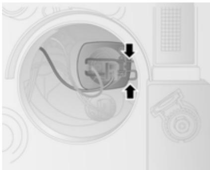
4. Die neue Glühlampe so in den Reflektor einsetzen, dass sie mit der Aussparung des Reflektors fluchtet.
