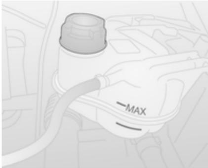
Bei kaltem Kühlsystem muss sich das Kühlmittel zwischen den Markierungen **MIN** und **MAX** bewegen. Bei zu niedrigem Füllstand auffüllen.
