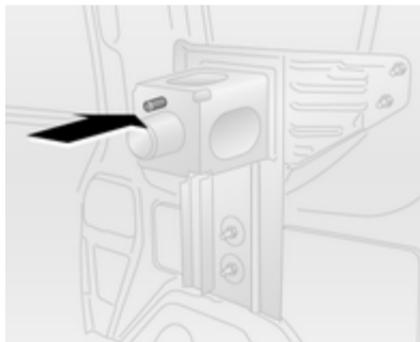
3. Das ausgetauschte Reserverad in die Halterung einsetzen und auf korrekte Ausrichtung des Fixierstiftes achten.
