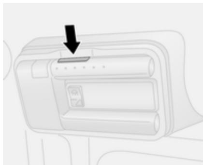
Je nach Modellvariante wird beim Öffnen der hinteren Türen/der Hecktür bzw. einer Schiebetür die herausnehmbare hintere Innenleuchte eingeschaltet, sofern der Schalter in der Mitte in Mittelstellung ist.
