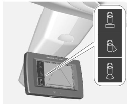
Die Standardansicht nach hinten oder die Sicht auf die Beifahrerseite durch Drücken auf "☰" am unteren Rand auswählen.
