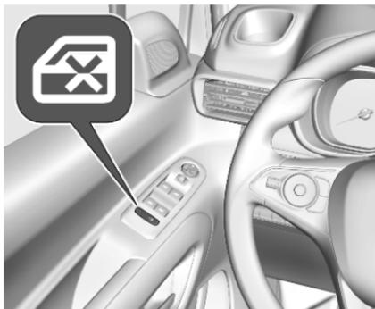
Zur Deaktivierung der elektrischen Fensterbetätigung der Hintertüren ☒ drücken; die LED leuchtet auf. Zur Aktivierung erneut ☒ drücken.
