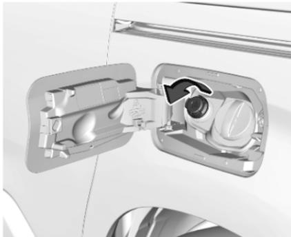
4. Die Schutzkappe vom Einfüllstutzen abschrauben.
