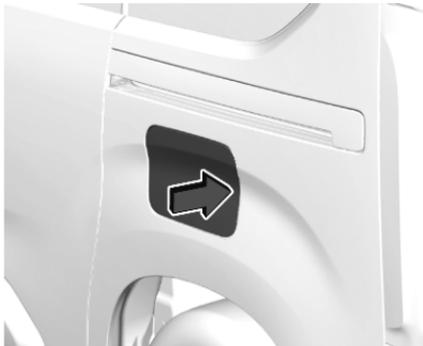
Wenn das Fahrzeug mit einem elektronischen Schlüsselsystem ausgerüstet ist, kann die Tankklappe nur bei entriegeltem Fahrzeug geöffnet werden. Die Tankklappe wird je nach Version durch Drücken auf die Klappe oder Ziehen am unteren rechten Eck freigegeben.
