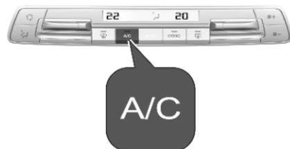
**A/C** drücken, um die Kühlung einzuschalten. Die Kühlung ist nur bei laufendem Motor und eingeschaltetem Klimatisierungsgebläse funktionsfähig.
