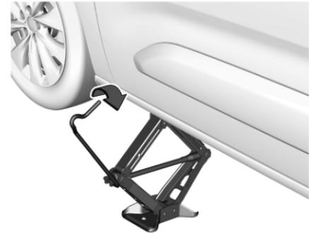
Radschlüssel bei korrektem ausgerichtetem Wagenheber drehen, bis das Rad vom Boden abhebt.
