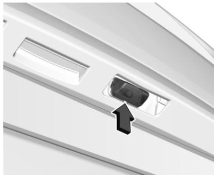
1. Einen Schraubendreher in die Aussparung der Abdeckung einsetzen und die Abdeckung abnehmen.
