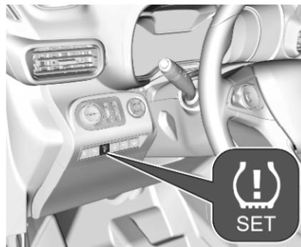
3. Das Reifendruckverlust-Überwachungssystem initialisieren: Bei Fahrzeugen mit Graphic-Info-Display drei Sekunden lang
