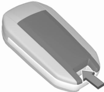
1. Die hintere Abdeckung von der Fernsteuerung entfernen.
