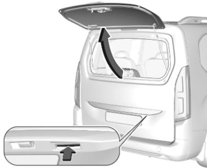
Nach dem Entriegeln die rechte Heckklappentaste drücken und die Heckscheibe öffnen.
