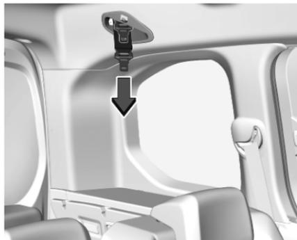
Schließungen mit dem Sicherheitsgurt aus dem Sicherheitsgurthalter am Dach ziehen.
