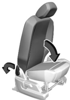
Den Hebel drücken, die Rückenlehne vollständig nach vorne klappen und den Hebel loslassen. Dann die Rückenlehne weiter nach unten drücken, bis sie komplett flach liegt.
