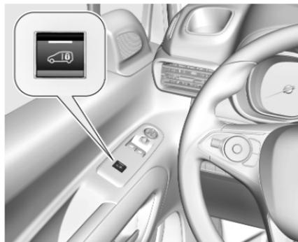
Zum Entriegeln der Heckklappe je nach Version
