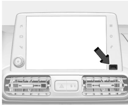
Im Instrument neben dem Info-Display befindet sich ein USB-Anschluss.
