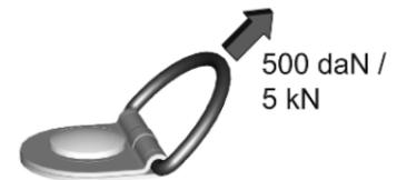
Die maximale auf die Verzurrösen einwirkende Kraft darf 500 daN/5 kN/ 5000 N nicht übersteigen.
