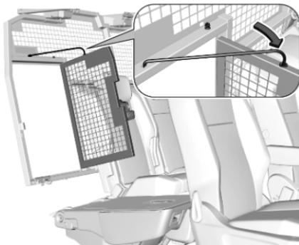
3. Die Klappe mit der Stange sichern.
