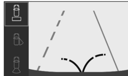
Zusätzlich wird der Öffnungsradius der Hecktüren im Displayrückspiegel angezeigt.
