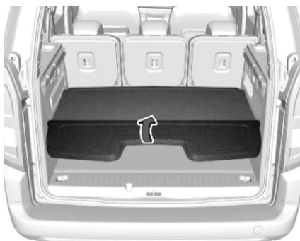
Die Hutablage kann von hinten nach oben geklappt werden, damit der Laderaum flexibler verwendet werden kann.
