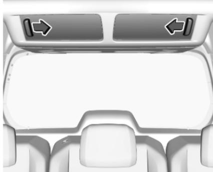
Zum Öffnen die Klappen verschieben.
