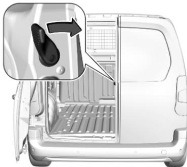
Die rechte hintere Tür wird mit dem Hebel entriegelt.
