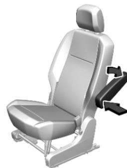
Die Armlehne zum Entfernen nach oben klappen und durch Drücken und Drehen in die abgebildete Position bringen.
