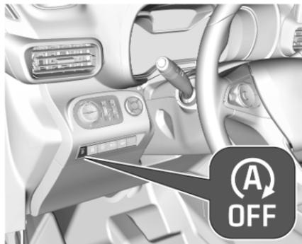
Die Stopp-Start-Automatik lässt sich durch Drücken von
