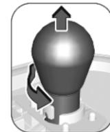
5. Leuchte leicht nach unten drücken, drehen und aus der Leuchtmittelfassung ausbauen. Leuchtmittel wechseln:
