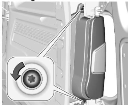
1. Die beiden Schrauben losschrauben und abnehmen.
