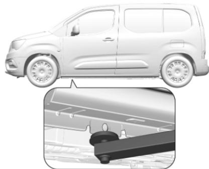
Die Arme der Hebebühne müssen vorne mittig unter den entsprechenden Wagenheberaufnahmen positioniert werden.
