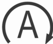
Ein Autostopp wird durch die Kontrollleuchte
