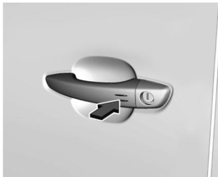
Elektronisches Schlüsselssystem: Beim Entriegeln des Fahrzeugs durch Drücken auf die Markierung an einem der Vordertürgriffe wird die Diebstahlwarnanlage deaktiviert.
