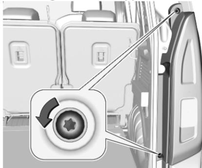
1. Die beiden Schrauben losschrauben und abnehmen.
