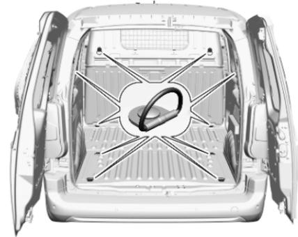
Am Fahrzeugboden und / oder an der Seitenwand können sich Verzurrösen befinden. Die Anzahl und der Anbringungsort der Verzurrösen können je nach Fahrzeug unterschiedlich sein.
