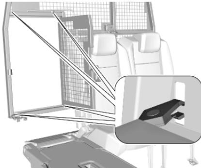
1. Die vier Karabiner an der Abdeckung an den entsprechenden Verzurrösen befestigen.
