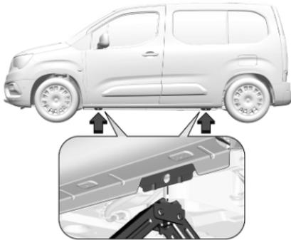
3. Sicherstellen, dass der Wagenheber richtig unter dem entsprechenden Aufnahmepunkt ausgerichtet ist.
