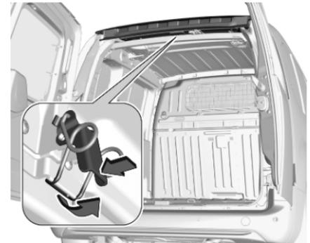
1. Den Hebel drücken und die Federklammer von der Halterung abziehen.
