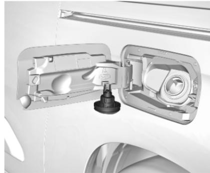
Der Tankdeckel kann am Haken an der Tankklappe eingehängt werden.
