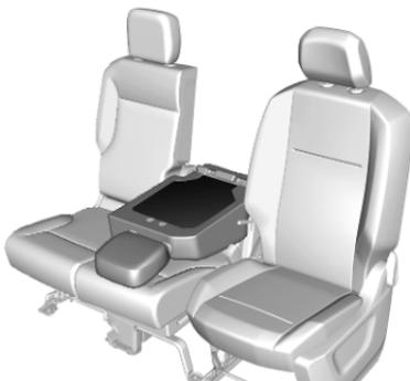
Die Rückenlehne des Beifahrersitzes ist mit einer Dokumentenablage ausgestattet.
