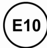
Kraftstoff gemäß der Norm EN228, mit Beimischung eines Biokraftstoffs gemäß der Norm EN15376.
