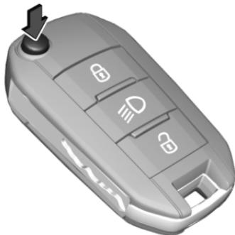
Zum Ausklappen auf den Knopf drücken. Zum Einklappen zuerst auf den Knopf drücken.
