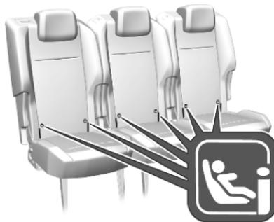
Für das Fahrzeug zugelassene ISOFIX-Kindersicherheitsysteme an den ISOFIX-Befestigungen befestigen. Die speziellen Positionen für ISOFIX-Kindersicherheitsysteme sind in der Tabelle mit ISOFIX gekennzeichnet ↷ 71.
