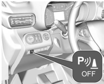
Graphic-Info-Display: Das System ist betriebsbereit, wenn die LED in der Einparkhilfetaste  $\text{P}_{\text{off}}^{\text{PMS}}$  nicht leuchtet.
