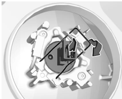
2. Die Federklammer nach rechts schieben, um sie von der Halterung zu lösen. Die Federklammer nach unten schwenken. Die Lampenfassung aus dem Reflektorgehäuse ziehen.
