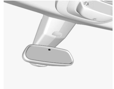
Beim Fahren im Dunkeln wird die Blendwirkung folgender Fahrzeuge automatisch reduziert.
