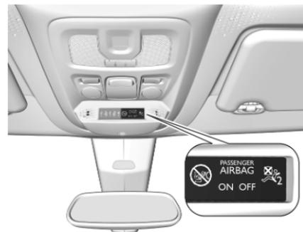
Wenn die Kontrollleuchte
