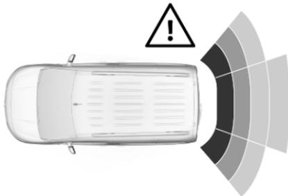
Außerdem wird der Abstand zu Hindernissen hinter dem Fahrzeug durch sich ändernde Abstandslinien im Info-Display angezeigt  $\hookrightarrow$  117. Bei einem sehr geringen Abstand wird das Warnsymbol  $\triangle$  angezeigt.
