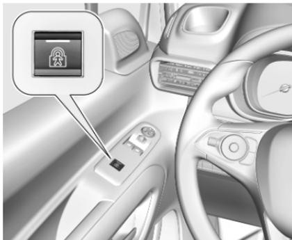
Je nach Version befindet sich die Taste
