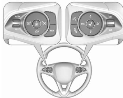
Der Geschwindigkeitsregler und der Geschwindigkeitsbegrenzer werden über die Bedienelemente links am Lenkrad bedient.
