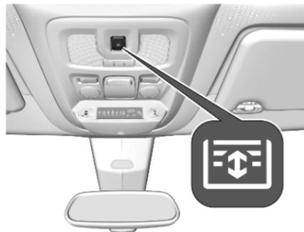
Drücken hinten auf
