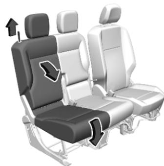
Die äußere Rückenlehne durch Ziehen an der Schlaufe umklappen. Die Rückenlehne nach vorne schwenken, bis der Sitz auf den Fahrzeugboden abgesenkt ist.
