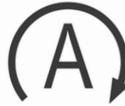
Bei geringer Fahrgeschwindigkeit oder im Stillstand wird unter bestimmten Bedingungen ein Autostopp aktiviert.
