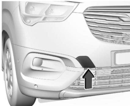
Die Spitze eines Schlitzschraubendrehers mit einem Tuch umwickeln, um den Lack zu schützen. Den Schraubendreher in den Schlitz am unteren Bereich der Abdeckung stecken. Die Kappe vorsichtig lösen. Die Abschleppöse befindet sich beim Wagenwerkzeug ⇨ 243.
