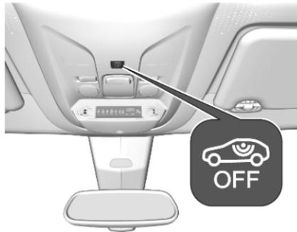
Wenn Tiere im Fahrzeug zurückgelassen werden, muss die Überwachung des Fahrzeuginnenraums abgeschaltet werden, weil laute Ultraschallsignale oder Bewegungen den
