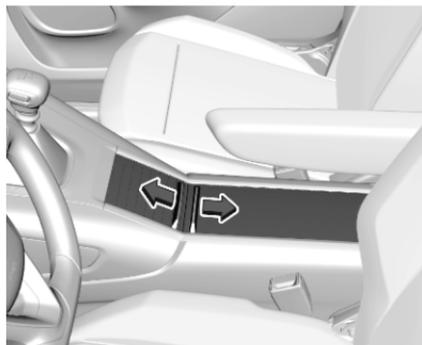
In der Mittelkonsole kann sich ein Ablagefach befinden. Zum Öffnen auf die Abdeckung drücken.
