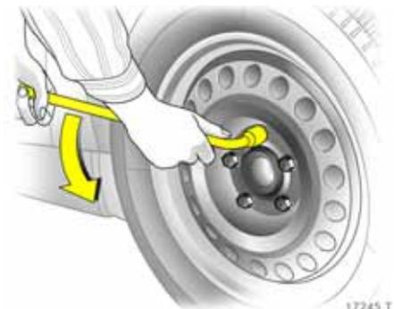
2. Radschrauben mit Radschraubensteckschlüssel \* eine halbe Umdrehung lösen, dabei Radschraubensteckschlüssel \* bis zum Anschlag aufstecken.
