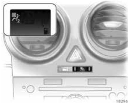
Die Airbag-Systeme für den Beifahrer sind nun aktiviert. LEDs in der Taste
