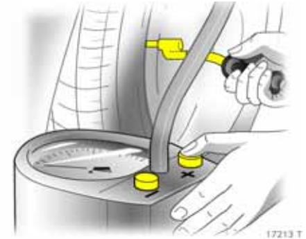
Ventilkappen nach der Prüfung mit Ventilkappenschlüssel fest zuschrauben.
