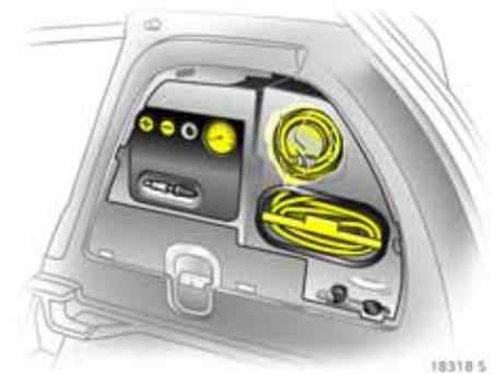
1. Dichtmittelflasche und Halter mit Luftschlauch aus dem Fach nehmen.
