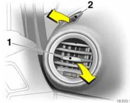
Zum Schließen der Düse Rändelrad bis zum Anschlag nach rechts oder links drehen.
