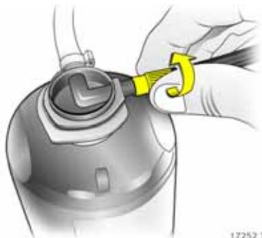
2. Luftschlauch vom Halter abwickeln und an den Anschluss der Dichtmittelflasche schrauben.
