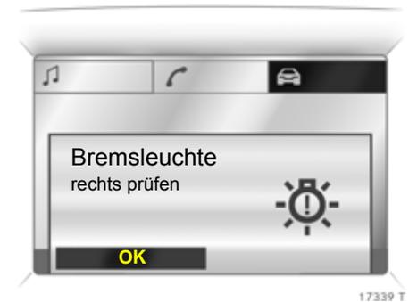
Bei einer Störung der Beleuchtungsanlage erscheint die entsprechende Fehlerquelle als Text, z. B.:
