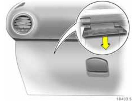
Bei Fahrzeugen mit Lenkrad auf der rechten Seite befindet sich der Sicherungskasten hinter einer Abdeckung im Handschuhfach. Handschuhfach öffnen und Abdeckung abziehen. Zum Schließen Abdeckung zuerst unten ansetzen und einrasten.
