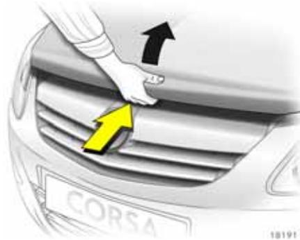
An der Motorhaubenunterseite befindet sich ein Sicherungsgriff: Hochdrücken und Haube öffnen.
