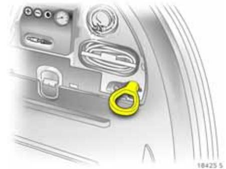
Zum Öffnen des Faches Abdeckung ausrasten und aufklappen.
