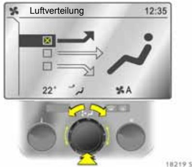
Die einzelnen Menüpunkte werden durch Drehen des zentralen Drehknopfes markiert und durch Drücken ausgewählt. Bei einigen Menüpunkten wird ein weiteres Menü angezeigt ✱, sobald das entsprechende Menü durch Drücken ausgewählt wurde.
