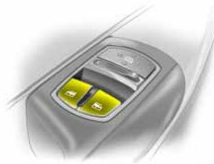
Bedienung mit zwei Schaltern im Griff der Fahrertür für vordere Fenster. Zusätzlicher Schalter in der Beifahrertür.
