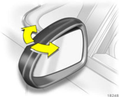
Zur Sicherheit für Fußgänger klappen die Außenspiegel bei Anstoßen aus ihrer Ausgangslage. Durch leichten Druck wieder einrasten.
