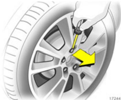
Leichtmetallräder \* Radschraubenkappen mit Schraubendreher ausrasten und abnehmen. Dabei zum Schutz der Felge weichen Lappen zwischen Schraubendreher und Leichtmetallrad legen.
