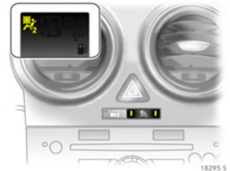
Bei einer Störung der Airbag-Systeme blinken die LEDs in der Taste ⚠️ zur Abschaltung der Airbag-Systeme ⚠️ zusätzlich zur leuchtenden Kontrollleuchte ⚠️.
