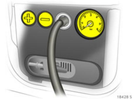
8. Taste **+** am Kompressor drücken, der Reifen wird mit dem Dichtmittel gefüllt.
