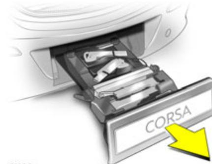
Flex-Fix System vollständig bis zum hörbaren Einrasten herausziehen.
