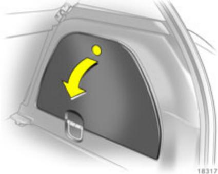
Die Abschleppöse befindet sich im Gepäckraum rechts unten hinter der Abdeckung. Zum Öffnen des Faches Abdeckung ausrasten und aufklappen.
