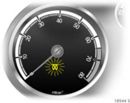
Wenn das Filter gereinigt werden muss und die letzten Fahrbedingungen die Reinigung nicht automatisch zuließen, dann blinkt die Kontrollleuchte 00. Die Fahrt kann dennoch normal fortgesetzt werden. Das Fahrzeug wird nicht beschädigt und es müssen keine Servicearbeiten durchgeführt werden.
