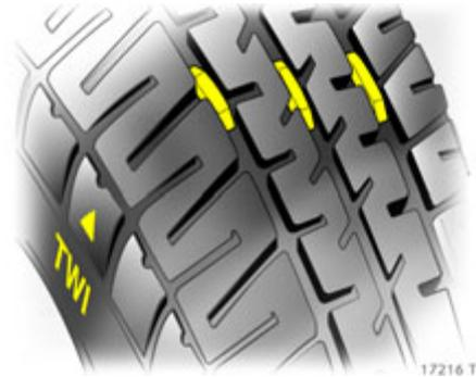
Die gesetzlich zulässige Mindestprofiltiefe (1,6 mm) ist erreicht, wenn das Profil bis zu einem Verschleißanzeiger (TWI<sup>1)</sup>) abgefahren ist. Mehrere Verschleißanzeiger sind in gleichen Abständen im Profilgrund der Lauffläche verteilt. Ihre Lage ist durch Markierungen an der Reifenflanke angezeigt.
