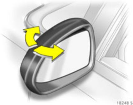
Zur Sicherheit für Fußgänger klappen die Außenspiegel bei Anstoßen aus ihrer Ausgangslage. Durch leichten Druck wieder einrasten.
