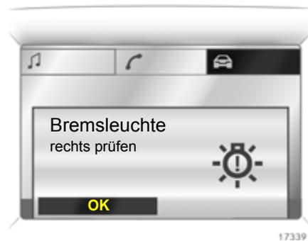
Bei einer Störung der Beleuchtungsanlage erscheint die entsprechende Fehlerquelle als Text, z. B.:
