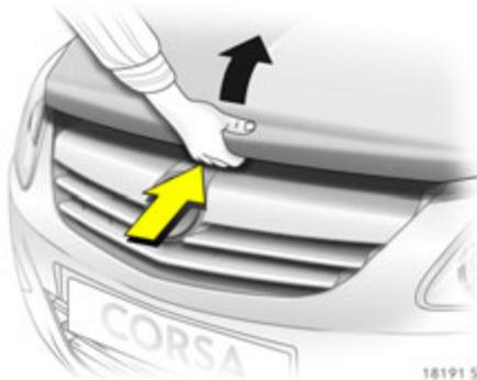
Sicherungsgriff hochdrücken und Motorhaube öffnen.
