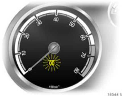
Wenn der Filter gereinigt werden muss und die letzten Fahrbedingungen die Reinigung nicht automatisch zuließen, dann blinkt die Kontrollleuchte '00'.
