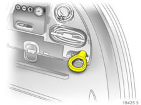
Zum Öffnen des Faches Abdeckung ausrasten und aufklappen ↗ 196, Bild 18317 S.
