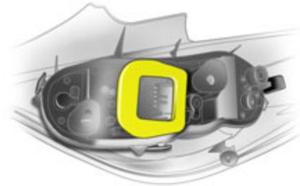
9. Sicherstellen, dass die Dichtung am Lampenträger, wie im Bild gezeigt, angesetzt ist. Runde Dichtung auf Befestigungsschraube stecken.
