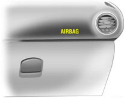
Das Beifahrer-Airbag-System ❄️ ist erkennbar am Schriftzug **AIRBAG** oberhalb des Handschuhfaches.
