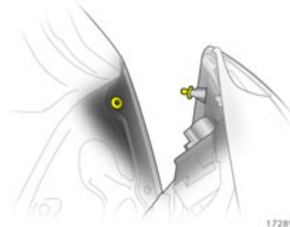
10. Lampengehäuse in Karosserie einsetzen, dabei Rastnase und Kugelbolzen in Aussparungen einrasten. Befestigungsmuttern mit Hand festziehen. Kabelstecker einrasten. Klappe schließen und verriegeln.
