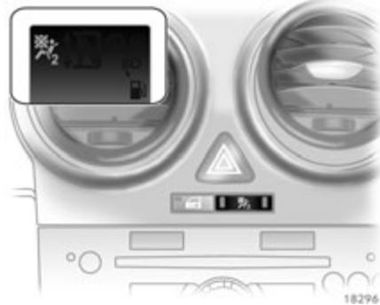
Die Airbag-Systeme für den Beifahrer sind nun aktiviert. LEDs in der Taste
