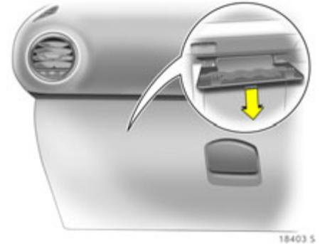
Bei Fahrzeugen mit Lenkrad auf der rechten Seite befindet sich der Sicherungskasten hinter einer Abdeckung im Handschuhfach. Handschuhfach öffnen und Abdeckung abziehen. Zum Schließen Abdeckung zuerst unten ansetzen und einrasten.
