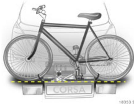
Radaufnahmen so einstellen, dass das Fahrrad ungefähr waagrecht steht, dabei sollte der Abstand zwischen Pedale und Hecktür mindestens 5 cm betragen. Einstellen der Radaufnahmen ↪ 176.
