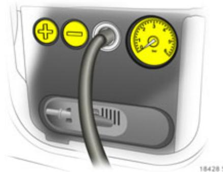
8. Taste **+** am Kompressor drücken, der Reifen wird mit dem Dichtmittel gefüllt.
