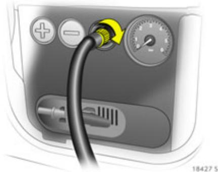
6. Luftschlauch an den Anschluss am Kompressor schrauben.
