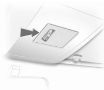
1. Streuscheibe an der in der Abbildung gezeigten Stelle mit dem Schraubendreher ausrasten und abziehen.
