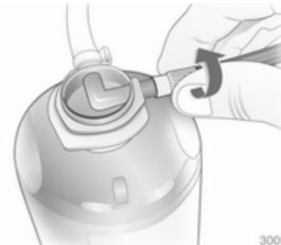
2. Luftschlauch vom Halter abwickeln und an den Anschluss der Dichtmittelflasche schrauben.
