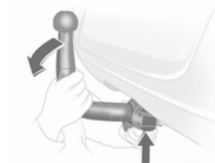
Gespannte Kugelstange in die Aufnahmeöffnung einführen und kräftig bis zum hörbaren Einrasten nach oben drücken.
