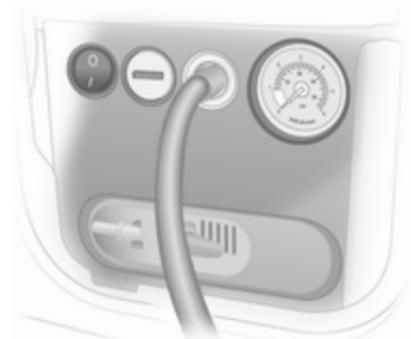
8. Den Ein/Aus-Schalter am Kompressor drücken. Der Reifen wird mit dem Dichtmittel gefüllt.
