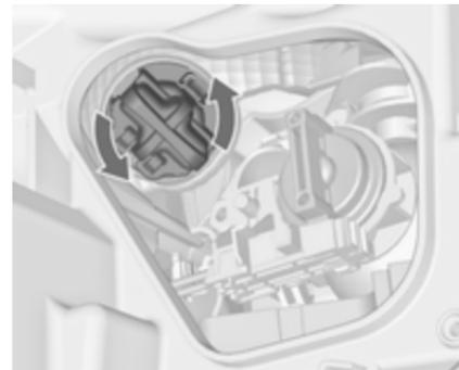
2. Lampenfassung durch Drehen nach links austrasten.
