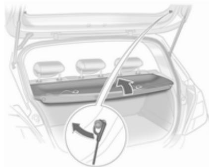
Abdeckung hinten bis zum Ausrasten hochheben und herausnehmen.
