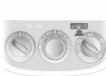
Die Heizung wird durch Drücken der Taste
