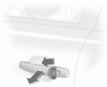
Schlüssel im Fahrertürschloss in Richtung Fahrzeugvorderseite drehen.
