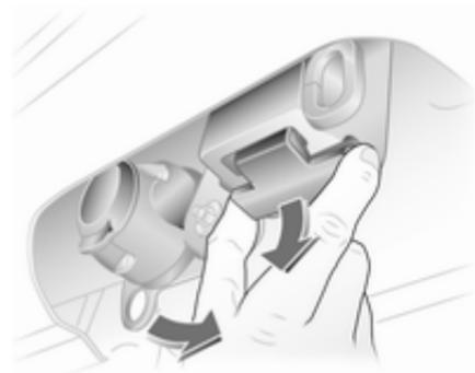
Steckdose ausrasten und nach unten klappen. Verschlussstopfen von der Öffnung für die Kugelstange entfernen und verstauen.
