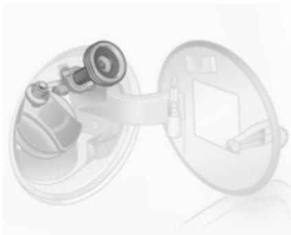
**ACME Adapter:** Die Mutter der Einfülldüse auf den Adapter schrauben. Den Sperrhebel auf der Einfülldüse nach unten drücken.
