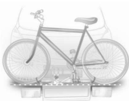
Die Radaufnahmen so positionieren, dass das Fahrrad sich etwa in horizontaler Position befindet. Dabei sollte der Abstand zwischen den Pedalen und der Hecktür mindestens 5 cm betragen.
