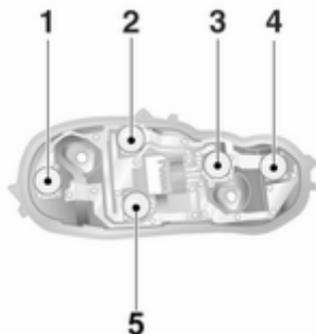
6. Glühlampe etwas in die Fassung hineindrücken, links herumdrehen und herausnehmen. Neue Glühlampe einsetzen.
