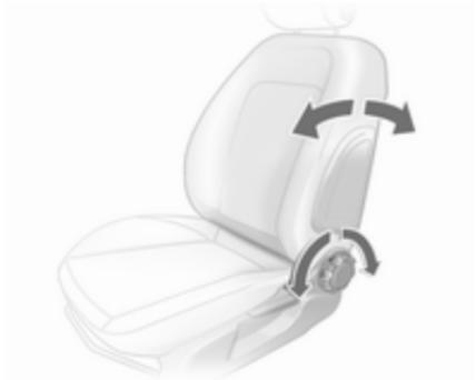
Handrad drehen. Zum Einstellen Rückenlehne entlasten.
