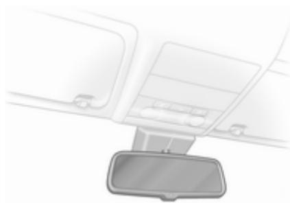
Bei Nacht wird die Blendwirkung durch nachfolgende Fahrzeuge automatisch reduziert.
