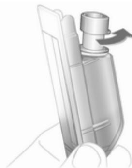
4. Lampenfassung durch Drehen nach links ausrasten.
