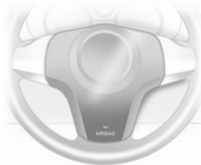
Das Front-Airbag-System besteht aus einem Airbag im Lenkrad und einem in der Instrumententafel auf der Beifahrerseite. Diese Stellen sind mit dem Wort **AIRBAG** gekennzeichnet.
