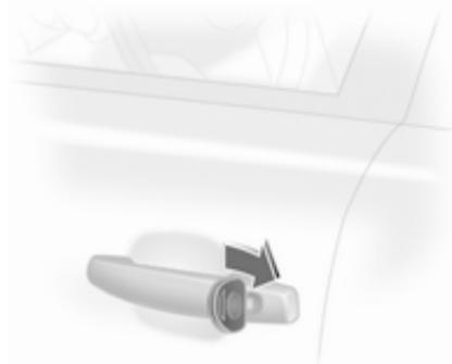
Schlüssel im Fahrertürschloss in Richtung Fahrzeugheck drehen.
