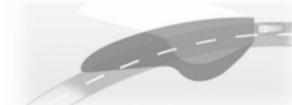
Der Lichtstrahl wird auf Basis des Lenkwinkel und der Geschwindigkeit geschwenkt, was die Ausleuchtung von Kurven verbessert.
