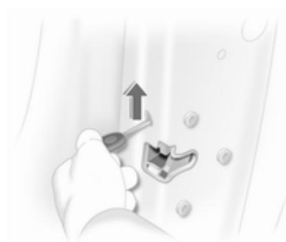
Den Schlüssel an der Innenseite der Tür in die Öffnung oberhalb des Schlosses stecken und die Verriegelung durch Anheben mit dem Schlüssel hörbar betätigen. Dann die Tür schließen. Dieser Vorgang muss für jede Tür wiederholt werden. Die Fahrertür kann auch von außen mit dem Schlüssel verriegelt werden. Tankklappe und Hecktür können nicht verriegelt werden.
