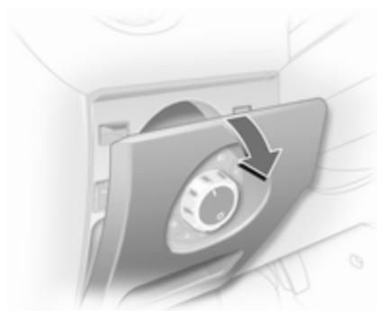
Bei Fahrzeugen mit Linkslenkung befindet sich der Sicherungskasten hinter dem Lichtschalter. Blende an oberer Kante ziehen und abklappen.
