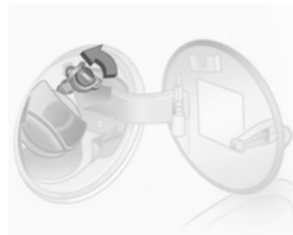
Die Schutzkappe vom Einfüllstutzen abschrauben.
