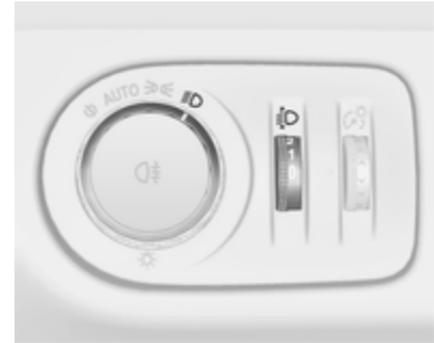
Leuchtweite der Fahrzeugbeladung anpassen, um das Blenden anderer zu vermeiden: Das Rändelrad
