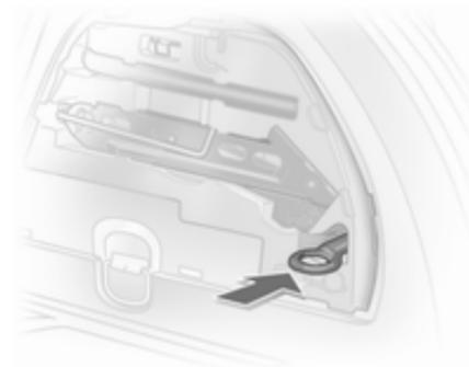
Die Abschleppöse befindet sich beim Wagenwerkzeug ↷ 179. Die Abschleppöse ist in einer Aussparung untergebracht.
