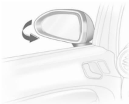
Die Außenspiegel lassen sich durch leichten Druck auf die Außenkante des Gehäuses beiklappen.
