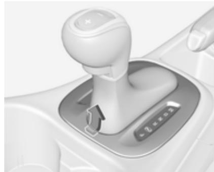
2. Die Verkleidung des Wählhebels von der Mittelkonsole entfernen. Mit einem Finger in die Leder-
