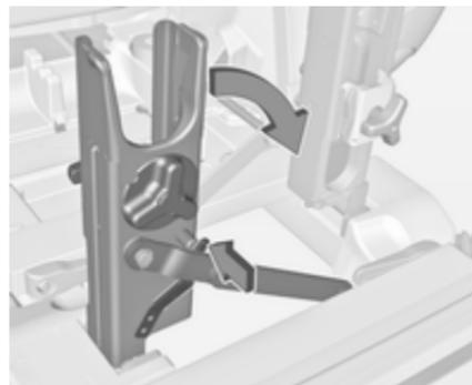
Arretierungshebel an der diagonalen Stütze ausrasten und beide Tretkurbelaufnahmen nach unten klappen.
