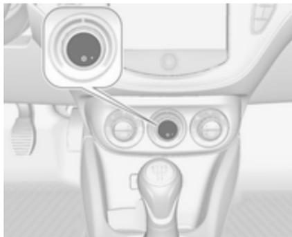
Taste ☀ drücken, um die Kühlung einzuschalten. Die Aktivierung wird durch das Leuchten der LED auf der
