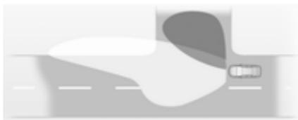
In engen Kurven oder beim Abbiegen wird abhängig vom Lenkwinkel bzw. dem Blinkersignal links oder rechts ein zusätzlicher Reflektor eingeschaltet, der die Straße in Fahrtrichtung beleuchtet. Er wird bei Geschwindigkeiten von bis zu 40 km/h aktiviert.
