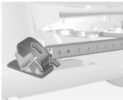
Entriegelungshebel am Spannband drücken und Spannband herausziehen.
