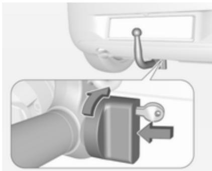
Schlüssel in Schloss stecken und Kugelstange aufschließen.
