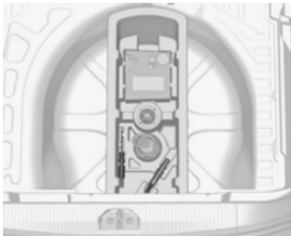
Bei Ausführungen mit Heckträgersystem oder doppeltem Laderaumboden ist das Wagenwerkzeug mit der Abschleppöse und dem Reifenreparaturset rechts im Laderaum hinter einer Abdeckung verstaut.
