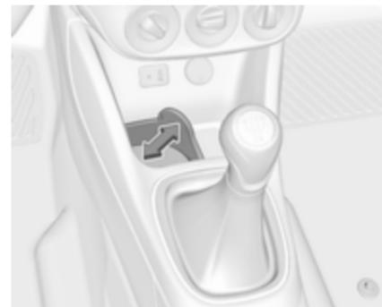
Im Ablagefach vor dem Wählhebel befindet sich ein beweglicher Gummiriemen. Den Riemen herausziehen, um einen Becher oder Ascher zu fixieren.
