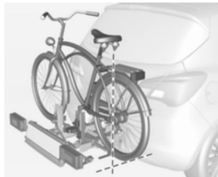
Fahrrad in Fahrzeuginnenrichtung ausrichten: Tretlagerfixierung etwas lösen.
