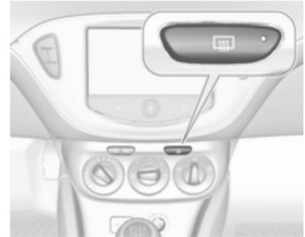
Wird durch Drücken der Taste
