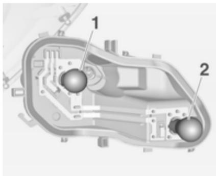
5. Die Lampe ausbauen und ersetzen. Hierzu die Lampe leicht in die Fassung drücken und gegen den Uhrzeigersinn drehen:
