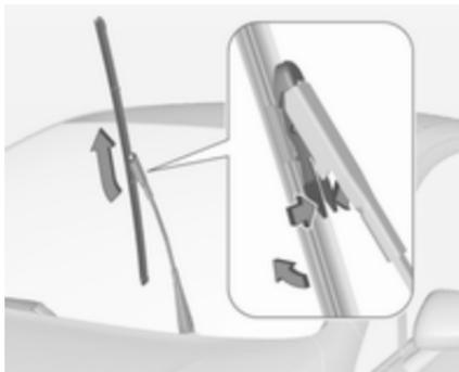
Den Wischerarm anheben, bis er in der angehobenen Stellung bleibt. Die Arretierungen an beiden Seiten drücken, das Wischerblatt in einen Winkel von 90° zum Wischerarm neigen und nach oben entfernen.
