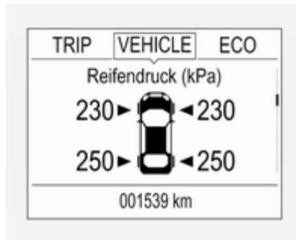
6. Auf **SET/CLR** drücken, um den Sensorabgleich zu starten. Eine Meldung wird eingeblendet, die eine Bestätigung des Vorgangs erfordert.
