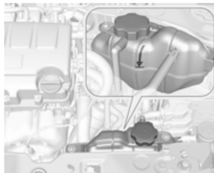
Bei zu niedrigem Füllstand auffüllen.
