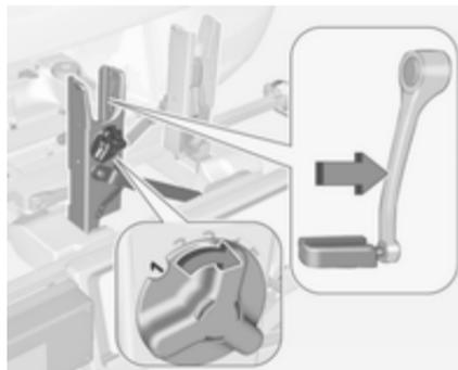
Bei gekrümmten Tretkurbeln am Fahrrad Tretkurbelanlage vollständig hineindreihen (Position 1).
