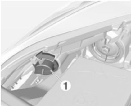
1. Lampenfassung (1) durch Drehen nach links ausrasten.
