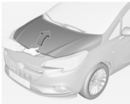
Den Sicherungshebel nach oben drücken und die Motorhaube öffnen.
