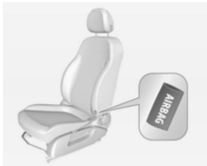
Das Seiten-Airbag-System besteht aus je einem Airbag in den Rückenlehnen der Vordersitze. Diese Stelle ist durch das Wort **AIRBAG** gekennzeichnet.
