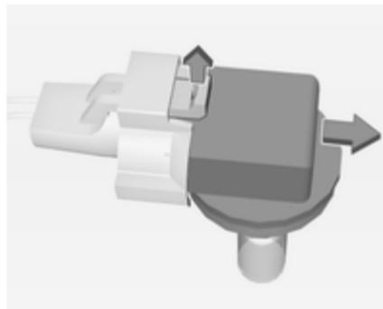
3. Die Lampe durch Ausrasten und Ziehen vom Steckverbinder entfernen.
