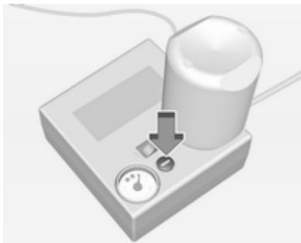
Wird der vorgeschriebene Reifendruck nicht innerhalb von 10 Minuten erreicht, Reifenreparaturset entfernen. Das Fahrzeug um eine Reifenumdrehung bewegen. Das Reifenreparaturset wieder anschließen und Füllvorgang
