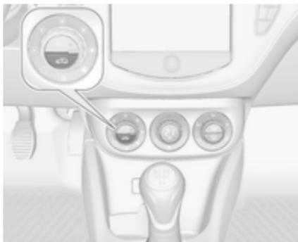
Zum Einschalten des Umluftbetriebs Taste
