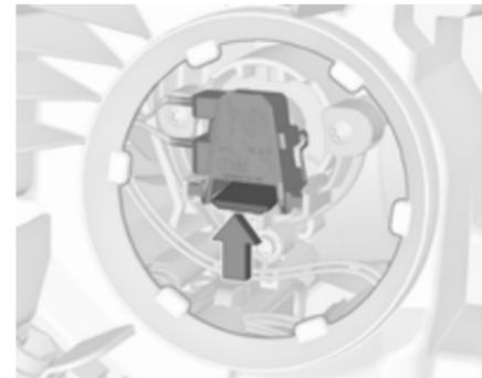
2. Auf den Clip drücken, um die Lampenfassung zu lösen. Lampenfassung aus dem Reflektor ziehen.
