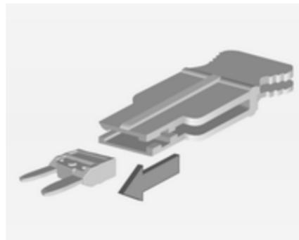
Den Sicherungszieher von oben auf die verschiedenen Arten von Sicherungen stecken und die Sicherung herausziehen.
