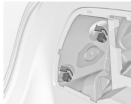
2. Beide Kunststoff-Befestigungsmuttern von innen mit der Hand abschrauben.
