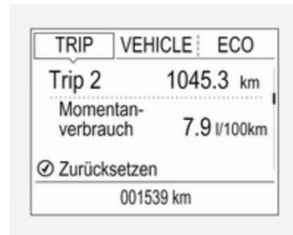
Die Menüseiten des Uplevel-Displays werden durch Drücken auf die Taste **MENU** am Blinkerhebel ausgewählt. Die Symbole des Hauptmenüs sind in der obersten Displayzeile zu sehen:
