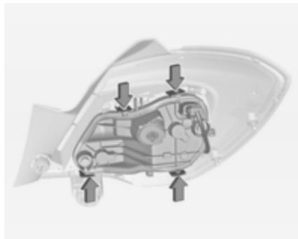
4. Auf die Haltenasen drücken und die Lampenfassung aus dem Leuchtensammenbau herausnehmen.
