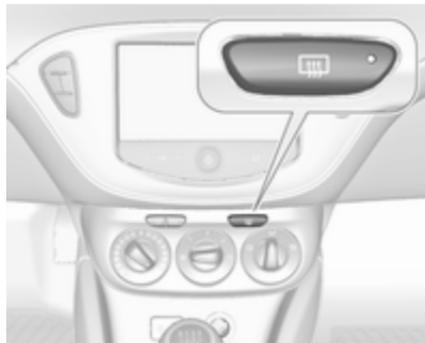
Die Heizung wird durch Drücken der Taste
