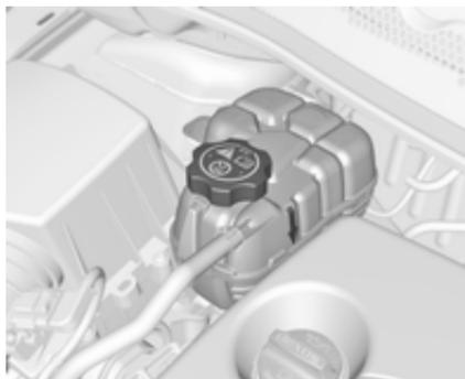
Bei kaltem Kühlsystem muss der Kühlmittelspiegel über der Fülllinienmarkierung liegen.
