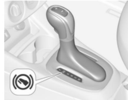
Bei nicht betätigtem Bremspedal leuchtet die Kontrollleuchte
