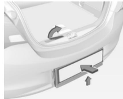
Entriegelungshebel nach oben drücken und halten. Das System leicht anheben und in den Stoßfänger drücken, bis es einrastet.
