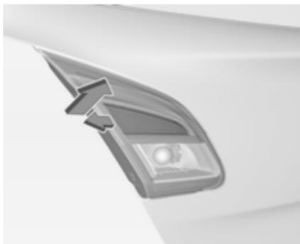
2. Den Leuchtensammenbau etwas nach außen bewegen und dann aus der Hecktür herausziehen.
