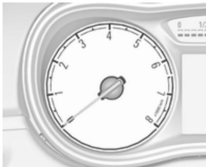
Anzeige der Motordrehzahl. Nach Möglichkeit in jedem Gang im niedrigen Drehzahlbereich fahren.
