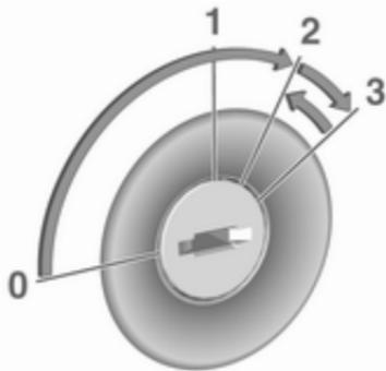
Den Schlüssel in die Stellung **1** drehen, um das Lenkradschloss zu lösen.
