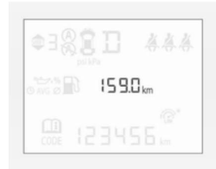
Zum Zurücksetzen Taste **SET/CLR** auf dem Blinkerhebel einige Sekunden lang drücken ↵ 96.
