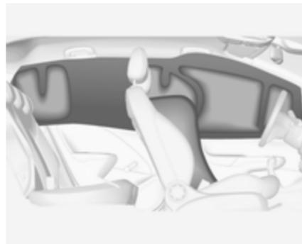
Der aufgeblähte Airbag dämpft den Aufprall, wodurch die Verletzungsfahr für den Kopf bei einem Seitenaufprall deutlich verringert wird.
