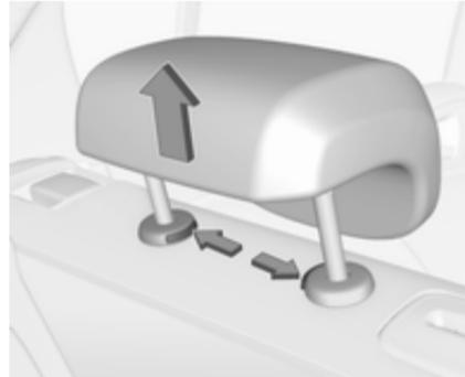
Beide Verriegelungen drücken, die Kopfstütze nach oben ziehen und abnehmen.
