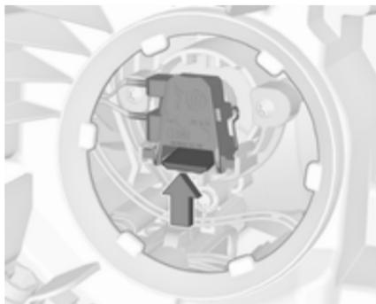
2. Auf den Clip drücken, um die Lampenfassung zu lösen. Lampenfassung aus dem Reflektor ziehen.
