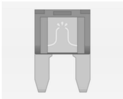
Je nach Ausführung lässt sich eine durchgebrannte Sicherung anhand des geschmolzenen Drahtes erkennen. Sicherung nur dann ersetzen, wenn die Ursache für die Störung behoben wurde.
