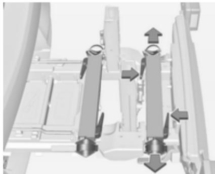
Entriegelungshebel drücken und Radaufnahmen herausziehen.
