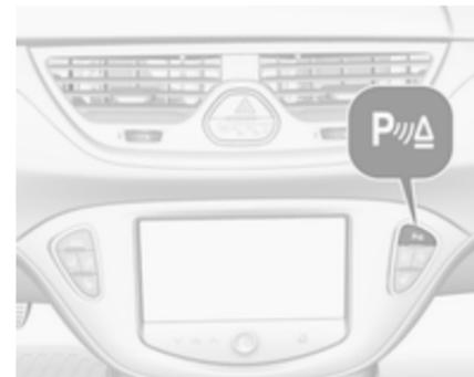
Fahrzeuge mit Heckeinparkhilfe oder mit Front- und Heckeinparkhilfe sind mit der Taste **P** mit einem Dreieckssymbol ausgestattet.
