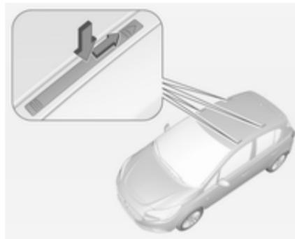
Abdeckungen der Montageöffnungen des Dachgepäckträgers nach unten drücken und mit Ventilkappenschlüssel nach hinten schieben ↻ 209.
