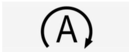
Ein Autostopp wird durch die Kontrollleuchte (A) angezeigt.
