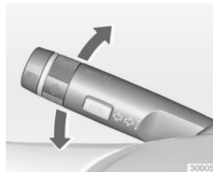
Hebel nach oben = Blinker rechts
