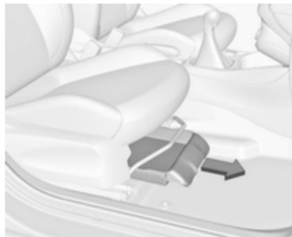
An Griffmulde anheben und herausziehen. Höchstlast: 1,5 kg. Zum Schließen hineindrücken und einrasten.
