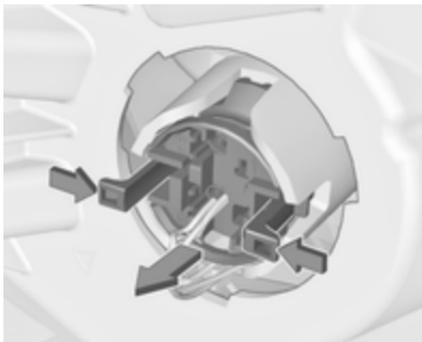
2. Beide Clips zusammendrücken und die Lampenfassung aus dem Scheinwerfergehäuse ziehen.
