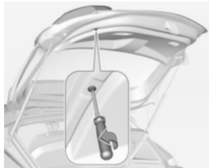
1. Die Schraube in der Hecktür entfernen.
