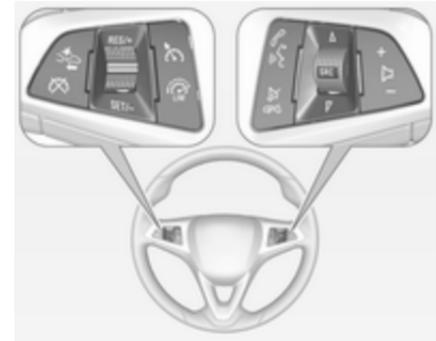
Der Geschwindigkeitsregler, der Geschwindigkeitsbegrenzer, die Einstellungen der Auffahrwarnung, das Infotainment System und ein angeschlossenes Mobiltelefon können über die Bedienelemente am Lenkrad gesteuert werden.
