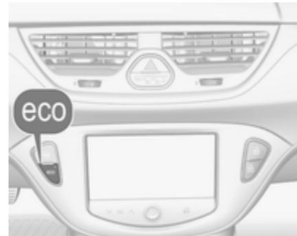
Die Stopp-Start-Automatik lässt sich durch Drücken der Taste **eco** manuell deaktivieren. Die Deaktivierung wird durch das Erlöschen der LED in der Taste angezeigt.
