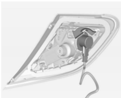
3. Die Lampenfassung drehen und entfernen.
