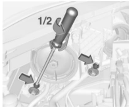
An jedem Scheinwerfergehäuse befinden sich zwei Einstellelemente.
