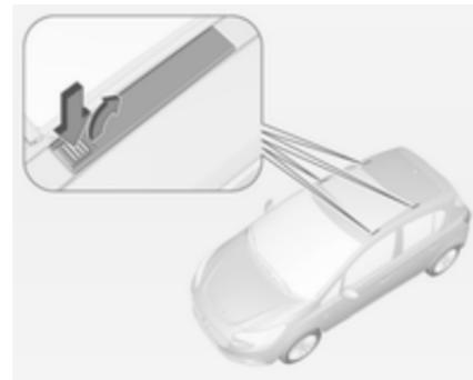
Die Abdeckungen der Montageöffnungen für den Dachgepäckträger durch Drücken der Gleitstücke in Pfeilrichtung ausrasten und nach oben herausnehmen. Zum Schließen der Montagöffnungen Abdeckungen erst vorn einsetzen und dann Gleitstücke hinten einrasten lassen.
