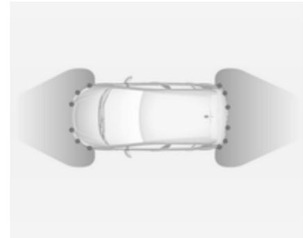
Die erweiterte Einparkhilfe ist immer mit der Front-Heck-Einparkhilfe kombiniert (siehe vorigen Abschnitt). Beide Systeme nutzen dieselben Sensoren im vorderen und hinteren Stoßfänger.
