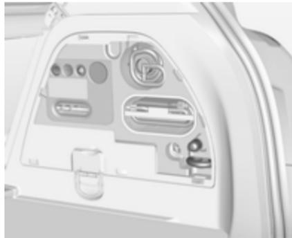
Einige Werkzeuge, die Abschleppöse und das Reifenreparaturset befinden sich im Laderaum unter der Bodenabdeckung.
