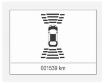
Der Abstand zu einem Hindernis an der Front oder am Heck wird durch Änderung der Abstandslinien im Driver Information Center angezeigt.
