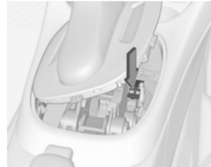
3. Den Entriegelungshebel nach unten drücken und den Wählhebel aus der Stellung **P** oder **N** bewegen. Wenn eine dieser Stellungen erneut eingelegt wird, wird der
