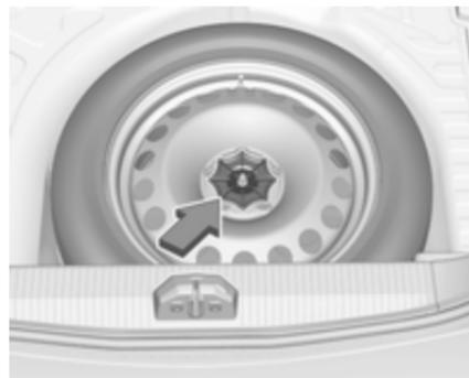
Das Reserverad befindet sich im Laderaum unter der Abdeckung des Laderaumbodens. Es ist mit einer Flügelmutter gesichert.
