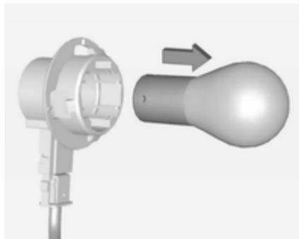
4. Die Lampe ausbauen. Hierzu die Lampe leicht in die Fassung drücken und gegen den Uhrzeigersinn drehen. Die Glühlampe ersetzen.
