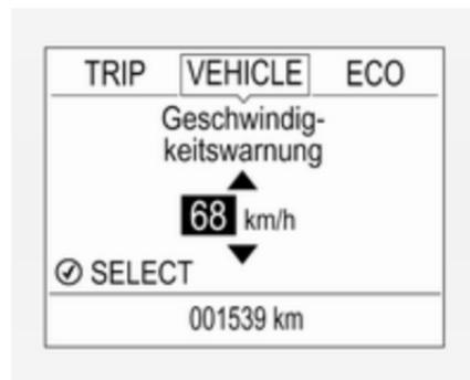
Die Geschwindigkeitswarnung ertönt, wenn eine eingestellte Geschwindigkeit überschritten wird.
