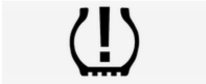
Wenn niedriger Reifendruck erkannt wird, wird dies durch die Kontrollleuchte (⚠) gemeldet ⇨ 94.
