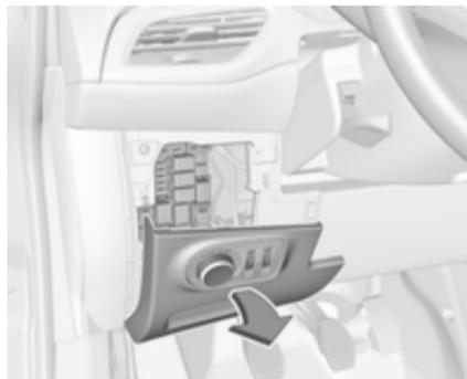
Der Sicherungskasten befindet sich hinter dem Lichtschalter in der Instrumententafel. Den Griff halten, daran ziehen und den Lichtschalter herunterklappen.
