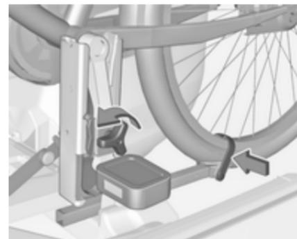
Spannbänder an beiden Fahrradreifen lösen.
