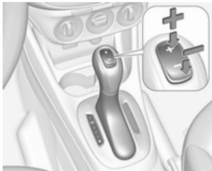
Den Wählhebel in Stellung **M** bringen. Am Wählhebel auf **+** drücken, um in einen höheren Gang zu schalten.
