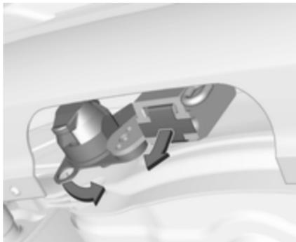
Steckdose ausrasten und nach unten klappen. Verschlussstopfen von der Öffnung für die Kugelstange entfernen und verstauen.
