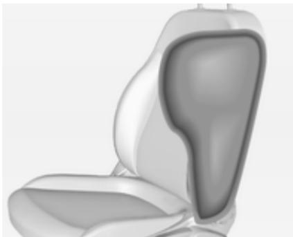
Der aufgeblähte Airbag dämpft den Aufprall, wodurch die Verletzungsfahr für Oberkörper und Becken bei einem Seitenaufprall deutlich verringert wird.
