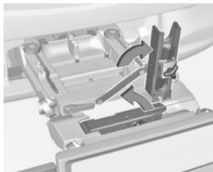
Eine oder beide Tretkurbelaufnahmen nach oben klappen, bis die diagonale Stütze einrastet.
