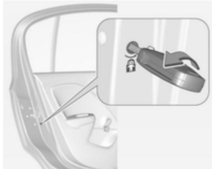
Den Knopf am Schloss der Hintertür mit einem Schlüssel oder einem geeigneten Schraubendreher in die waagerechte Stellung drehen. Jetzt lässt sich die Tür nicht mehr von innen öffnen.
