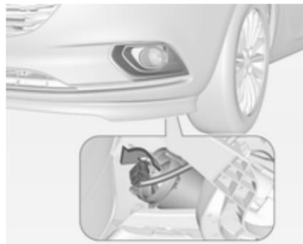
1. Die Lampenfassung linksherum drehen und aus dem Reflektor herausnehmen.
