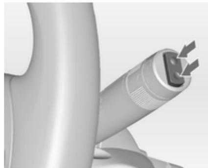
Zur Betätigung des Heckscheibenwischers Wippschalter drücken:
