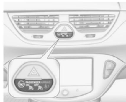
Wenn die Kontrollleuchte
