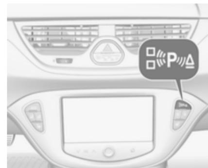
Fahrzeuge mit Front- und Heckeinparkhilfe und erweiterter Einparkhilfe sind an der Taste
