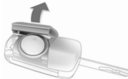
Schlüsselbart ausklappen und die Funkfernbedienung seitlich öffnen. Die Batterie austauschen (Batterietyp CR 2032). Die neue Batterie richtig einsetzen. Funkfernbedienung schließen und synchronisieren.
