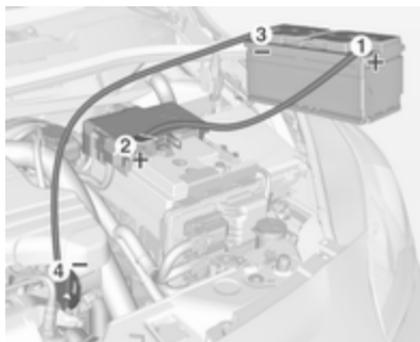
Reihenfolge für das Anschließen der Kabel:
