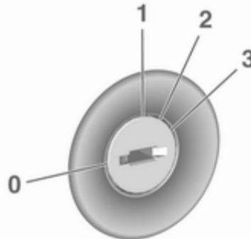
**0 = Zündung aus:** Einige Funktionen bleiben aktiv, bis der Schlüssel abgezogen oder die Fahrertür geöffnet wird, wenn die Zündung zuvor eingeschaltet war.
