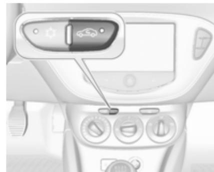
Zum Einschalten des Umluftbetriebs Taste drücken. Die Aktivierung wird durch das Leuchten der LED auf der Taste angezeigt.
