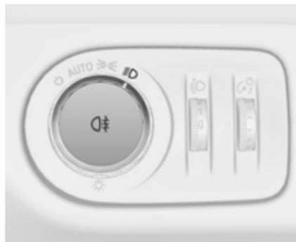
Wird durch Drücken der Taste **D** ein- bzw. ausgeschaltet.
