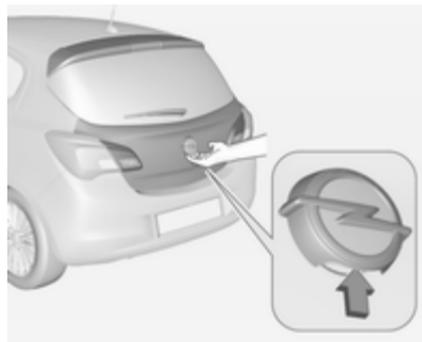
Zum Öffnen der Hecktür den Touchpad-Schalter unterhalb des Markenemblems betätigen.
