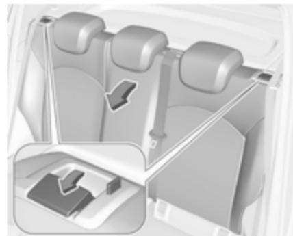
Die Sicherheitsgurte durch die seitlichen Halterungen führen, um sie vor Beschädigung zu schützen. Beim Umklappen der Rückenlehne die Sicherheitsgurte mitziehen.
