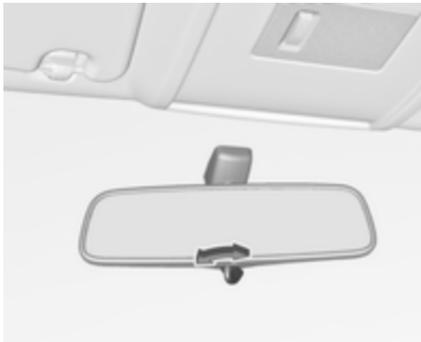
Zur Reduzierung der Blendwirkung Hebel an der Unterseite des Spiegelgehäuses verstellen.
