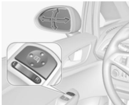
Mit dem Kippschalter den entsprechenden Außenspiegel auswählen und den Spiegel mit dem Bedienelement
