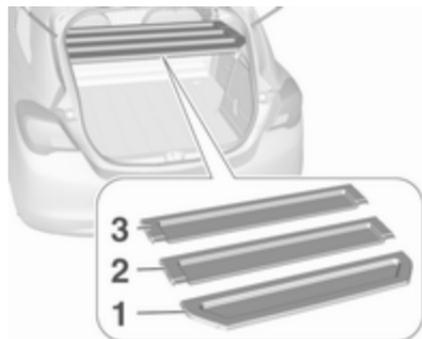
Die drei anderen Segmente zum Ausbau (Reihenfolge 1 bis 3) hinten anheben, ausrasten, verdrehen und herausnehmen.
