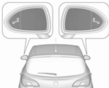
Die Funktion „Toter-Winkel-Warnung“ ist bei Geschwindigkeiten zwischen 10 km/h und 140 km/h aktiv. Bei Geschwindigkeiten über 140 km/h wird das System deaktiviert. Dies wird in beiden Außenspiegeln durch die Warnsymbole  $\text{A}^{\text{B}}$  angezeigt. Wird die Geschwindigkeit erneut reduziert, erlöschen die Warnsymbole. Wird daraufhin ein Fahrzeug im toten Winkel erkannt, leuchten die Warnsymbole  $\text{A}^{\text{B}}$  wie üblich auf der entsprechenden Seite auf.
