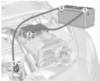
Reihenfolge für das Anschließen der Kabel:
