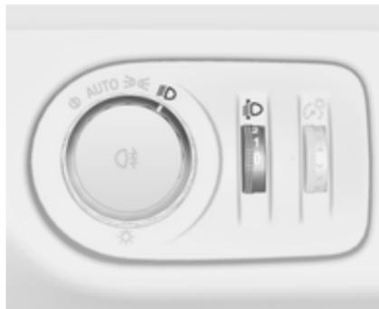
Zur Anpassung der Leuchtweite an die Fahrzeuglast, um Blendwirkung zu reduzieren: Daumenrädchen  $\text{D}$  in die gewünschte Stellung drehen.
