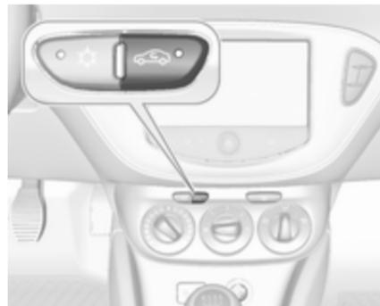
Zum Einschalten des Umluftbetriebs
