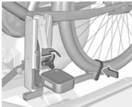
Spannbänder an beiden Fahrradreifen lösen.
