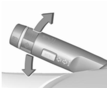
Hebel nach oben : Blinker rechts
