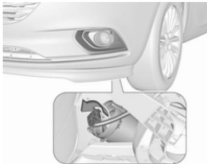
1. Die Lampenfassung linksherum drehen und aus dem Reflektor herausnehmen.
