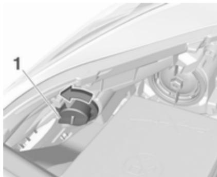
1. Lampenfassung (1) durch Drehen nach links austrasten.
