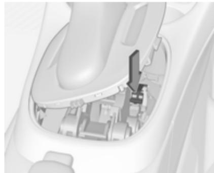
3. Den Entriegelungshebel nach unten drücken und den Wählhebel aus der Stellung **P** oder **N** bewegen. Wenn eine dieser Stellungen erneut eingelegt wird, wird der Wählhebel erneut gesperrt. Ursache für die Stromunterbrechung von einer Werkstatt beheben lassen.
