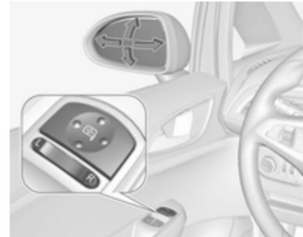
Den gewünschten Außenspiegel durch Drücken des Kippschalters nach links (**L**) bzw. rechts (**R**) auswählen. Danach das Bedienelement
