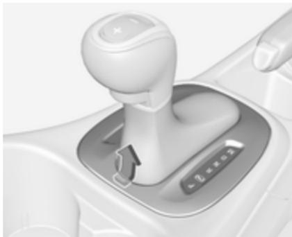
2. Die Verkleidung des Wählhebels von der Mittelkonsole entfernen. Mit einem Finger in die Lederhülse vor dem Wählhebel stoßen und die Verkleidung wie in der Abbildung dargestellt am vorderen Rand von unten nach oben drücken. Die Verkleidung links herum drehen.
