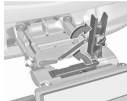
Eine oder beide Tretkurbelaufnahmen nach oben klappen, bis die diagonale Stütze einrastet.
