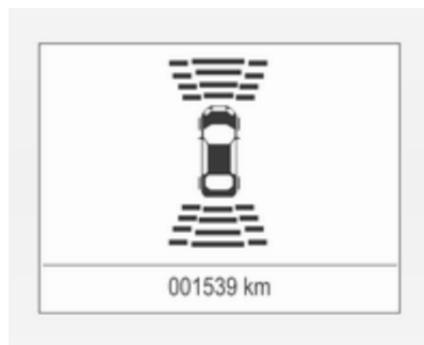
Der Abstand zu einem Hindernis hinter oder vor dem Fahrzeug wird durch Änderung der Abstandslinien im Driver Information Center angezeigt
