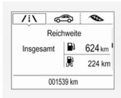
Anzeige der ungefähren Kraftstoffreichweite für jeden Kraftstofftank (LPG und Benzin). Ein niedriger Kraftstoffstand wird durch **Niedrig** im entsprechenden Bereich angezeigt.
