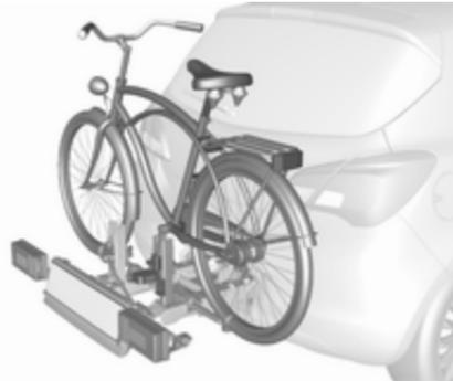
Das Heckträgersystem (Flex-Fix-System) bietet die Möglichkeit, Fahrräder auf einem in den Fahrzeugboden integrierten, herausziehbaren Träger zu befestigen. Der Transport anderer Gegenstände ist nicht zulässig.
