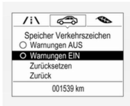
Bei angezeigter Einstellungsseite **Warnungen AUS** auswählen, um die Popup-Warnung zu aktivieren. Durch Auswahl von **Warnungen EIN** wird sie deaktiviert. Beim Einschalten der Zündung wird die Warnfunktion ausgeschaltet.
