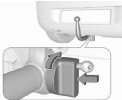
Schlüssel in Schloss stecken und Kugelstange aufschließen.
