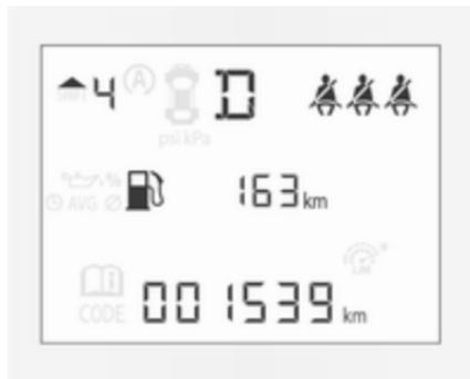
Die Menüseiten des Midlevel-Displays werden durch Drücken auf **MENU** am Blinkerhebel ausgewählt.
