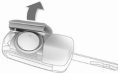
Schlüsselbart ausklappen und die Funkfernbedienung seitlich öffnen. Die Batterie austauschen (Batterietyp CR 2032). Die neue Batterie richtig einsetzen. Funkfernbedienung schließen und synchronisieren.
