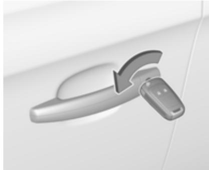
Fahrtür durch Drehen des Schlüssels im Schloss manuell entriegeln. Zündung einschalten und Zentralverriegelungstaste
