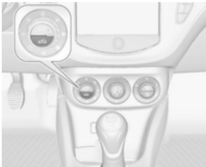
Zum Einschalten des Umluftbetriebs
