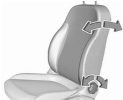
Handrad drehen. Beim Verstellen Rückenlehne entlasten.
