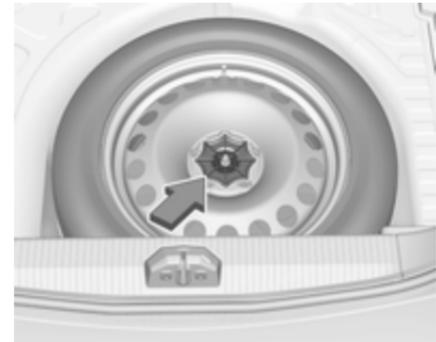
Das Reserverad befindet sich im Laderaum unter der Abdeckung des Laderaumbodens. Es ist mit einer Flügelmutter gesichert.
