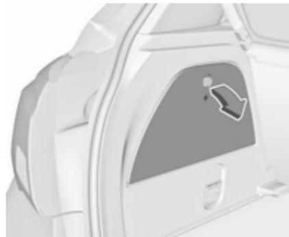
1. Die Abdeckung im Laderaum auf der entsprechenden Seite lösen und entfernen.
