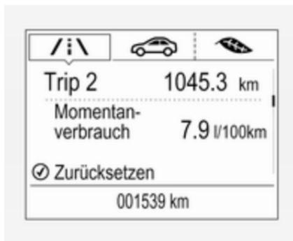
Die Menüseiten des Uplevel-Displays werden durch Drücken auf **MENU** am Blinkerhebel ausgewählt. Die Symbole des Hauptmenüs sind in der obersten Displayzeile zu sehen:
