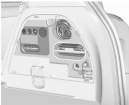
1. Dichtmittelflasche und Halter mit Luftschlauch aus dem Einsatz nehmen.
