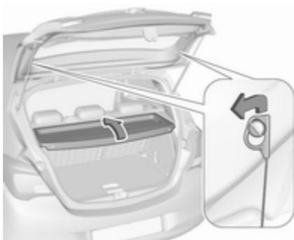
Befestigungsgurte von Hecktür lösen.
