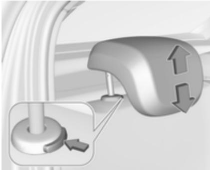
Kopfstütze nach oben ziehen und einrasten lassen. Zum Absenken auf die Verriegelung drücken und die Kopfstütze nach unten drücken.
