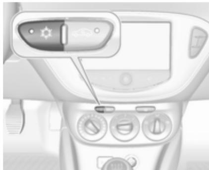
☀ drücken, um die Kühlung einzuschalten. Die Aktivierung wird durch das Leuchten der LED auf der Taste angezeigt. Die Kühlung ist nur bei laufendem Motor und eingeschaltetem Klimatisierungsgebläse funktionsfähig.
