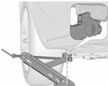
4. Den Wagenheber auf die erforderliche Höhe einstellen. Den Wagenheber direkt unter der Aufnahme positionieren, damit er nicht abrutschen kann.
