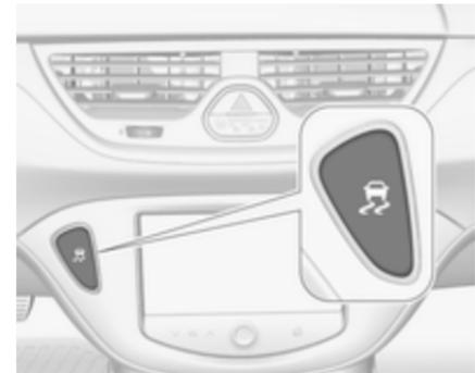
Die Traktionskontrolle kann ausgeschaltet werden, wenn ein Durchdrehen der Antriebsräder erwünscht ist:
