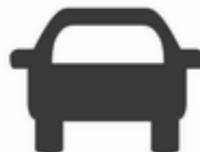
Ein vorausfahrendes Fahrzeug wird durch die Kontrollleuchte
