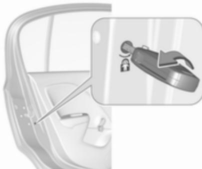
Den Schalter am Schloss der Hintertür mit einem Schlüssel oder einem geeigneten Schraubendreher in die waagerechte Stellung drehen. Jetzt lässt sich die Tür nicht mehr von innen öffnen.
