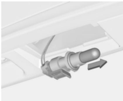
3. Lampenfassung durch Drehen nach links aus dem Leuchtengehäuse herausnehmen.
