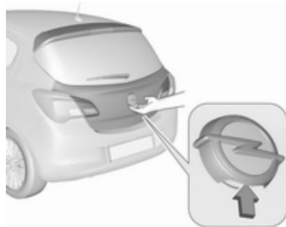
Zum Öffnen der Hecktür den Touchpad-Schalter unterhalb des Markenemblems betätigen.
