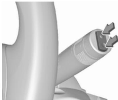
Zur Betätigung des Heckscheibenwischers Wippschalter drücken:
