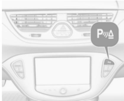
Wenn die LED in der Einparkhilfe-Taste **P** mit einem Dreieck leuchtet, ist das System betriebsbereit.
