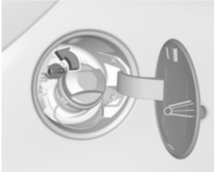
Die Schutzkappe vom Einfüllstutzen abschrauben.
