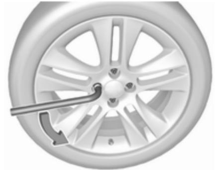
2. Radschraubenschlüssel ansetzen und sicherstellen, dass er gut sitzt. Die Radschrauben jeweils eine halbe Umdrehung lösen. Die Räder können mit Felgenschlössern verriegelt werden. Zum Lösen dieser Schrauben zuerst den Felgenschlossadapter anbringen und erst dann den Radschraubenschlüssel ansetzen. Der Adapter befindet sich im Handschuhfach.
