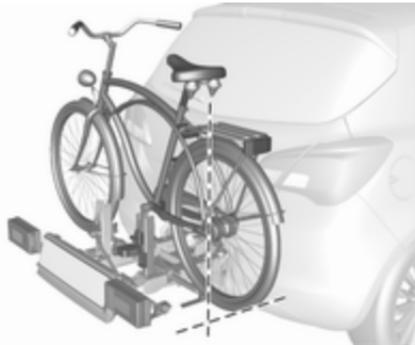
Fahrrad in Fahrzeuginnenrichtung ausrichten: Tretlagerfixierung etwas lösen.
