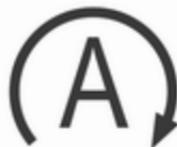
Ein Autostopp wird durch die Kontrollleuchte <sup>(A)</sup> angezeigt.
