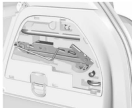
Der Wagenheber, der Radbolzenschlüssel und einige Werkzeuge sind rechts im Laderaum hinter einer Abdeckung verstaut ↗ 73.
