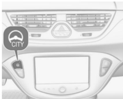
Bei laufendem Motor ☹️ drücken. Das System ist im Stillstand, bis zu einer Geschwindigkeit von 35 km/h und im Rückwärtsgang aktiv. Sobald diese Geschwindigkeit überschritten wird, wechselt das System in den normalen Modus. Wenn die Funktion aktiviert ist, wird der City-Modus bei einer Geschwindigkeit unter 35 km/h automatisch eingeschaltet.
