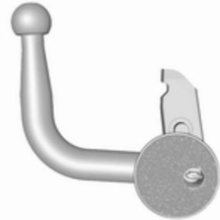
Schutzkappe über den Drehgriff mit Schlüssel stecken.
