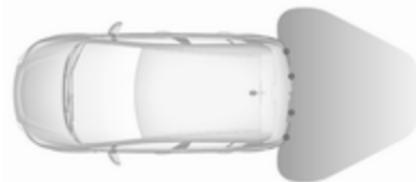
Das System besteht aus vier Ultraschall-Parksensoren im hinteren Stoßfänger.
