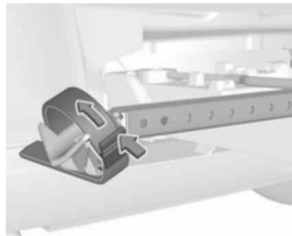
Entriegelungshebel am Spannband drücken und Spannband herausziehen.
