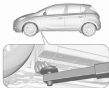
Position des vorderen Arms der Hebebühne am Unterboden.
