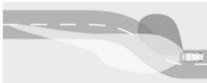
Je nach Lenkwinkel und Geschwindigkeit werden spezielle LED zusätzlich eingeschaltet, um in Kurven das Scheinwerferlicht zu verbessern. Die Funktion wird bei einer Geschwindigkeit zwischen 40 km/h und 70 km/h aktiviert.
