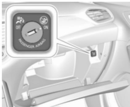
Das Beifahrer-Airbag-System lässt sich durch einen schlüsselbetätigten Schalter im Handschuhfach deaktivieren.
