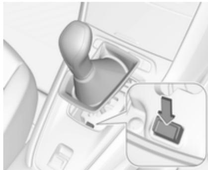
3. Taste nach unten drücken und den Wählhebel aus der Stellung **P** bringen. Ursache der Stromunterbrechung von einer Werkstatt beheben lassen.
