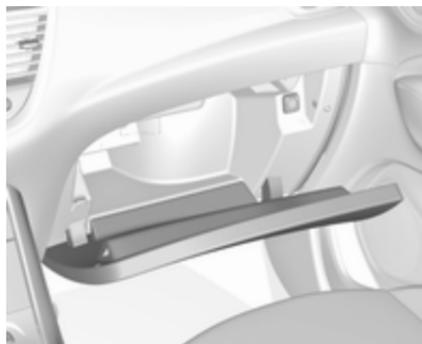
Bei einigen Versionen ist das Handschuhfach belüftet. Belüftung und Temperatur hängen von den Einstellungen des Klimatisierungssystems ab. Die Belüftungsdüse im Handschuhfach kann geschlossen werden ➔ 139.
