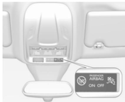
Wenn die Kontrollleuchte
