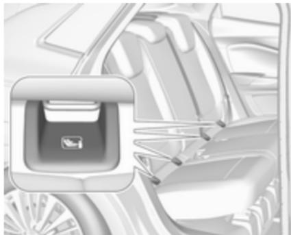
Für das Fahrzeug zugelassene ISOFIX-Kindersicherheitssysteme an ISOFIX-Befestigungshalterungen befestigen. Die speziellen Positionen für ISOFIX-Kindersicherheitssysteme sind in der Tabelle mit ISOFIX gekennzeichnet ↷ 68.
