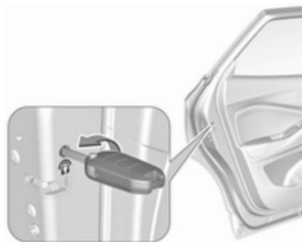
Die Kindersicherung in der Hintertür mit einem Schlüssel in die horizontale Position drehen. Die Tür kann anschließend von innen nicht geöffnet werden.
