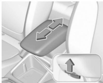
Die Armlehne kann um 10 cm nach vorn verschoben werden. Am Griff ziehen, um die Armlehne zu verschieben. Unter der Armlehne befindet sich ein Staufach.
