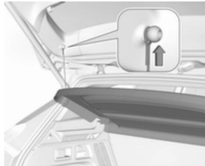
Haltebänder von der Heckklappe lösen.
