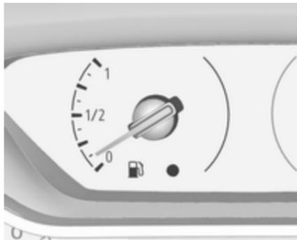
Zeigt den Füllstand im Kraftstofftank an.
