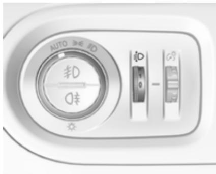
Um die Leuchtweite an die Fahrzeugbelastung anzupassen und so die Blendwirkung zu reduzieren, das Daumenrad
