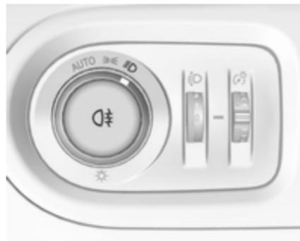
Wird durch Drücken von  $\#D$  bedient. Lichtschalter auf **AUTO**: Beim Einschalten der Nebelschlussleuchte werden die Scheinwerfer automatisch eingeschaltet.
