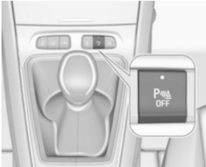
Beim Ausrücken des Rückwärtsgangs wird das System ausgeschaltet. Um das System manuell zu deaktivieren,  $P_{\text{OFF}}$  drücken. Bei deaktiviertem System leuchtet die LED in der Taste. Wenn das System manuell deaktiviert
