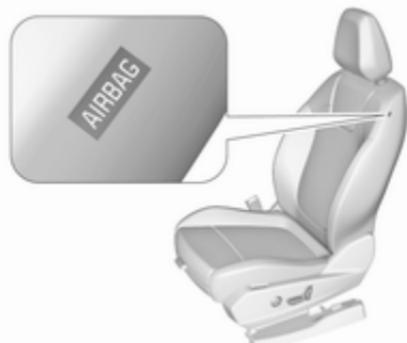
Das Seiten-Airbag-System besteht aus einem Airbag in der Rückenlehne jedes Vordersitzes. Diese Stellen sind mit dem Wort **AIRBAG** gekennzeichnet.
