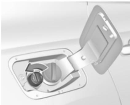
4. Die Schutzkappe vom Einfüllstutzen abschrauben.
