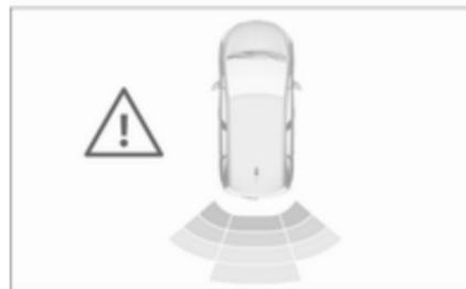
Außerdem wird die Entfernung zu Hindernissen hinter dem Fahrzeug durch veränderliche Abstandslinien im Info-Display ↻ 107 angezeigt. Wenn der Abstand zum Hindernis sehr klein ist, wird das Gefahrensymbol  $\Delta$  angezeigt.
