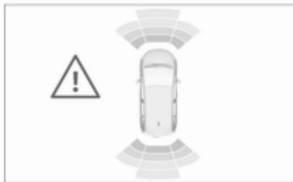
Außerdem wird die Entfernung zu Hindernissen hinter bzw. vor dem Fahrzeug durch veränderliche Abstandslinien im Info-Display ⇨ 107 angezeigt.
