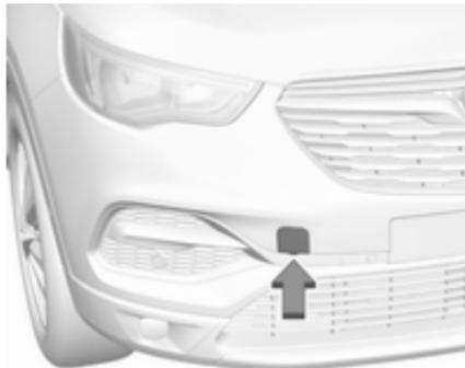
Entfernen Sie den Verschlussdeckel.
