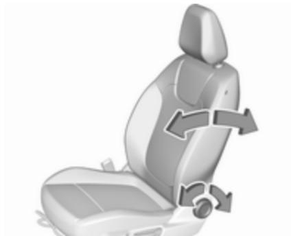
Handrad drehen. Zum Einstellen Rückenlehne entlasten.
