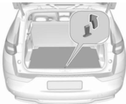
Die hintere Bodenabdeckung kann angehoben und entfernt werden. Abdeckung an der Schlaufe anheben und herausnehmen.
