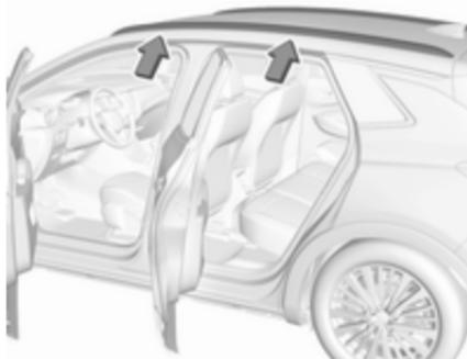
Den Dachgepäckträger im Dachgepländer über den Befestigungspunkten befestigen, die sich in den Türrahmen der Fahrzeugkarosserie befinden.
