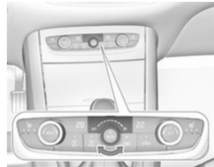
Den Luftstrom durch Drehen des Drehrings auf die gewünschte Geschwindigkeit einstellen. Zum Senken linksherum, zum Erhöhen rechtsherum drehen. Die Gebläsezahl kann ebenfalls im Menü der Klimatisierungseinstellungen geändert werden. Zum Öffnen des Menüs auf **MENU** drücken.
