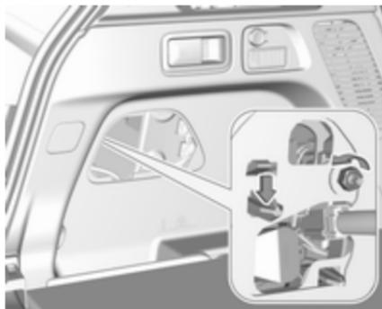
2. Die Leuchtenbefestigungsmutter mit einem Steckschlüssel lösen.
