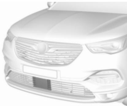
Die Radareinheit befindet sich in der Mitte des vorderen Stoßfängers.
