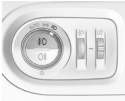
Wird durch Drücken von  $\#D$  bedient. Lichtschalter auf **AUTO**: Beim Einschalten der Nebelleuchten werden die Scheinwerfer automatisch eingeschaltet.
