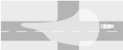
Wird automatisch bei Geschwindigkeiten bis ca. 55 km/h und in Situationen mit Außenumgebungslicht akti-
