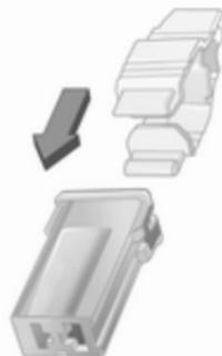
Sicherungszieher von oben oder seitlich auf die verschiedenen Ausführungen von Sicherungen stecken und Sicherung herausziehen.
