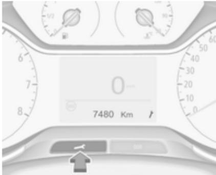
Nach dem Einschalten der Zündung wird ein erforderlicher und fälliger Service im Driver Information Center sieben Sekunden lang angezeigt.
