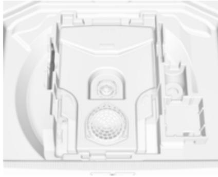
Die Abschleppöse und Unterlegkeile befinden sich in einem Kasten unter der Bodenabdeckung im Laderaum.
