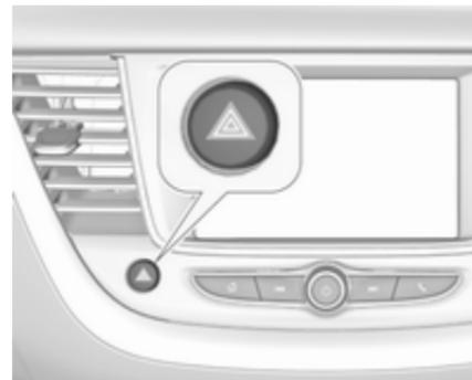
Wird durch Drücken von
