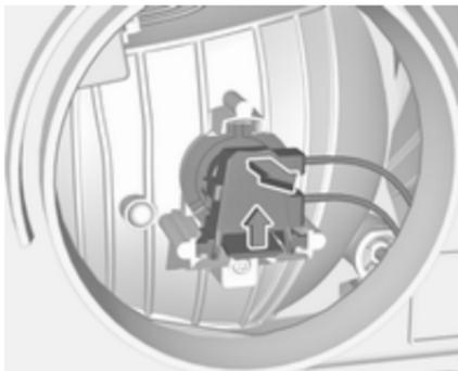
2. Halteklammer nach oben drücken und Lampenfassung nach hinten ziehen.
