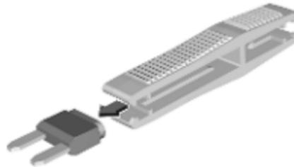
Die Sicherung mit dem Sicherungsabzieher greifen und herausziehen.
