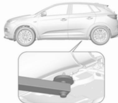
Hintere Arme der Hebebühne mittig unter den entsprechenden Wagenheberaufnahmen positionieren.
