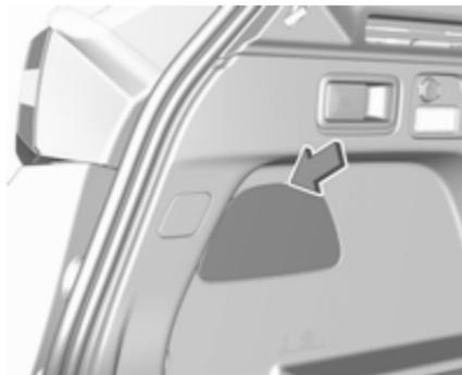
1. Die Heckklappe öffnen und die Zugangsabdeckung auf der betreffenden Seite abclipsen.
