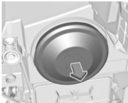
1. Die Schutzabdeckung durch Ziehen entfernen.
