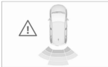
Außerdem wird der Abstand zu Hindernissen hinter dem Fahrzeug durch sich ändernde Abstandslinien im Info-Display angezeigt ↻ 103. Bei einem sehr geringen Abstand wird das Warnsymbol ⚠ angezeigt.
