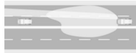
Der Fernlichtassistent beinhaltet einen speziellen Autobahnmodus. Wird auf Autobahnen schneller als 115 km/h gefahren, verkleinert sich der Lichtstrahl, damit der entgegenkommende Verkehr nicht geblendet wird. Bei vorausfahrenden Fahrzeugen bzw. beim Überholen wird der andere Verkehrsteilnehmer weniger geblendet.
