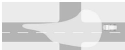
Wird automatisch bei Geschwindigkeiten bis ca. 55 km/h und in Situationen mit Außenumgebungslicht aktiviert. Das Licht ist weit und symmetrisch. Unter 30 km/h werden die Scheinwerfer leicht nach außen geschwenkt, um Fußgänger und Hindernisse am Straßenrand leichter erkennen zu können. Eine spezielle Lichtverteilung sorgt dafür, dass andere Straßenbenutzer nicht geblendet werden.
