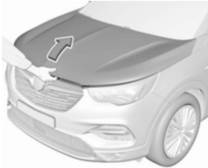
Schnappriegel hochdrücken und Motorhaube öffnen.
