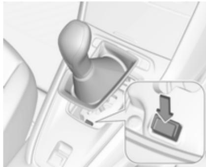
3. Die Taste drücken und den Wählhebel in Position **P** bewegen. Ursache für die Stromunterbrechung von einer Werkstatt beheben lassen.
