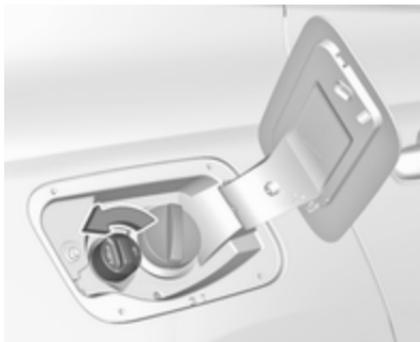
4. Die Schutzkappe vom Einfüllstutzen abschrauben.
