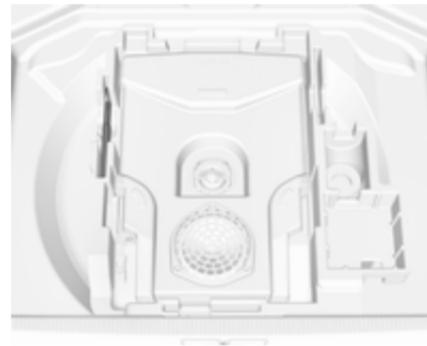
Die Abschleppöse und die Unterlegkeile befinden sich in einem Behälter unter der Bodenabdeckung im Laderaum.
