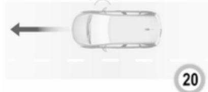
Wird eine freie Parklücke erkannt, wird im Info-Display eine visuelle Rückmeldung angezeigt und es ertönt ein erster Signalton. Langsam vorwärts fahren. Beim zweiten Signalton Fahrzeug anhalten, Rückwärtsgang einlegen, Lenkrad loslassen und langsam anfahren. Im Info-Display wird eine optische Rückmeldung gegeben.
