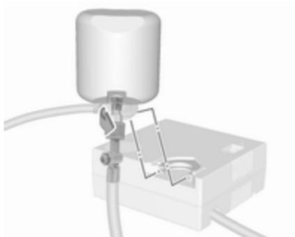
4. Den Kompressorluftschlauch an den Anschluss an der Dichtmittelflasche schrauben.
