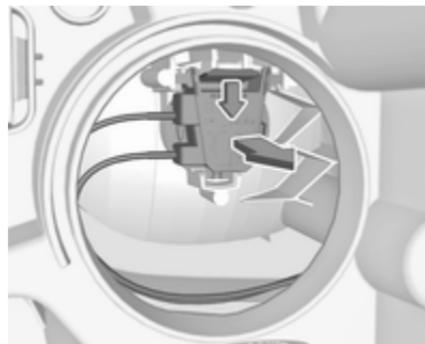
2. Die Halteklammer nach unten drücken und die Lampenfassung nach hinten ziehen.
