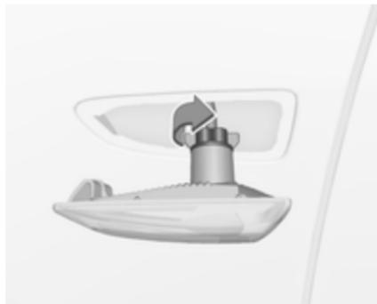
2. Lampenfassung nach rechts drehen und aus dem Gehäuse entfernen.
