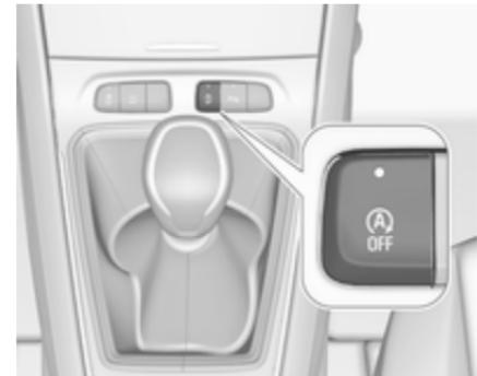
Die Stopp-Start-Automatik lässt sich durch Drücken von
