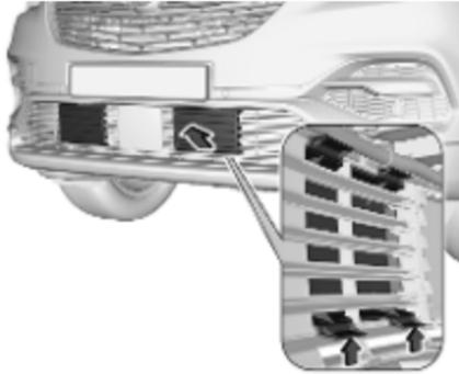
1. Halterungen der Schutzabdeckung innen im Kühlergrill mit der Hand nach oben drücken, um die Schutzabdeckung zu lösen.
