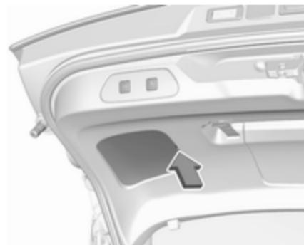
1. Heckklappe öffnen und Abdeckung entfernen.
