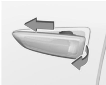
1. Das Lampengehäuse nach vorn schieben und an der Rückseite entfernen.
