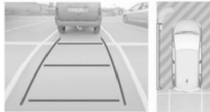
Der Bildschirm im Info-Display ist zweigeteilt. Rechts erscheint ein Bild des Fahrzeugs von oben, links die Ansicht von hinten oder vorn. Die Einparksensoren ergänzen die Informationen zur Ansicht von oben.
