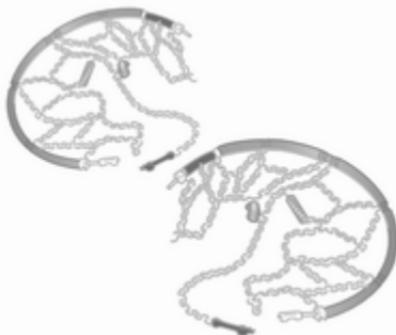
Schneeketten dürfen nur auf den Vorderrädern verwendet werden. Immer engmaschige Schneeketten verwenden, die an der Lauffläche und an den Reifeninnenseiten (einschließlich Kettenschloss) maximal 9 mm aufragen.
