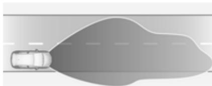
Wird bei einer Geschwindigkeit über 115 km/h automatisch aktiviert. Die Leuchtweite wird an die höhere Autobahngeschwindigkeit angepasst. Ohne Gegenverkehr wird die Sicht auf der Fahrzeugseite erhöht. Die Leuchtweite wird von 70 auf 140 m erhöht, damit entfernte Objekte auf der gesamten Straßenbreite erkannt werden können.
