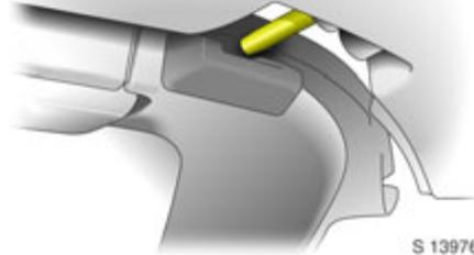
Das Softtop ganz in geschlossene Position ziehen oder drücken und darauf achten, dass die vorderen Schließbolzen korrekt in den Öffnungen auf beiden Seiten des Windschutzscheibenrahmens einrasten.
