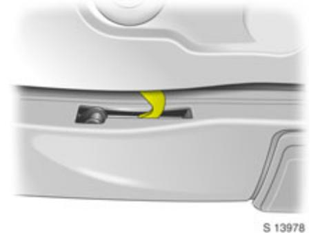
Darauf achten, dass der Haltehaken korrekt in seiner Öffnung ausgerichtet ist, bevor der Verriegelungshebel eingeführt wird.
