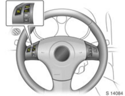
Auf die gewünschte Geschwindigkeit beschleunigen, die Taste
