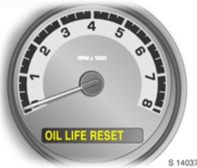
Die Motoröl-Lebensdaueranzeige zeigt Ihnen an, wann das Öl gewechselt werden muss. Je nach Fahrbedingungen kann die Kilometerleistung, nach der ein Ölwechsel angezeigt wird, sehr unterschiedlich sein.
