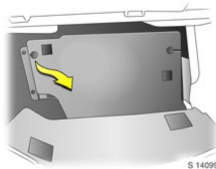
Die Abdeckung zum Öffnen von der linken Seite von den Klettverschlüssen abziehen und herausnehmen.
