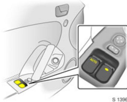
Fahrer- und Beifahrerfenster werden mit den Schaltern im Fahrertürgriff betätigt.
