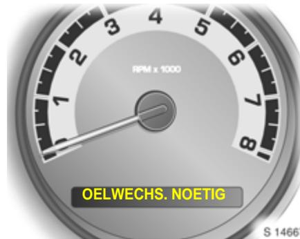
Die Motoröl-Lebensdaueranzeige zeigt Ihnen an, wann das Motoröl gewechselt werden muss. Je nach Fahrbedingungen kann die Kilometerleistung, nach der ein Motorölwechsel angezeigt wird, sehr unterschiedlich sein.
