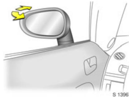
Zur Sicherheit für Fußgänger klappen die Außenspiegel bei Anstoßen aus ihrer Ausgangslage. Durch leichten Druck wieder einrasten.
