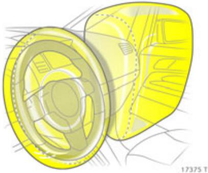
Beim Auslösen blähen sich die Airbags innerhalb weniger Millisekunden auf und bilden Schutzpolster für Fahrer und Beifahrer. Die Vorwärtsbewegung der Insassen wird kontrolliert und die Verletzungsgefahr für Oberkörper und Kopf deutlich verringert.
