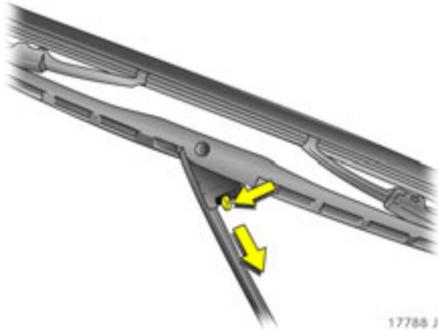
Zum Austausch des Wischerblatts den Wischerarm von der Windschutzscheibe abheben, Entriegelungshebel betätigen und Wischerblatt abziehen.
