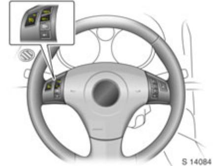
Auf die gewünschte Geschwindigkeit beschleunigen, die Taste 9 drücken und loslassen: Die aktuelle Geschwindigkeit wird gespeichert und beibehalten.
