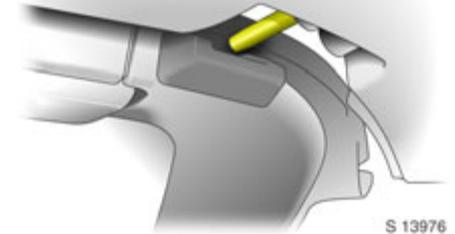
Das Softtop ganz anheben und darauf achten, dass die Ausrichtungszapfen korrekt auf beiden Seiten des Windschutzscheibenrahmens und auf beiden Seiten der Karosserie in der Nähe der Rückenlehnen sitzen.
