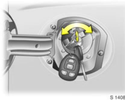
Kraftstoffeinfüllstutzen an der linken Fahrzeugseite hinten.
