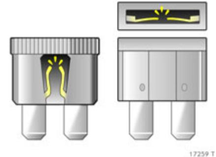
Eine defekte Sicherung ist erkennbar am durchgebrannten Schmelzfaden. Sicherung nur dann ersetzen, wenn die Ursache für die Störung behoben wurde.
