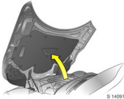
Motorhaube zum vollständigen Öffnen von der Kante an der Windschutzscheibe aus hochziehen. Die Motorhaube wird von Druckluftaufstellern in geöffneter Position gehalten.
