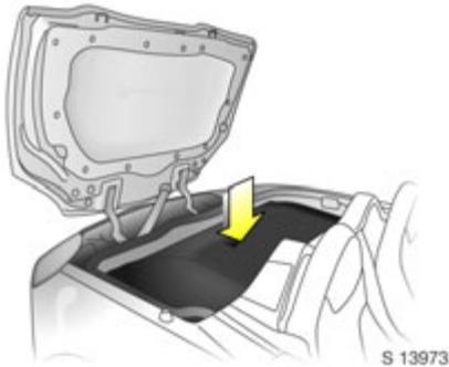
Damit sich der Gepäckraumdeckel korrekt schließen lässt, durch gleichmäßiges Drücken auf die Mitte des Softtops dafür sorgen, dass es richtig verstaut ist.
