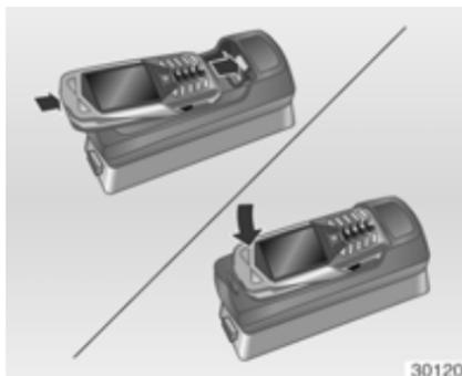
Mobiltelefon in den Adapter einsetzen.
