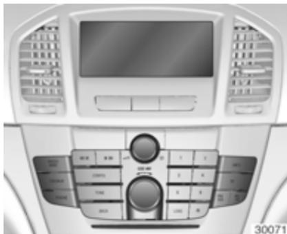
Das Infotainment System wird über Funktionstasten, Multifunktionsknöpfe und im Display angezeigte Menüs bedient.
