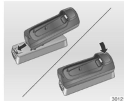
Adapter an der Basisplatte befestigen.
