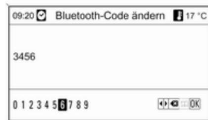
**Bluetooth-Code ändern** wählen. Im angezeigten Menü den aktuellen Bluetooth-Code bearbeiten und den geänderten Code mit **OK** bestätigen.
