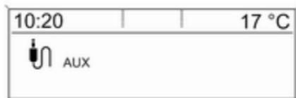
Eine Audioquelle, die an den AUX-Eingang angeschlossen ist, kann ausschließlich mit den Bedienelementen der Audioquelle bedient werden.
