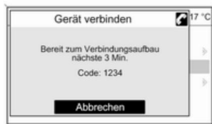
**Gerät hinzufügen (Freisprechen)** wählen. Der am Mobiltelefon einzugebende Bluetooth-Code wird angezeigt.
