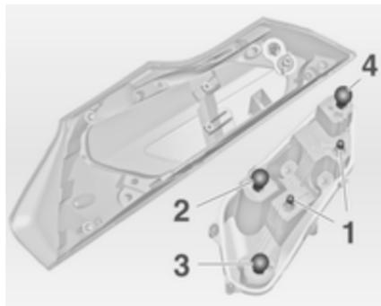
6. Glühlampe etwas in die Fassung hineindrücken, nach links drehen und herausnehmen. Neue Glühlampe einsetzen.
