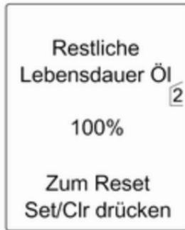
Im Uplevel- und Uplevel-Kombi-Display wird die restliche Öllebensdauer im **Fahrzeug Informationsmenü** angezeigt.
