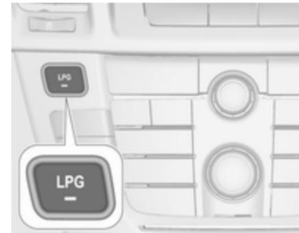
Durch Drücken der Taste **LPG** kann zwischen Benzin- und Flüssiggasbetrieb umgeschaltet werden. Die LED-Statusleuchte
