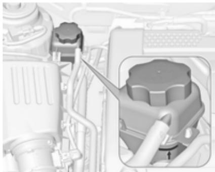
Bei kaltem Kühlsystem muss der Kühlmittelspiegel über der Fülllinienmarkierung liegen. Bei zu niedrigem Füllstand auffüllen.
