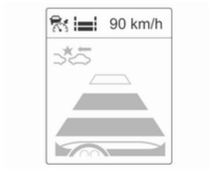
Beachten Sie, dass die Einstellung der Warnempfindlichkeit mit der Abstandswarnung des adaptiven Geschwindigkeitsreglers zusammenhängt. Durch Ändern der Warnempfindlichkeit wird auch die Einstellung der Abstandswarnung des adaptiven Geschwindigkeitsreglers geändert.
