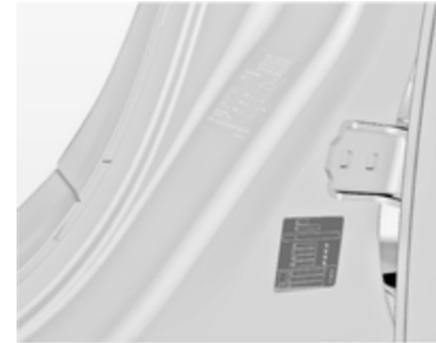
Das Typenschild befindet sich am linken Vordertürrahmen.
