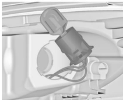
3. Glühlampe aus der Fassung nehmen und neue Glühlampe einsetzen.
