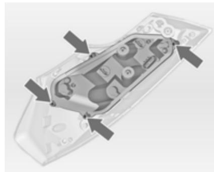
5. Zum Wechseln der anderen Leuchten die Schrauben lösen und Lampenträger herausnehmen.
