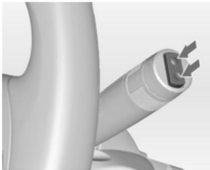
Zum Betätigen des Heckscheibenwischers Wippschalter drücken:
