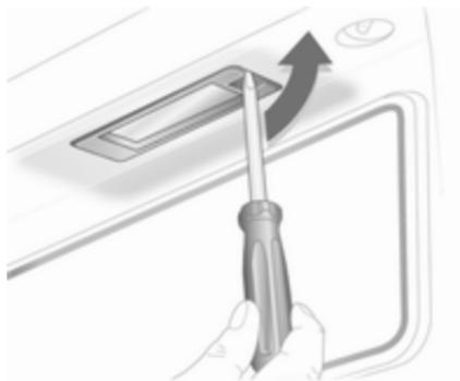
1. Schraubendreher in das Lampengehäuse einstecken, zur Seite drücken und Feder entriegeln.
