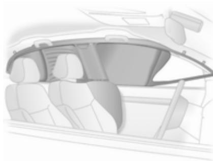
Der aufgeblähte Airbag dämpft den Aufprall, wodurch die Verletzungsfahr für den Kopf bei einem Seitenaufprall deutlich verringert wird.
