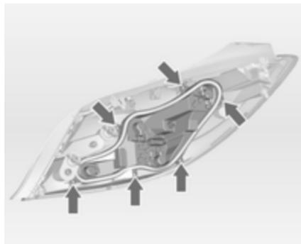
4. Schrauben lösen und Lampenfassung herausnehmen.
