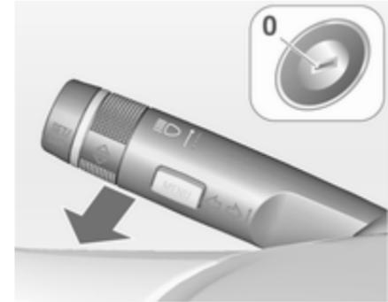
Scheinwerfer, Rückleuchten und Kennzeichenleuchte beleuchten für eine einstellbare Zeit nach dem Verlassen des Fahrzeugs die Umgebung.
