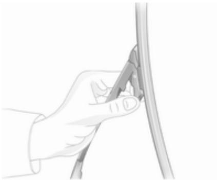
Wischerarm anheben, beide Riegel am Wischerarm drücken, Wischerblatt ausrasten und abziehen.
