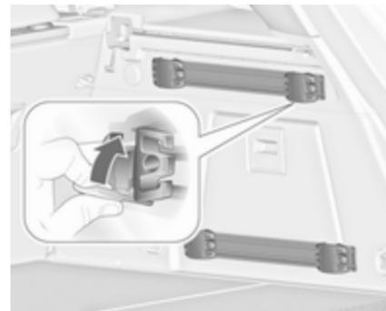
Die Griffplatte aufklappen, den Adapter in die obere und untere Nut der Schiene einsetzen und in die gewünschte Position bringen. Die Griffplatte zum Arretieren des Adapters
