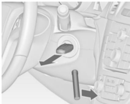
3. Das Spezialwerkzeug zur Fahrzeugvorderseite drehen und Schlüssel aus dem Zündschloss abziehen. Möglicherweise sind mehrere Versuche nötig, um den Schlüssel erfolgreich abzuziehen.
