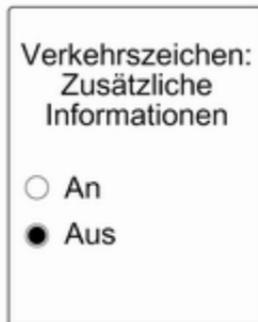
Bei angezeigter Einstellungsseite **Aus** auswählen, um die Popup-Funktion auszuschalten. Durch Auswahl von **An** wird sie wieder eingeschaltet. Beim Einschalten der Zündung wird die Popup-Funktion deaktiviert.
