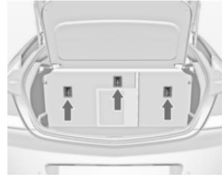
Zusätzlich zur ISOFIX-Befestigung den Top-Tether-Befestigungsgurt an den Top-Tether-Befestigungsösen verankern. Der Gurt muss zwischen den beiden Führungsstangen der Kopfstütze verlaufen.
