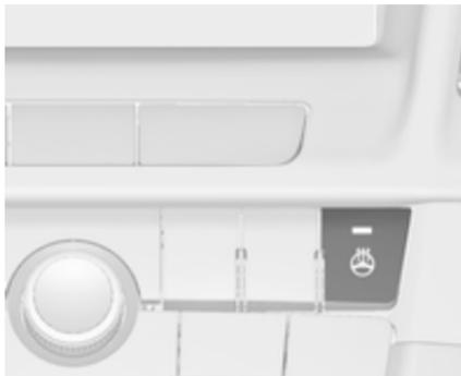
Die Heizung durch Drücken der Taste
