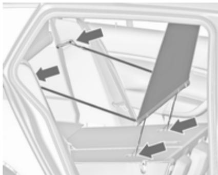
Die Haken der schmalen Gurte in die Top-Tether Befestigungsschlaufen auf der Rückseite der umgeklappten Rücksitzlehnen einhängen.
