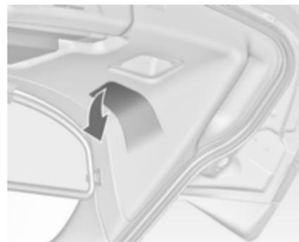
1. Abdeckung in der Hecktür lösen und öffnen.
