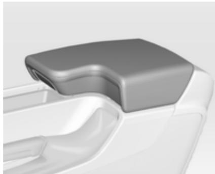
Taste drücken und Armlehne nach oben klappen. Unter der Armlehne befindet sich ein Staufach.
