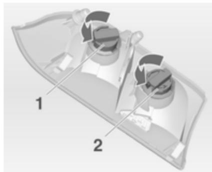
4. Kunststoffmutter nach links drehen und vom Lampenträger abnehmen.
