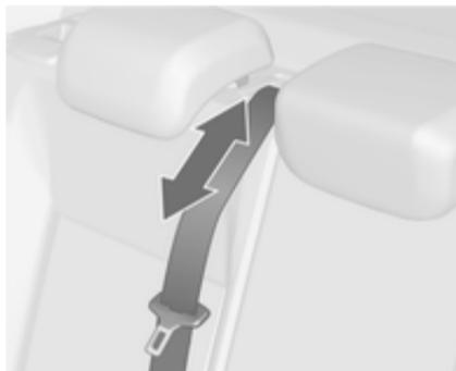
Der Sicherheitsgurt des Mittelsitzes könnte blockiert werden, wenn die Rückenlehne zu schnell hochklappt wird. Um den Aufroller zu entsperren, Sicherheitsgurt ca. 20 mm hineindrücken oder herausziehen, und dann loslassen.
