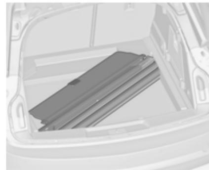
Laderaumabdeckung mit der Oberseite nach unten und mit dem Entsperrhebel nach vorne rechts in die Aushöhlung setzen.
