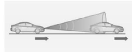
Der adaptive Geschwindigkeitsregler arbeitet mit einem Radarsensor zum Erkennen der vorausfahrenden Fahrzeuge. Wird kein Fahrzeug in der Fahrspur erkannt, arbeitet der adaptive Geschwindigkeitsregler wie ein herkömmlicher Geschwindigkeitsregler.
