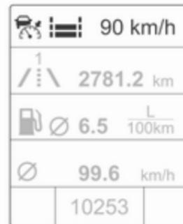
Das Symbol für den adaptiven Geschwindigkeitsregler, der eingestellte Sicherheitsabstand und die festgelegte Geschwindigkeit werden in der obersten Zeile des Driver Information Center angezeigt.
