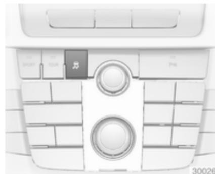
Für extremes Hochleistungsfahren kann die ESC deaktiviert werden: Taste
