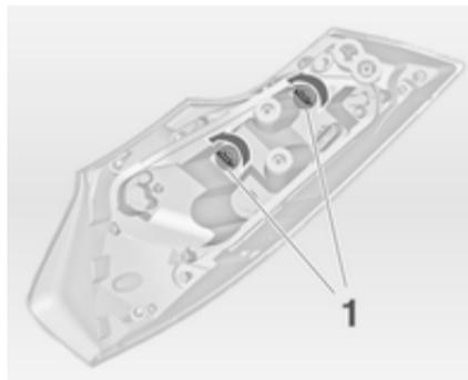
4. Die Rückleuchten bestehen aus zwei Glühlampen. Um eine der Glühlampen zu wechseln, die Kunststoffmutter (1) nach links drehen und vom Lampenträger entfernen.
