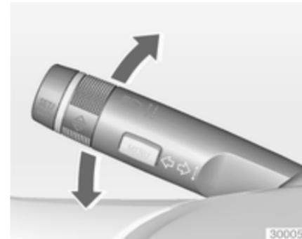
Hebel nach oben = Blinker rechts
