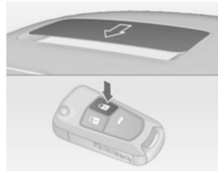
Zum Schließen des Schiebedachs die Taste
