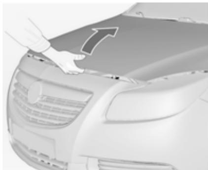
Verschlusshaken nach rechts ziehen und Motorhaube öffnen.
