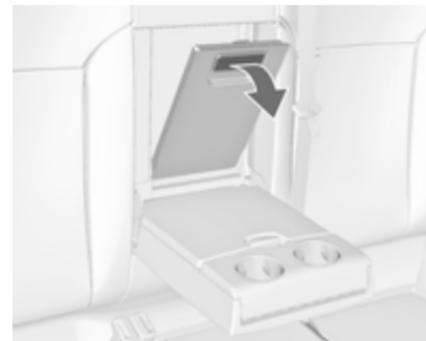
Griff ziehen und Abdeckung öffnen. Eignet sich für den Transport von langen, schmalen Gegenständen. Sicherstellen, dass die Abdeckung nach dem Hochklappen einrastet.
