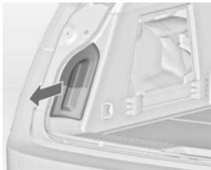
3. Lampengehäuse von innen aus der Seitenverkleidung herausdrücken.
