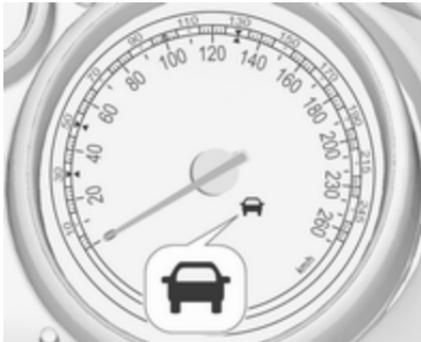
Wenn das System ein vorausfahrendes Fahrzeug in der Fahrspur erkennt, leuchtet die Kontrollanzeige für ein erkanntes vorausfahrendes Fahrzeug 🚗 grün im Tachometer auf.
