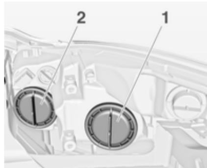
Scheinwerfer haben getrennte Systeme für Fernlicht **2** (innere Lampen) und Abblendlicht **1** (äußere Lampen).
