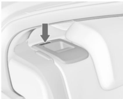
Die Rückenlehnen sind korrekt eingerastet, wenn beide roten Markierungen auf der Seite neben dem Entriegelungsgriff nicht mehr sichtbar sind.
