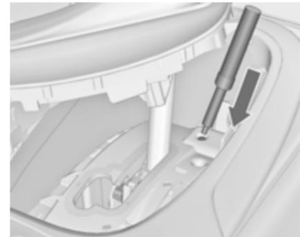
4. Werkzeug so weit wie möglich in die Öffnung einführen und den Wählhebel aus der Stellung **P** bzw. **N** bewegen. Wenn **P** bzw. **N** wieder eingelegt wird, wird der Wählhebel wieder in dieser Stellung gesperrt. Ursache für die Stromunterbrechung von einer Werkstatt beheben lassen.
