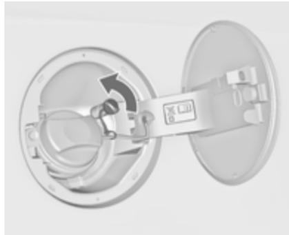
Die Schutzkappe vom Einfüllstutzen abschrauben.
