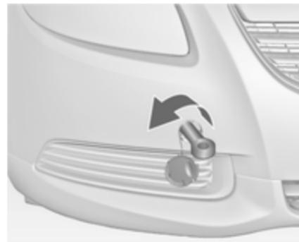
Abschleppöse bis zum Anschlag in waagerechter Stellung einschrauben. Abschleppseil - besser Abschleppstange - an der Abschleppöse befestigen.
