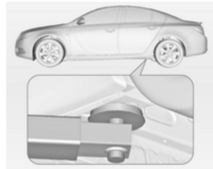
Anhebestelle für hinteren Arm der Hebeplattform am Unterboden.
