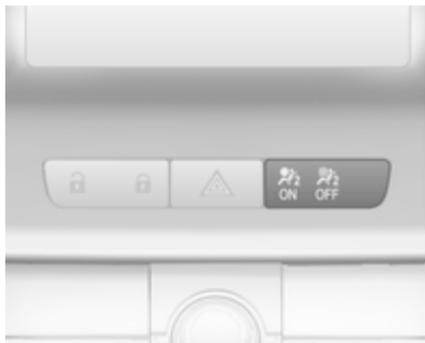
Solange die Kontrollleuchte
