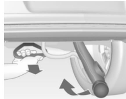
Den Griff unter der hinteren Stoßfängerverkleidung links des Nummernschildes in einem Winkel von etwa 45° Richtung Boden ziehen.
