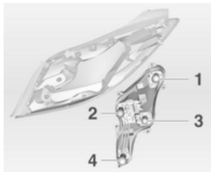
5. Glühlampe etwas in die Fassung hineindrücken, nach links drehen und herausnehmen. Neue Glühlampe einsetzen.
