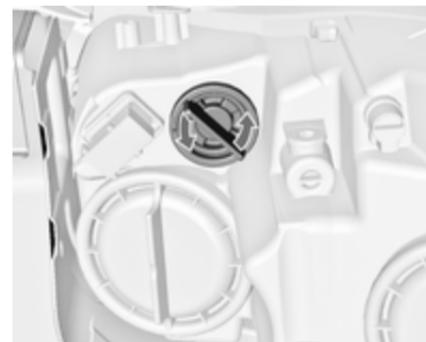
1. Lampenträger nach links drehen und lösen.
