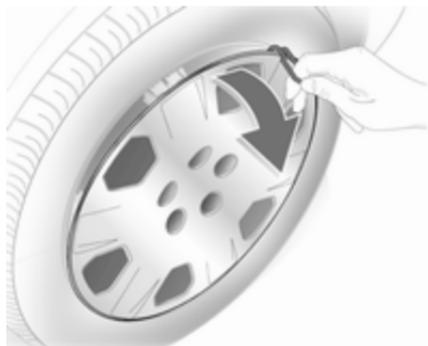
1. Radmutternkappen mit Schraubendreher lösen und abnehmen. Radabdeckung mit dem Haken abziehen. Wagenwerkzeug ↗ 228.
