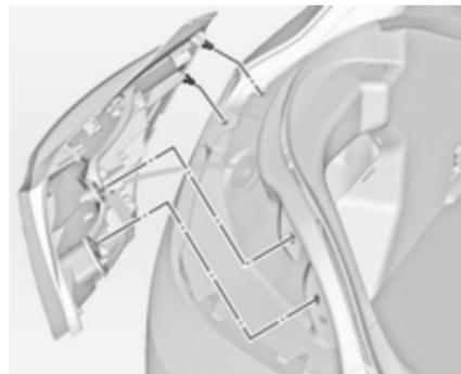
3. Lampengehäuse herausnehmen. Aufpassen, dass der Kabelkanal nicht verschoben wird. Stecker von Lampenfassung abziehen.
