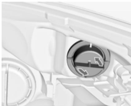
1. Lampenträger nach links drehen und lösen.
