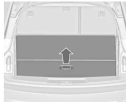
Den Laderaumboden durch Ziehen am Griff öffnen. Den Boden zusammenfalten und hinter den Rücksitzen verstauen.
