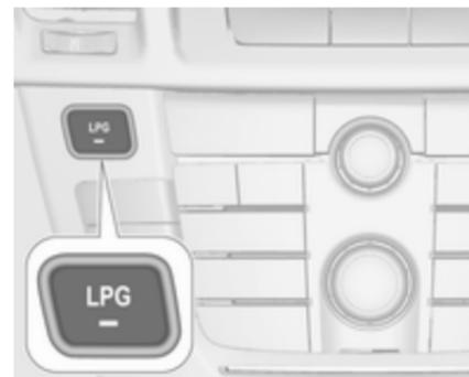
Taste **LPG** drücken, um zwischen Benzin- und Flüssiggasbetrieb umzuschalten, sobald die erforderlichen Parameter (Kühlmitteltemperatur, Gastemperatur und Mindestdrehzahl des Motors) erreicht sind. Die Anforderungen sind normalerweise nach etwa 60 Sekunden (je nach Außentemperatur) und der ersten festen Betätigung des Gaspedals erreicht. Der LED-Status zeigt den aktuellen Betriebsmodus.
