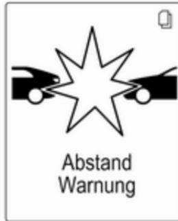
Beim zu schnellen Heranfahren an ein vorausfahrendes Fahrzeug wird die Auffahrwarnungsmeldung im Driver Information Center angezeigt. Gleichzeitig ertönt ein Warnton. Betätigen sie das Bremspedal, wenn es die Situation erfordert.
