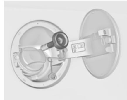
**ACME Adapter:** Die Mutter der Einfülldüse auf den Adapter schrauben. Den Sperrhebel auf der Einfülldüse nach unten drücken.
