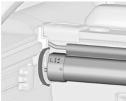
Kassette zum Entriegeln leicht nach hinten drehen und nach oben aus den Aufnahmen nehmen.
