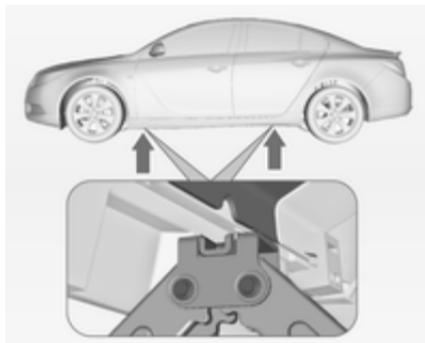
3. Sicherstellen, dass der Wagenheber richtig unter dem entsprechenden Ansatzpunkt ausgerichtet ist.
