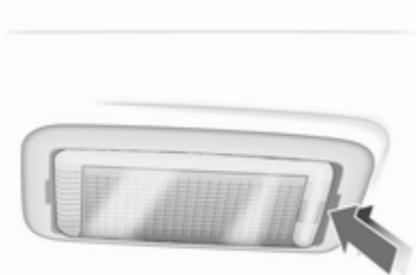
1. Leuchte mit Schraubendreher lösen und herausnehmen.
