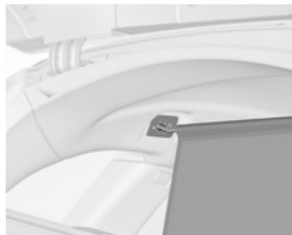
Netz aus der Kassette ziehen und Netzstange auf einer Seite in die hintere Aufnahme im Dachrahmen einrasten. Netzstange zusammendrücken und auf der anderen Seite einrasten.
