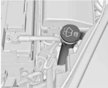
Mit einem Gemisch aus sauberem Wasser und einer geeigneten Menge frostschutzmittelhaltiger Waschflüssigkeit auffüllen. Das richtige Mischungsverhältnis ist auf dem Behälter der Waschflüssigkeit angegeben.
