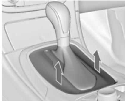
2. Wählhebelverkleidung hinten von der Mittelkonsole lösen, nach oben klappen und nach links drehen.
