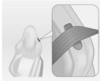
Den Sicherheitsgurt beim Anlegen durch die Gurtführung an der Rückenlehne führen.
