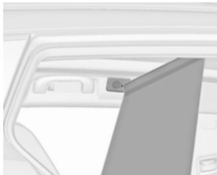
Vordere Aufnahmen im Dachrahmen: Stange auf einer Seite einrasten, Stange zusammendrücken und auf der anderen Seite einrasten.
