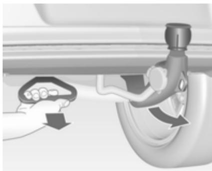
Den Griff unter der hinteren Stoßfängerverkleidung links des Nummernschildes in einem Winkel von etwa 45° Richtung Boden ziehen.
