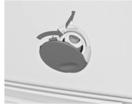
Abdeckung am Boden einsetzen, im Uhrzeigersinn leicht drehen und schließen.
