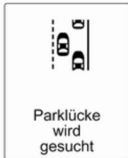
Wenn das Fahrzeug bei aktiviertem System an einer Reihe geparkter Autos vorbeifährt, beginnt die erweiterte Einparkhilfe nach einer geeigneten Parklücke zu suchen. Wird eine geeignete Parklücke entdeckt, erfolgen eine optische Rückmeldung und ein akustisches Signal im Driver Information Center.
