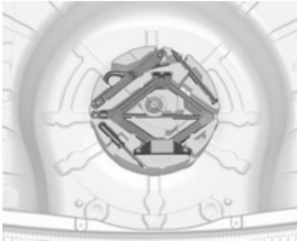
Der Wagenheber inkl. Radschlüssel, das Wagenwerkzeug, der Verlängerungsbolzen zur Befestigung des schadhaften Rades und die Abschleppöse befinden sich im Werkzeugkasten, welcher unterhalb des Reserverads im Laderaum verstaut ist. Reserverad ↗ 240.
