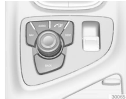
Eine Funktion mit den Tasten der Multifunktionseinheit auswählen. Das Menü der gewählten Funktion wird angezeigt.
