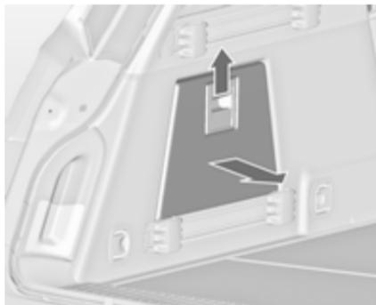
2. Abdeckung in Seitenverkleidung lösen und herausnehmen.
