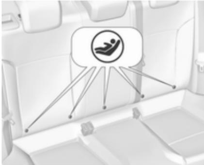
Für das Fahrzeug zugelassene ISOFIX Kindersicherheitsysteme an ISOFIX Befestigungsbügel befestigen. Die speziellen Positionen für ISOFIX Kindersicherheitsysteme sind in der Tabelle mit IL gekennzeichnet.
