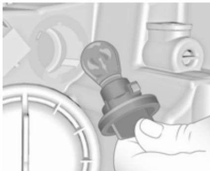
2. Glühlampe etwas in die Fassung hineindrücken, nach links drehen und herausnehmen. Neue Glühlampe einsetzen.
