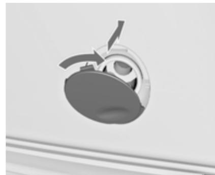
Abdeckung am Boden einsetzen, im Uhrzeigersinn leicht drehen und einrasten.
