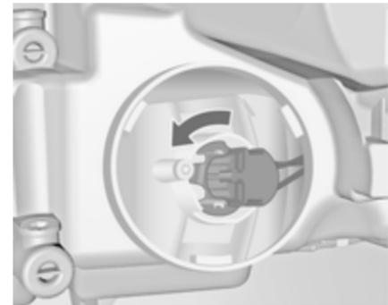
2. Lampenträger zum Lösen nach links drehen. Lampenträger aus dem Reflektor herausnehmen.
