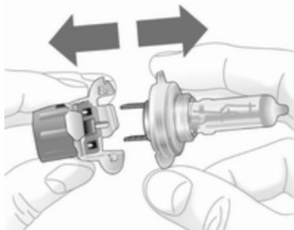
3. Glühlampe aus dem Lampenträger ziehen und neue Glühlampe einsetzen.
