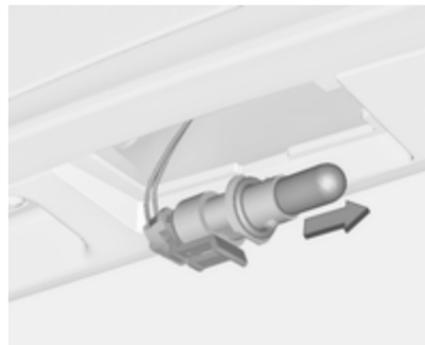
3. Die Lampenfassung nach links drehen, um sie aus dem Lampengehäuse zu entfernen.
