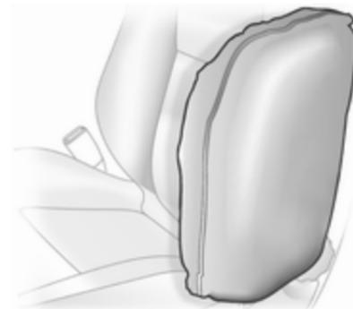
Der aufgeblähte Airbag dämpft den Aufprall, wodurch die Verletzungsgefahr für Oberkörper und Becken bei einem Seitenaufprall deutlich verringert wird.
