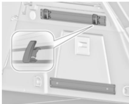
Den Haken in gewünschte Position zuerst in der oberen Nut der Schiene einsetzen und dann in die untere Nut hineindrücken. Zum Abnehmen zuerst aus der oberen Nut herausziehen.
