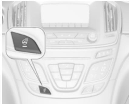
Die Heizung durch Drücken der Taste
