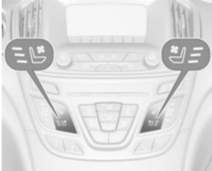
Je nach gewünschter Lüftungsleistung die Taste
