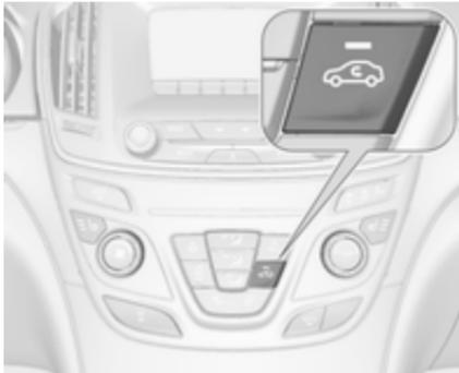
Zum Einschalten des Umluftbetriebs Taste
