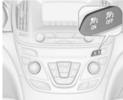
Solange die Kontrollleuchte
