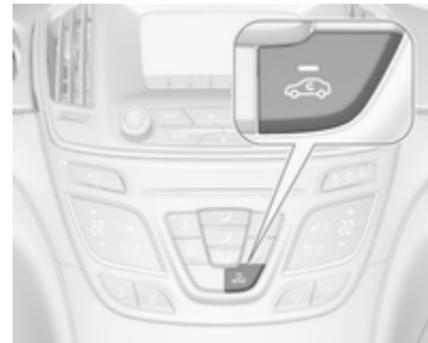
Zum Einschalten des Umluftbetriebs Taste
