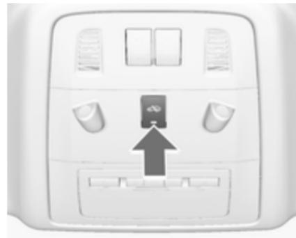
Wenn Tiere im Fahrzeug zurückgelassen werden, muss die Überwachung des Fahrzeuginnenraums und der Fahrzeugneigung abgeschaltet werden, weil laute Ultraschallsignale oder Bewegungen den Alarm auslösen Auch ausschalten, wenn das Fahrzeug auf einer Fähre oder einem Zug transportiert wird.
