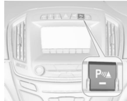
Beim Einlegen des Rückwärtsgangs wird die Front- und Heck-Einparkhilfe aktiviert.
