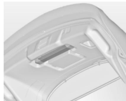
Warndreieck in der Aussparung hinter den Befestigungsgurten an der Innenseite der Heckklappe aufbewahren.
