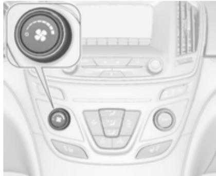
Luftstrom durch Drehen des Reglers
