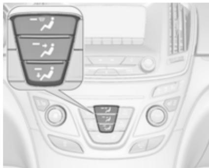
Entsprechende Taste für die gewünschte Einstellung drücken. Die Betätigung wird durch die LED auf der Taste angezeigt.
