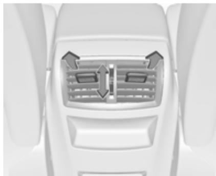
Die Belüftungsdüsen für die hintere Sitzreihe befinden sich in der Mittelkonsole zwischen den Vordersitzen.
