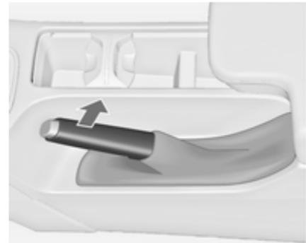
Parkbremse immer ohne Betätigung des Entriegelungsknopfes fest anziehen; bei Gefälle oder Steigung so fest wie möglich anziehen.
