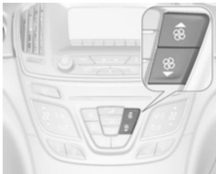
Drücken Sie auf
