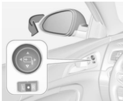
Bedienelement auf ● stellen und Schaltknopf ▽ hinunterdrücken. Beide Außenspiegel werden eingeklappt.
