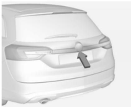
Zum Öffnen der Heckklappe den Touchpad-Schalter unter der Heckklappenleiste drücken, bis die Klappe geöffnet wird.
