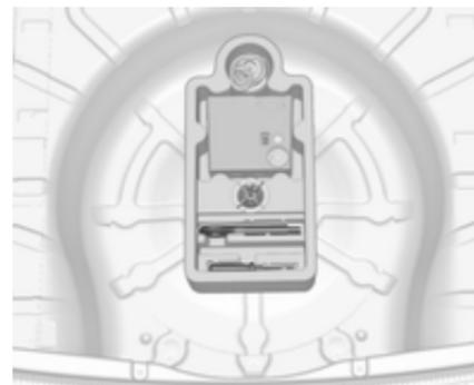
Das Wagenwerkzeug und die Abschleppöse befinden sich zusammen mit dem Reifenreparaturset in einem Werkzeugkasten unter der Abdeckung des Laderaumbodens.
