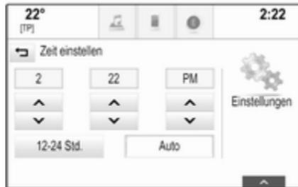
Bildschirmtaste „Automatische Einstellung“ unten im Display wählen. Ein - RDS-Modus oder Aus - Manuell-Modus auswählen.
