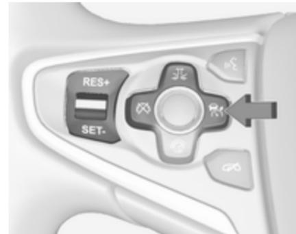
Zum Einschalten des adaptiven Geschwindigkeitsreglers Taste drücken. Die Kontrollleuchte oder im Instrument leuchtet weiß.
