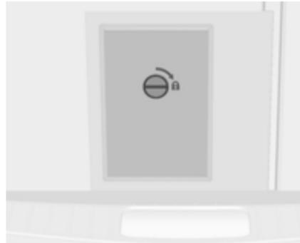
Die geschlossene Abdeckung kann im Laderrauminneren gesichert werden. Knopf um 90° drehen:
