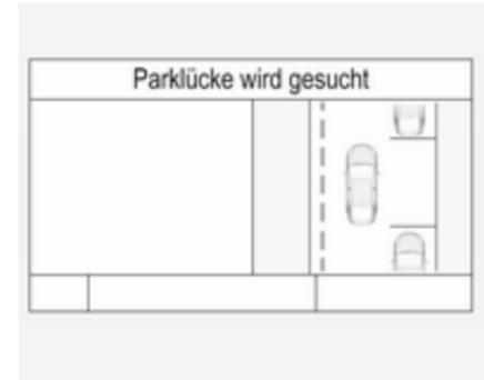
Wenn das Fahrzeug bei aktiviertem System an einer Reihe geparkter Autos vorbeifährt, beginnt die erweiterte Einparkhilfe nach einer geeigneten Parklücke zu suchen. Wird eine geeignete Parklücke entdeckt, erfolgen eine optische Rückmeldung und ein akustisches Signal im Driver Information Center.
