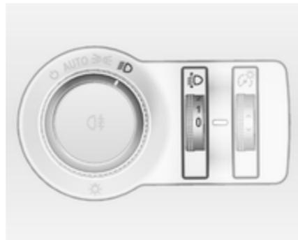
Zur Anpassung der Leuchtweite an die Fahrzeuglast, um Blendwirkung zu reduzieren: Daumenrädchen
