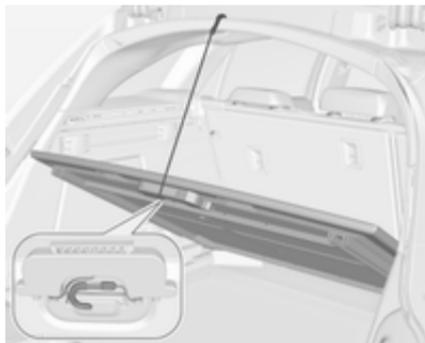
Um Zugang zum Reserverad bzw. Reifenreparaturset zu erhalten, Laderaumboden anheben und Halteriemmen an der Oberkante der Hecktür in der Vertiefung einhängen. Laderaumboden nur unbeladen anheben und oben fixieren.
