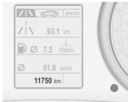
Die erfasste Gesamtfahrstrecke wird in km angezeigt.
