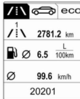
Die Menüseiten des Baselevel-Displays werden durch Drücken auf die Taste **MENU** am Blinkerhebel ausgewählt. Die Symbole des Hauptmenüs sind in der obersten Displayzeile zu sehen:
