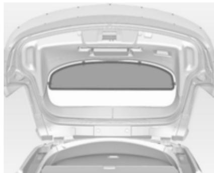
Um den Laderaum komplett abzudecken, die Blende an vier Befestigungspunkten an der Innenseite der Heckklappe anbringen.
