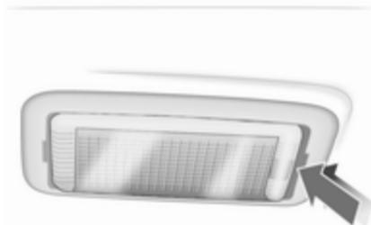
1. Leuchte mit Schraubendreher lösen und herausnehmen.
