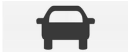
Wenn das System ein vorausfahrendes Fahrzeug in der Fahrspur erkannt hat, leuchtet die Kontrollleuchte für ein erkanntes vorausfahrendes Fahrzeug
