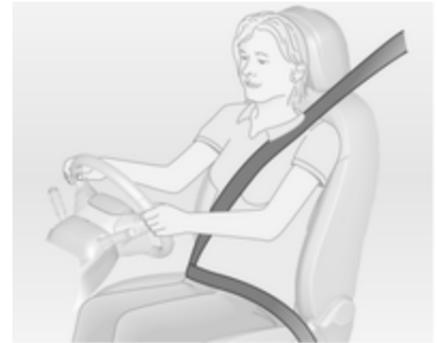
Bei starker Beschleunigung oder Verzögerung des Fahrzeugs blockieren die Sicherheitsgurte, um die Insassen in Sitzposition zu halten. Dadurch wird die Verletzungsgefahr deutlich verringert.
