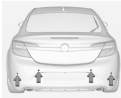
Die Front-Heck-Einparkhilfe misst die Entfernung zwischen dem Fahrzeug und Hindernissen vor und hinter dem Fahrzeug. Das System gibt akustische Signale aus und zeigt Meldungen auf dem Display an.
