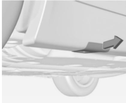
3. Bei einigen Modellen ist der Ansatzpunkt abgedeckt. Abdeckung seitlich herausziehen.
