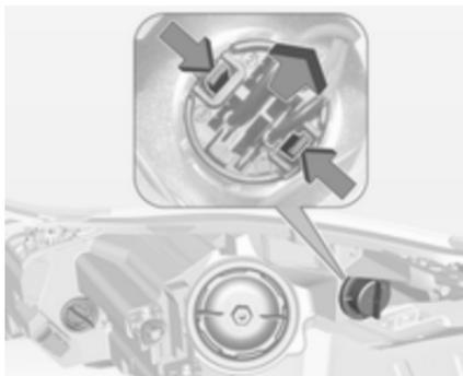
2. Haltetaschen zusammendrücken und Fassung aus dem Gehäuse ziehen.
