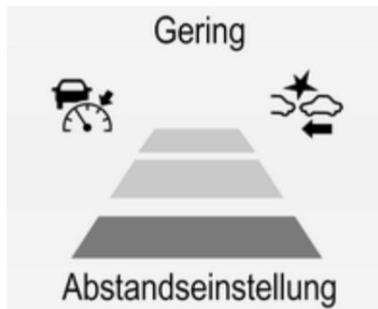
Der ausgewählte Sicherheitsabstand wird durch ausgefüllte Abstandsbalken auf der Seite des adaptiven Geschwindigkeitsreglers angezeigt.
