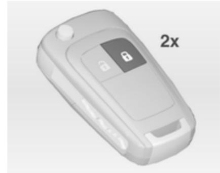
Funkfernbedienung oder elektronischer Schlüssel: zweimal innerhalb von 5 Sekunden auf drücken.
