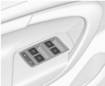
Zum Deaktivieren der elektrischen Fensterbetätigung für die hinteren Fenster Schalter
