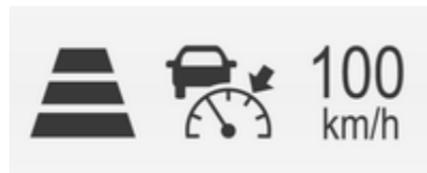
Das Symbol für den adaptiven Geschwindigkeitsregler, der eingestellte Sicherheitsabstand und die eingestellte Geschwindigkeit werden im Driver Information Center angezeigt.
