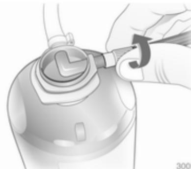
4. Kompressor-Luftschlauch an den Anschluss der Dichtmittelflasche schrauben.
