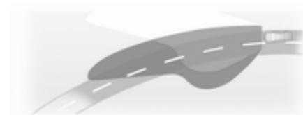
Der Lichtstrahl wird auf Basis des Lenkwinkels und der Geschwindigkeit geschwenkt, was die Ausleuchtung von Kurven verbessert.
