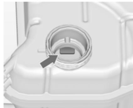
Bei einer anderen Ausführung befindet sich die Fülllinienmarkierung in der Einfüllöffnung. Zum Prüfen den Verschlussdeckel abnehmen.
