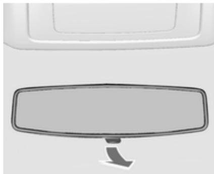
Hebel an der Unterseite verstellen, um die Blendwirkung zu reduzieren. Innenspiegel ↻ 41, automatisch abblendender Innenspiegel ↻ 41.
