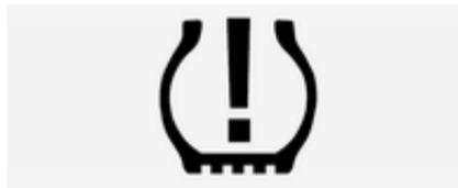
Wenn niedriger Reifendruck erkannt wird, wird dies durch die Kontrollleuchte (⚠) gemeldet ⇨ 112.
