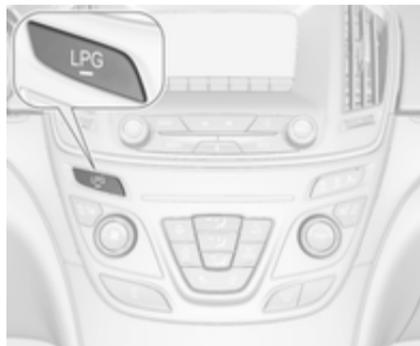
Taste **LPG** drücken, um zwischen Benzin- und Flüssiggasbetrieb umzuschalten, sobald die erforderlichen Parameter (Kühlmitteltemperatur, Gastemperatur und Mindestdrehzahl des Motors) erreicht sind. Die Anforderungen sind normalerweise nach etwa 60 Sekunden (je nach Außentemperatur) und der ersten festen Be-
