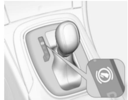
Ohne Betätigung des Bremspedals leuchtet die Kontrollleuchte
