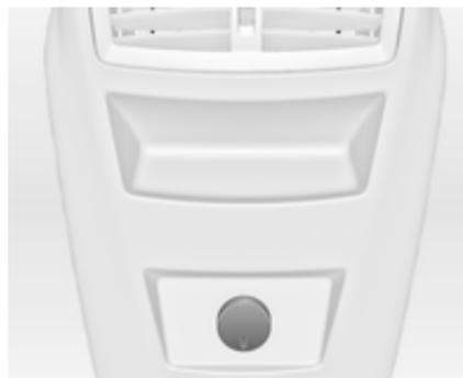
Die maximale Leistungsaufnahme darf 120 Watt nicht überschreiten.
