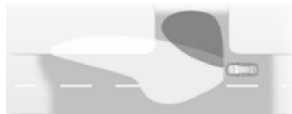
In engen Kurven oder beim Abbiegen wird abhängig vom Lenkwinkel oder dem Blinkersignal links oder rechts ein zusätzlicher Reflektor eingeschaltet, der die Straße im rechten Winkel zur Fahrtrichtung ausleuchtet. Er wird bei Geschwindigkeiten von bis zu 40 km/h aktiviert.
