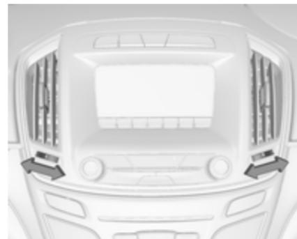
Zum Öffnen der Düse Einstellrädchen auf **I** drehen. Die Einstellung der Luftmenge am Düsenausgang erfolgt durch Drehen des Einstellrädchens.
