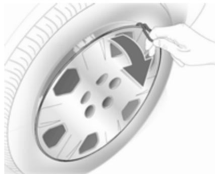
1. Radmutternkappen mit Schraubendreher lösen und abnehmen. Radabdeckung mit dem Haken abziehen. Wagenwerkzeug ⇨ 256.
