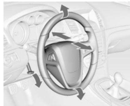
Griff entriegeln, Lenkrad einstellen, Griff einrasten und darauf achten, dass er komplett verriegelt ist. Lenkrad nur bei stehendem Fahrzeug und gelöster Lenkrsperre einstellen.
