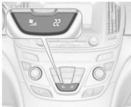
Die Einstellungen für Temperatur und Gebläsegeschwindigkeit werden im Klima-Display angezeigt.
