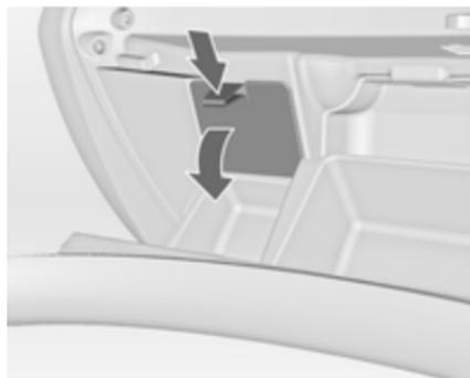
In Rechtslenkern befindet sich der Sicherungskasten hinter einer Abdeckung im Handschuhfach. Handschuhfach öffnen und Abdeckung entfernen.
