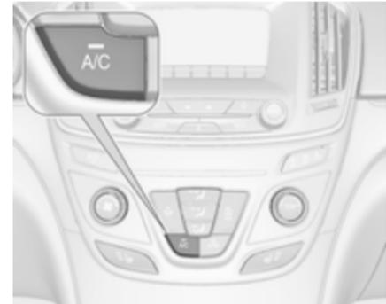
Taste **A/C** drücken, um die Kühlung einzuschalten. Die Betätigung wird durch die LED auf der Taste angezeigt. Die Kühlung ist nur bei laufendem Motor und eingeschaltetem Klimatisierungsgebläse funktionsfähig.
