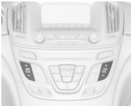
Die Temperatureinstellungen werden im Temperaturfeld für die Fahrer- und Beifahrerseite angezeigt.
