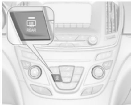
Die Heizung wird durch Drücken der Taste
