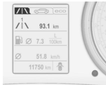
Die erfasste Fahrstrecke seit dem letzten Zurücksetzen wird im Bordcomputer angezeigt. Es stehen zwei Tageskilometerzähler zur Verfügung.
