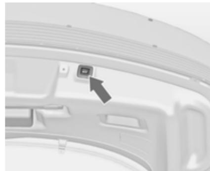
Zum Schließen die Taste
