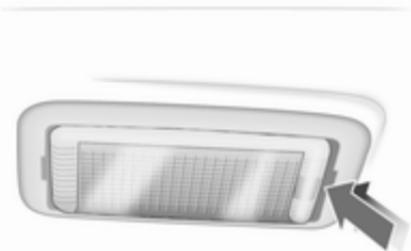
1. Leuchte mit Schraubendreher lösen und herausnehmen.
