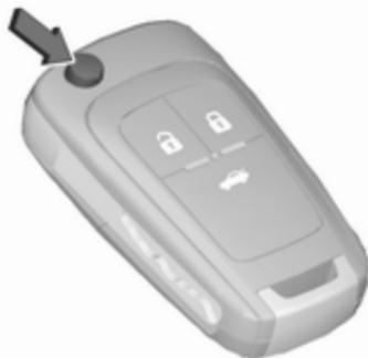
Zum Ausklappen auf den Knopf drücken. Zum Einklappen zuerst auf den Knopf drücken.
