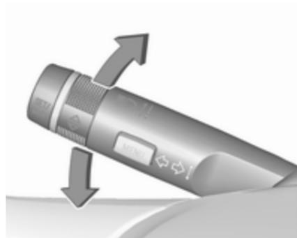
Hebel nach oben = Blinker rechts
