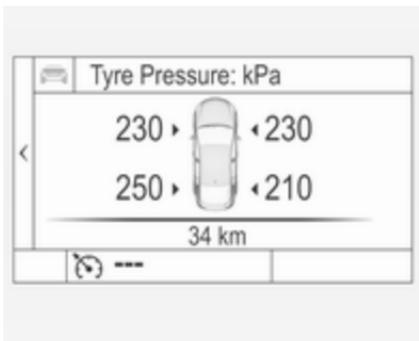
Systemstatus und Druckwarnungen werden durch eine Meldung und gleichzeitiges Blinken des betreffenden Reifens im DIC angezeigt.
