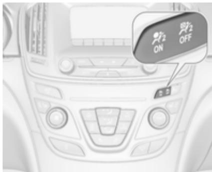
Solange die Kontrollleuchte
