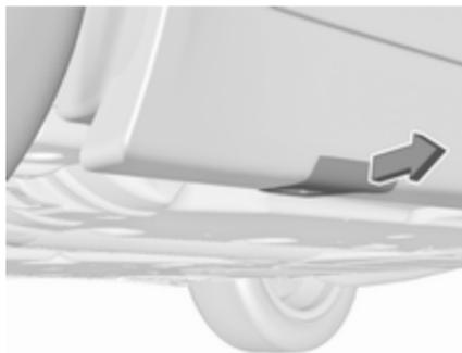
3. Bei einigen Modellen ist der Ansatzpunkt abgedeckt. Abdeckung seitlich herausziehen.
