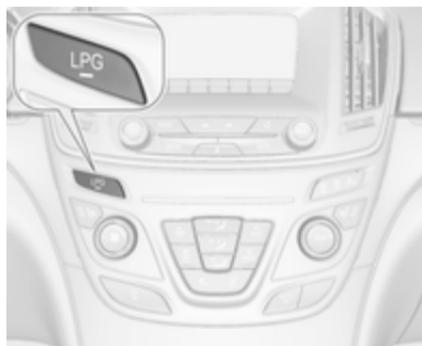
Auf **LPG** drücken, um zwischen Benzin- und Flüssiggasbetrieb umzuschalten, sobald die erforderlichen Parameter (Kühlmitteltemperatur, Gastemperatur und Mindestdrehzahl des Motors) erreicht sind. Die Anforderungen sind normalerweise nach etwa 60 Sekunden (je nach Außentemperatur) und der ersten festen Be-
