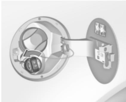
4. Die Schutzkappe vom Einfüllstutzen abschrauben.
