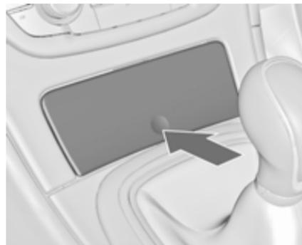
Unterhalb der Bedienelemente der Klimatisierung befindet sich hinter einer Abdeckung ein Stauraum. Zum Öffnen auf die Abdeckung drücken.
