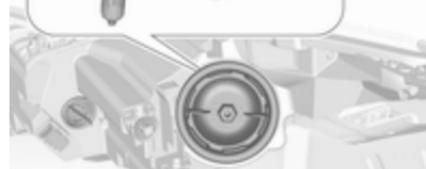
3. Die Lampenfassung durch leichtes Aufbiegen der Haltenase vom Stecker lösen.
