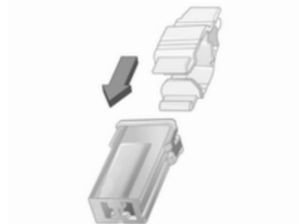
Sicherungszieher von oben oder seitlich auf die verschiedenen Ausführungen von Sicherungen stecken und Sicherung herausziehen.
