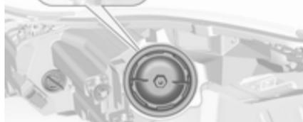
2. Die Lampenfassung durch Drehen nach links lösen. Lampenfassung aus dem Reflektor ziehen.
