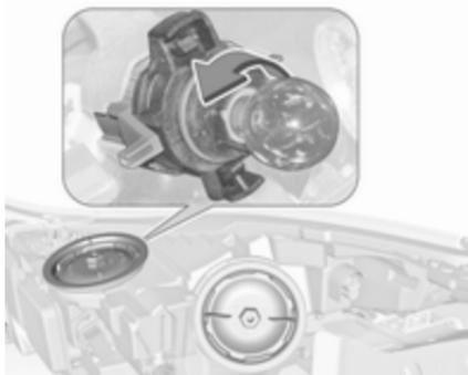
2. Glühlampe etwas in die Fassung hineindrücken, nach links drehen und herausnehmen.
