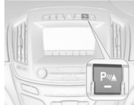
Das System kann durch kurzes Drücken der Einparkhilfe-Taste **P**▲ manuell deaktiviert werden.
