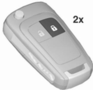
Funkfernbedienung oder elektronischer Schlüssel: zweimal innerhalb von 5 Sekunden auf
