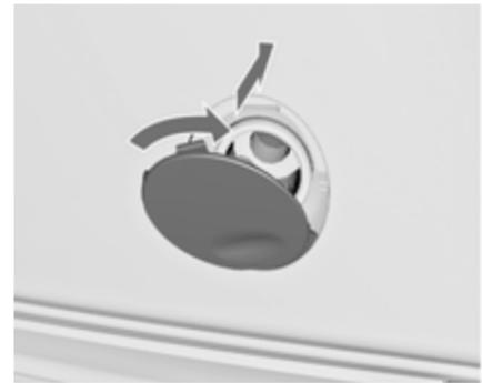
**Schrägheck, 5-türig, 4-türige Limousine, Sports Tourer, OPC:** Unteren Teil der Abdeckung einsetzen, leicht nach rechts drehen und Abdeckung schließen.
