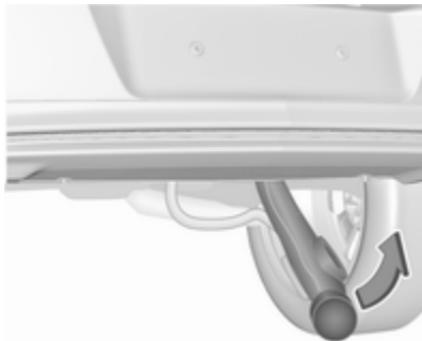
Die ausgerastete Kugelstange mit der flachen Hand nach rechts bewegen, bis diese unter dem Boden einrastet. Sicherstellen, dass der Entriegelungsgriff zurück in seine verborgene Ausgangsposition geführt wird, da sonst der Summton nicht aufhört.
