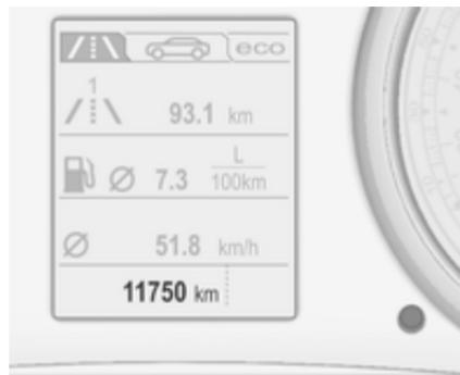
Die erfasste Gesamtfahrstrecke wird in km angezeigt.
