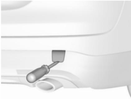
**Country Tourer:** Mit einem Schraubendreher in den Schlitz unten an der Abdeckung fahren. Abdeckung durch vorsichtiges Abwärtsbewegen des Schraubendrehers lösen. Um Schäden zu vermeiden, wird empfohlen, ein Tuch zwischen Schraubendreher und Rahmen zu legen.
