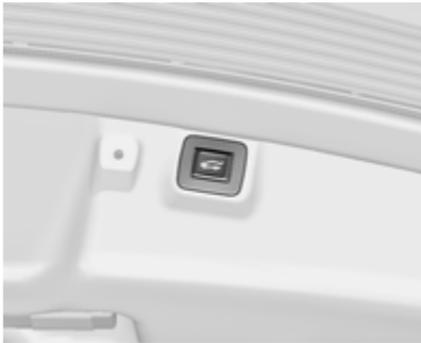
4. Die Taste auf der Innenseite der geöffneten Hecktür drücken und 3 Sekunden lang halten.
