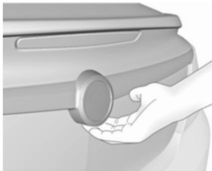
Nach dem Entriegeln auf die Taste unter der Heckklappenleiste drücken und die Heckklappe von Hand öffnen.
