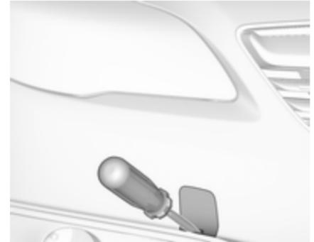
**Country Tourer:** Mit einem Schraubendreher in den Schlitz unten an der Abdeckung fahren. Abdeckung durch vorsichtiges Abwärtsbewegen des Schraubendrehers lösen. Um Schäden zu vermeiden, wird empfohlen, ein Tuch zwischen Schraubendreher und Rahmen zu legen.
