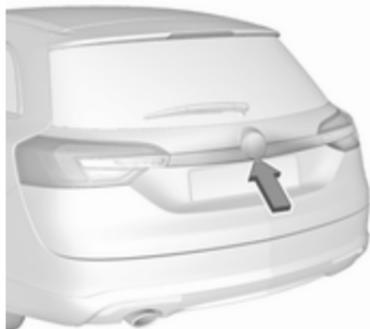
Zum Öffnen der Heckklappe den Touchpad-Schalter unter der Heckklappenleiste drücken, bis die Klappe geöffnet wird.
