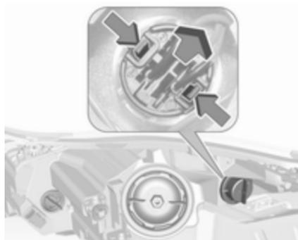
2. Haltelaschen zusammendrücken und Fassung aus dem Gehäuse ziehen.
