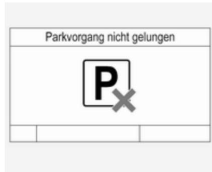
Wenn während der Einpark-Anweisungen ein Gegenstand erkannt wird, erscheint **Stop** im Driver Information Center. Nach Entfernen des Gegenstands wird das Einparkmanöver fortgesetzt. Das System wird deaktiviert, wenn der Gegenstand nicht entfernt wird. System durch Drücken auf **P** aktivieren und nach einer neuen Parklücke suchen.
