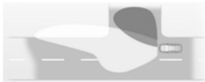
In engen Kurven oder beim Abbiegen wird abhängig vom Lenkwinkel oder dem Blinkersignal links oder rechts ein zusätzlicher Reflektor eingeschaltet, der die Straße im rechten Winkel zur Fahrtrichtung ausleuchtet. Er wird bei Geschwindigkeiten von bis zu 40 km/h aktiviert.
