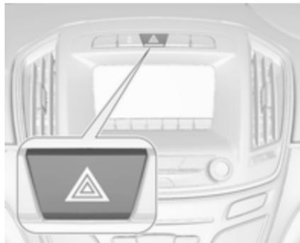
Wird durch Drücken von ▲ bedient.
