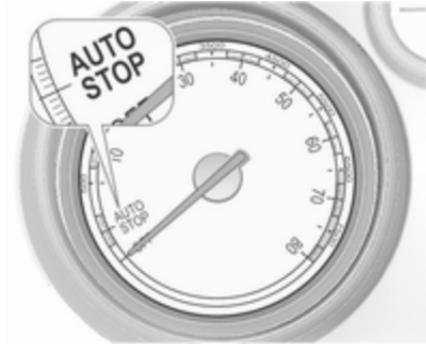
Ein Autostopp wird auf dem Drehzahlmesser angezeigt, indem die Nadel auf der Position **AUTOSTOP** steht. Bei bestimmten Versionen leuchtet bei einem Autostopp des Motors eine Kontrollleuchte im Instrument auf.
