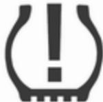
Wenn niedriger Reifendruck erkannt wird, wird dies durch die Kontrollleuchte (⚠) gemeldet ⇨ 112.
