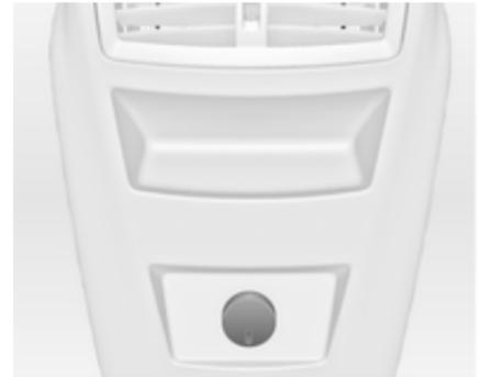
Die maximale Leistungsaufnahme darf 120 Watt nicht überschreiten.
