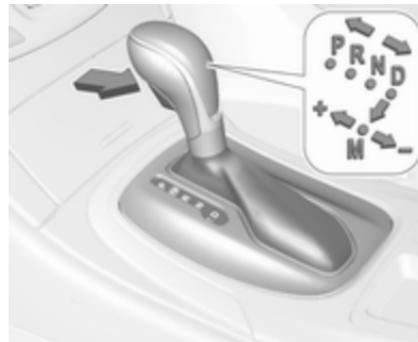
**P** : Parkstellung, Entriegelungsknopf drücken, Räder sind blockiert. Nur bei stillstehendem Fahrzeug und betätigter Parkbremse einlegen
