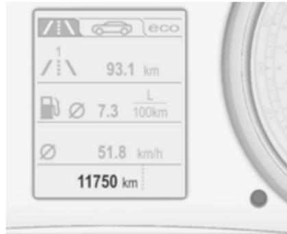
Die erfasste Gesamtfahrstrecke wird in km angezeigt.
