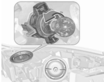
2. Glühlampe etwas in die Fassung hineindrücken, nach links drehen und herausnehmen.
