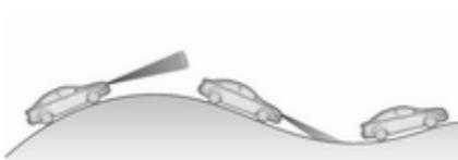
Die Systemleistung beim Bergauf- und Bergabfahren ist abhängig von der Fahrgeschwindigkeit, der Beladung, den Verkehrsbedingungen und der Straßenneigung. Beim Befahren von Steigungen oder Gefällen erkennt das System ein vorausfahrendes Fahrzeug möglicherweise nicht. An starken Steigungen kann es erforderlich sein, zur Beibehaltung der Fahrgeschwindigkeit das Gaspedal zu betätigen. Beim Bergabfahren müssen Sie unter Umständen bremsen, um die Fahrzeuggeschwindigkeit zu halten bzw. zu reduzieren.
