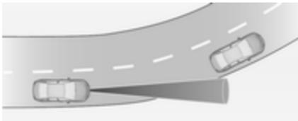
Ausgehend von der Zentrifugalkraft berechnet der adaptive Geschwindigkeitsregler einen voraussichtlichen Weg. Der berechnete Weg berück-
