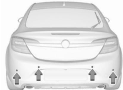
Die Front-Heck-Einparkhilfe misst die Entfernung zwischen dem Fahrzeug und Hindernissen vor und hinter dem
