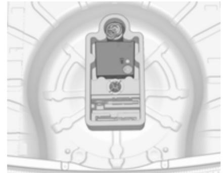
Das Reifenreparaturset befindet sich in einem Staufach unter der Abdeckung des Laderaumbodens.
