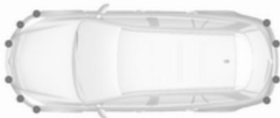
Die erweiterte Einparkhilfe leitet den Fahrer durch Anweisungen im Driver Information Center und akustische Signale in eine Parklücke. Der Fahrer muss selbst beschleunigen, bremsen, lenken und schalten.
