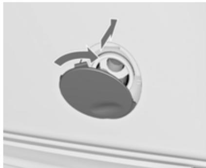
**Schrägheck, 5-türig, 4-türige Limousine, Sports Tourer, OPC:** Unteren Teil der Abdeckung einsetzen, leicht nach rechts drehen und Abdeckung schließen.
