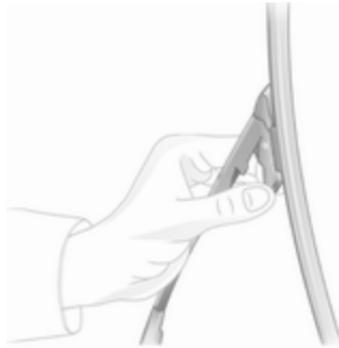
Wischerarm anheben. Beide Riegel am Wischerarm drücken, Wischerblatt ausrasten und abziehen.
