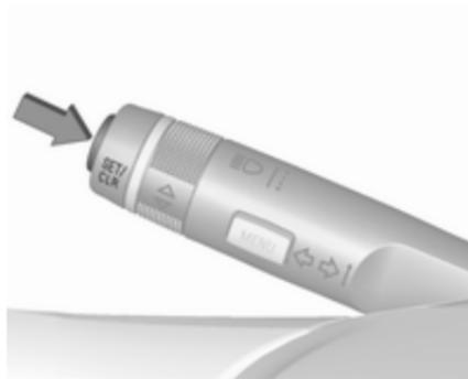
Die Warnfunktion kann im Einstellungs­menü der Seite „Verkehrs­zeichen-Assistent“ durch Drücken von **SET/CLR** am Blinkerhebel oder **✓** am Lenkrad aktiviert und deaktiviert werden.
