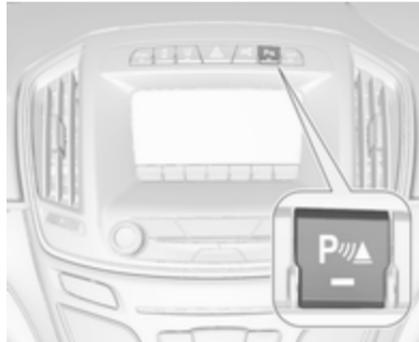
Das System kann durch kurzes Drücken der Einparkhilfe-Taste **P**▲ manuell deaktiviert werden.
