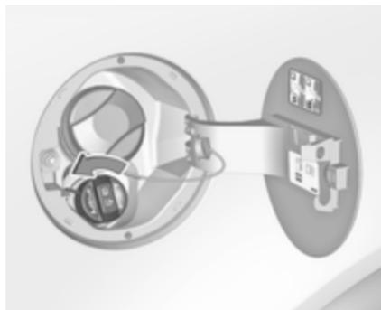
4. Die Schutzkappe vom Einfüllstutzen abschrauben.
