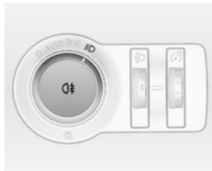
Wird durch Drücken von  $\#D$  bedient.
