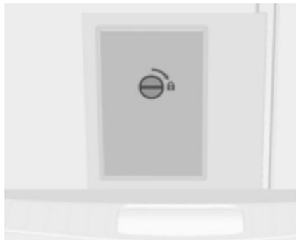
Die geschlossene Abdeckung kann im Laderauminneren gesichert werden. Knopf um 90° drehen:
