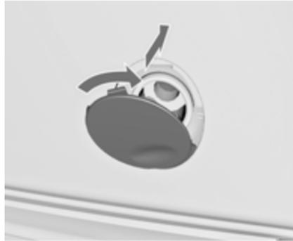
**Schrägheck, 5-türig, 4-türige Limousine, Sports Tourer:** Unteren Teil der Abdeckung einsetzen, leicht nach rechts drehen und Abdeckung schließen.
