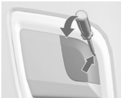
**OPC:** Einen Schraubendreher in den Schlitz an der oberen Ecke der Abdeckung einführen. Abdeckung durch vorsichtiges Abwärtsbewegen des Schraubendrehers lösen. Um Schäden zu vermeiden, wird empfohlen, ein Tuch zwischen Schraubendreher und Rahmen zu legen.
