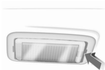
1. Leuchte mit Schraubendreher lösen und herausnehmen.
