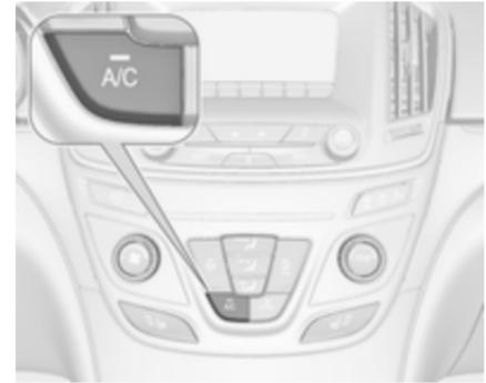
**A/C** drücken, um die Kühlung einzuschalten. Die Betätigung wird durch die LED in der Taste angezeigt. Die Kühlung ist nur bei laufendem Motor und eingeschaltetem Klimatisierungsgebläse funktionsfähig.
