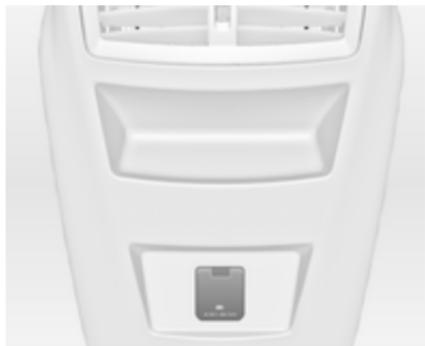
Eine 230-Volt- Zubehörsteckdose befindet sich in der hinteren Mittelkonsole. Bei eingeschalteter Zündung und einem angesteckten Gerät leuchtet eine LED auf der Steckdose grün.
