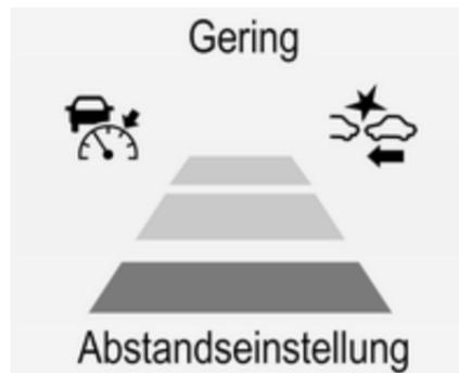
Beachten Sie, dass die Einstellung der Warnempfindlichkeit mit der Abstandswarnung des adaptiven Geschwindigkeitsreglers zusammenhängt ↪ 194. Durch Ändern der Warnempfindlichkeit wird auch die Einstellung der Abstandswarnung des adaptiven Geschwindigkeitsreglers geändert.
