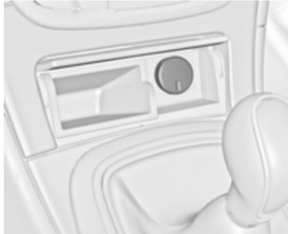
Unterhalb der Bedienelemente der Klimatisierung befindet sich hinter der Staufachabdeckung eine 12-Volt-Zubehörsteckdose. Zum Öffnen auf die Abdeckung drücken.
