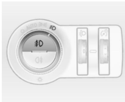
Wird durch Drücken von  $\#D$  bedient.
