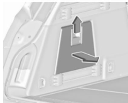
2. Abdeckung in Seitenverkleidung lösen und herausnehmen.
