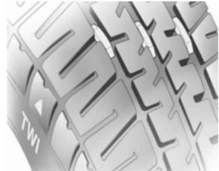
Die gesetzlich zulässige Mindestprofiltiefe (1,6 mm) ist erreicht, wenn das Profil bis zu einem Verschleißanzeiger (TWI = Tread Wear Indicator) abgefahren ist. Seine Lage wird durch Markierungen an der Reifenflanke angezeigt.
