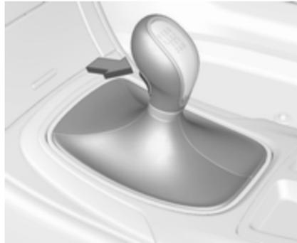
Zum Einlegen des Rückwärtsgangs bei stillstehendem Fahrzeug Entriegelungsknopf am Wählhebel drücken und Gang einlegen.
