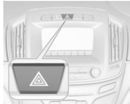
Wird durch Drücken von  $\triangle$  bedient.
