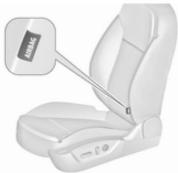
Das Seiten-Airbag-System besteht aus einem Airbag in der Rückenlehne jedes Vordersitzes und in den Rückenlehnen der äußeren Rücksitze. Diese Stellen sind mit dem Wort **AIRBAG** gekennzeichnet.
