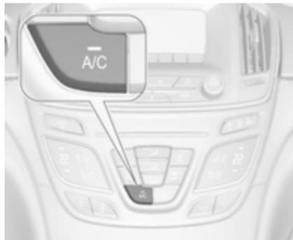
**A/C** drücken, um die Kühlung einzuschalten. Die LED in der Taste leuchtet auf, um die Aktivierung anzuzeigen. Die Kühlung ist nur bei laufendem Motor und eingeschaltetem Klimatisierungsgebläse funktionsfähig.
