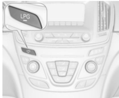
Auf **LPG** drücken, um zwischen Benzin- und Flüssiggasbetrieb umzuschalten, sobald die erforderlichen Parameter (Kühlmitteltemperatur, Gastemperatur und Mindestdrehzahl des Motors) erreicht sind. Die Anforderungen sind normalerweise nach etwa 60 Sekunden (je nach Außentemperatur) und der ersten festen Betätigung des Gaspedals erreicht. Die LED-Statusleuchte zeigt den aktuellen Betriebsmodus.
