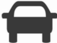
Wenn das System ein vorausfahrendes Fahrzeug in der Fahrspur erkannt hat, leuchtet die Kontrollleuchte für ein erkanntes vorausfahrendes Fahrzeug
