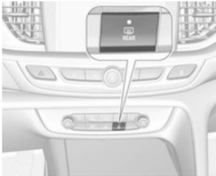
Die Heizung wird durch Drücken auf
