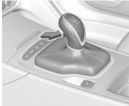
Zum Einlegen des Rückwärtsgangs das Kupplungspedal und dann den Knopf am Wählhebel betätigen und den Gang einlegen.
