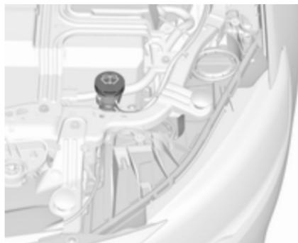
Mit einem Gemisch aus sauberem Wasser und einer geeigneten Menge zugelassener Scheibenwaschflüssigkeit mit Frostschutzmittel auffüllen.
