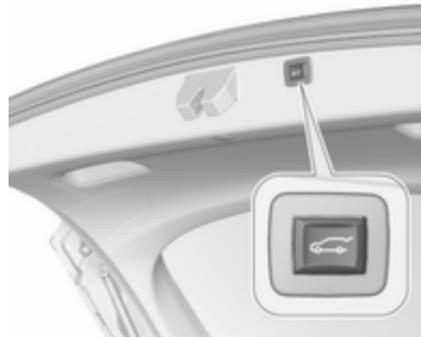
Zum Schließen auf
