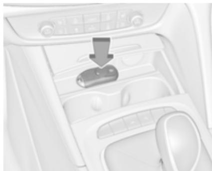
Abdeckung der Mittelkonsole vor dem Schalthebel öffnen. Elektronischen Schlüssel wie in der Abbildung
