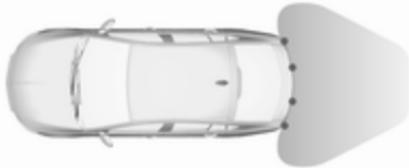
Das System besteht aus vier Ultraschall-Parkensensoren im hinteren Stoßfänger.
