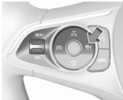
Zum Einschalten des adaptiven Geschwindigkeitsreglers
