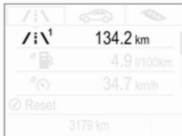
$\swarrow/\searrow$  durch Drücken auf **Menu** am Blinkerhebel auswählen. Das Einstellrädchen am Blinkerhebel drehen und  $\swarrow/\searrow$ 1 oder  $\swarrow/\searrow$ 2 auswählen. Jede Tageskilometerzählerseite kann separat zurückgesetzt werden, indem während der Anzeige des entsprechenden Menüs einige Sekunden lang **SET/CLR** am Blinkerhebel gedrückt wird.
