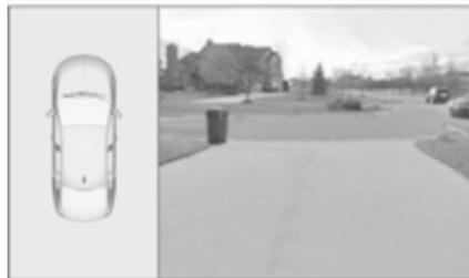
Der Bildschirm des Info-Displays ist geteilt: Links wird eine Draufsicht des Fahrzeugs angezeigt, rechts eine Ansicht von vorn oder von hinten, je nach eingelegtem Gang. Die Parksensoren ergänzen die angezeigten Informationen.
