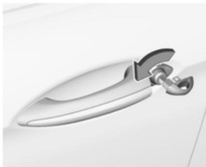
Die Fahrertür durch Einsetzen und Drehen des Schlüsselblatts im Schließzylinder von Hand entriegeln.
