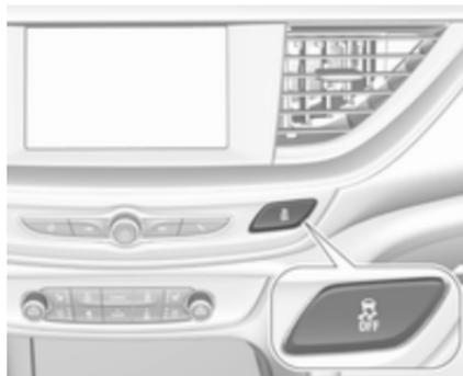
Die Traktionskontrolle kann ausgeschaltet werden, wenn ein Durchdrehen der Antriebsräder erwünscht ist:
