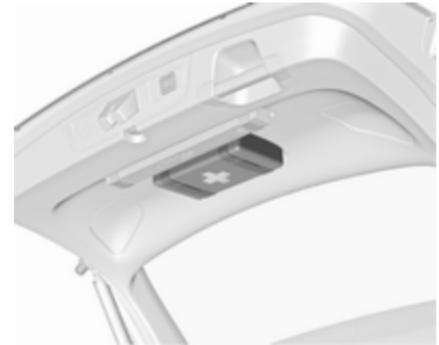
Die Verbandstasche mit den Haltegurten der Heckklappeninnenverkleidung verstauen.
