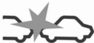
Wenn der Zeitabstand zum vorausfahrenden Fahrzeug sich zu sehr verringert und eine Kollision droht, wird das Aufprallwarnsymbol im Driver Information Center eingeblendet und der Fahrer wird durch einen rot blinkenden LED-Streifen oder durch ein vom Head-up-Display im Sichtfeld des Fahrers auf die Windschutzscheibe projiziertes Popup-Symbol gewarnt.
