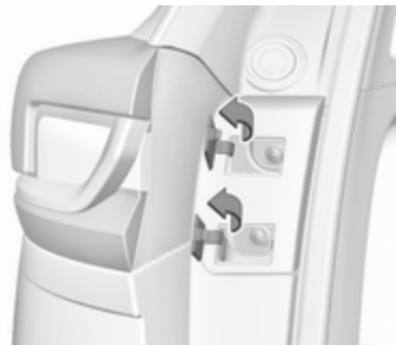
1. Die Abdeckungen mit dem Schraubendreher öffnen. Beide Schrauben lösen und abnehmen.
