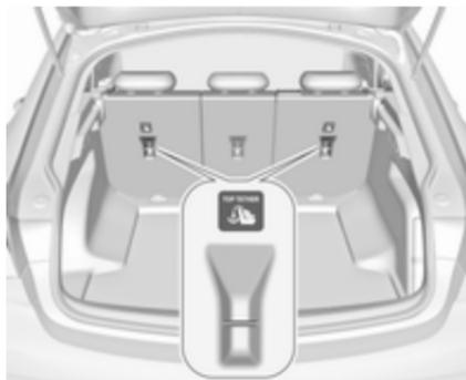
Zusätzlich zu den ISOFIX-Befestigungen den Top-Tether-Gurt an den Top-Tether-Befestigungsösen befestigen.
