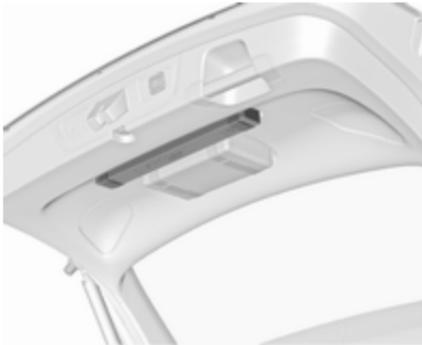
Das Warndreieck mit den Haltegurten der Heckklappeninnenverkleidung verstauen.
