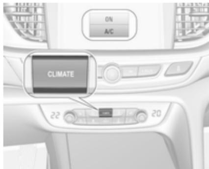
Zum Öffnen des Menüs auf **Climate** drücken und über die Schaltflächen navigieren, um die Klimaanlage einzuschalten (A/C ON) oder auszuschalten (A/C OFF).
