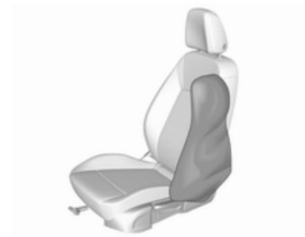
Der aufgeblähte Airbag dämpft den Aufprall, wodurch die Verletzungsgefahr für Oberkörper und Becken bei einem Seitenaufprall deutlich verringert wird.
