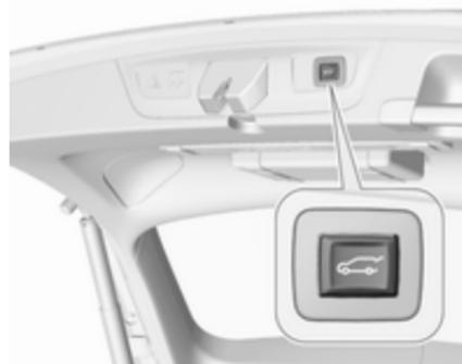
4. Die Taste
