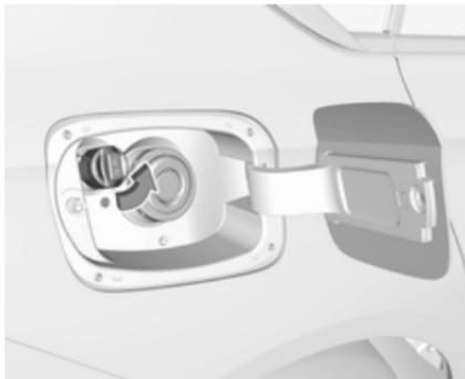
4. Die Schutzkappe vom Einfüllstutzen abschrauben.
