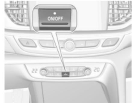
Kühlung, Gebläse und Automatikmodus können durch Drücken auf **ON/OFF** ausgeschaltet werden. Bei Deaktivierung des Systems leuchtet die LED in der Taste **ON/OFF** nicht.
