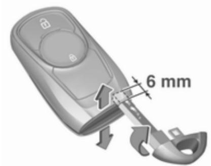
2. Das Schlüsselblatt wieder etwa 6 mm weit einführen und den Schlüssel drehen, um das Gehäuse zu öffnen. Wenn das Schlüsselblatt zu weit eingeführt wird, kann dies das Gehäuse beschädigen.
