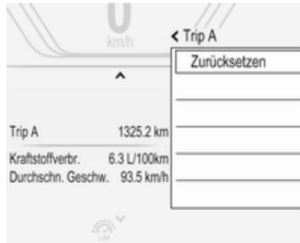
**Info**-Seite im Hauptmenü anwählen. Durch Drücken auf  $\checkmark$  am Lenkrad die Seite **Trip A** oder **Trip B** auswählen.
