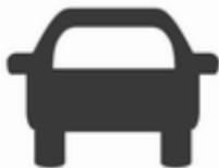
Wenn das System ein vorausfahrendes Fahrzeug in der Fahrspur erkannt hat, leuchtet die Kontrollleuchte für ein erkanntes vorausfahrendes Fahrzeug
