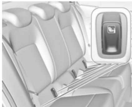
Für das Fahrzeug zugelassene ISOFIX-Kindersicherheitssysteme an den ISOFIX-Befestigungen befestigen. Die speziellen Positionen für ISOFIX-Kindersicherheitssysteme sind aus der ISOFIX-Tabelle ersichtlich ⇨ 69.
