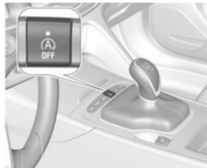
Die Stopp-Start-Automatik lässt sich durch Drücken von
