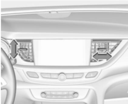
Abbildung zeigt mittlere Belüftungsdüsen in der Instrumententafel.
