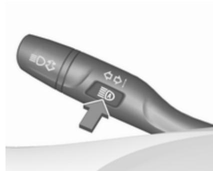
Den Fernlichtassistenten durch einmaliges Drücken auf  $\equiv$ D aktivieren. Bei Geschwindigkeiten über 50 km/h wird das Fernlicht automatisch eingeschaltet. Bei Geschwindigkeiten unter 35 km/h wird das Fernlicht automatisch ausgeschaltet, der Fernlichtassistent bleibt jedoch aktiv.
