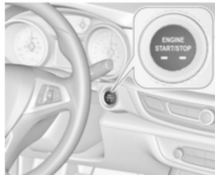
Schaltgetriebe: Kupplung und Bremspedal betätigen.
