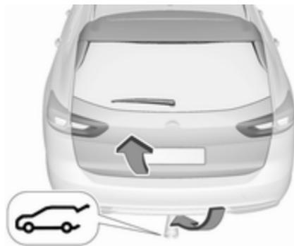
Zum Öffnen oder Schließen der Hecktür den Fuß unter dem Heckstoßfänger in dem Bereich, in dem das Hologramm auf den Boden projiziert wird, vor und zurück bewegen. Den Fuß nicht länger unter den Heckstoßfänger halten oder zu langsam hin und her bewegen. Der elektronische Schlüssel muss sich außerhalb des Fahrzeugs in einem Bereich bis zu ca. einem Meter von der Hecktür
