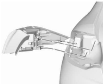
3. Rückleuchtenzusammenbau vorsichtig aus der Aussparung nehmen und entfernen. Aufpassen, dass der Kabelkanal nicht verschoben wird.
