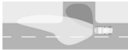
Beim Abbiegen werden je nach Lenkwinkel und Blinklicht spezielle LED eingeschaltet, um die Fahrtrichtung auszuleuchten. Er wird bei Geschwindigkeiten von bis zu 40 km/h aktiviert.
