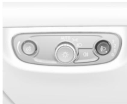
Zur Anpassung der Leuchtweite an die Fahrzeuglast, um die Blendwirkung zu reduzieren: Daumenrädchen  $\equiv$  drücken und in die gewünschte Stellung drehen.
