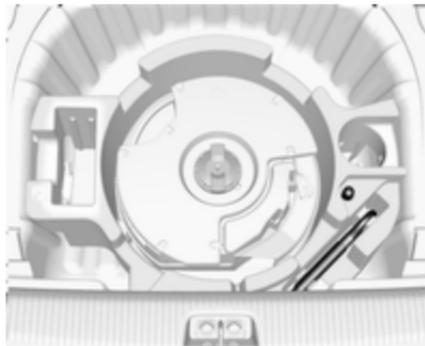
Der Schraubendreher und die Abschleppöse befinden sich unter der Bodenabdeckung im Laderaum neben der runden Lautsprechersystemkomponente.
