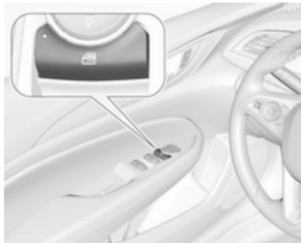
Zur Deaktivierung der elektrischen Fensterheber der hinteren Türen
