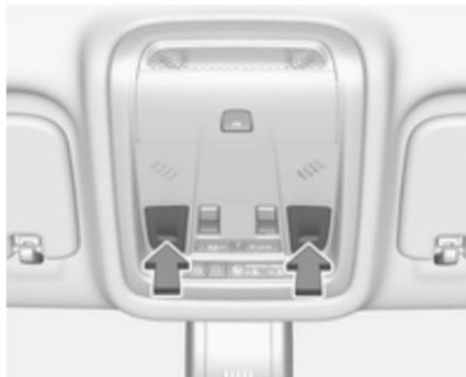
Wird durch Drücken des entsprechenden Leselichtschalters eingeschaltet.
