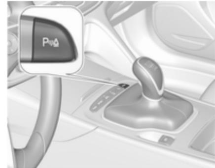
Zum Deaktivieren die Taste Einparkhilfe **P** mit einem Dreieck drücken; die LED in der Taste erlischt.
