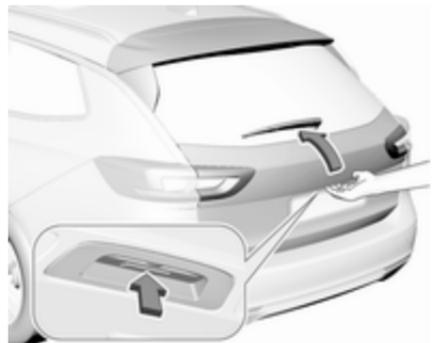
Nach dem Entriegeln den Touchpad-Schalter unter der Hecktürlleiste drücken und die Hecktür manuell öffnen.
