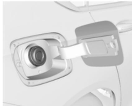
Die Tankdüse gerade am Einfüllstutzen ansetzen und mit geringem Kraftaufwand einstecken.
