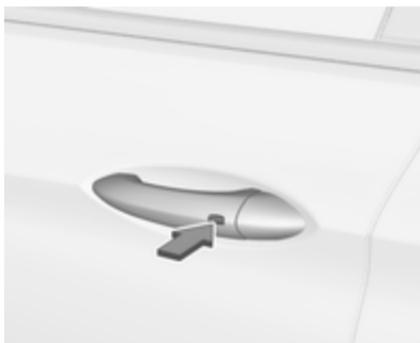
Beim Entriegeln des Fahrzeugs durch Drücken der Taste an einem Außentürgriff wird die Diebstahlwarnanlage deaktiviert.
