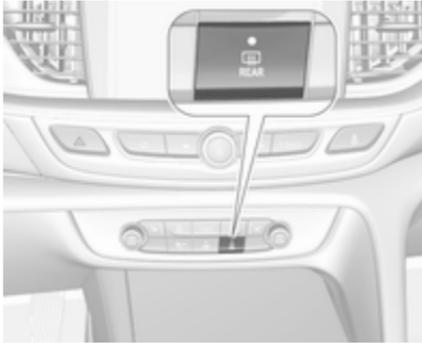
Zur Aktivierung gleichzeitig auf
