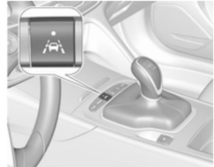
Der Spurhalteassistent wird durch Drücken auf
