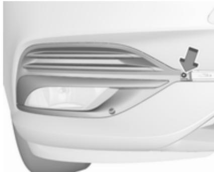
2. Schraube lösen und Blende abnehmen.
