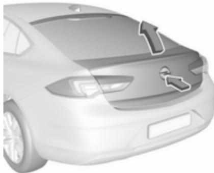
Nach dem Entriegeln auf das Markenemblem drücken und die Heckklappe öffnen.
