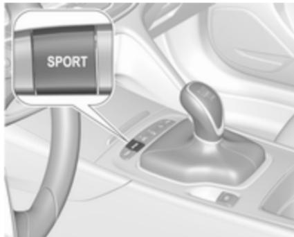
Bei Fahrzeugen mit Flex-Ride-Fahrmodi kann der Fahrer durch Auswahl des Sport-Modus die Beschleunigung des adaptiven Geschwindigkeitsreglers leicht erhöhen.
