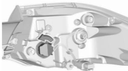
4. Die Lampenfassung des Blinkers nach links aus dem Leuchtenzusammenbau herausdrehen und abnehmen.
