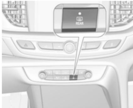
Zur Aktivierung gleichzeitig auf
