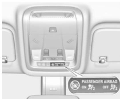
Wenn die Kontrollleuchte
