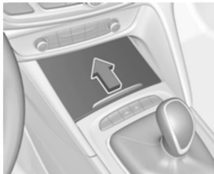
Ein Ablagefach befindet sich in der Mittelkonsole. Abdeckung nach vorne drücken.
