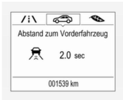
Beim Midlevel- und Uplevel-Display das **Info**-Menü über die Lenkradtasten auswählen und zum Anzeigen der Abstandswarnung auf  $\nabla$  drücken  $\diamond$  116.
