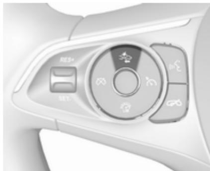
Beim ersten Drücken der Taste wird die aktuelle Einstellung im Driver Information Center angezeigt. Durch erneutes Drücken der Taste wird die Einstellung geändert. Die ausgewählte Einstellung bleibt aktiv, bis sie erneut geändert wird. Der Zeitpunkt der Warnung hängt von der Fahrge-
