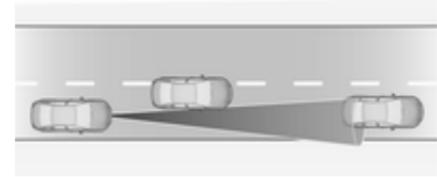
Wechselt ein anderes Fahrzeug auf die von Ihnen verwendete Spur, berücksichtigt der adaptive Geschwindigkeitsregler das Fahrzeug erst nach dem vollständigen Spurwechsel. Seien Sie bereit, das Bremspedal zu betätigen, falls dies erforderlich wird.
