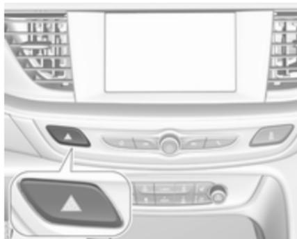
Bei einem Unfall mit Airbagauslösung wird der Warnblinker automatisch eingeschaltet.
