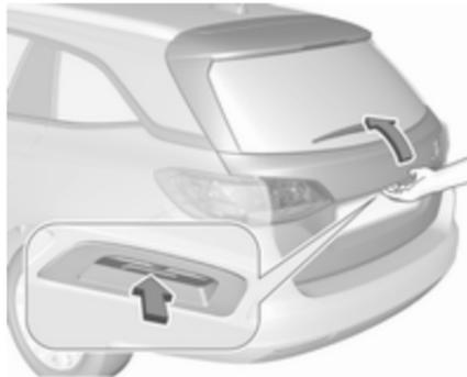
Zum Öffnen der Heckklappe den Touchpad-Schalter unter der Heckklappenleiste drücken, bis die Klappe geöffnet wird. Wenn das Fahrzeug verriegelt ist, muss sich der elektronische Schlüssel außerhalb des Fahrzeugs in einem Bereich bis zu ca. einem Meter von der Hecktür entfernt befinden.
