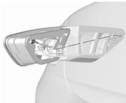
3. Die Leuchtenbaugruppe vorsichtig aus den Aussparungen ziehen und herausnehmen. Aufpassen, dass der Kabelkanal nicht verschoben wird.
