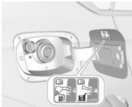
Der Fehlbetankungsschutz sorgt dafür, dass die Klappe des Einfüllstutzens nur mit der richtigen Tankdüse oder einem Trichter für eine Notfallbetankung geöffnet werden kann.
