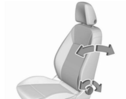
Handrad drehen. Zum Einstellen Rückenlehne entlasten.
