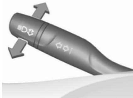
Zum Umschalten von Ablend- auf Fernlicht den Hebel drücken.
