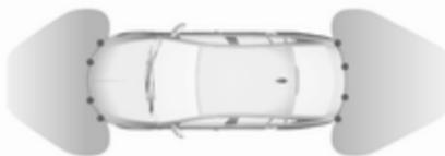
Das System besteht aus jeweils vier Ultraschall-Parksensoren im vorderen und hinteren Stoßfänger.
