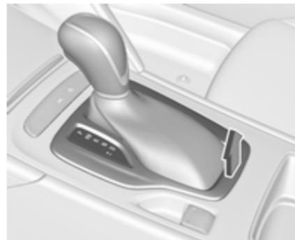
2. Lösen Sie die Wählhebel-Verkleidung von der Mittelkonsole. Stecken Sie einen Finger in die
