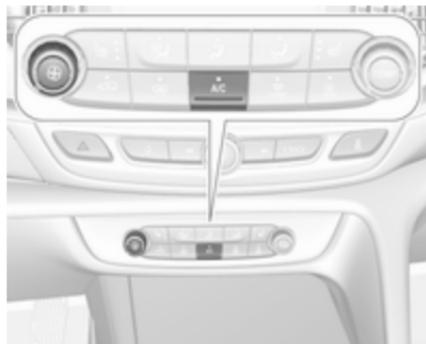
**A/C** drücken, um die Kühlung einzuschalten. Die Betätigung wird durch die LED in der Taste angezeigt. Die
