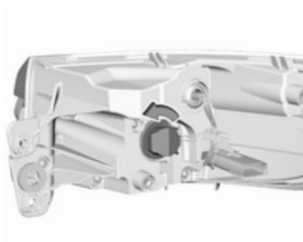
3. Die Lampenfassung des Blinkers nach links aus dem Leuchtensammenbau herausdrehen und abnehmen.
