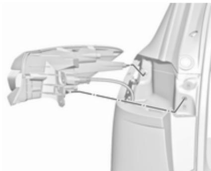
2. Rückleuchtenzusammenbau vorsichtig aus der Aussparung nehmen und entfernen. Aufpassen, dass der Kabelkanal nicht verschoben wird.
