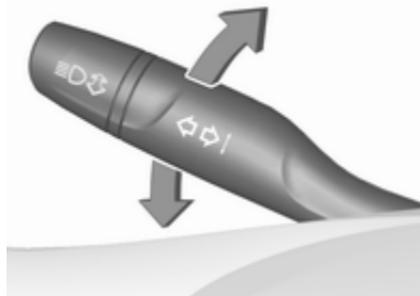
Hebel nach oben : Blinker rechts
