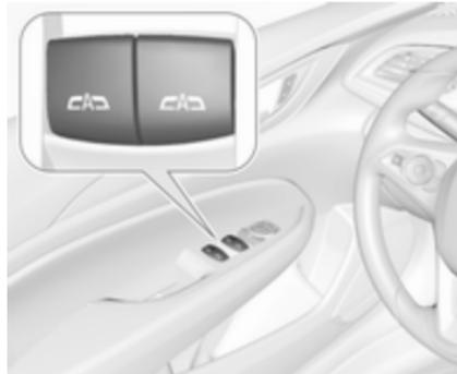
Schalter **CAB** des betreffenden Fensters zum Öffnen drücken bzw. zum Schließen ziehen.
