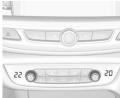
Gewünschte Temperaturvoreinstellungen für Fahrer und Beifahrer separat über linken und rechten Drehreg-
