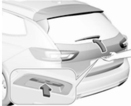
Nach dem Entriegeln den Touchpad-Schalter unter der Hecktürleiste drücken und die Hecktür manuell öffnen.
