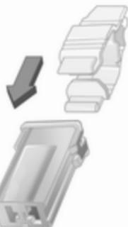
Sicherungszieher von oben oder seitlich auf die verschiedenen Ausführungen von Sicherungen stecken und Sicherung herausziehen.
