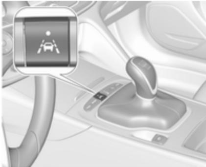
Der Spurhalteassistent wird durch Drücken auf
