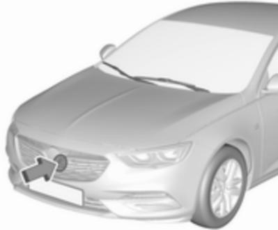
Das Radargerät ist hinter dem Kühlergrill hinter dem Markenemblem oder unterhalb des Markenemblems montiert.
