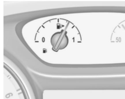
Zeigt den Füllstand im Kraftstofftank an.
