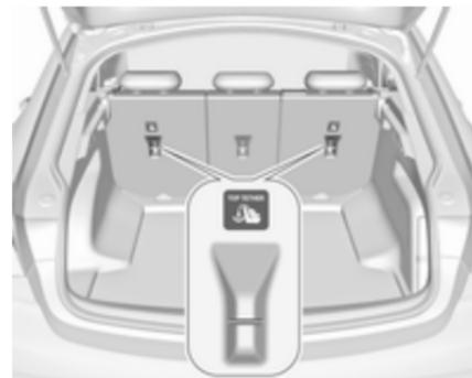
Zusätzlich zu den ISOFIX-Befestigungshalterungen den Top-Tether-Befestigungsgurt an den Top-Tether-Befestigungen verankern.
