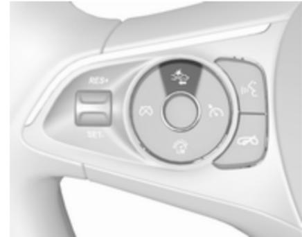
Beim ersten Drücken der Taste wird die aktuelle Einstellung im Driver Information Center angezeigt. Durch erneutes Drücken der Taste wird die Einstellung geändert. Die ausgewählte Einstellung bleibt aktiv, bis sie erneut geändert wird. Der Zeitpunkt der Warnung hängt von der Fahrgeschwindigkeit ab. Je höher die Fahrgeschwindigkeit, desto größer die Entfernung, ab der die Warnung ausgegeben wird. Beim Auswählen des Warnzeitpunkts die Verkehrs- und Witterungsbedingungen berücksichtigen.
