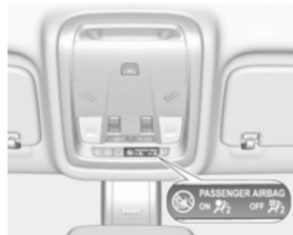
Wenn die Kontrollleuchte
