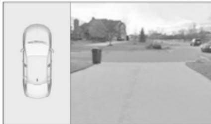
Der Bildschirm des Info-Displays ist geteilt: Links wird eine Draufsicht des Fahrzeugs angezeigt, rechts eine Ansicht von vorn oder von hinten, je nach eingelegtem Gang. Die Parksensoren ergänzen die angezeigten Informationen.
