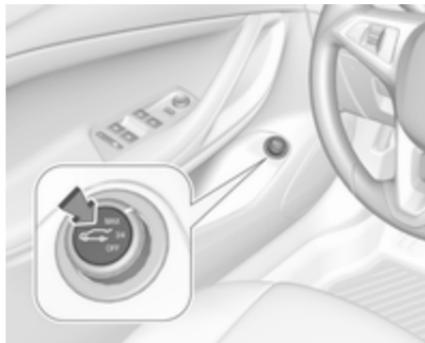
☞ innen an der Fahrertür drücken, bis die Hecktür geöffnet bzw. geschlossen wird.
