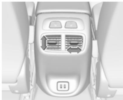
Abbildung zeigt Belüftungsdüsen für hintere Insassen.
