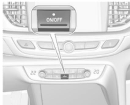
Kühlung, Gebläse und Automatikmodus können durch Drücken auf **ON/OFF** ausgeschaltet werden. Bei Deaktivierung des Systems leuchtet die LED in der Taste **ON/OFF** nicht.
