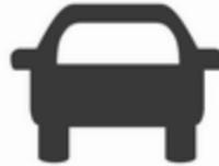
Wenn das System ein vorausfahrendes Fahrzeug in der Fahrspur erkannt hat, leuchtet die Kontrollleuchte für ein erkanntes vorausfahrendes Fahrzeug 🚗 grün auf. Die Sensorreichweite beträgt je nach Fahrgeschwindigkeit 25 bis 150 Meter.
