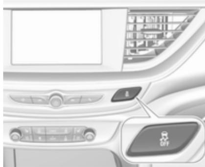
Die Traktionskontrolle kann ausgeschaltet werden, wenn ein Durchdrehen der Antriebsräder erwünscht ist:
