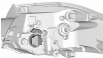
4. Die Lampenfassung des Blinkers nach links aus dem Leuchtenzusammenbau herausdrehen und abnehmen.
