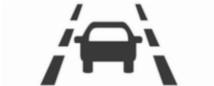
Wenn die Kontrollleuchte
