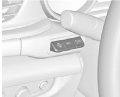
Das Head-up-Display wird über drei Bedienelemente über dem Lichtschalter bedient.
