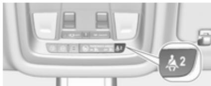
☞ für den Beifahrersitz leuchtet oder blinkt rot in der Dachkonsole, wenn der Sitz belegt ist.
