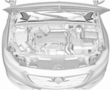
Der Luftreinlass im Motorraum außen vor der Windschutzscheibe muss zur Luftzufuhr frei sein. Gegebenenfalls Laub, Schmutz oder Schnee entfernen.
