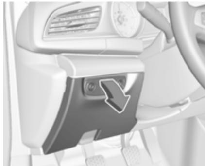
Bei Linkslenkern befindet sich der Sicherungskasten hinter einer Abdeckung in der Instrumententafel.
