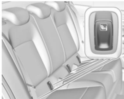
Für das Fahrzeug zugelassene ISOFIX-Kindersicherheitsysteme an den ISOFIX-Befestigungen befestigen. Die speziellen Positionen für ISOFIX-Kindersicherheitsysteme sind in der Tabelle mit ISOFIX gekennzeichnet ↷ 69.
