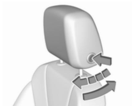
Die Entriegelungstaste drücken und das Polster der Kopfstütze langsam nach vorne ziehen. Sie rastet in verschiedenen Positionen ein.
