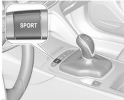
Bei Fahrzeugen mit Flex-Ride-Fahrmodi kann der Fahrer durch Auswahl des Sport-Modus die Beschleunigung des adaptiven Geschwindigkeitsreglers leicht erhöhen. Diese Funktion kann im Flex-Ride-Visualisierungsmenü ↷ 193 deaktiviert werden.
