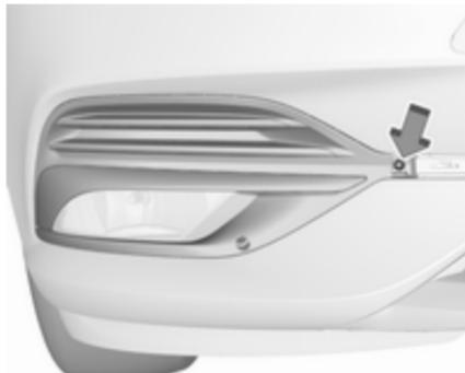
Schraube lösen und Blende abnehmen.
