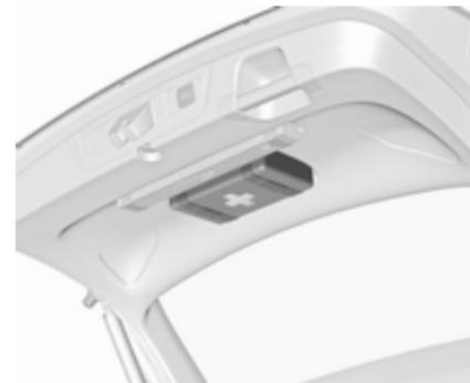
Die Verbandstasche mit den Haltegurten der Heckklappeninnenverkleidung verstauen.
