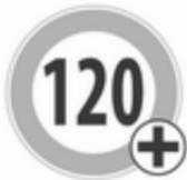
Zudem werden in der unteren Zeile des Driver Information Centers permanent die aktuell gültigen Geschwindigkeitsbegrenzungen angezeigt. Wenn eine Geschwindigkeitsbegrenzung mit zusätzlichem Verkehrsschild verfügbar ist, wird in diesem Bereich ein + Symbol angezeigt.
