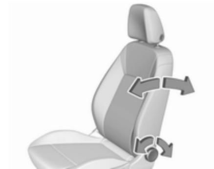
Handrad drehen. Zum Einstellen Rückenlehne entlasten.
