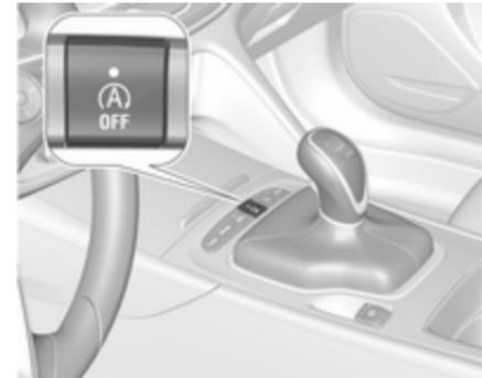
Die Stopp-Start-Automatik lässt sich durch Drücken von
