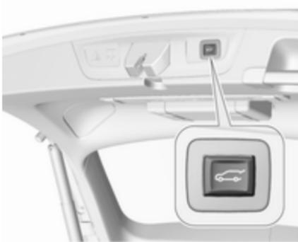
4. Die Taste
