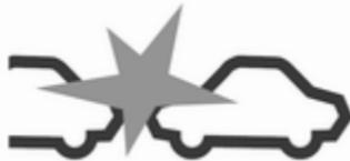
Wenn der Zeitabstand zum vorausfahrenden Fahrzeug sich zu sehr verringert und eine Kollision droht, wird das Aufprallwarnsymbol im Driver Information Center eingeblendet und der Fahrer wird durch einen rot blinkenden LED-Streifen oder durch ein vom Head-up-Display im
