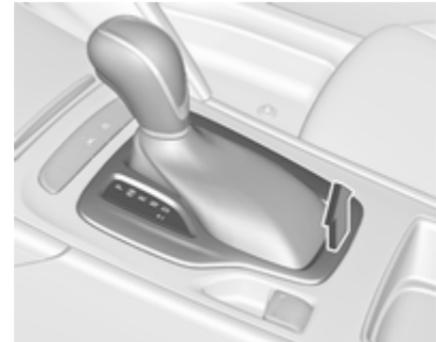
2. Lösen Sie die Wählhebel-Verkleidung von der Mittelkonsole. Stecken Sie einen Finger in die
