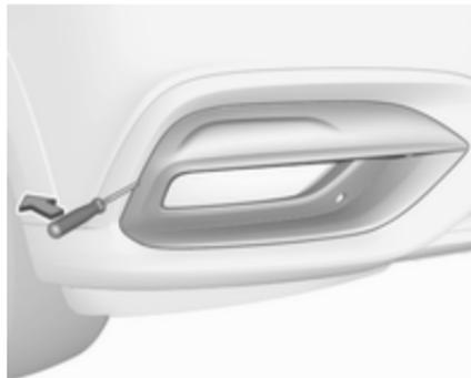
Einen Schraubendreher in die Aussparung der Blende einsetzen und die Blende heraushebeln.
