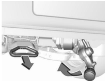
Den Griff unter der hinteren Stoßfängerverkleidung links vom Nummernschild in einem Winkel von etwa 45° Richtung Boden ziehen.
