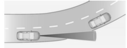
Ausgehend von der Zentrifugalkraft berechnet der adaptive Geschwindigkeitsregler einen voraussichtlichen Weg. Der berechnete Weg berücksichtigt die aktuellen Kurveneigenschaften, kann jedoch keine späteren Änderungen der Kurvenspur vorhersehen. Das System kann daher ein vorausfahrendes Fahrzeug aus dem Erkennungsbereich verlieren oder ein Fahrzeug erkennen, das sich nicht auf der verwendeten Fahrspur befindet. Dies kann beim Einfahren in eine Kurve oder beim Ausfahren aus einer
