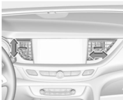
Abbildung zeigt mittlere Belüftungsdüsen in der Instrumententafel.
