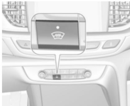
Die Heizung wird durch Drücken auf
