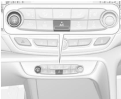
**A/C** drücken, um die Kühlung einzuschalten. Die Betätigung wird durch die LED in der Taste angezeigt. Die Kühlung ist nur bei laufendem Motor und eingeschaltetem Klimatisierungsgebläse funktionsfähig.
