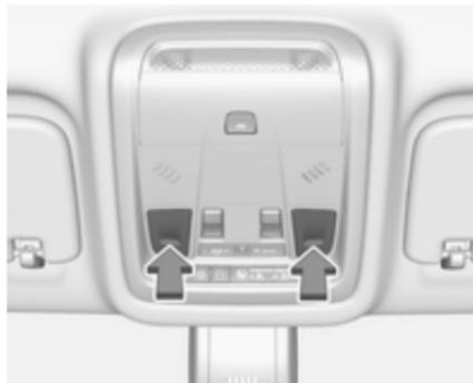
Wird durch Drücken des entsprechenden Leselichtschalters eingeschaltet.
