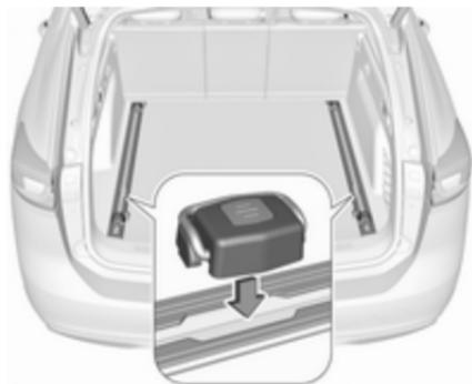
Die Schlitten in die Schienen am Laderaumboden einsetzen. Dazu die Aussparung in der Schiene verwenden und den Knopf am Schlitten drücken, während er eingesetzt wird.
