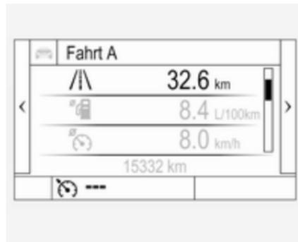
**Info**-Seite  $\text{/\i\}$  im Hauptmenü anwählen. Durch Drücken auf  $\checkmark$  am Lenkrad die Seite **Trip A** oder **Trip B** auswählen.
