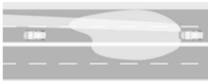
Der Fernlichtassistent beinhaltet einen speziellen Autobahnmodus. Wird auf Autobahnen schneller als 115 km/h gefahren, verkleinert sich der Lichtstrahl, damit der entgegenkommende Verkehr nicht geblendet wird. Beim Fahren hinter Fahrzeugen bzw. beim Überholen wird die Spiegelblendwirkung in diesen Fahrzeugen verringert.
