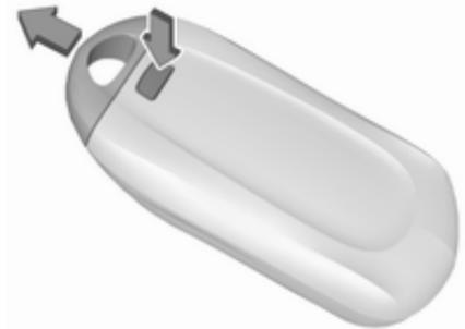
1. Den Knopf an der Rückseite des elektronischen Schlüssels drücken und das Schlüsselblatt aus dem Gehäuse ziehen.
