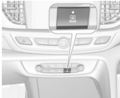
Zur Aktivierung gleichzeitig auf und die Taste der Heckscheibenheizung drücken. Die LED in der Taste leuchtet auf.
