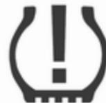
Wenn niedriger Reifendruck erkannt wird, wird dies durch die Kontrollleuchte (L) gemeldet ⇨ 114.
