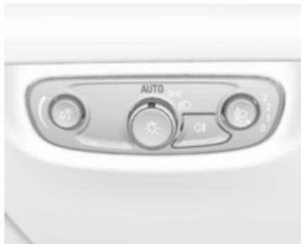
Bei aktivierter Funktion Automatisches Fahrlicht und laufendem Motor schaltet das System abhängig von den äußeren Lichtverhältnissen und den Informationen des Wischersystems zwischen Tagfahrlicht und Scheinwerfern automatisch um.
