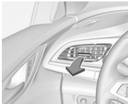
Abbildung zeigt äußere Belüftungsdüsen in der Instrumententafel.
