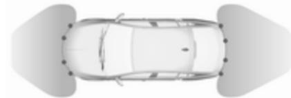
Das System besteht aus jeweils vier Ultraschall-Parksensoren im vorderen und hinteren Stoßfänger.
