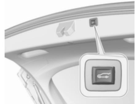
Zum Schließen auf
