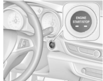
Schaltgetriebe: Kupplung und Bremspedal betätigen.
