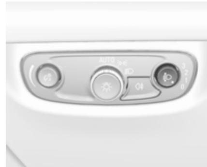
Zur Anpassung der Leuchtweite an die Fahrzeuglast, um die Blendwirkung zu reduzieren: Daumenrädchen
