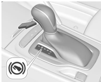
Der Wählhebel ist in der **P**-Stellung gesperrt und kann nur bewegt werden, wenn die Zündung eingeschaltet ist, die Freigabetaste am Wählhebel gedrückt und das Bremspedal betätigt wird.
