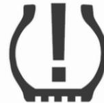
Wenn niedriger Reifendruck erkannt wird, wird dies durch die Kontrollleuchte (⚠) gemeldet ↻ 115.
