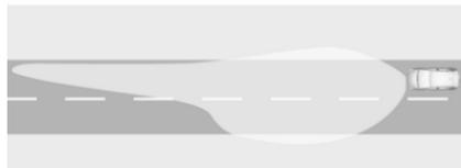
Wird außerorts ab einer bestimmten Fahrgeschwindigkeit automatisch aktiviert. Die eigene Fahrbahn und deren Rand werden besser ausgeleuchtet. Entgegenkommende und vorausfahrende Fahrzeuge werden nicht geblendet.
