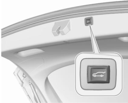
Zum Schließen auf
