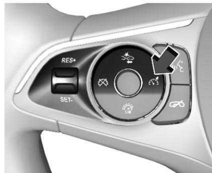
Zum Einschalten des adaptiven Geschwindigkeitsreglers 🚗 drücken. Im Fahrerinfodisplay wird 🚗 angezeigt.
