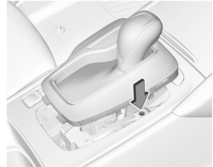
3. Einen kleinen Stab (z. B. Stift oder Schraubendreher) in die Öffnung neben dem Wählhebel einführen. Den Stab senkrecht nach unten drücken und den Wählhebel aus **P** schalten. Wenn diese Stellung wieder erreicht ist, wird der Wählhebel wieder arretiert. Ursache für die Stromunterbrechung von einer Werkstatt beheben lassen.
