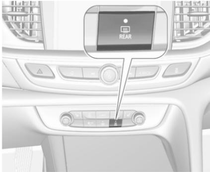
Die Heizung der Heckscheibe und der Außenspiegel wird durch Drücken auf
