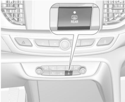
Die Heizung der Heckscheibe und der Außenspiegel wird durch Drücken auf
