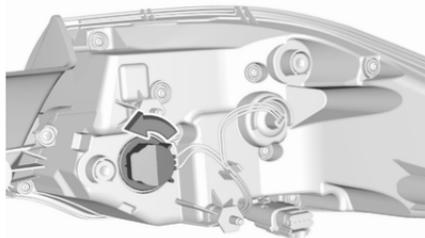
4. Die Lampenfassung des Blinkers links herum aus der Leuchteneinheit drehen und abnehmen.
