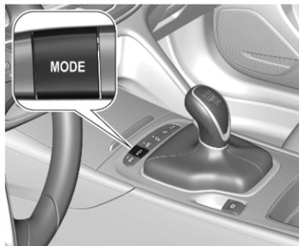
Bei Fahrzeugen mit FlexRide-Fahrmodi kann der Fahrer durch Auswahl des Sport-Modus die Beschleunigung des adaptiven Geschwindigkeitsreglers leicht erhöhen. Diese Funktion kann im FlexRide-Visualisierungsmenü deaktiviert werden ↻ 183.
