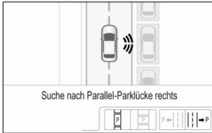
Längs- oder Querparklücke durch Antippen des entsprechenden Symbols im Display auswählen. Parkseite durch Antippen des entsprechenden Symbols im Display auswählen.
