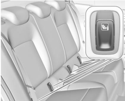
Für das Fahrzeug zugelassene ISOFIX-Kindersicherheitssysteme an den ISOFIX-Befestigungen befestigen. Die speziellen Positionen für ISOFIX-Kindersicherheitssysteme sind in der Tabelle mit ISOFIX gekennzeichnet ↷ 73.
