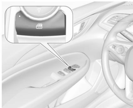
Zur Deaktivierung der elektrischen Fensterheber der hinteren Türen
