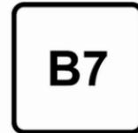
Nur Dieseldieselkraftstoff verwenden, der die Anforderungen von EN 590 erfüllt und einen Schwefelgehalt von maximal 10 ppm aufweist.
