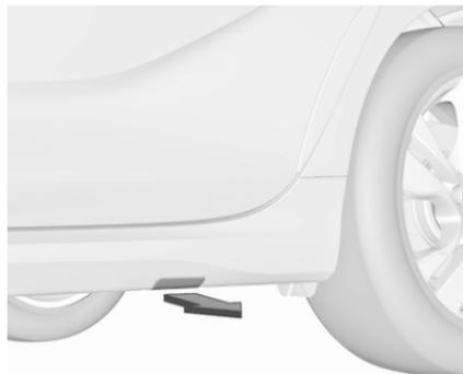
Einige Fahrzeuge verfügen über Schwellerverkleidungen mit abgedeckten Aufnahmepunkten für den Wagenheber. Zuerst die Abdeckung des entsprechenden Aufnahmepunktes abziehen.
