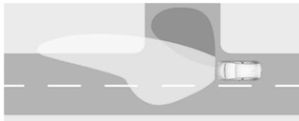
Beim Abbiegen werden je nach Lenkwinkel und Blinklicht spezielle LEDs eingeschaltet, um die Fahrtrichtung auszuleuchten. Diese Funktion ist bis zu einer bestimmten Fahrgeschwindigkeit verfügbar.
