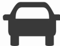
Wenn das System ein vorausfahrendes Fahrzeug in der Fahrspur erkannt hat, leuchtet die Kontrollleuchte für ein erkanntes vorausfahrendes Fahrzeug
