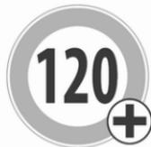
Zudem werden in der unteren Zeile des Fahrerinfodisplays permanent die aktuell gültigen Geschwindigkeitsbegrenzungen angezeigt. Wenn eine Geschwindigkeitsbegrenzung mit zusätzlichem Verkehrsschild verfügbar ist, wird in diesem Bereich ein + Symbol angezeigt.
