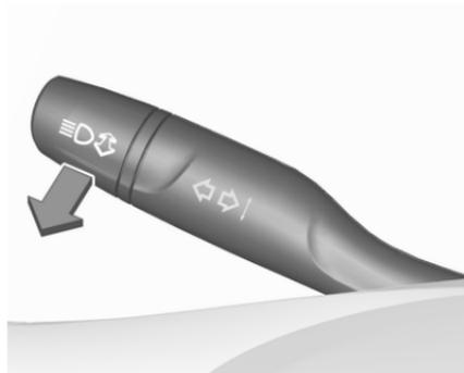
Zum Betätigen der Lichthupe Hebel zum Lenkrad ziehen.
