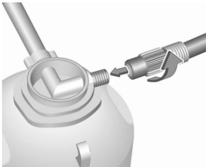
2. Typ 1: Kompressor-Luftschlauch auf den Anschluss der Dichtmittelflasche schrauben und Dichtmittelflasche in die Halterung am Kompressor einsetzen.
