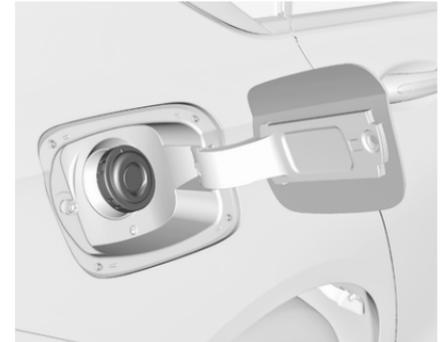
Die Tankdüse gerade am Einfüllstutzen ansetzen und mit geringem Kraftaufwand einstecken.
