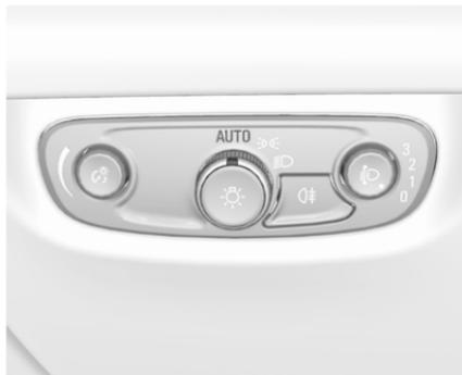
Bei aktivierter automatischer Lichtsteuerung und laufendem Motor schaltet das System abhängig von den äußeren Lichtverhältnissen und den Informationen des Wischersystems zwischen Tagfahrlicht und Scheinwerfern automatisch um. Tagfahrlicht ↗ 137.
