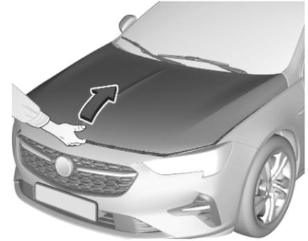
Den Sicherungshaken zur linken Fahrzeugseite drücken und die Motorhaube öffnen.
