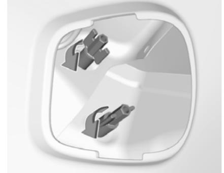
2. Die zwei Kunststoff-Befestigungsmuttern von innen mit der Hand abschrauben.
