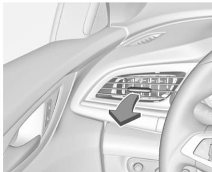
Abbildung zeigt äußere Belüftungsdüsen in der Instrumententafel.
