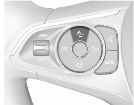
Beim ersten Drücken der Taste wird die aktuelle Einstellung im Fahrerinfodisplay angezeigt. Durch erneutes Drücken der Taste wird die Einstellung geändert. Die ausgewählte Einstellung bleibt aktiv, bis sie erneut geändert wird. Der Zeitpunkt der Warnung hängt von der Fahrgeschwindigkeit ab. Je höher die Fahrgeschwindigkeit, desto größer die Entfernung, ab der die Warnung ausgegeben wird. Beim Auswählen des Warnzeitpunkts die Verkehrs- und Witterungsbedingungen berücksichtigen.
