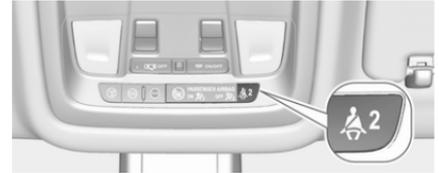
☞<sup>2</sup> für den Beifahrersitz leuchtet oder blinkt rot in der Dachkonsole, wenn der Sitz belegt ist.
