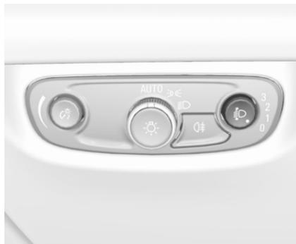
Zur Anpassung der Leuchtweite an die Fahrzeughast, um die Blendwirkung zu reduzieren: Daumenrädchen ☰☉ drücken und in die gewünschte Stellung drehen.
