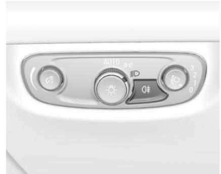
Wird durch Drücken von  $\text{D}$  bedient. Lichtschalter in Stellung **AUTO**: Beim Einschalten der Nebelschlussleuchte werden die Scheinwerfer automatisch eingeschaltet.
