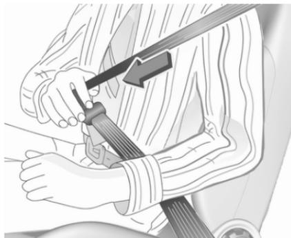
Den Gurt aus dem Aufroller herausziehen, unverdreht über den Körper legen und die Schlosszunge in das Gurtschloss einstecken, bis sie einrastet. Sicherstellen, dass der Gurt während der Fahrt eng am Körper anliegt.
