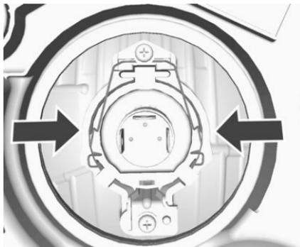
5. Den Federclip drücken und lösen.
