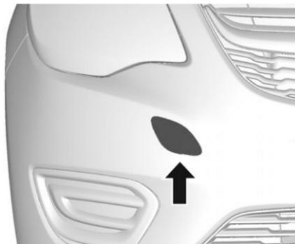
Abdeckung mit einem Schraubenzieher lösen und abnehmen.
