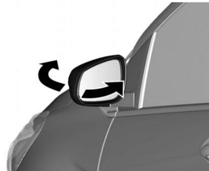
Aus Gründen der Fußgängersicherheit klappen die Außenspiegel aus ihrer Normalstellung, wenn sie mit ausreichend großer Kraft angestoßen werden. Klappen Sie sie durch leichtes Drücken auf das Spiegelgehäuse in die Normalstellung zurück.
