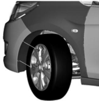
1. Rad drehen und 2 Steckmuttern an der Außenseite der Radblende abnehmen.
