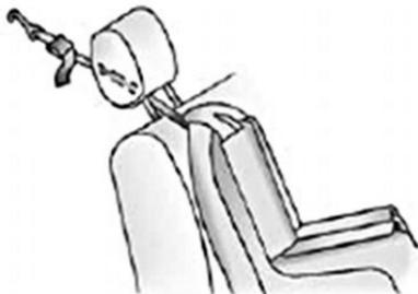
Wenn die von Ihnen genutzte hintere äußere Sitzposition eine einstellbare Kopfstütze hat und Sie einen Einzelgurt verwenden, dann heben Sie die Kopfstütze an und führen Sie diesen Einzelgurt unter der Kopfstütze zwischen den Streben der Kopfstütze hindurch.
