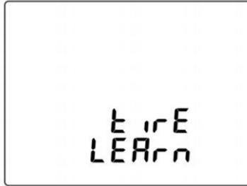
Dieser Menüpunkt dient dem Abgleichen eines neuen Reifen/neuen Rads mit den TPMS-Sensoren (Sensoren des Reifendruck-Kontrollsystems).
