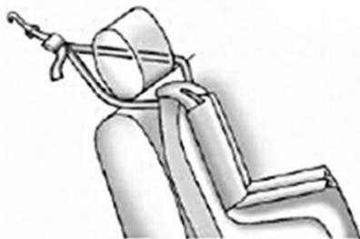
Wenn die von Ihnen genutzte hintere äußere Sitzposition eine einstellbare Kopfstütze hat und Sie ein doppeltes Halteband verwenden, heben Sie die Kopfstütze an und führen Sie das Halteband unter der Kopfstütze und um die Kopfstützenbügel herum.
