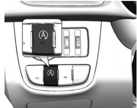
Das Stopp-Start-System lässt sich durch Drücken der Taste manuell deaktivieren. Bei Deaktivierung erlischt die LED in der Taste.
