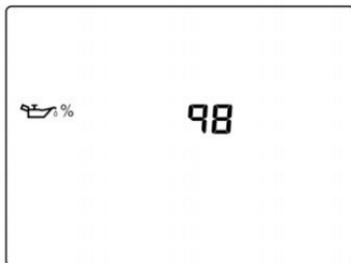
Der angezeigte Wert entspricht der geschätzten verbleibenden Motoröllebensdauer.
