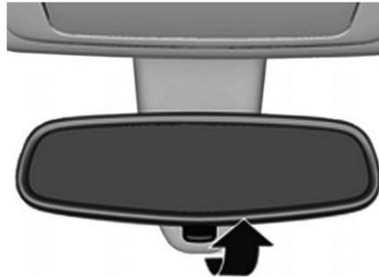
Zur Reduzierung der Blendwirkung Hebel an der Unterseite des Spiegelgehäuses verstellen.
