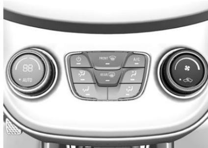
Luftstrom durch Einschalten des Gebläses auf die gewünschte Geschwindigkeit einstellen. Die gewählte Gebläsegeschwindigkeit ist anhand der Anzahl der Segmente auf dem Display
