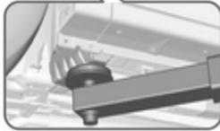
Position des vorderen Hebebühnens am Unterboden.
