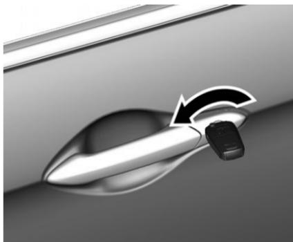
Fahrtür durch Drehen des Schlüssels im Schloss manuell entriegeln. Die Zündung einschalten und die Zentralverriegelungstaste drücken, um alle Türen und den Laderaum zu entriegeln.
