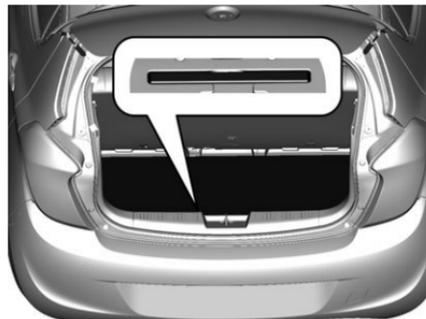
Warndreieck im Wagenwerkzeugkasten unter der Bodenabdeckung im Laderaum verstauen.
