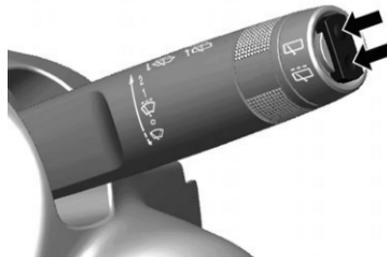
Zur Betätigung des Heckscheibenwischers Wippschalter drücken:
