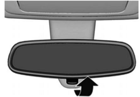
Zur Reduzierung der Blendwirkung Hebel an der Unterseite des Spiegelgehäuses verstellen.
