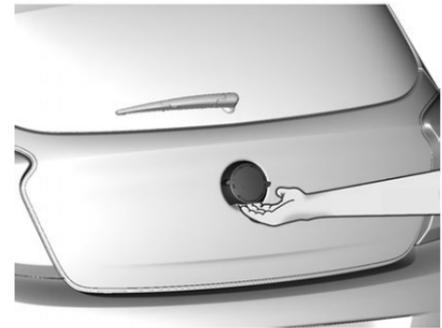
Zum Öffnen der Heckklappe den Touchpad-Schalter unter der Heckklappenleiste drücken.
