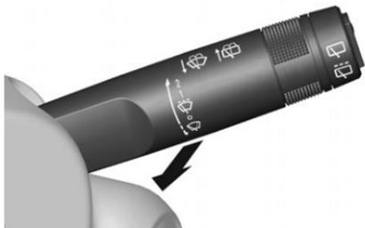
Hebel ziehen. Waschflüssigkeit spritzt auf die Windschutzscheibe und die Wischer werden für einige Wischbewegungen eingeschaltet.
