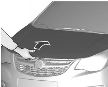
Den Sicherungshebel drücken und die Motorhaube öffnen.
