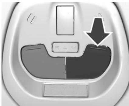
Betätigung über die Tasten an den vorderen Innenleuchten.
