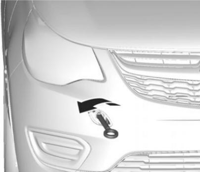
Abschleppöse bis zum Anschlag in waagrechter Stellung einschrauben. (Muss die Mutter berühren.)
