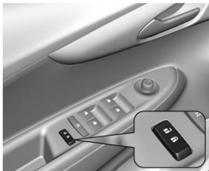
Die Zentralverriegelungstaste drücken: Die Türen werden ver- oder entriegelt.
