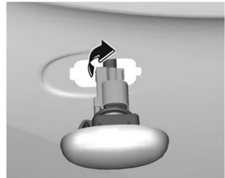
2. Lampenfassung linksherum drehen, um sie aus dem Gehäuse zu entfernen.
