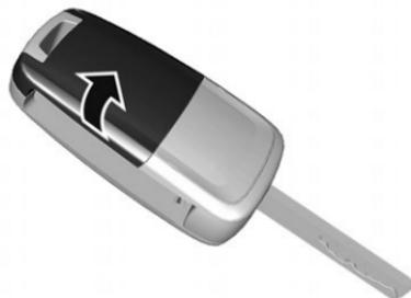
Schlüsselbart ausklappen und die Funkfernbedienung öffnen. Batterie austauschen (Batterietyp CR 2032), Einbaulage beachten. Funkfernbedienung schließen und synchronisieren.
