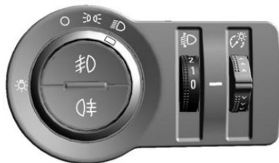
Zur Anpassung der Leuchtweite an die Fahrzeuglast, um Blendwirkung zu reduzieren: Daumenrädchen
