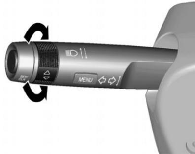
Zur Betätigung des Bordcomputers das Einstellrad am Blinkerhebel drehen.
