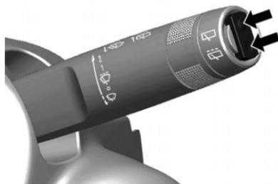
Zur Betätigung des Heckscheibenwischers Wippschalter drücken:
