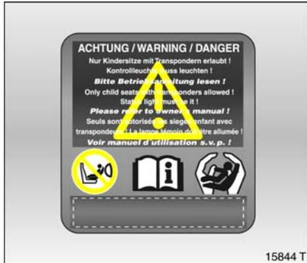
Fahrzeuge mit Sitzbelegungserkennung sind an einem Aufkleber erkennbar, der sich an der Blende unten am Beifahrersitz befindet, siehe Bild oben.
