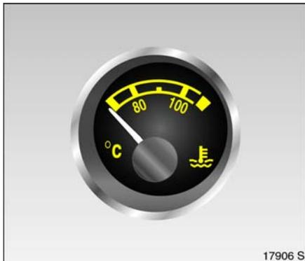
Die Kühlmitteltemperatur wird aus physikalischen Gründen nur bei ausreichendem Kühlmittelstand angezeigt.
