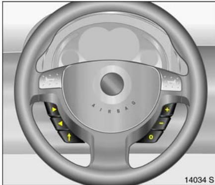
Auswahl mit den Tasten \* am Lenkrad:
