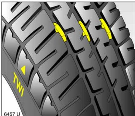
Die gesetzlich zulässige Mindestprofiltiefe (1,6 mm) ist erreicht, wenn das Profil bis zu einem Verschleißanzeiger (TWI<sup>1)</sup>) abgefahren ist. Mehrere Verschleißanzeiger sind in gleichen Abständen im Profilgrund der Lauffläche verteilt. Ihre Lage ist durch Markierungen an der Reifenflanke angezeigt.
