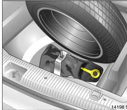
Die Abschleppöse befindet sich in der Tasche für Wagenwerkzeug \* im Gepäckraum unter dem Reserverad \*, siehe Bild oben oder bei Ausführung mit Reifenreparaturset \* im Staufach unter der Bodenabdeckung, siehe Seite 182, Bild 17918 S.
