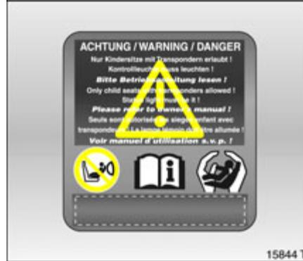
Außerdem sind Fahrzeuge mit Sitzbelegungserkennung am Aufkleber am Beifahrersitz oder seitlich an der Instrumententafel erkennbar.
