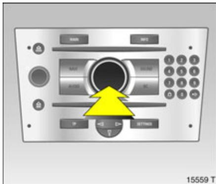
Auswahl mit dem Multifunktionsknopf **\***: Multifunktionsknopf drehen und drücken. Zum Verlassen eines Menüs Multifunktionsknopf links oder rechts herum auf **Zurück** oder **Main** drehen und auswählen.
