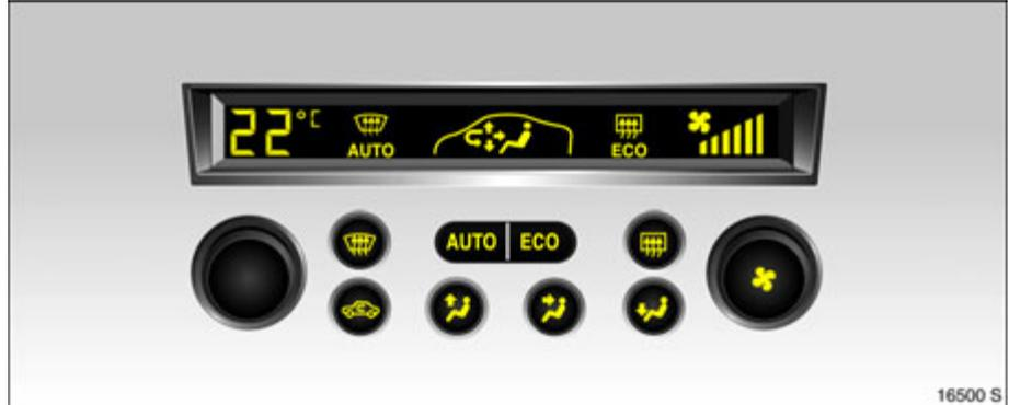
Temperaturänderungen durch äußere Einflüsse, z. B. Sonneneinstrahlung, werden automatisch ausgeglichen.
