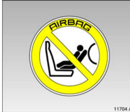
Ausführung mit Beifahrer-Airbag ist erkennbar am Schriftzug **AIRBAG** oberhalb des Handschuhfaches und am Aufkleber auf der Beifahrerseite seitlich an der Instrumententafel, siehe Bild 11704 A.
