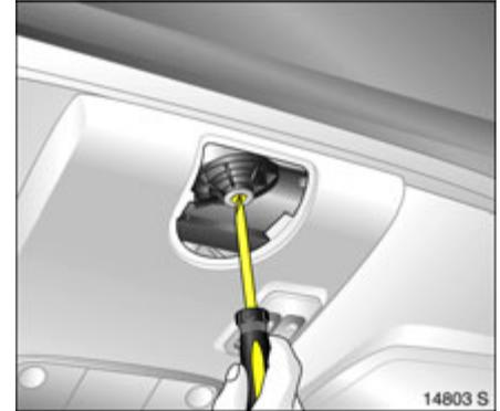
Antriebswelle mit Schraubendreher \* hindrücken und drehen, bis Schiebedach bzw. Hebedach geschlossen ist.
