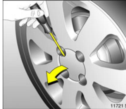
Leichtmetallräder \*: Radkappe mit Schraubendreher \* ausrasten und abnehmen, dazu Schraubendreher an der seitlichen Aussparung der Radkappe ansetzen. Dabei zum Schutz der Felge weichen Lappen zwischen Schraubendreher und Leichtmetallrad legen.
