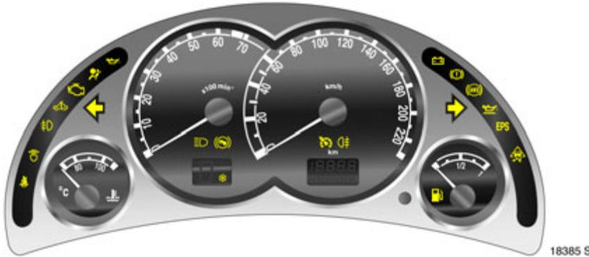
**❄ Winterprogramm des automatisiertem Schaltgetriebes \***
