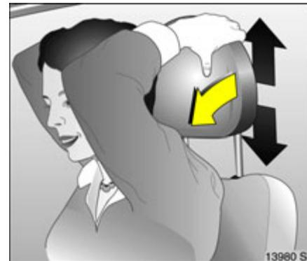
**Kopfstützhöhe der vorderen Sitze und der hinteren äußeren Sitze: Zur Entriegelung Kopfstütze nach vorn kippen, festhalten und Höhe einstellen, einrasten**
