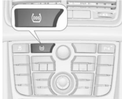
Nach Korrektur des Reifendrucks oder Radwechsel muss das System initialisiert werden: Dazu die Zündung einschalten und die Taste **DDS** etwa 4 Sekunden lang gedrückt halten.
