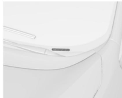
Die Fahrzeug-Identifizierungsnummer kann an der Instrumententafel eingeprägt und durch die Windschutzscheibe sichtbar sein.
