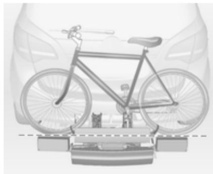
Die Radaufnahmen so einstellen, dass das Fahrrad ungefähr waagrecht steht. Der Abstand zwischen den Pedalen und der Hecktür sollte dabei mindestens 5 cm betragen.
