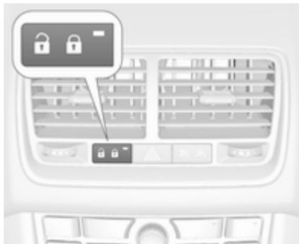
In der Zentralverriegelungstaste befindet sich eine Status-LED.
