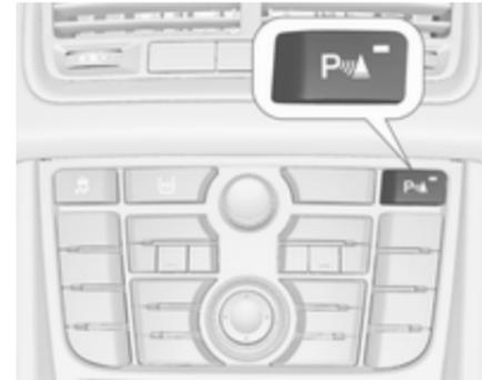
Beim Einlegen des Rückwärtsgangs wird das System automatisch aktiviert.
