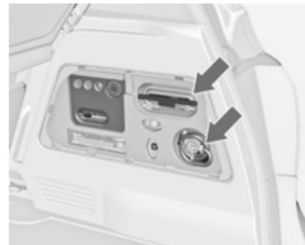
1. Die Dichtmittelflasche mit Halterung und Luftschlauch aus dem Einsatz nehmen.
