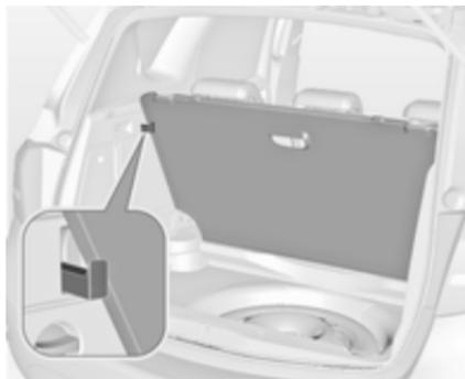
Die hintere Bodenabdeckung kann angehoben werden.
