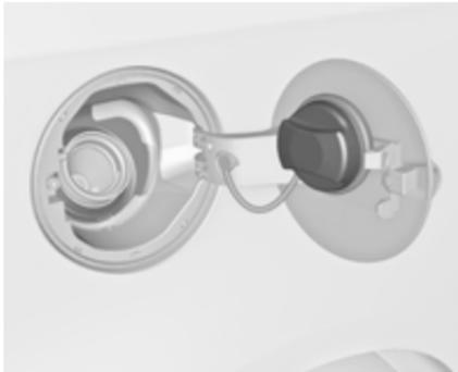
Der Tankdeckel kann in die Halterung auf der Tankklappe eingehängt werden.
