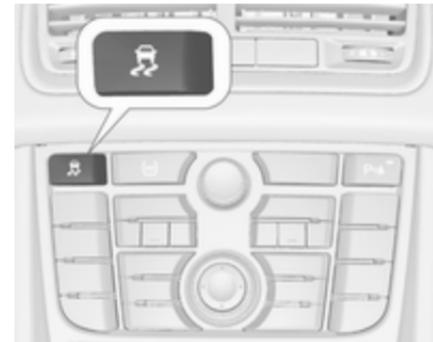
Für extremes Hochleistungsfahren kann ESC deaktiviert werden: Taste
