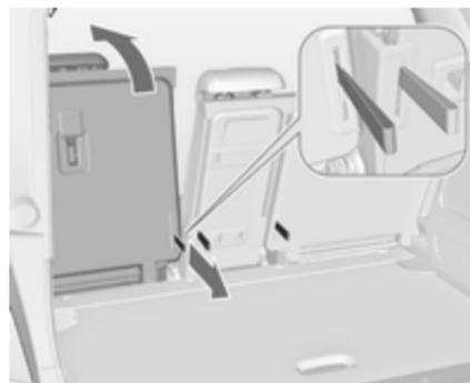
Am Gurt an der Rückseite der Rückenlehne ziehen und die Rückenlehne nach unten klappen.
