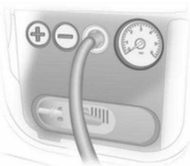
8. Am Kompressor Knopf **+** drücken. Der Reifen wird mit Dichtmittel gefüllt.
