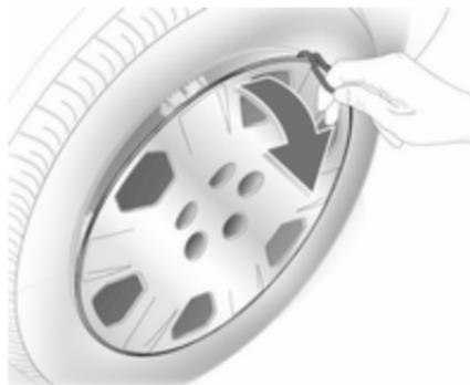
1. Radabdeckung mit dem Haken abziehen. Wagenwerkzeug ⇨ 173.
