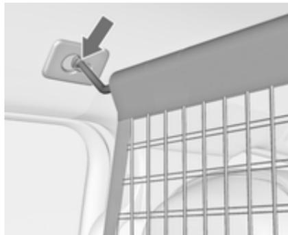
Im Dachrahmen befinden sich zwei Einbaueinheiten: Stange für das Netz an einer Seite einhängen, nach
