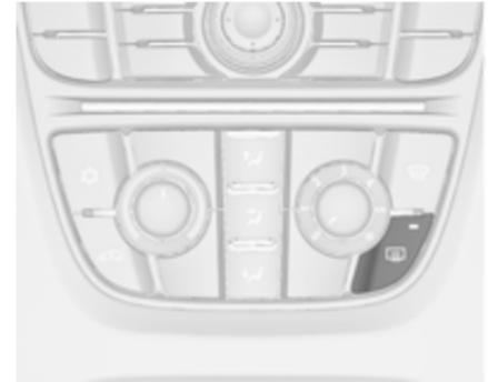
Die Heizung wird durch Drücken der Taste
