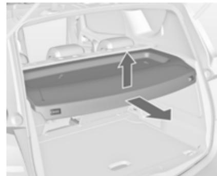
Abdeckung am hinteren Ende anheben und aus den seitlichen Führungen herausziehen.
