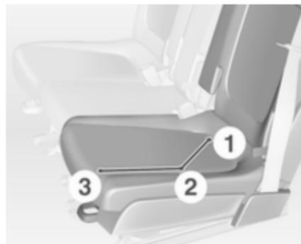
Die hintere Sitzreihe kann so eingestellt werden, dass zwei Sitze in Position **1** maximale Schulter- und Beinfreiheit bieten, oder sich drei Sitze in Position **2** befinden. In Position **1** ist der mittlere Sitz abgesenkt.
