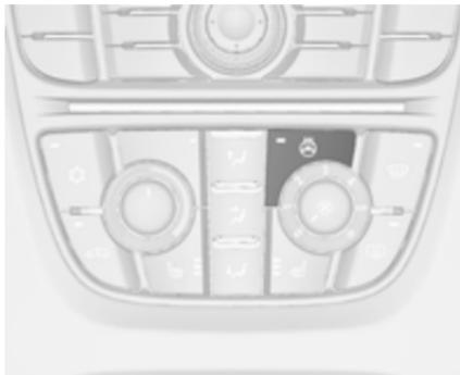
Die Heizung durch Drücken der Taste
