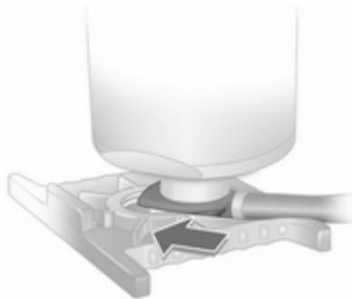
3. Die Dichtmittelflasche auf der Halterung platzieren. Sicherstellen, dass die Flasche nicht herunterfällt.
