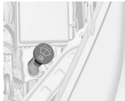
Mit einem Gemisch aus sauberem Wasser und einer geeigneten Menge frostschutzmittelhaltiger Waschflüssigkeit auffüllen. Das richtige Mischverhältnis ist auf dem Waschflüssigkeitsbehälter angegeben.
