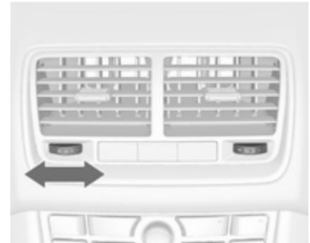
Zum Öffnen der Düse das Einstellrad nach rechts drehen. Durch Drehen am Einstellrad die Luftmenge an der Düse einstellen.
