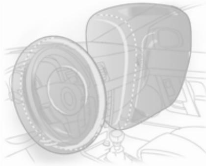
Die aufgeblähten Airbags dämpfen den Aufprall, wodurch die Verletzungsgefahr für Oberkörper und Kopf bei einem Frontalaufprall deutlich verringert wird.
