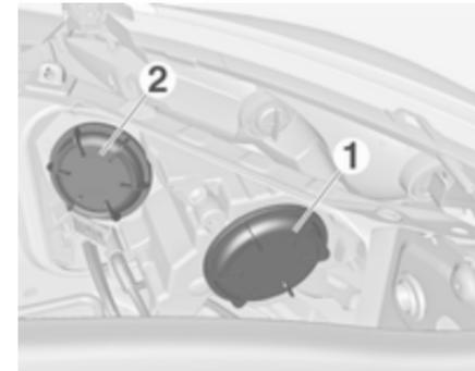
Scheinwerfer haben getrennte Systeme für Abblend- und Fernlicht 1 (äußere Lampen) sowie zusätzliches Fernlicht 2 (innere Lampen). Das Abbiegelicht befindet sich ebenfalls hinter der Abdeckung für das zusätzliche Fernlicht.
