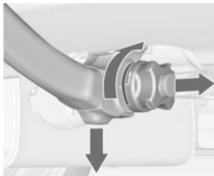
Schutzlasche öffnen und zum Entriegeln der Kugelstange Schlüssel nach rechts drehen.
