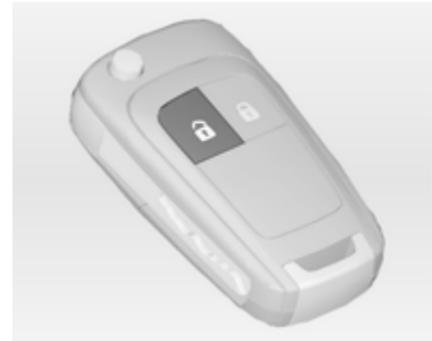
Wenn bei ausgeschalteter Zündung alle Türen entriegelt werden sollen, die Taste
