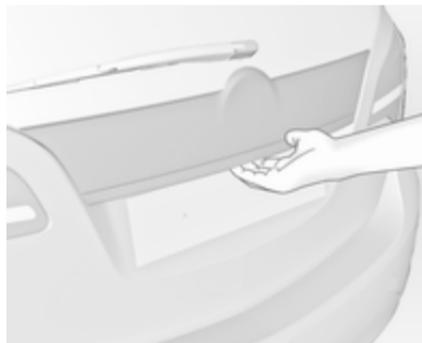
Nach dem Entriegeln den Touchpad-Schalter unter der Hecktürleiste betätigen und die Hecktür öffnen.
