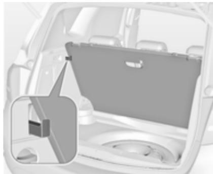
Die hintere Bodenabdeckung kann angehoben werden.
