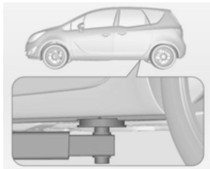
Den hinteren Arm der Hebebühne am Unterboden ansetzen.
