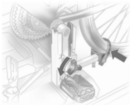
Spannbander an beiden Fahrradreifen lösen.
