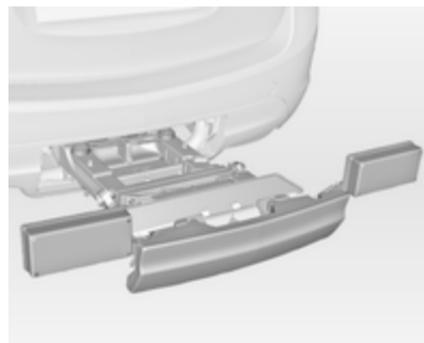
Position von Kabel und Leuchte prüfen, um sicherzustellen, dass sie korrekt montiert sind und fest sitzen.
