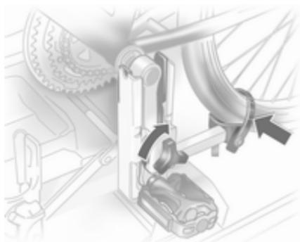
Die Klemmschraube der Tretlagerfixierung bis zum Maximalpunkt von Hand festziehen.
