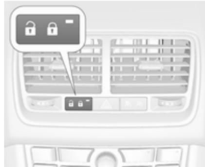
In der Zentralverriegelungstaste befindet sich eine Status-LED.
