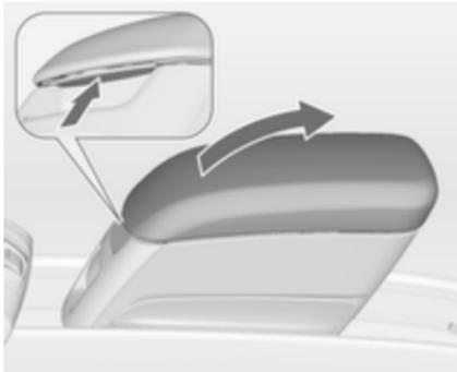
Knopf drücken und den Deckel der Armlehne nach oben klappen. Die Armlehne enthält ein Ablagefach.
