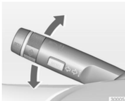
Hebel nach oben = Blinker rechts
