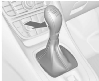
Rückwärtsgang: Bei stehendem Fahrzeug das Kupplungspedal durchtreten, den Entriegelungsknopf am Wählhebel betätigen und den Gang einlegen.
