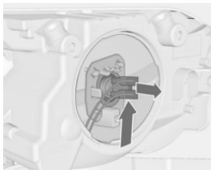
2. Die Lampenfassung nach oben drücken und aus dem Reflektor ziehen.
