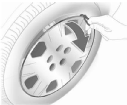
1. Radabdeckung mit dem Haken abziehen. Wagenwerkzeug ⇨ 182.
