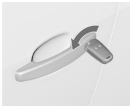
Fahrtür durch Drehen des Schlüssels im Schloss manuell entriegeln. Zündung einschalten und Zentralverriegelungstaste drücken, um alle Türen, Laderaum und Tankklappe zu entriegeln. Durch Einschalten der Zündung wird die Diebstahlsicherung deaktiviert ⇨ 29.
