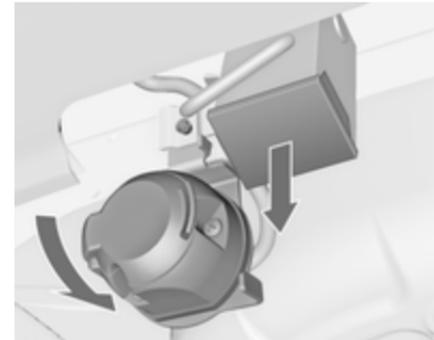
Steckdose austrasten und nach unten klappen. Verschlussstopfen von der Öffnung für die Kugelstange entfernen und verstauen.
