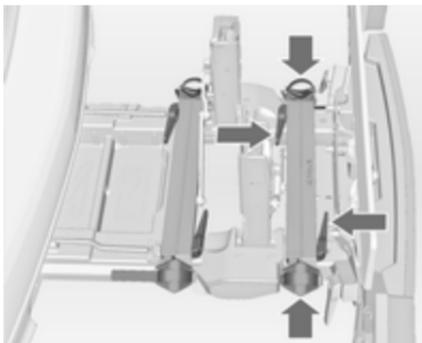
Entriegelungshebel drücken und Radaufnahmen vollständig bis zum Anschlag einschieben.
