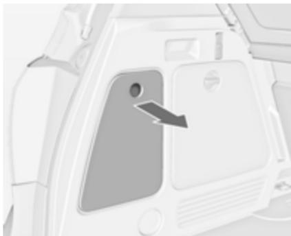
Der Sicherungskasten befindet sich auf der linken Seite im Laderaum hinter einer Abdeckung. Abdeckung entfernen.
