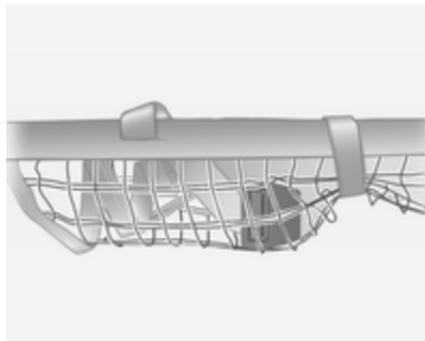
Klettband neben den Längenverstellern eng ums Netz legen. Die Längenversteller und Netzstangen müssen flach nebeneinander liegen.
