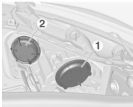
Scheinwerfer haben getrennte Systeme für Ablendlicht 1 (äußere Lampen) und Fernlicht 2 (innere Lampen).
