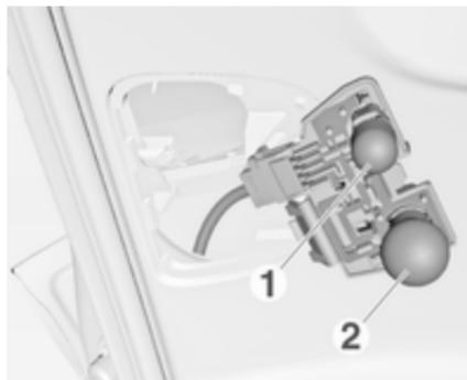
3. Zum Austauschen der Glühlampe der Rückfahrleuchte (1) die Glühlampe herausnehmen und ersetzen.
