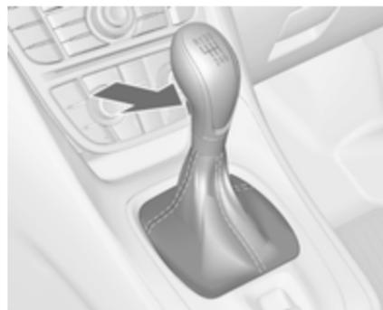
Zum Einlegen des Rückwärtsgangs, bei stehendem Fahrzeug Knopf am Wählhebel betätigen und Gang einlegen.
