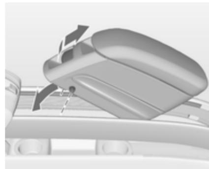
Die Armlehne vorn absenken. Fest am vorderen Griff ziehen und die vorderen Führungsstifte in die oberen Führungsschienen einsetzen. Den Griff loslassen. Die Armlehne bewegen, bis sie hörbar einrastet.
