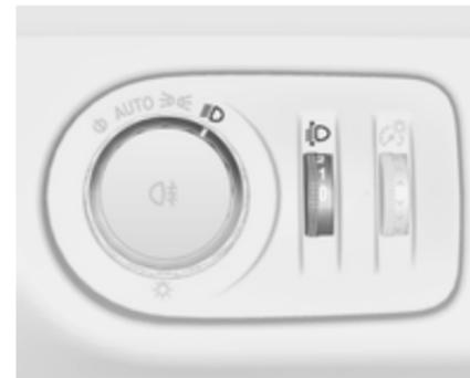
Zur Anpassung der Leuchtweite an die Fahrzeugbeladung, um Blendwirkung zu reduzieren: Daumenrad
