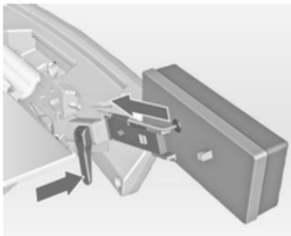
Spannhebel nach unten drücken und Lampenträger in die Halterung drücken, bis er einrastet. Vorgang für beide Rückleuchten durchführen.
