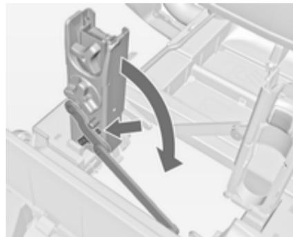
Arretierungshebel an der diagonalen Stütze ausrasten und beide Trekkur-belaufnahmen nach unten klappen.
