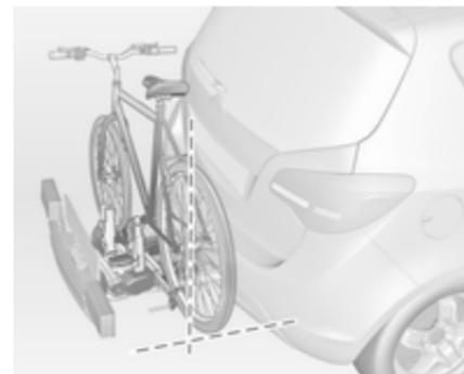
Fahrrad in Fahrzeuginnenraum ausrichten: Tretlagerfixierung etwas lösen.
