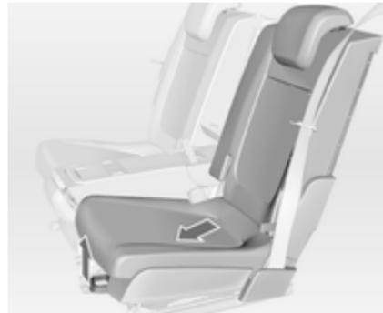
Am Griff ziehen und den Sitz schräg nach vorn in Position 2 schieben. Der Sitz gleitet automatisch nach außen. Den Griff loslassen und den Sitz einrasten lassen.
