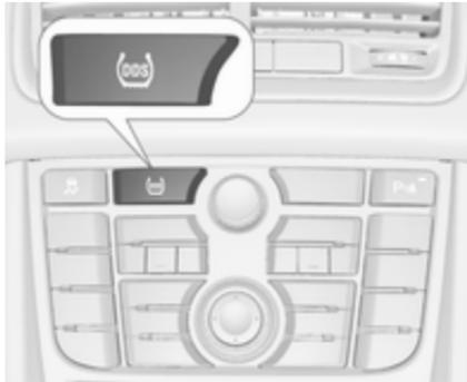
Nach Korrektur des Reifendrucks oder nach einem Radwechsel muss das System initialisiert werden: Dazu die Zündung einschalten und die Taste **DDS** etwa 4 Sekunden lang gedrückt halten.
