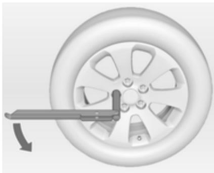
Radschraubenschlüssel herausklappen und sicherstellen, dass er gut sitzt. Jede Radmutter um eine halbe Drehung lösen.
