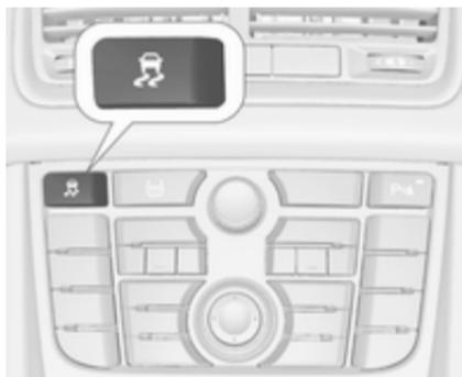
Die Traktionskontrolle kann ausgeschaltet werden, wenn ein Durchdrehen der Antriebsräder erwünscht ist: Taste
