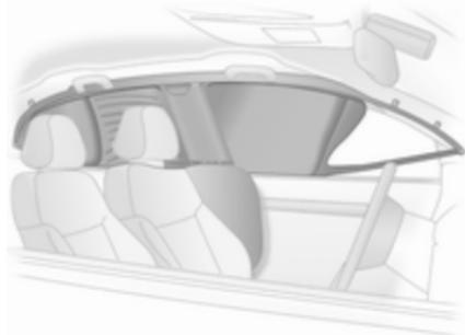
Der aufgeblähte Airbag dämpft den Aufprall, wodurch die Verletzungsgefahr für den Kopf bei einem Seitenaufprall deutlich verringert wird.
