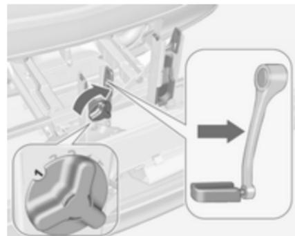
Bei gekrümmten Tretkurbeln am Fahrrad Tretkurbelanlage vollständig hineindrehen (Position 1).
