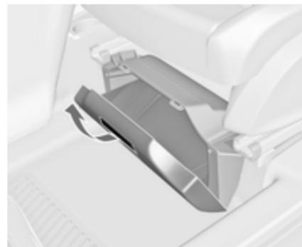
Je nach Fahrzeug befindet sich unter dem Fahrersitz ein Kasten. Am Griff ziehen und die Abdeckung nach unten klappen. Höchstlast: 1,5 kg.
