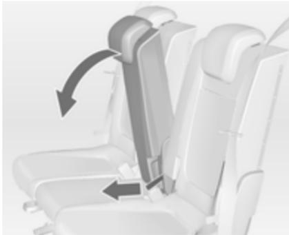
Am Band ziehen und den mittleren Sitz nach unten klappen.
