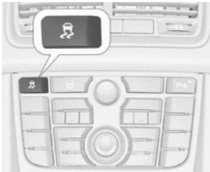
Für extremes Hochleistungsfahren kann ESC deaktiviert werden: Taste
