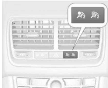
Solange die Kontrollleuchte
