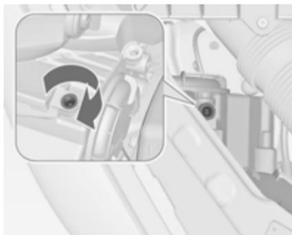
Die Stellschrauben mit dem Schraubendreher eine halbe Umdrehung nach rechts drehen.
