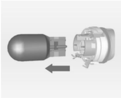
2. Die Lampe aus der Fassung lösen und austauschen.
