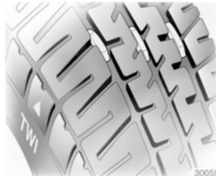
Die gesetzlich zulässige Mindestprofiltiefe (1,6 mm) ist erreicht, wenn das Profil bis zu einem Verschleißanzeiger (TWI = Tread Wear Indicator) ab-
