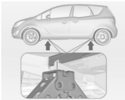
3. Sicherstellen, dass der Wagenheber an den Aufnahmen richtig ausgerichtet ist.
