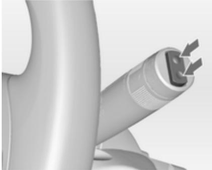
Zur Betätigung des Heckscheibenwischers Wippschalter drücken:
