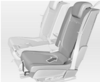
Am Griff ziehen und den Sitz schräg nach hinten in Position 1 schieben. Der Sitz gleitet automatisch nach innen. Den Griff loslassen und den Sitz einrasten lassen.
