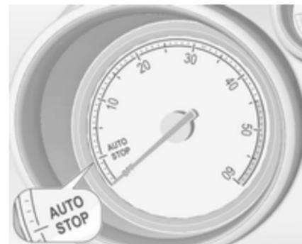
Ein Autostop wird auf dem Drehzahlmesser angezeigt, indem die Nadel auf der Position **AUTOSTOP** steht.
