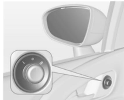
Gewünschten Außenspiegel durch Drehen des Bedienelements nach links (**L**) bzw. rechts (**R**) wählen. Danach das Bedienelement schwenken, um den Spiegel einzustellen. In Stellung **0** ist kein Spiegel ausgewählt.
