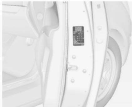
Reifendruck  $\varnothing$  216 und auf dem Aufkleber an der Beifahrertür.
