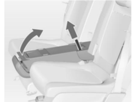
Am Band ziehen und den mittleren Sitz nach oben klappen.
