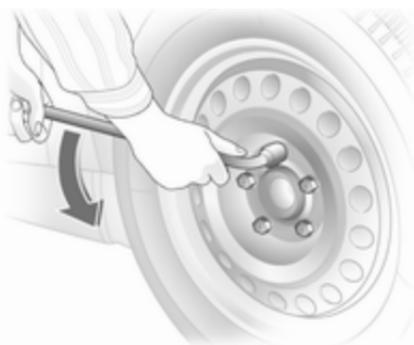
Radschraubenschlüssel ansetzen und sicherstellen, dass er gut sitzt. Die Radschrauben jeweils eine halbe Umdrehung lösen.
