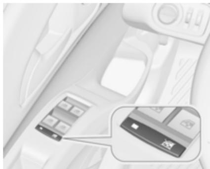
Zur Deaktivierung der elektrischen Fensterbetätigung der Hintertüren Schalter
