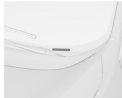
Die Fahrzeug-Identifizierungsnummer kann an der Instrumententafel eingepägt und durch die Windschutzscheibe sichtbar sein.
