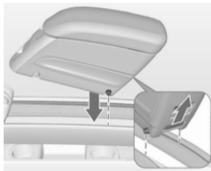
Den hinteren Knopf drücken und die hinteren Führungsstifte in die oberen Führungsschienen einsetzen. Den Knopf loslassen.
