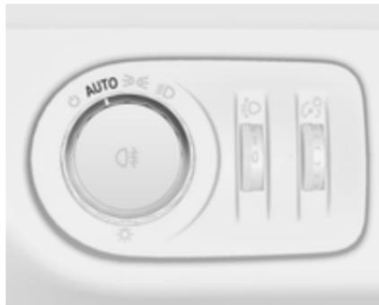
Wenn das automatische Fahrlicht bei laufendem Motor aktiviert wird, schaltet das System je nach Umgebungslicht zwischen Tagfahrlicht und Abblendlicht um.
