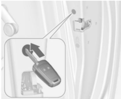
Den Schlüssel in die Öffnung über dem Schloss an der Türinnenseite einführen und das Schloss betätigen, indem Sie drücken, bis es klickt. Dann die Tür schließen. Dies muss bei allen anderen Türen wiederholt werden. Die Fahrertür lässt sich mit dem Schlüssel auch von außen verriegeln. Tankklappe und Hecktür können nicht verriegelt werden.
