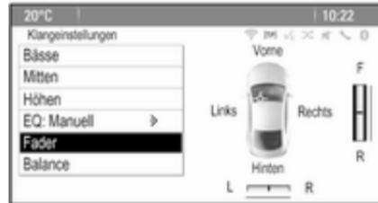
**Fader** auswählen, um die Lautstärkeverteilung zwischen den vorderen und hinteren Fahrzeugausprechern anzupassen. Die Einstellungen wie gewünscht anpassen.
