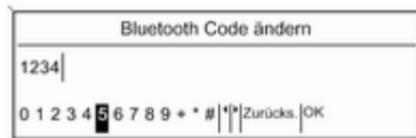
**Bluetooth Code ändern** auswählen. Im angezeigten Menü den aktuellen Bluetooth-Code bearbeiten und den geänderten Code mit **OK** bestätigen.
