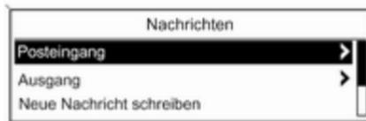
Wenn das Mobiltelefon mittels SAP-Modus gepaart wurde, kann der Nutzer über das Mobiltelefon Portal Nachrichten anzeigen, verfassen und verschicken. Die Nachrichten können in diesem Menü auch gelöscht werden.
