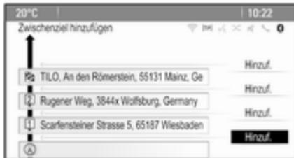
An der Position, an der der Wegpunkt hinzugefügt werden soll, **Hinzuf.** auswählen. Das Menü **Zieleingabe** wird angezeigt.
