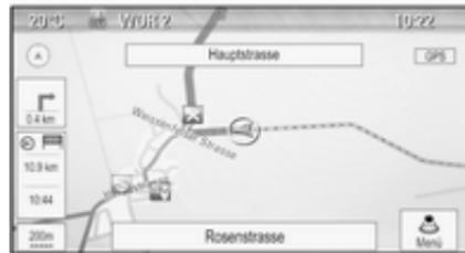
Zum Löschen des bereits aufgezeichneten Ariadnepfads in einer aktiven Sitzung **Löschen** auswählen. Eine Meldung mit einer Eingabeaufforderung wird angezeigt. Bestätigen Sie die Meldung, um den gesamten Ariadnepfad zu löschen.
