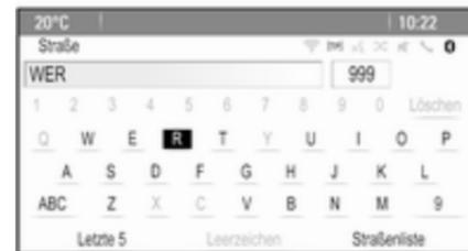
Um die Buchstabenanordnung der Tastatur zu ändern, links an der Tastatur **ABC** auswählen. Die Buchstaben werden in alphabetischer Reihenfolge angeordnet.
