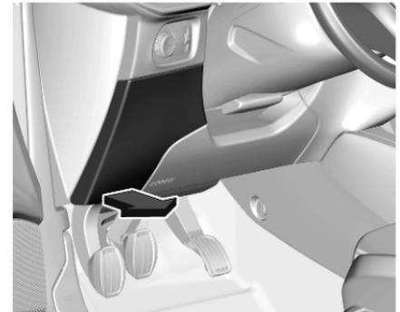
Bei Linkslenkern befindet sich der Sicherungskasten hinter einer Abdeckung in der Instrumententafel. Abdeckung an der Unterseite lösen und abnehmen.
