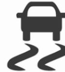
Die elektronische Stabilitätsregelung und die Traktionskontrolle sind nach jedem Motorstart funktionsfähig, sobald die Kontrollleuchte
