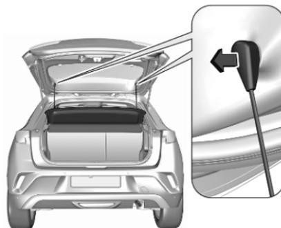
Haltebänder von Heckklappe lösen.
