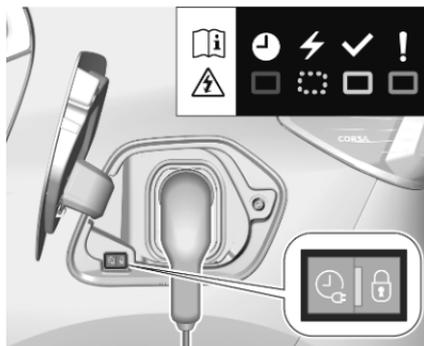
Der Beginn des Ladens wird durch eine grün blinkende Statusanzeige am Ladeanschluss und am Kontrollgerät des Ladekabels angezeigt.
