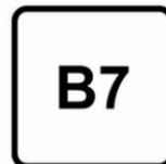
Dieselmotorkraftstoff gemäß der Norm EN590, gemischt mit einem Biokraftstoff gemäß der Norm EN14214 (mit bis zu 7 % Fettsäuremethylester).
