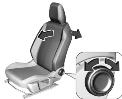
Handrad drehen. Zum Einstellen Rückenlehne entlasten.
