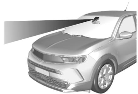
Das aktivierte System beobachtet mithilfe einer Kamera oben an der Windschutzscheibe die Spurmarkierungen. Das System lenkt das Fahrzeug in der erkannten Fahrspur. Der Fahrer spürt dabei, wie sich das Lenkrad dreht.
