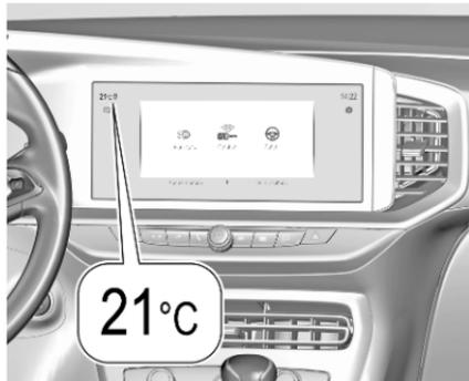
Die Abbildung zeigt ein Beispiel. Wenn die Außentemperatur unter einen bestimmten Wert sinkt, wird im Fahrerinfodisplay eine Warnmeldung angezeigt.
