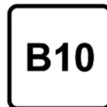
Dieselmotoren gemäß der Norm EN16734, gemischt mit einem Biokraftstoff gemäß der Norm EN14214 (mit bis zu 10 % Fettsäuremethylester).
