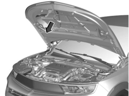
Die Motorhaube unter Verwendung des Griffs absenken und aus geringer Höhe (20–25 cm) in die Rastung fallen lassen. Sicherstellen, dass die Motorhaube eingerastet ist.
