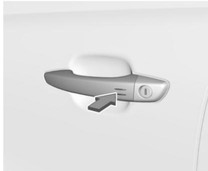
Die Zentralverriegelung kann auch durch Berühren des Sensors am Fahrertürgriff bedient werden.
