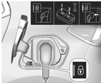
Nach dem Beginn des Ladevorgangs wird der Fahrzeugstecker am Ladeanschluss verriegelt und kann während des aktiven Ladens nicht getrennt werden. 🔒 leuchtet.
