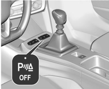
Beim Ausrücken des Rückwärtsgangs wird das System ausgeschaltet. Auf **P<sub>OFF</sub>** drücken, um das System manuell auszuschalten. Bei Deaktivierung des Systems leuchtet die LED in der Taste auf. Nach dem manuellen Ausschalten wird das System beim nächsten Einschalten der Zündung nicht automatisch wieder aktiviert.
