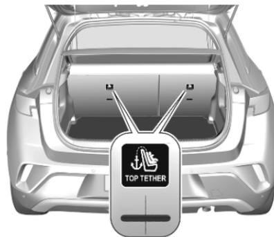
Zusätzlich zu den ISOFIX-Befestigungen, den Top-Tether-Befestigungsgurt an den Top-Tether-Befestigungsösen verankern.
