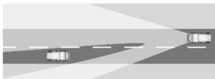
Jede LED auf der rechten bzw. linken Seite wird entsprechend der Verkehrslage speziell zu- oder ausgeschaltet. Das sorgt für die bestmögliche Lichtverteilung, ohne dass Verkehrsteilnehmer geblendet werden.
