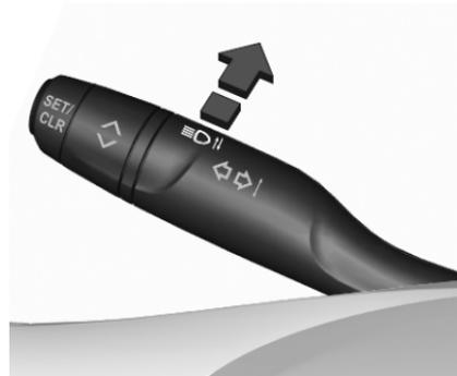
Durch Drücken wird von Abblend- auf Fernlicht umgeschaltet.
